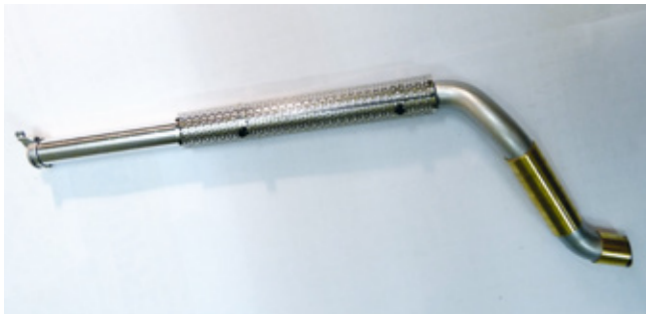
Die verlängerte und hochgezogene Auspuffanlage
