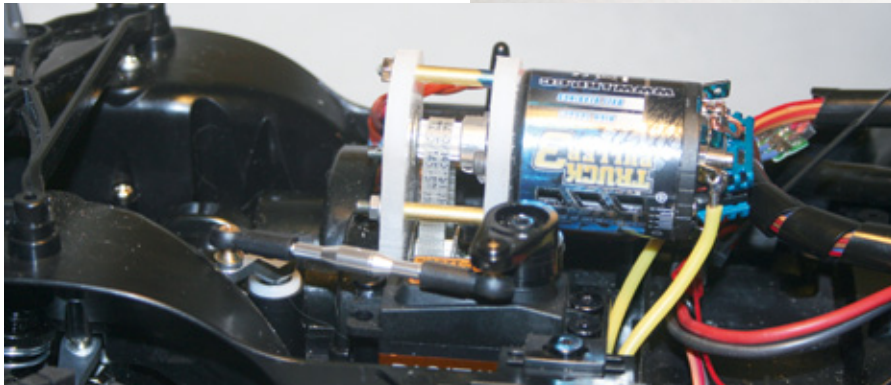
Der Truckpuller von LRP ist mit einem Riemenantrieb kombiniert und sorgt somit für reichlich Vortrieb
