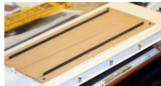
Der Gleisaufbau wird an den Ecken von vier Schrauben gehalten
