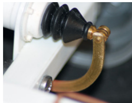
Zwei gebogene Messingteile sowie etwas Kupferdraht deuten die Bremsmechanik an
