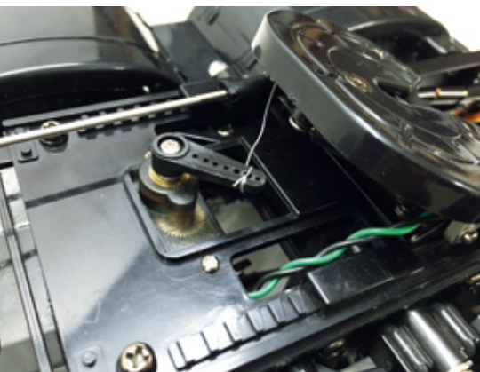
Die Sattelkupplung wird manuell bedient. Es besteht aber auch die Möglichkeit, ein fast unsichtbares Miniservo einzubauen
