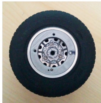
Der Magnethalter ist im Rad verbaut. Er ist auf der Drei-Uhr-Position zu sehen
