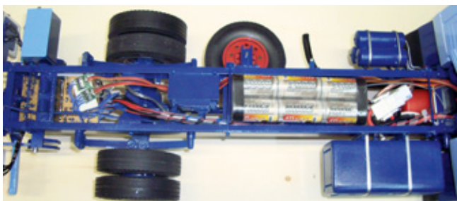
Elektronik und Fahrakku finden im Chassis Platz
