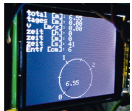
Die erste Version der Anzeige. Sie misst Zeit und Entfernung
