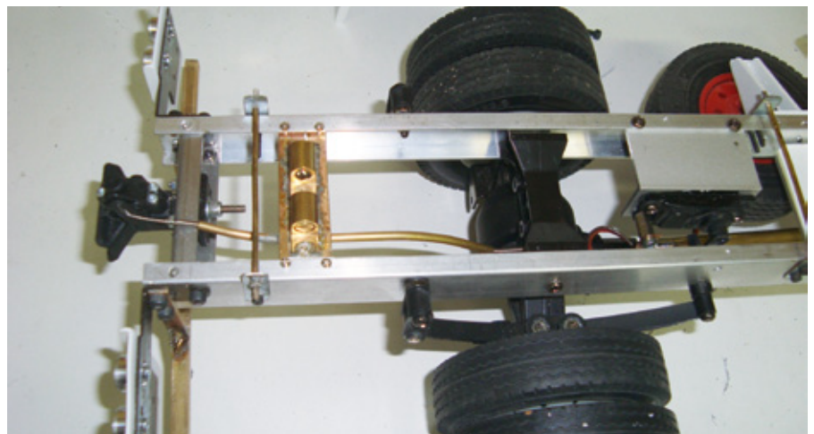
Das Servo für die Kupplung sitzt vor der Hinterachse, betätigt wird die Verriegelung mittels Bodenzug
