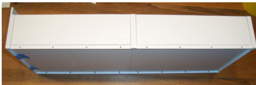
Die Pritsche wurde ebenfalls aus Polystyrol auf der CNC-Maschine gefertigt
