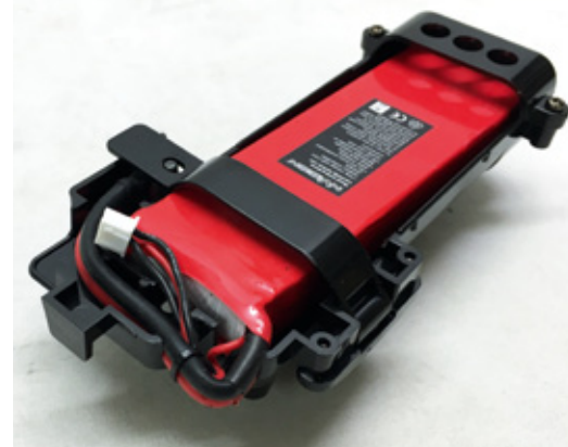
Für den Einsatz von LiPo-Akkus wurde das Akkufach etwas bearbeitet. Das Unterbodenakkufach selbst ist bereits von anderen Tamiya-Trucks bekannt
