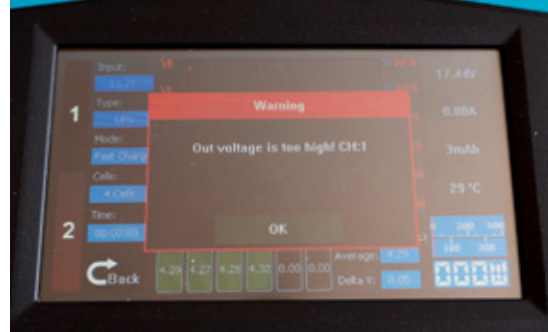
Die Ausgangsspannung kann auf kritische Werte ansteigen
