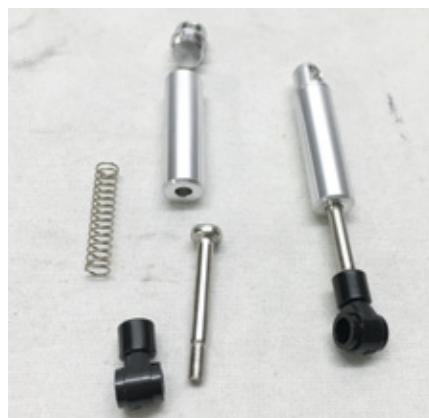
Die vorderen Stoßdämpfer werden mit einer kleinen Feder bestückt
