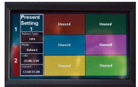
Je Kanal stehen sechs Speicherplätze zur Verfügung
