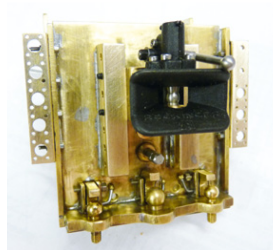
Das Heck ist mit Kupplungen und Befestigungsleisten für Steckdosen detailreich gestaltet
