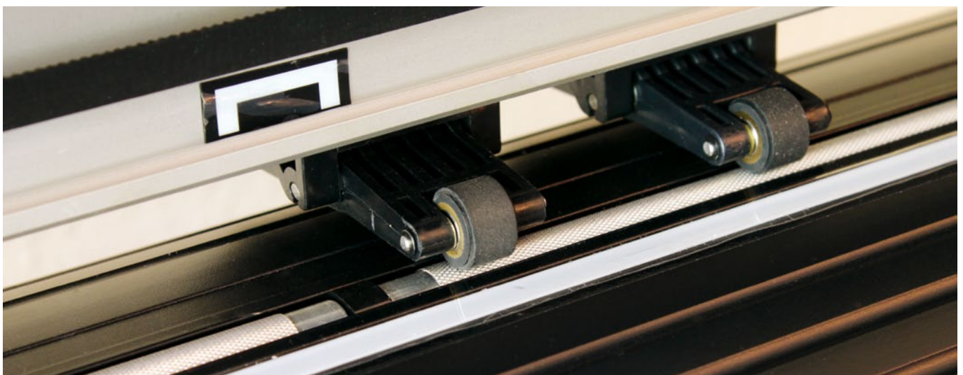
Zwei verstellbare Andruckrollen fixieren die Plotter-Folie auf der Transportrolle. Gerade bei größeren Objekten wären drei oder gar vier Andruckrollen besser
