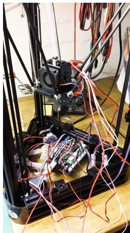
Kabelsalat: Unübersichtlich sieht es nach der testweisen Verkabelung aus. Funktioniert die Elektronik richtig, werden die Kabel anschließend sortiert
