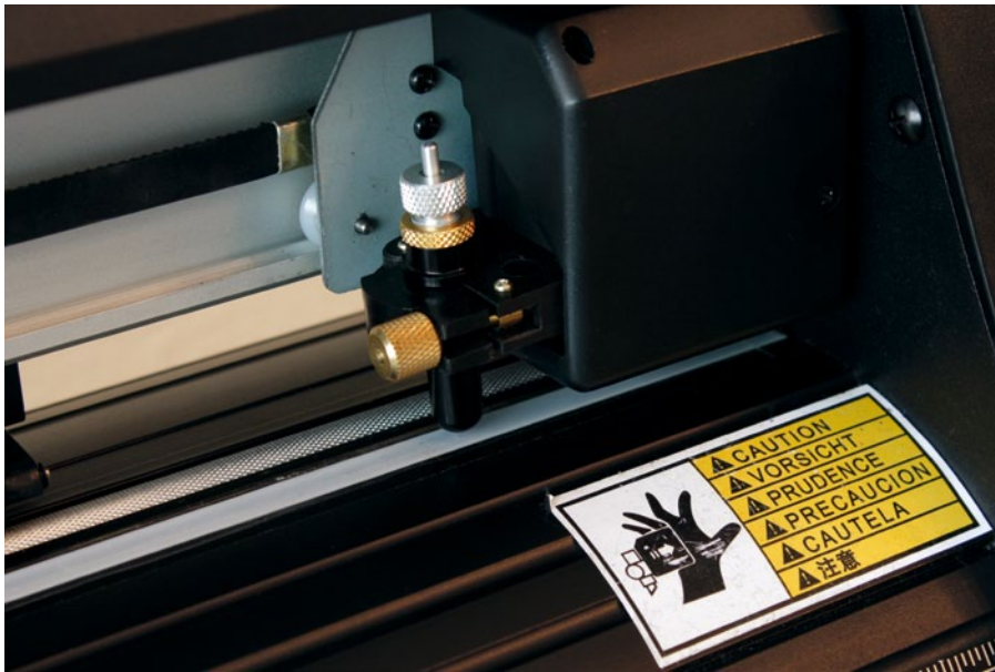
Das Messer sitzt gut geschützt in der schwarzen Aufnahme. Über die goldenen und silbernen Rändelschrauben oben wird die Schnitttiefe eingestellt
