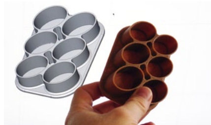
Das fertige 3D-Teil sollte in der Regel dem 3D-Objekt am Bildschirm sehr ähnlich sehen, in diesem Fall stimmt lediglich die Oberflächenfarbe nicht
