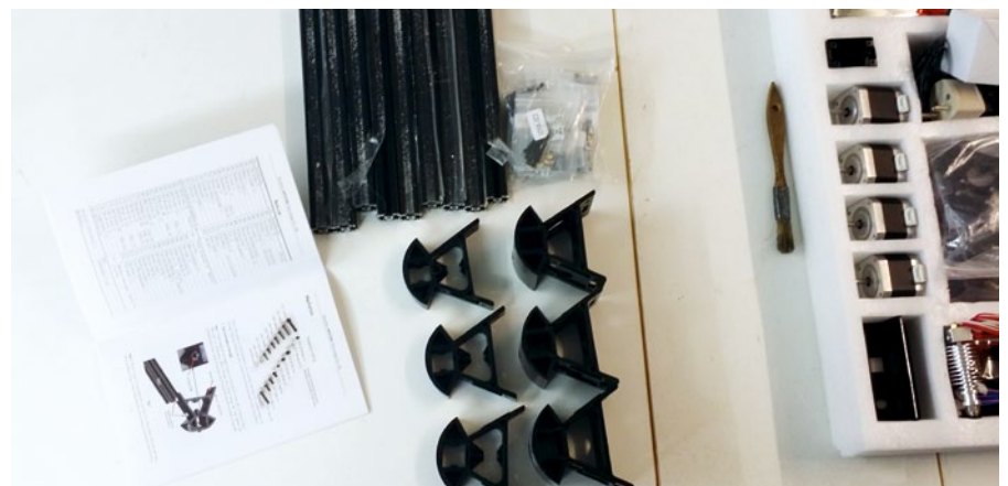
Es geht an die Montage des Druckerrahmens. Die Anleitung erläutert jeden Arbeitsschritt sehr gut. Die Aluprofile müssen vor dem Zusammensetzen von den Sägespänen befreit werden
