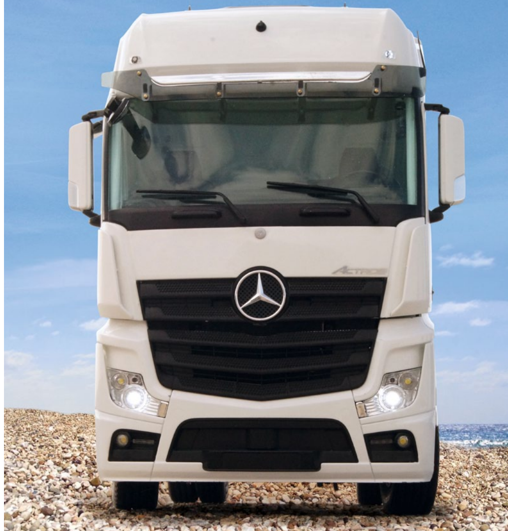
Das Abblendlicht schaltet sich mit dem typischen Xenon-Einschaltblitz ein; darunter sitzen die Tagfahrleuchten, die die charakteristische Streifenform haben
