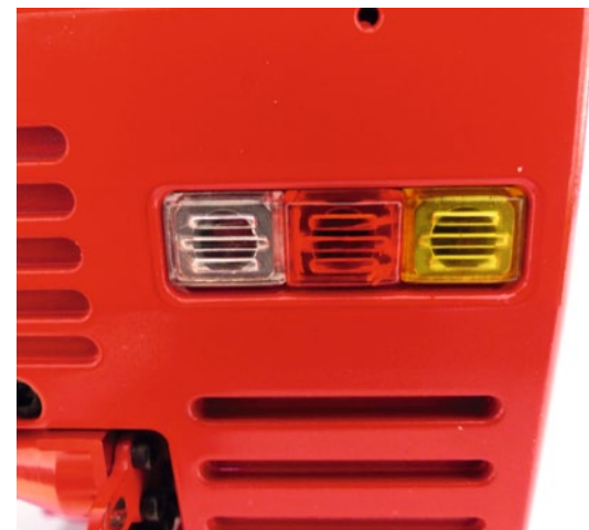
Die Rücklichter können mit 5-mm-LED versehen werden
