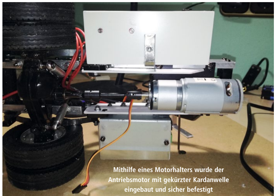
Die mit Längsstreben verschraubte Aluminiumbodenplatte sorgt für die notwendige Stabilität
