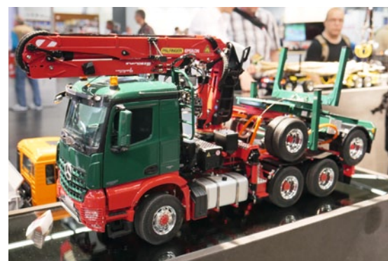
Bei Leerfahrten nimmt die Zugmaschine – hier eine Arocs-Version – den Dolly gewissermaßen huckepack
