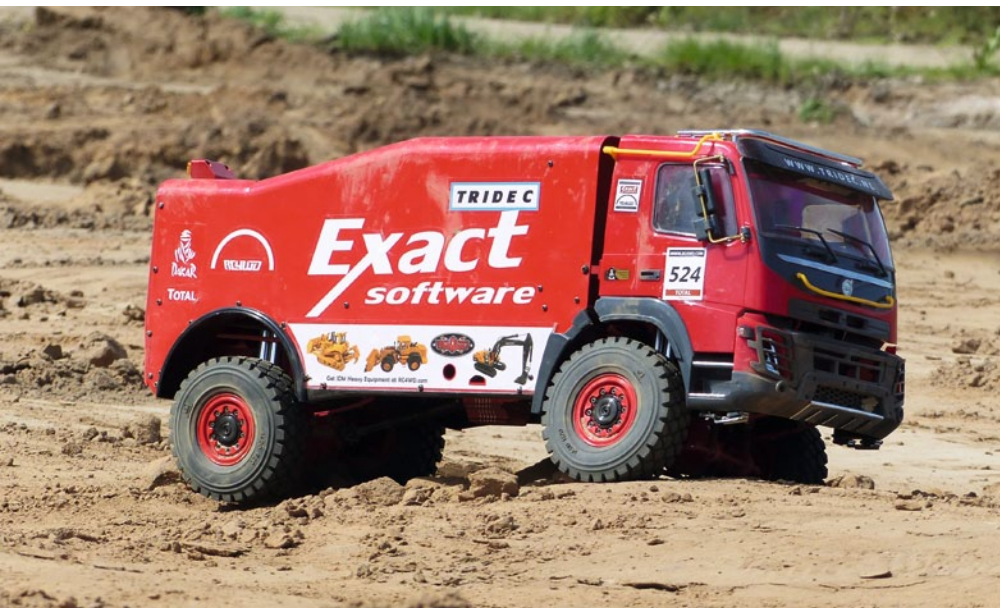
Die beachtliche Verschränkung der Achsen sorgt für viel Agilität im Gelände
