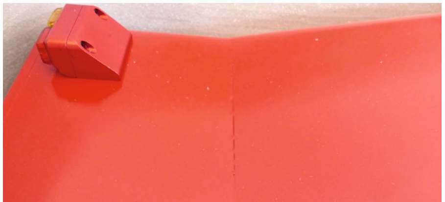
Die an manchen Stellen nicht optimalen Schweißnähte sind nur bei näherem Hinsehen erkennbar
