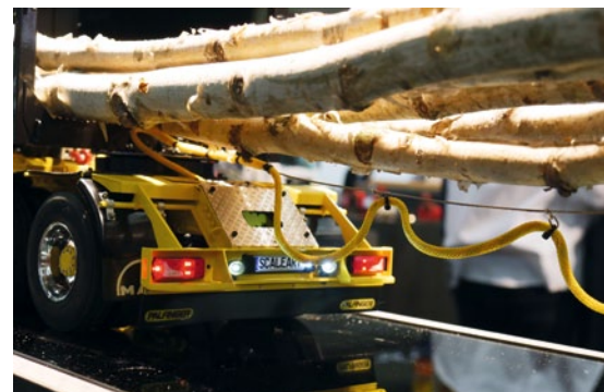
Die Verbindung zwischen Zugmaschine und Nachläufer erfolgt per Stahlkabel, die Signale werden ebenfalls per Kabel übertragen. Wahlweise ist aber auch eine Infrarot-Übertragung erhältlich
