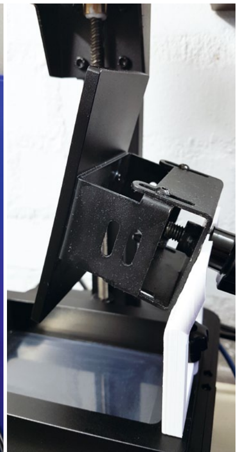
Nach dem Druck: Die Buildplate sitzt in der Abtropfhalterung, sodass das flüssige Resin in die Druckwanne ablaufen kann
