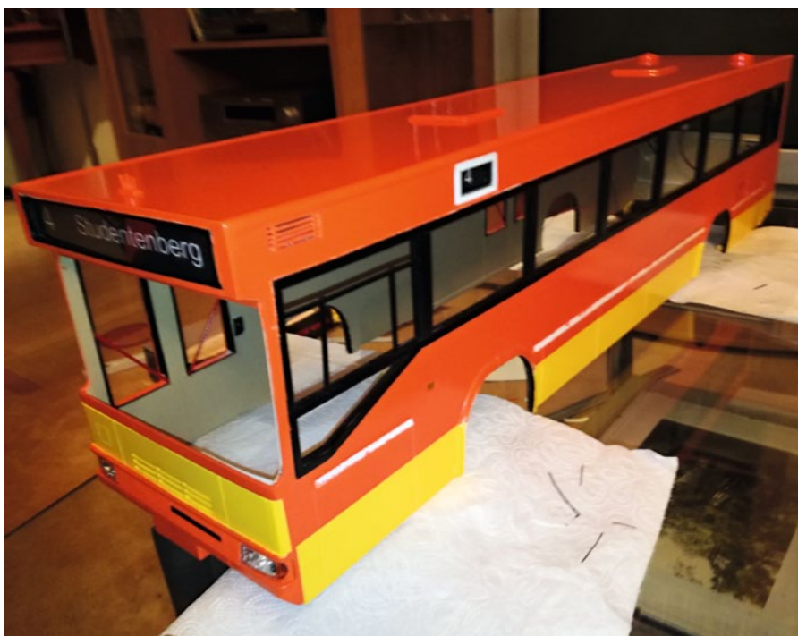
Möglichst genau den Vorgaben des Originals entsprechend, wurde erst der Innenraum lackiert und anschließend die typische orange-gelbe Außenlackierung aufgebracht
