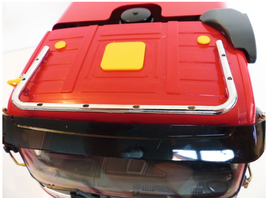
Die Vertiefungen in der Dachreling sind zur Aufnahme der vier Zusatzscheinwerfer und der Drucklufthörner vorbereitet
