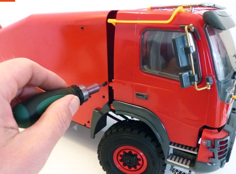
Ungewöhnlich, aber effektiv: die Fahrerhausverriegelung des Rallye-Trucks
