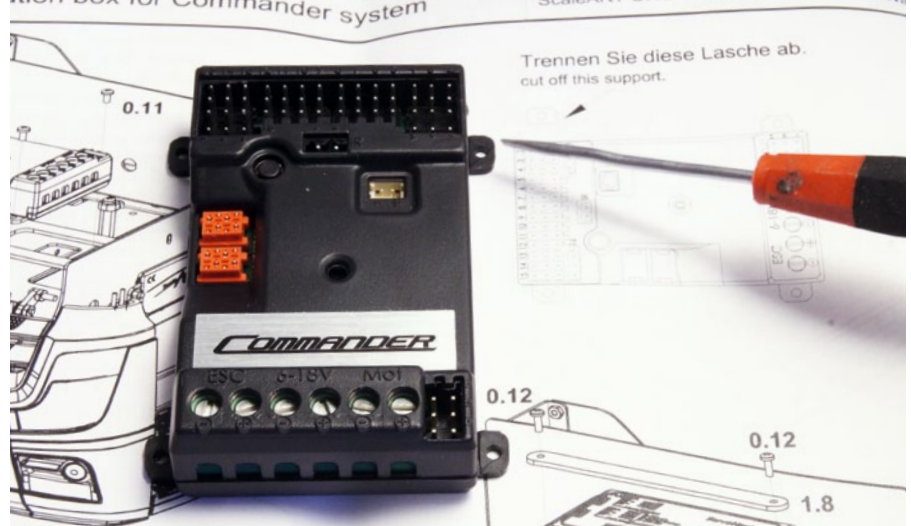
Die Anleitung fordert unmissverständlich: das Ding muss ab, damit der Empfänger rein passt
