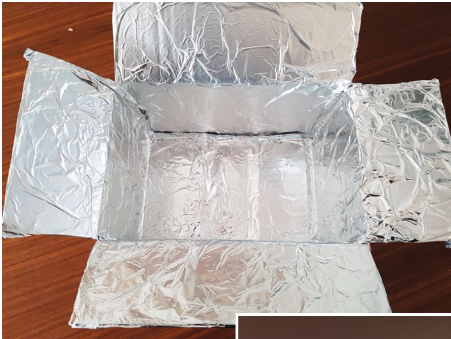
Die selbstgebaute Härtekammer für größere Objekte besteht aus einem Pappkarton, der mit Alu-Folie von innen ausgekleidet ist
