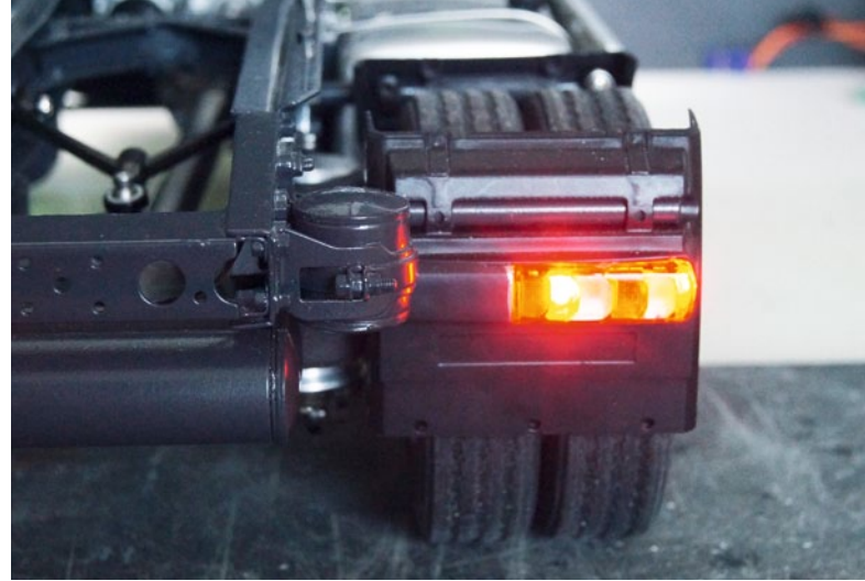
Die LED in den R ckleuchten strahlen hell und gleichm a ig in den Streuscheiben
