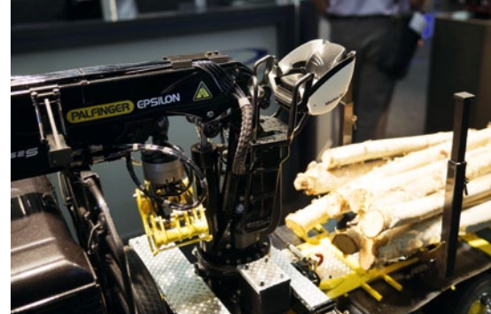
Der Palfinger-Kran des Typs Epsilon S290L ist hoch detailliert gestaltet und verfügt über ein Hydrauliksystem mit 18 bar Betriebsdruck
