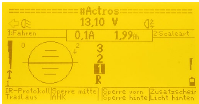
Anzeige im oberen Commander-Display zeigt unter anderem Spannung und aktuellen Strom im Bordnetz, die Akkukapazität sowie die eingeschalteten Leuchten
