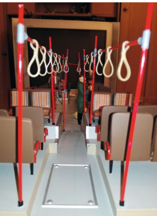
Die Halteriemien sind aus einem Lederantriebsband gebogen, verklebt und schließlich angemalt worden
