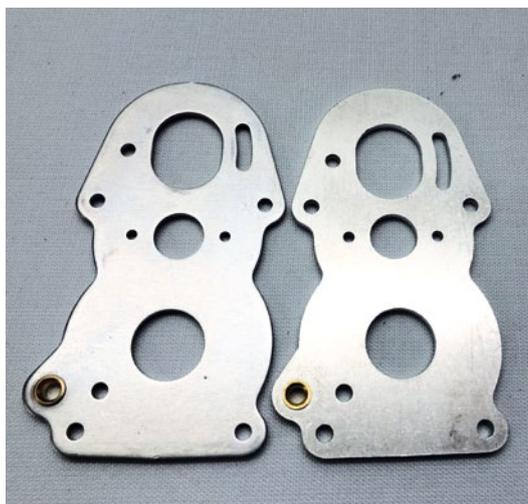
Die Neuerung an der Getriebeplatte ist kaum auszumachen. Das gebogene Langloch auf der rechten Platte ist ein wenig länger. Dadurch kann der Motor weiter verdreht und mit einem kleineren Motorritzel bestückt werden, welches ausschlaggebende Wirkung auf die Getriebeausgangsdrehzahl hat
