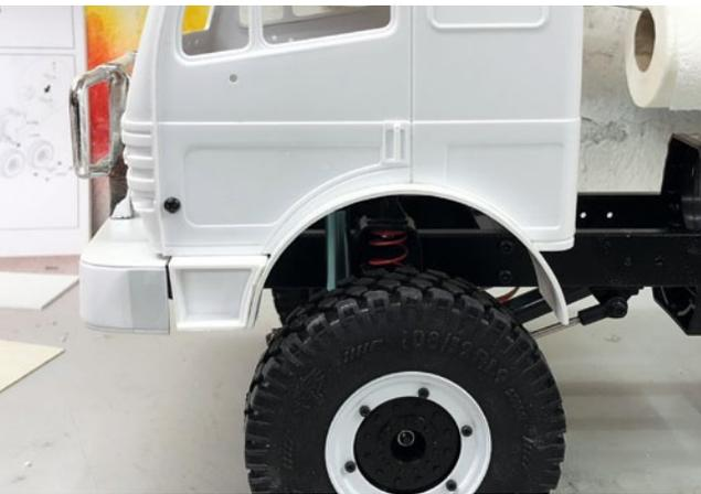
Ein breiter, gebogener PS-Streifen wurde direkt in den Radausschnitt geklebt. Die Trittstufe wurde aus dem Original-Kotflügel herausgetrennt. Die Stoßstange ist mit einem kleinen PS-Stück verlängert worden und von oben und unten mit PS-Platten abgedeckt
