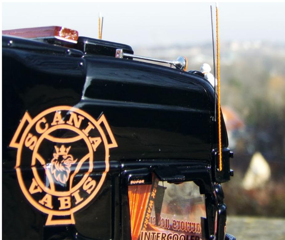
**Aus dünnen Gießstäben sind die Antennenfüße geschnitten, alle vier Antennen aus Blumenbindedraht gefertigt. Die orangenen CB-Antennen sind umwickelt mit feinem Kupferlackdraht**
