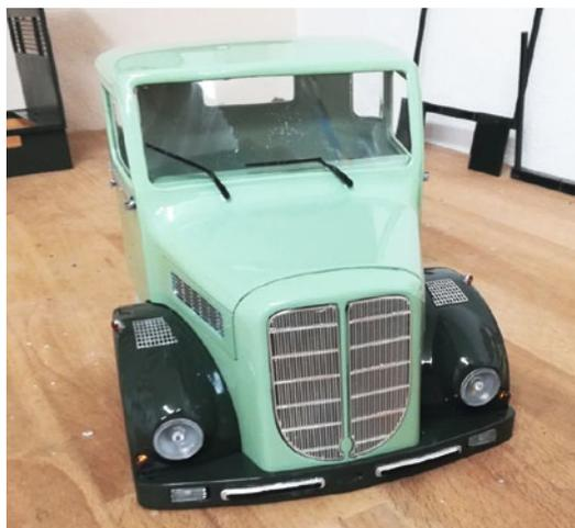
Ein echtes Schmuckstück ist das Fahrerhaus, das aus 3D-Druck-Komponenten entstand
