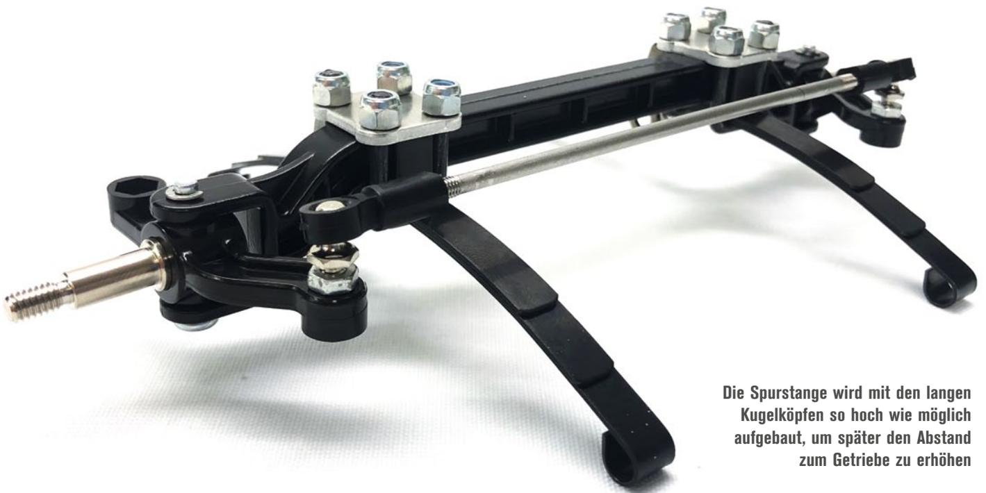
Die Spurstange wird mit den langen Kugelköpfen so hoch wie möglich aufgebaut, um später den Abstand zum Getriebe zu erhöhen
