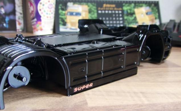
Der Bausatz hatte das Problem, dass die Verkleidungen im Radius nicht mit den vorderen und hinteren Kotflügeln übereinstimmten. Der Radius musste angepasst werden
