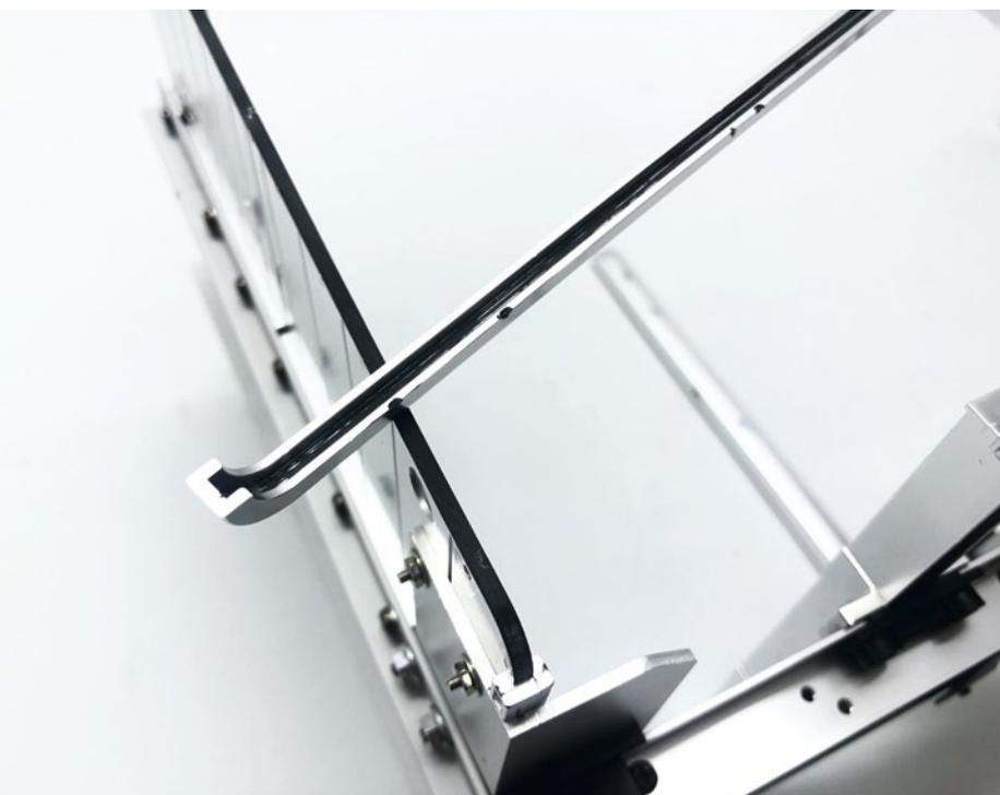
Die Kunststoffstirnwand wird seitlich mit einem kleinen Rahmen abgeschlossen. Für eine sichere Verklebung muss man die „Versilberung“ abkratzen, bis der schwarze Kunststoff zum Vorschein kommt. Nur so funktioniert dann die Kaltverschweißung mit Hilfe des Modellbauklebers
