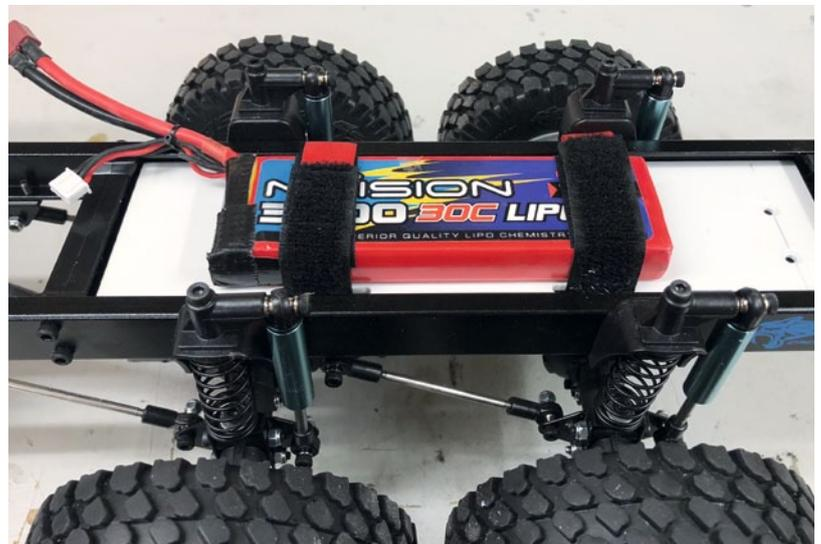
Allein wegen der Gewichtsverteilung ist es von Vorteil, dass sich der Akku über den hinteren Achsen befindet. Fixiert wird er mit zwei Klettbändern auf einer PS-Platte
