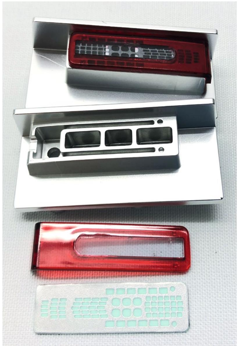
Die Rücklichter entsprechen dem Original in herausragender Weise. Mit dem Aufkleber, den man hinter die Streuscheibe klebt, werden die kleinen LED-Lichter simuliert
