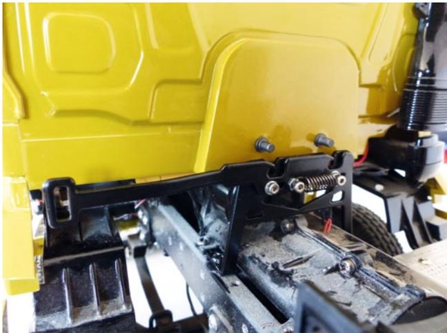
Ist die Verriegelung geöffnet, kann das Fahrerhaus gekippt oder nach oben abgezogen werden. So kann man schnell und unkompliziert an die unter der Kabine platzierten Bauteile herankommen
