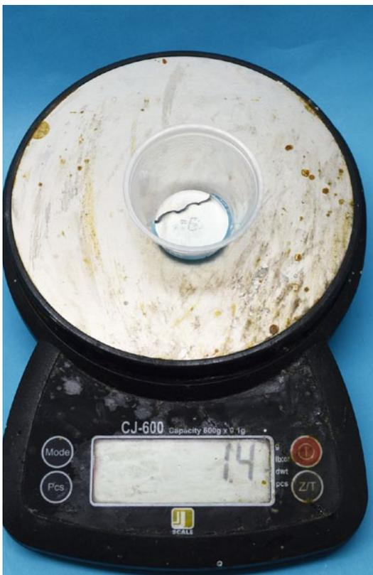
In diesem Becher sind 1,4 Gramm abgewogen: 1 Gramm Harz plus 0,4 Gramm Härter; Mischungsverhältnis also 100 zu 40 oder 10 zu 4. Und der Zustand der Waage zeugt von ihrem bedingungslosen Einsatz
