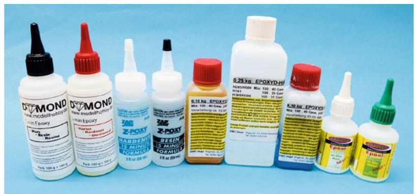
Klebesystem-Armada! Von links: Fünf-Minuten-Epoxy, 15-Minuten-Epoxy, schneller Härter (Topfzeit zehn Minuten) für Epoxydharz L 285, Harz L 285, langsamer Härter für L 285 und ganz rechts 30-Minuten-Epoxy
