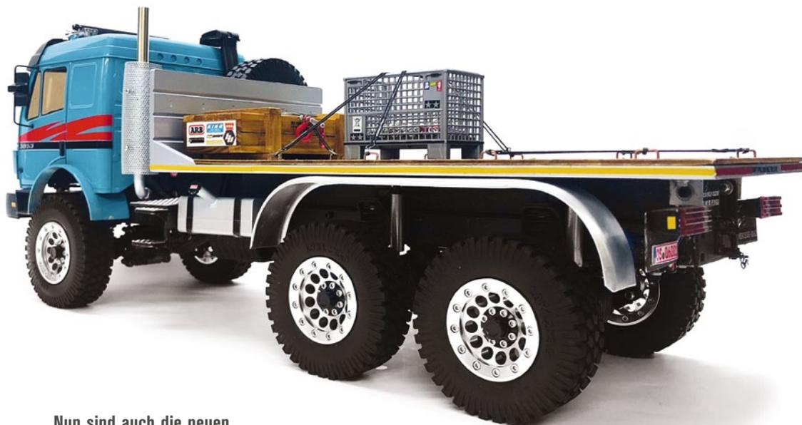
Nun sind auch die neuen Alu-Beadlockfelgen aufgezogen und die hinteren beiden Räder werden von einem Kotflügel abgedeckt
