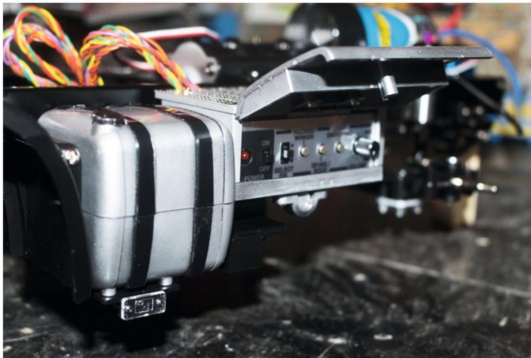
Die Steuereinheit wird versteckt untergebracht. Mit ihrer Hilfe kann man grundlegende Funktionen bequem von außen regeln
