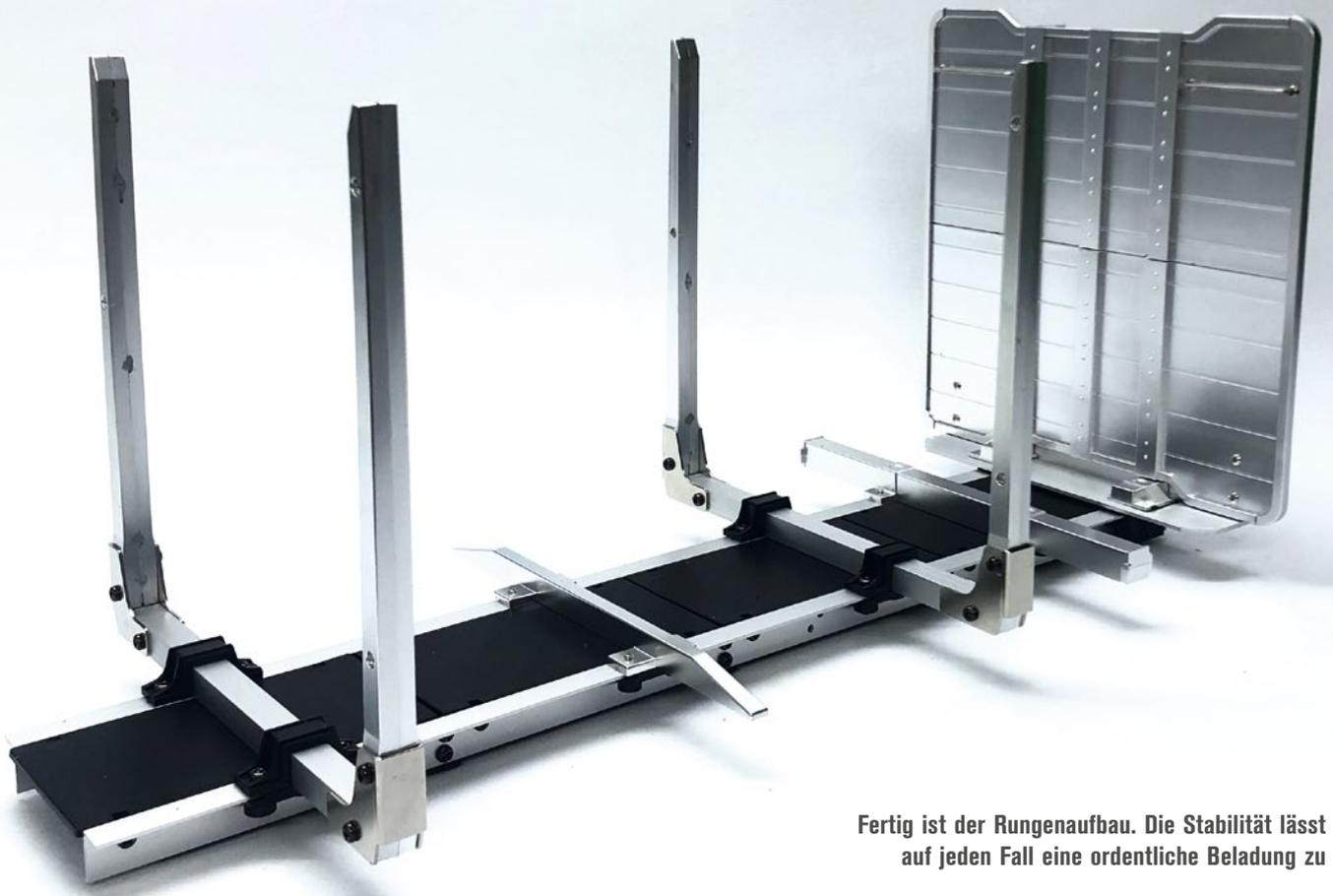
Fertig ist der Rungenaufbau. Die Stabilität lässt auf jeden Fall eine ordentliche Beladung zu
