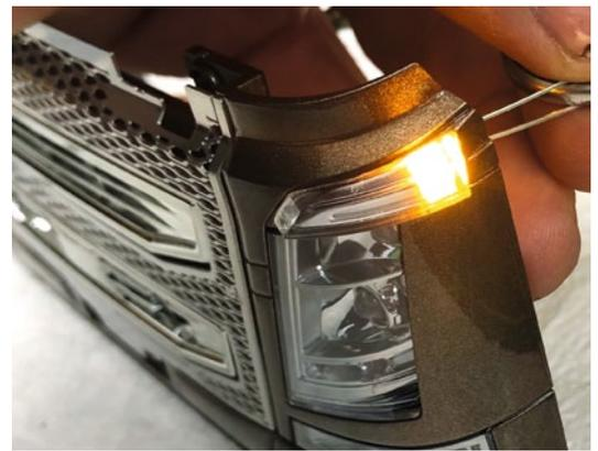
Tamiya sieht von Haus aus keine Funktion der Seitenblinker vor. Mit etwas Aufwand kann man aber diese Funktion nachrüsten. Nachdem man ein zirka 2 Millimeter großes Loch gebohrt hat, kann man eine 1,8-Millimeter-LED platzieren. Das Inlet des Seitenblinkers muss jedoch etwas bearbeitet werden, da die LED ihren Platz fordert. Der erste Funktionstest lässt dann aber Freude aufkommen
