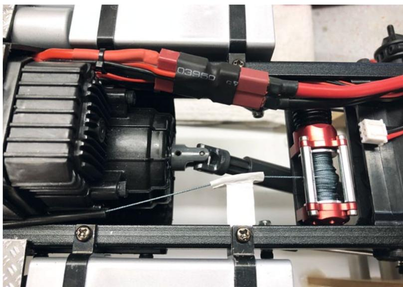
Die Winde ist im Rahmen versteckt. Das Seil wird durch ein Antennenröhrchen nach vorne zum Windenauge geführt. Damit die Winde sich korrekt aufwickelt, wird das Seil über eine selbst gebaute Brücke geführt
