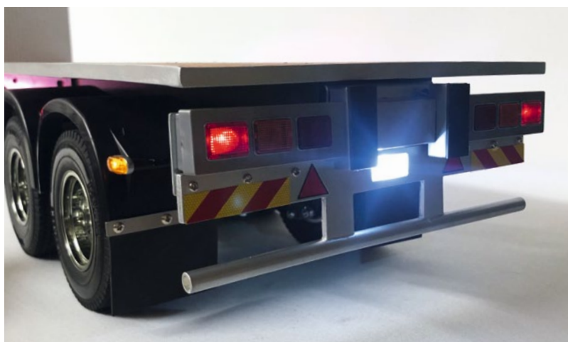
Die Infrarot-Lichtanlage von MM-Modellbau, angeschlossen an die MFC-03 von Tamiya, ermöglicht auch die Funktion des Rückfahrlichts bei Rückwärtsfahrt
