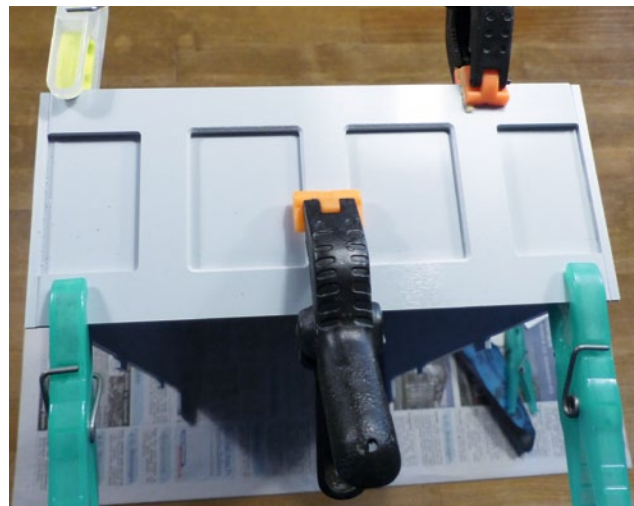
Klammern fixieren die Bauteile beim Kleben
