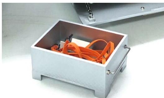
Für die ordnungsgemäße Unterbringung nicht genutzter Spanngurte entstand aus Polystyrol ein Aufbewahrungskasten
