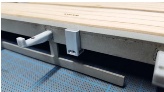
Ausgefahrene Ausleger mit Neodym-Magnet
