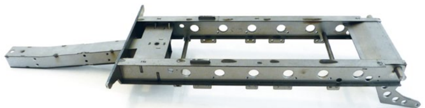
Der lasergeschnittene, geschweißte und CNC-gebogene Metallrahmen ist eine echte Augenweide
