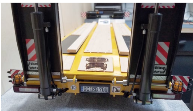
Details am Anhänger wie der im Eigenbau entstandene Kennzeichenträger mit Beleuchtung
