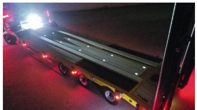
Damit man im Dunkeln alles gut erkennt, erhielt der Tieflader eine Fahrzeug- und Deckbeleuchtung
