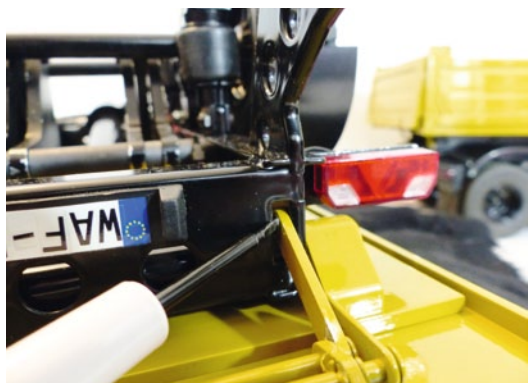
Die Zwangsöffnung der Heckklappe lässt sich am besten zusammenbauen, wenn das Modell auf dem Kopf liegt
