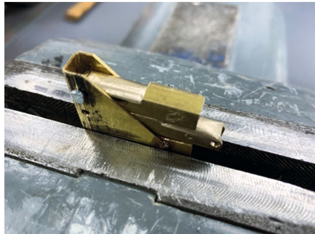
Prototyp der beweglichen Rungen. Über ein Langloch lässt sich die Runge aufstellen und verriegeln
