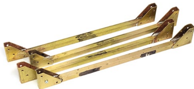
Die vier benötigten Holz-schemel im Rohbau. Der Grundträger besteht aus einem 6 x 6 x 1-Millimeter-U-Messing
