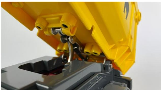
Der Auflieger kann die Mulde elektronisch auf- und abfahren. Dabei wird die Heckklappe automatisch beim Hochfahren entriegelt, sodass die transportierten Materialien ausgeschüttet werden können
