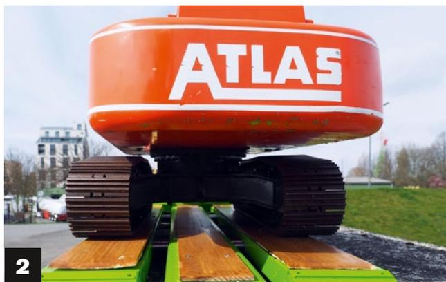
1) Am Dolly sind auch zwei Unterlegkeile vorhanden. 2) Die Ketten des Baggers stehen etwas über. Die Seitenteile können aber noch weiter ausgefahren werden
