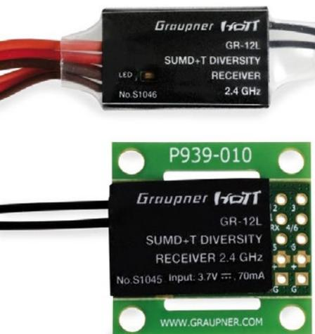
Der Graupner-Empfänger GR-12L arbeitet mit der HoTT-2,4-Gigahertz-Technologie, die bis zu 75 Kanäle verwendet. Das soll nach Herstellerangaben für Betriebssicherheit und Unempfindlichkeit gegen externe Störeinflüsse sorgen. Ohne zusätzliche Sensorik werden Empfängerspannung, Temperatur und Signalstärke übermittelt. Failsafe und Hold sind programmierbar. Der kleine und leichte
