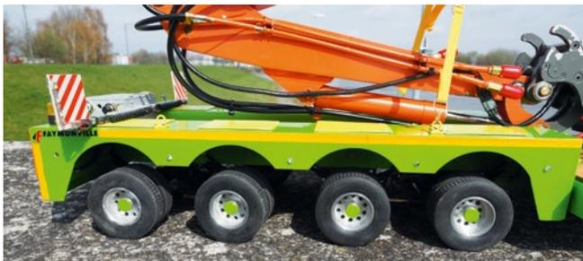
Der abgelegte Ausleger in der Baggermulde mit zusätzlicher Ladungssicherung
