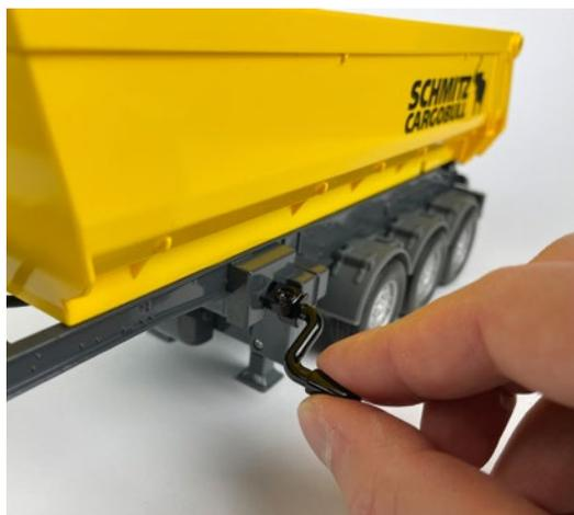
Die ausfahrbaren Stützen, die unter dem Auflieger montiert sind, lassen sich über eine Handkurbel manuell ausfahren
