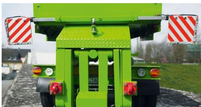
Die Warntafeln mit Halterohr an der Pritsche. Auf dem Riffelblech ist die Kupplung für den Dolly angebracht
