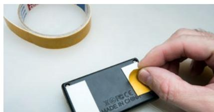
Mit Spiegelklebeband wird der LiPo-Checker auf der Senderrückseite befestigt
