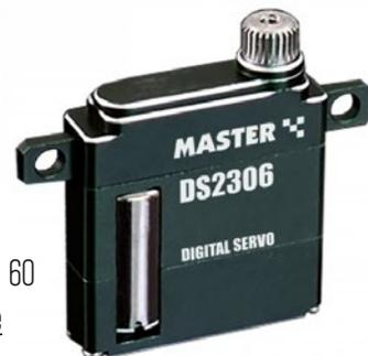
Master DS2306 heißt das neueste Mini-Servo aus dem Hause Pichler Modellbau. Das kleine Digital servo kostet 49,95 Euro, hat ein Alugehäuse und ein Metallgetriebe. Durch die schmalen Abmessungen von 6 Millimeter Breite und 25 Millimeter Höhe ist es laut Hersteller gut für F3K-Modelle geeignet. Es wiegt 9 Gramm. Die Betriebsspannung wird mit 3,7 bis 8,4 Volt angegeben, die Stellkraft liegt bei 2,7 Kilogramm.
