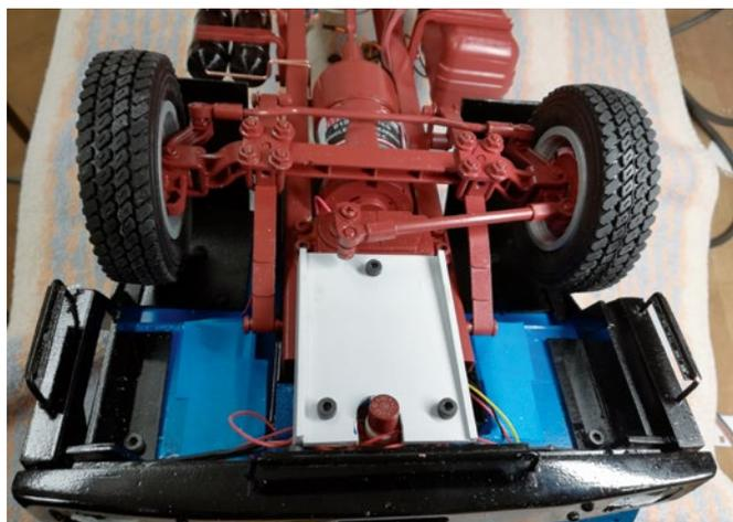
Die Vorwiderstandsplatine erhielt eine Schutzabdeckung, die genau an der Stelle sitzt, an der das Modell gerne hochgenommen wird
