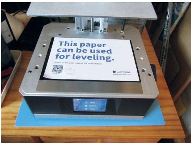
Mit Hilfe eines Blatt Papiers wird das „Leveling“ der Z-Achse nach Anleitung durchgeführt
