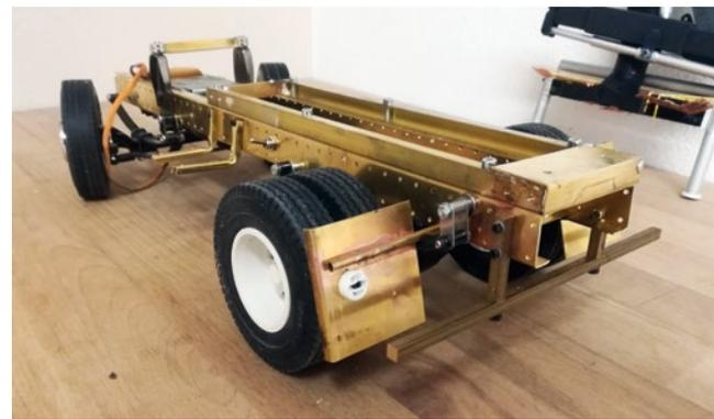
Rahmen und Hilfsrahmen im Probeaufbau
