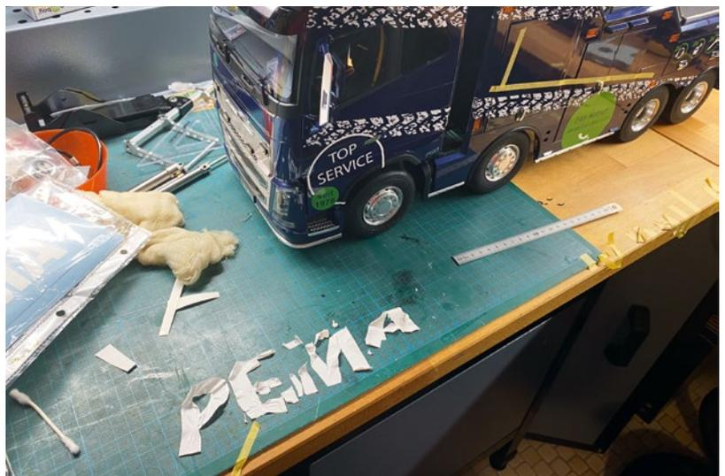
Das Entfernen von Aufklebern ist immer eine etwas heikle Angelegenheit, zum Glück funktionierte es ohne Beschädigungen der Oberfläche
