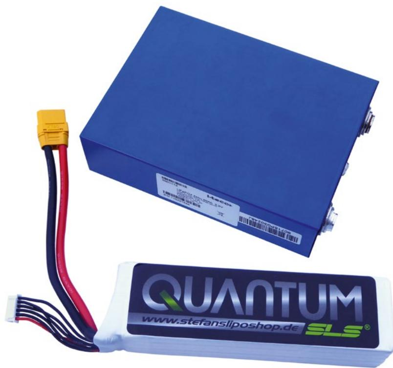
Prismatische LiFe-PO4-Zellen eignen sich gut, um daraus mobile Versorgungsakkus zu erstellen. Beim Größenvergleich zeigen sich die relativ geringen Abmessungen einer LiFe-PO4-Zelle mit einem 6s-LiPo
