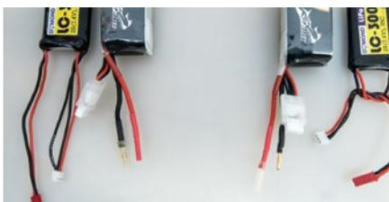
Leerer und voller Akku sind durch aufgesteckte Schlauchstücke markiert
