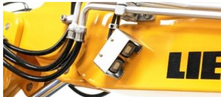
Die Doppelscheinwerfer für Baumaschinen von Premacon kommen bei allen hauseigenen Modellen zum Einsatz. Die Scheinwerfer sind als Fertigmodelle oder als Bausatz ab 45,- Euro erhältlich. Die neue Variante verfügt über einen integrierten Vorwiderstand und kann mit 6 bis 12 Volt betrieben werden. Die Scheinwerfer sind am Edelstahl-Rahmen befestigt und einzeln ausrichtbar.
