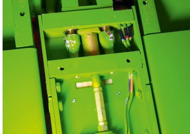
Die Verriegelung des Schwanhalses wird von der Welle des Servos direkt angetrieben
