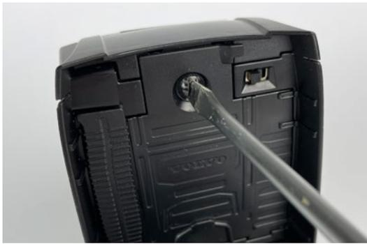
Verriegelt wird das Batteriefach mit einer Schraube, die man mit einem größeren Schraubendreher herausdrehen kann
