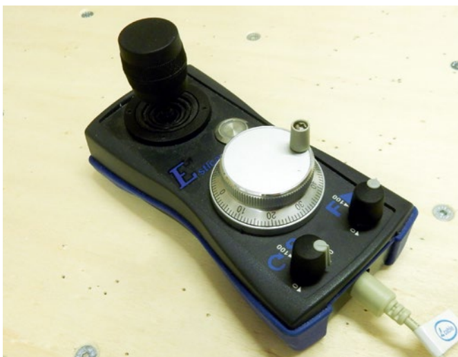
Sehr hilfreich bei allen Arbeiten an der Maschine ist das Handrad, das alle drei Achsen auf einmal in unterschiedlichen Geschwindigkeiten ansteuern kann
