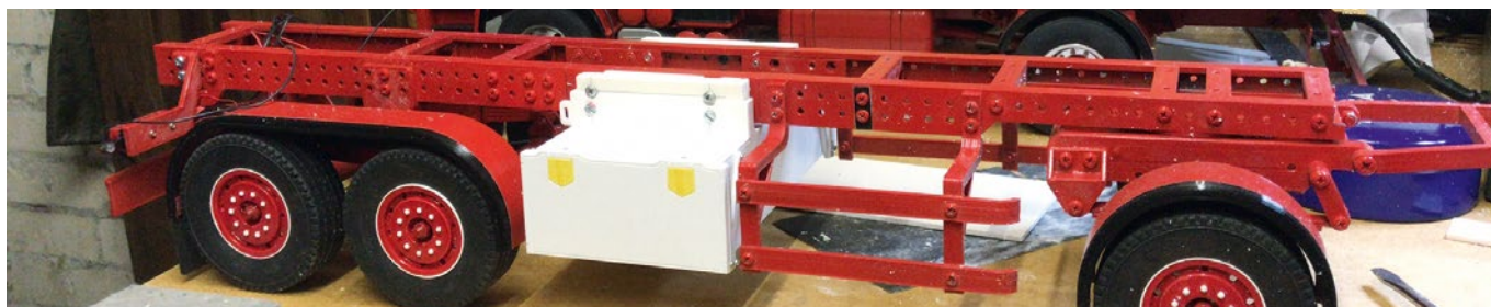
Um möglichst viele Elektronikkomponenten verstecken zu können, wurde im Hänger-Fahrgestell ein Palettenkasten verbaut
