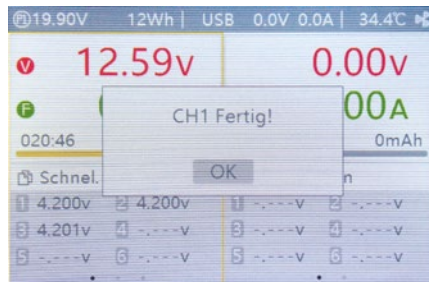
Der Ladevorgang ist beendet, der Akku voll aufgeladen und gut balanciert
