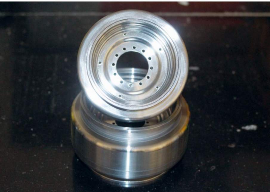
Die massiven Felgen und dicken Reifen tragen wesentlich zum Gesamtgewichts des Modells bei und verleihen dem Fendt einen niedrigen Schwerpunkt und somit viel Stabilität im Gelände
