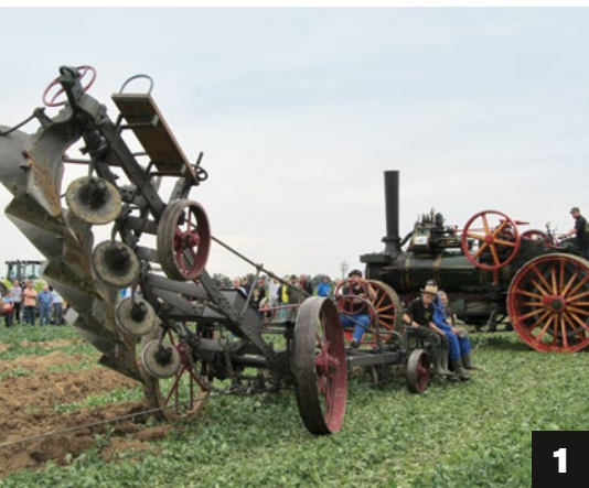
1) So wird der Kipp-Pflug zwischen zwei Lokomobilen hin- und hergezogen. 2) Manches glänzt auch mal an dem rußigen Ungetüm. 3) Mittels Seilwinde wird der Pflug über den Acker gezogen
