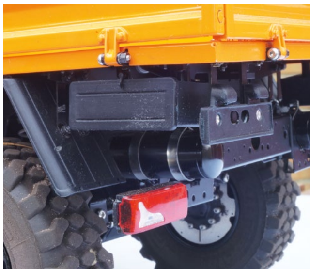
Schöne Details am Heck: Werkzeugkasten, Luftkessel und Nummernschildträger mit Kennzeichenbeleuchtung
