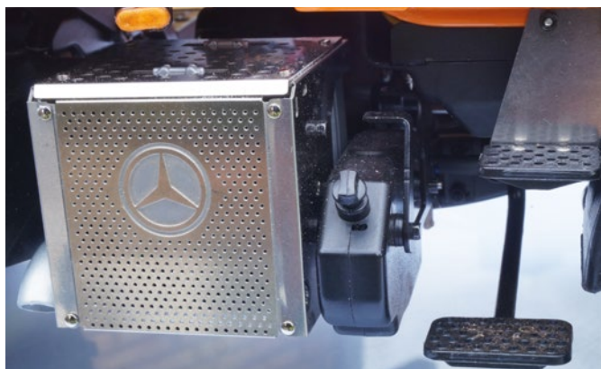
Neben dem Auspufftopf, der den Lautsprecher für den Motorsound verbirgt, sieht man den Ad-Blue-Tank; Durch Drücken des Tankdeckels schaltet man den Unimog ein und aus
