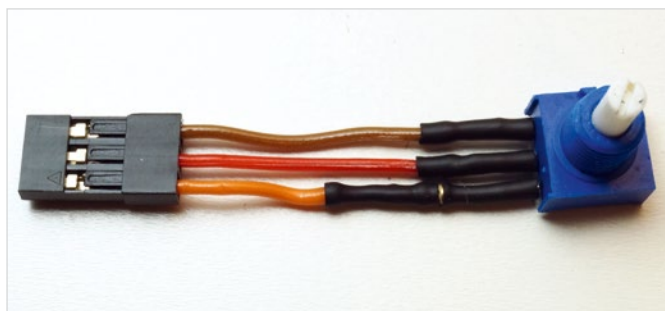
Das auf insgesamt 50 Millimeter eingekürzte Kabel mit dem Lautstärkepoti des SM3; In die orange Leitung wird nach Anleitung ein Widerstand zur Anpassung eingelötet
