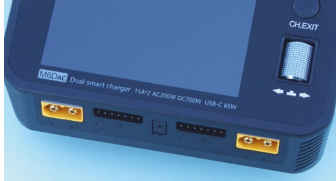
Für jeden Ausgang gibt es einen XT60- und einen Multi-Balancer-Port nach EH- und XH-Norm sowie einen Anschluss für einen Temperatursensor
