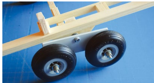
Die Pendelachse ist relativ simpel konstruiert und arbeitet doch sehr effektiv
