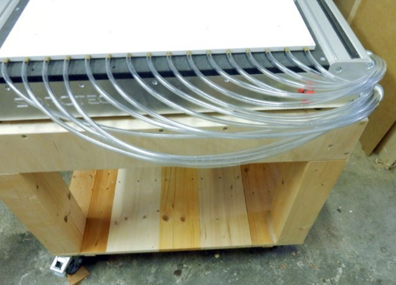
Insgesamt 16 PVC-Schläuche verbinden die Labyrinthplatte auf jeder Seite
