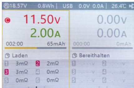
Zur Anzeige gehört auch die präzise Angabe der Innenwiderstände der Zellen
