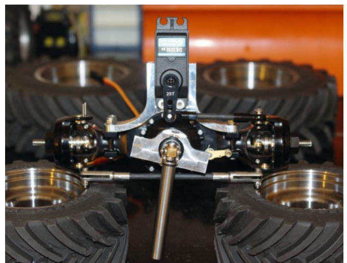
Die Achsen kommen vormontiert und alle beweglichen Teile sind mit Kugellagern ausgestattet
