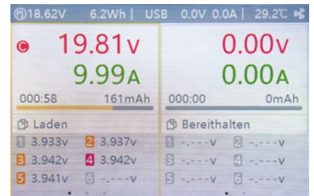
Farbige Markierungen der Zellennummern zeigen die Balancer-Aktivitäten
