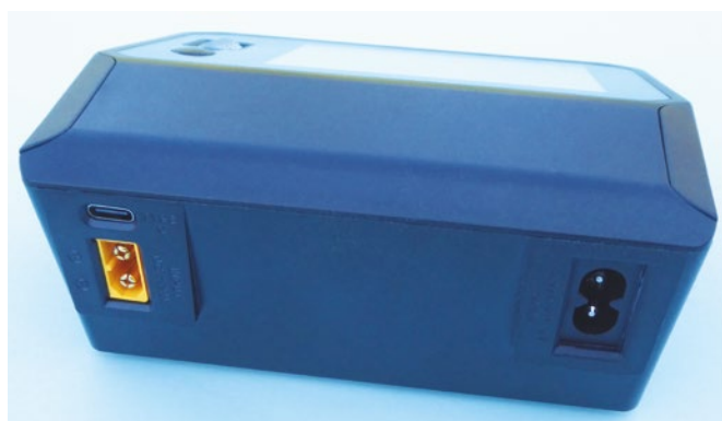
Rückseitig befinden sich die Anschlüsse für die Eingangsspannungen sowie der USB-C-Port
