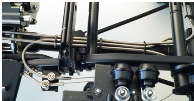
Die Bowdenzughüllen zur Hinterachse lassen sich ordentlich und fest in den Führungen auf dem Schubrohr fixieren
