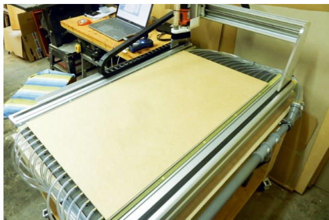
Jetzt noch die MDF-Platte aufgelegt und der Vakuumtisch ist betriebsbereit
