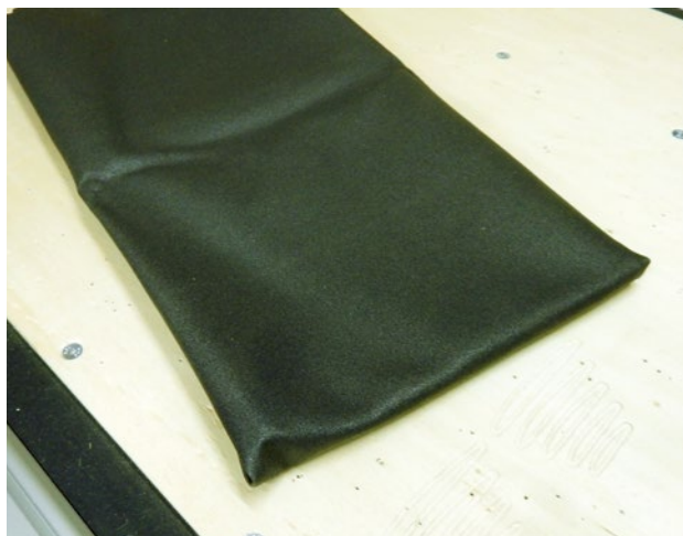
Das Vakuumvlies ist sehr rutschfest und eignet sich hervorragend als Opfermaterial für kleine Frästeile
