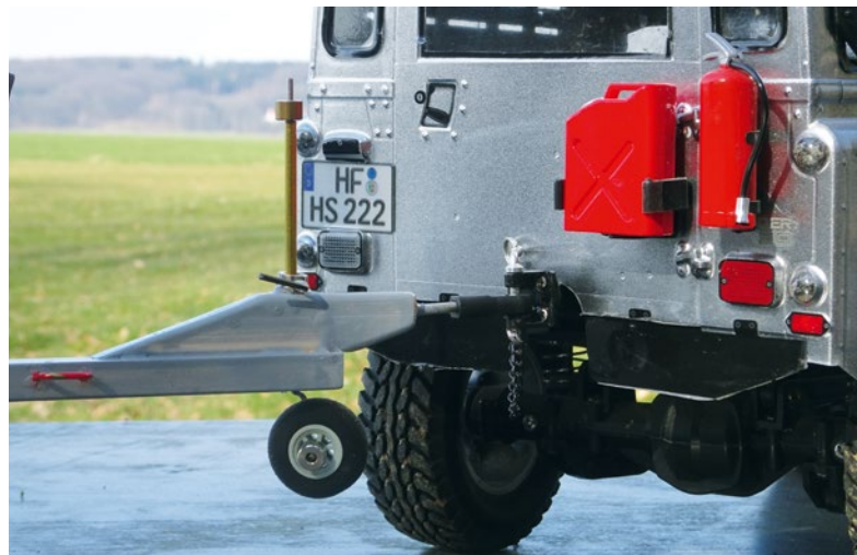
Mit hochgezogenem Stützrad und eingehängter Kupplung kann es auf Tour gehen
