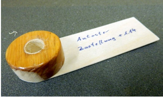
Das Abnullen der Z-Achse erfolgt mit diesem selbst gebauten Helferlein
