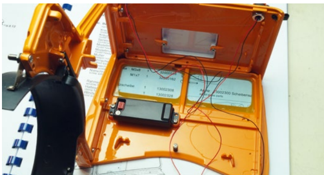
Die Bluetooth-Antenne wird an der Fahrerhausrückwand angeschraubt und ist von dort mit einem Flachkabel mit der Auswerteeinheit unter dem Boden verbunden
