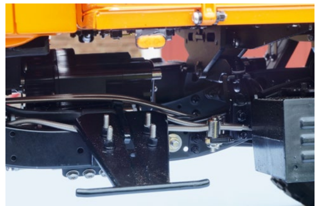
Bei abmontiertem Reserverad sieht man die Befestigung der festen Pritsche
