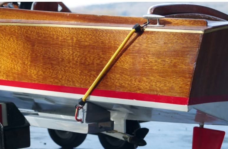
Spanngummis fixieren das Boot sicher auf dem Trailer
