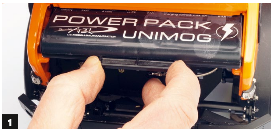
1) Unter der Motorhaube sitzt der Fahrakku, den man zum Laden leicht herausziehen kann. 2) Über eine SD-Speicherkarte lässt sich die Konfigurationsdatei mit allen Einstellungen auf den Unimog übertragen und erspart das aufwändige Einstellen der vielen Servos
