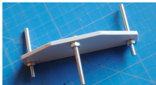
Die Pendelplatten, an denen die Räder aufgehängt sind, sind eigentlich sehr einfach zu bauen
