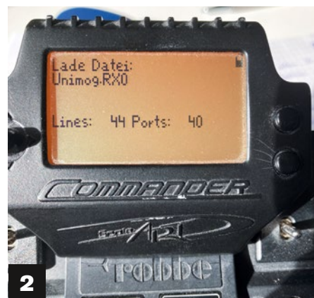
1) Unter der Motorhaube sitzt der Fahrakku, den man zum Laden leicht herausziehen kann. 2) Über eine SD-Speicherkarte lässt sich die Konfigurationsdatei mit allen Einstellungen auf den Unimog übertragen und erspart das aufwändige Einstellen der vielen Servos
