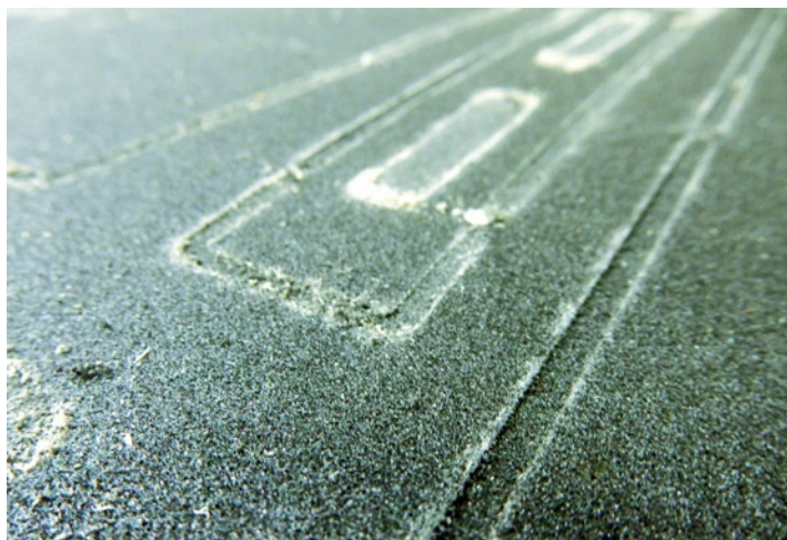
Die Fräsbahnen im Opfermaterial. Für ein sauberes Ergebnis sollte man die Fräse etwa 0,3 mm unterhalb des Werkstücks hervorstehen lassen
