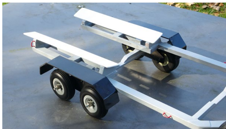
Bei den hinteren Bootsauflagen fehlt noch die Moosgummilage, um den Bootsrumpf zu schützen und etwas zu fixieren
