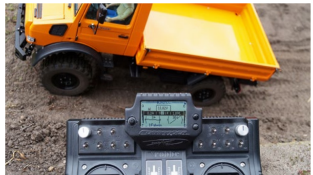
Das Inclinometer in der Commander Basic zeigt die Steigung über den im CM-5000 verbauten Neigungssensor an
