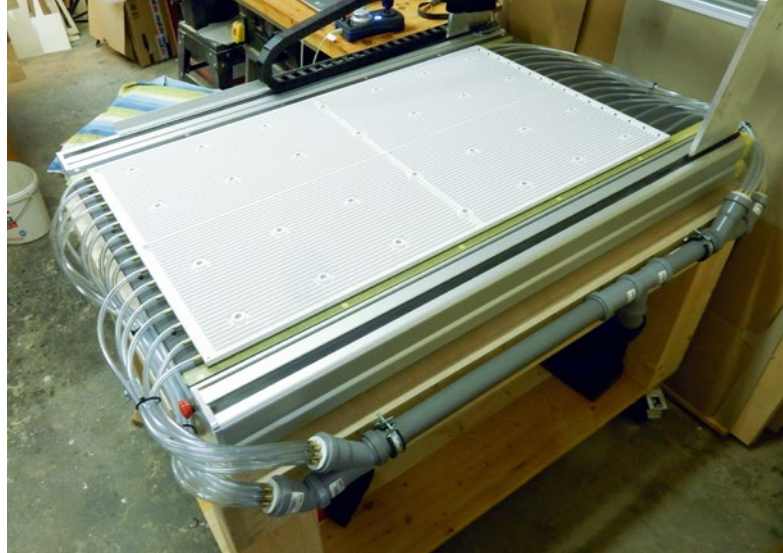
Die Schläuche werden auf beiden Seiten sauber zusammengeführt
