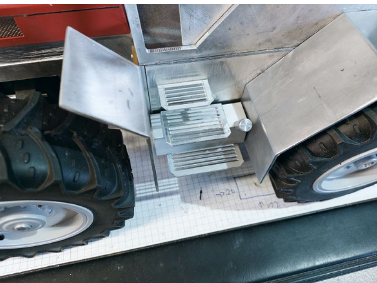
Alu hier, Alu da, Alu überall. Auch beim Bau der Trittstufen war feine Schneid- und Fräsarbeit angesagt
