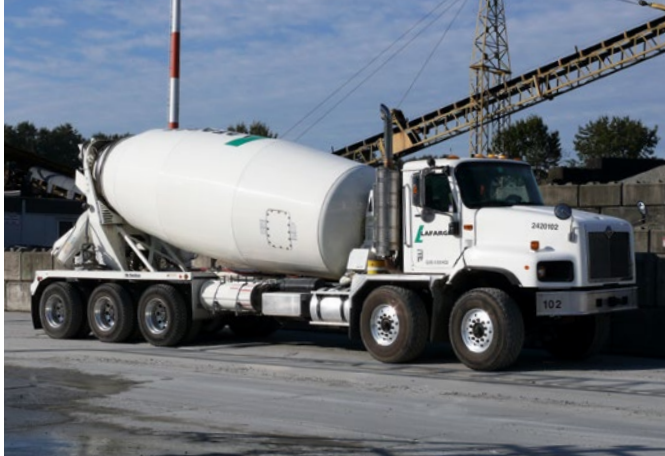
Die fünfachsiges Fahrzeuge mit ihrem großen Radstand sind beeindruckend. Bei dem Dreiachsaggregat handelt es sich zumeist um „threedrives“ – alle drei Achsen sind angetrieben
