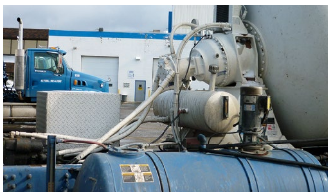
Der hydraulische Antrieb der Trommel mit Ölkühler und Ausgleichbehälter. Zwischen dem Hydraulikmotor und der Trommel liegt scheinbar noch ein Planetengetriebe
