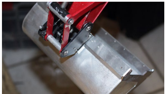
Nach dem Anbau eines mechanischen Schnellwechslers fehlten nur noch die richtigen Werkzeuge
