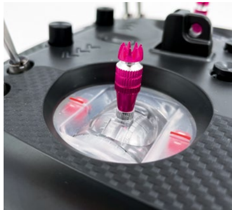
Transparent design sind die beiden kugelgelagerten Knüppelaggregate auf der Frontseite
