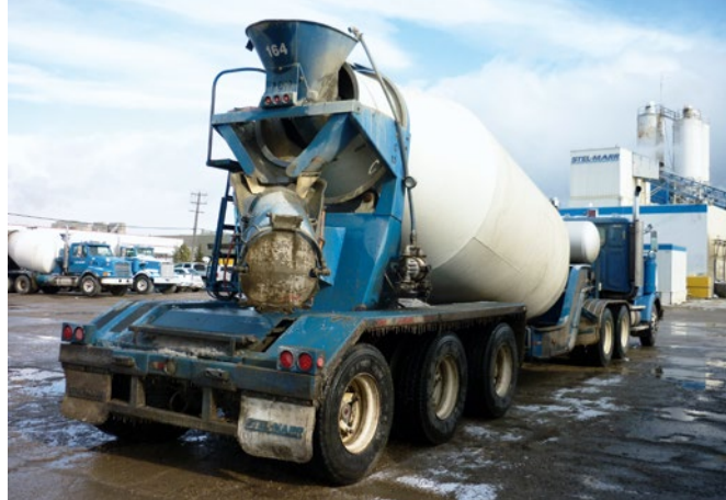
Die vorteilhafte tiefe Schwerpunktlage ist bei den gekrümmten Sattelauflegern gut zu erkennen. Der wichtige Abstand der Achsen ist im Sattel einfacher zu realisieren
