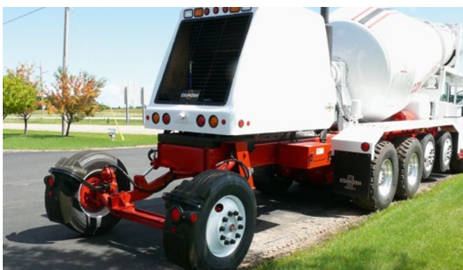
Der Motor sitzt bei den Frontladern im Heck, gefolgt von der Booster-Achse. Der Hydraulikzylinder, der die Achse auf die Fahrbahn drückt und auch nach oben schwenkt, ist gut zu erkennen
