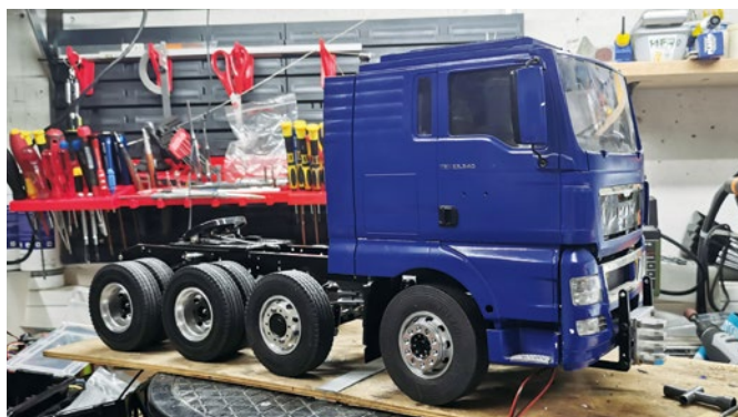
Mittels vorhandener Teile aus der Restekiste wurde das Modell zu einem 8x6/4 mit Zweiganggetriebe umgewandelt
