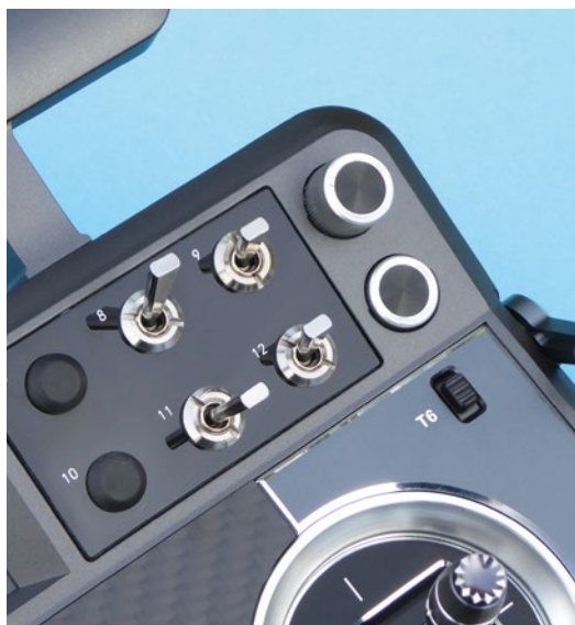
Die Schalterbänke sind mit jeweils vier Schaltern bestückt, die Drehgeber lassen sich versenken
