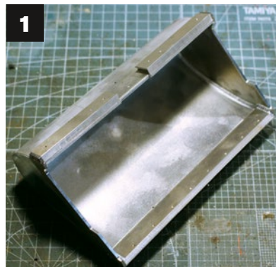
1) 170 mm breit ist die neue zahnlose Aluminiumschaufel für den 330D. 2) Der Ripper soll den Boden auflockern, wenn der zu hart für die Schaufel ist
