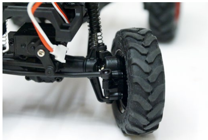
Detailbild der Vorderachse mit den Portal-Radaufnahmen
