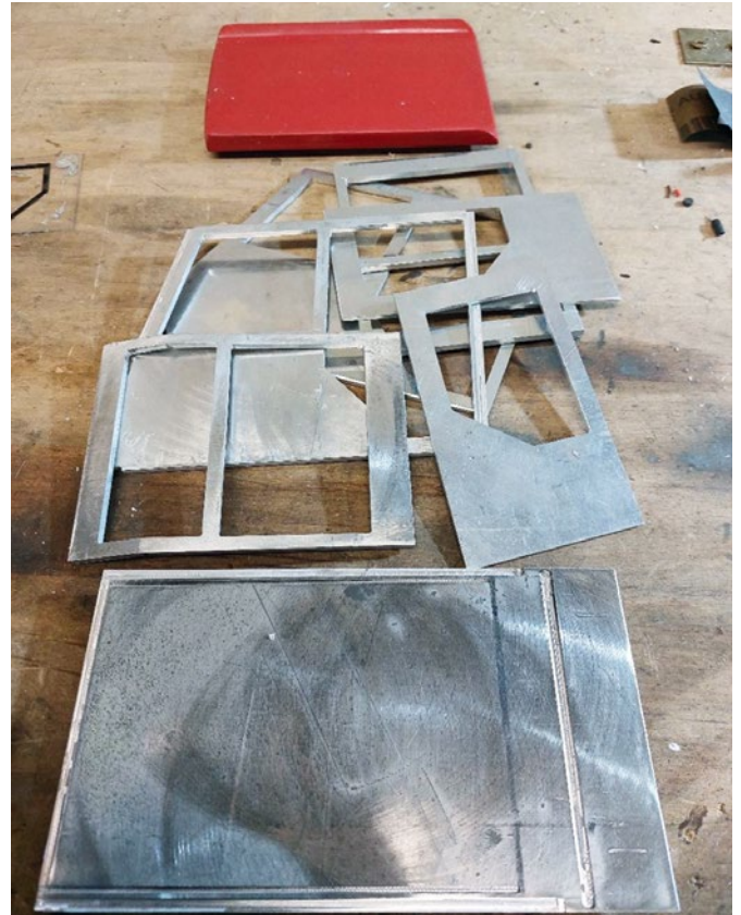
Bei der Einzelteillfertigung für die Kabine wurde auf 3-mm-Alu-Flach-Material zurückgegriffen. Schneiden und Fräsen war die Devise
