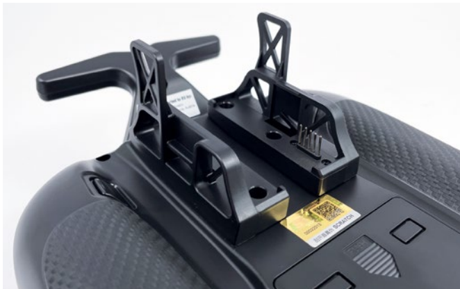
Auf der Rückseite der Einsteigerfunke wird der Halter für das HF-Modul montiert
