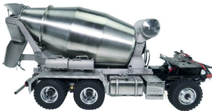
Die Länge des Aufbaus beträgt 434 mm, die Länge des Rahmens zur Fixierung auf dem Fahrgestell 354 mm
