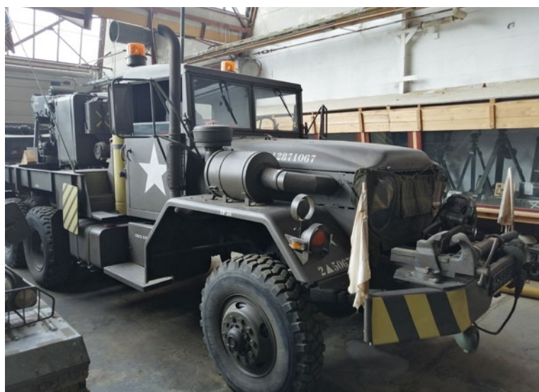
Der Wrecker aus US-amerikanischer Produktion bringt 15,5 t auf die Waage. Bis zu 5.450 kg Nutzland kann er transportieren
