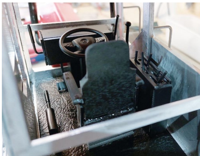
Der Blick ins Innere offenbart alle notwendigen Details. Die Plexiglasfenster sitzen in einem handgemalten Edding-Rahmen
