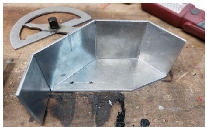
Der Bau der Kotflügel. Hier sollten die Reifen am Ende nicht zu weit herausragen. Dafür wurde das Tiefbett der Felge entsprechend angepasst
