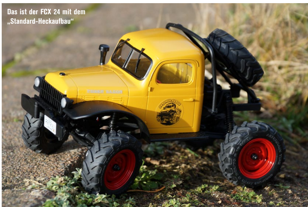
Der FCX 24 hat aufgrund der Portalachsen eine besonders große Bodenfreiheit im Bereich der Achsgehäuse
