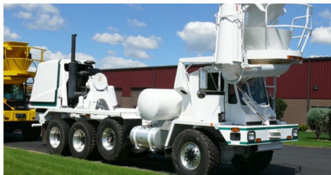
Einige Fahrgestell-details sowie Details der Schütze lassen sich bei diesem Frontlader ohne Mischtrommel erkennen
