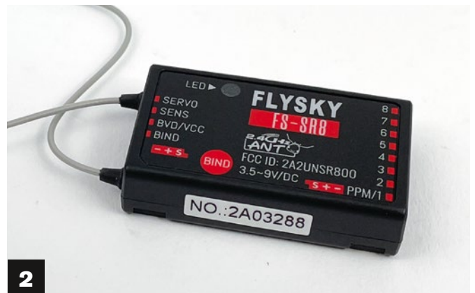
1) Betrieben wird die Fernsteuerung entweder mit vier AA-Batterien oder einem 2s-LiPo-Akku. 2) Im Lieferumfang enthalten ist bei beiden Versionen auch ein FS-SR8-Achtkanalempfänger, was gerade für Einsteiger einen zusätzlichen Anreiz bietet
