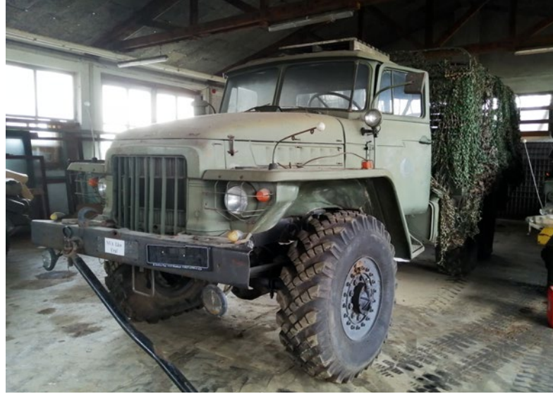
Aus NVA-Beständen: Der Lkw Ural 375 mit V8-Motor, 180 PS Leistung und 5.000 kg Nutzlast
