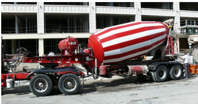
Die Stegbleche bei diesem Sattelaufleger sind im Hals zur Gewichtsreduzierung mit Löchern versehen
