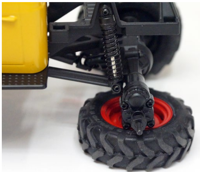
Der FCX 24 hat aufgrund der Portalachsen eine besonders große Bodenfreiheit im Bereich der Achsgehäuse
