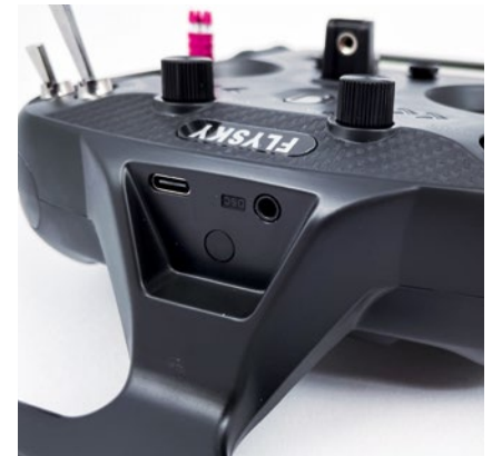
Zwischen einem DSC- und einem USB-C-Anschluss liegt noch eine Öffnung für eine optionale Antenne
