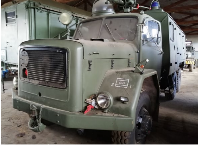
Etwas angestaubt, aber trotzdem sehenswert: das Feuerlösch-Kfz TLF 3800/400 mit 3.800 l fassendem Tank
