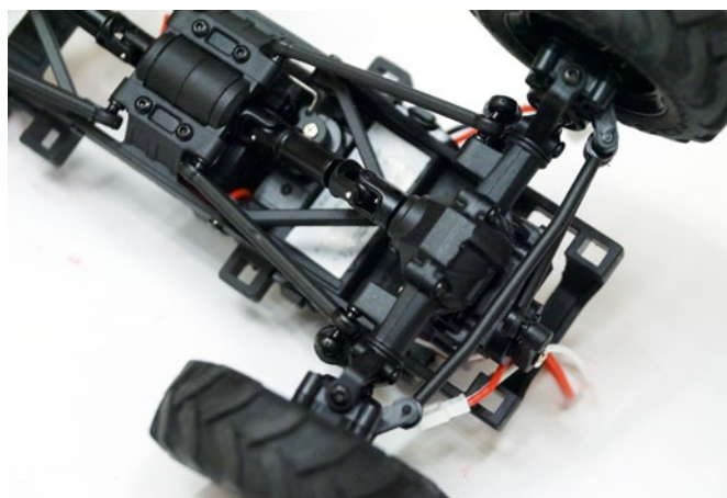
Das Lenkservo sitzt an der Vorderachse und nicht am Rahmen
