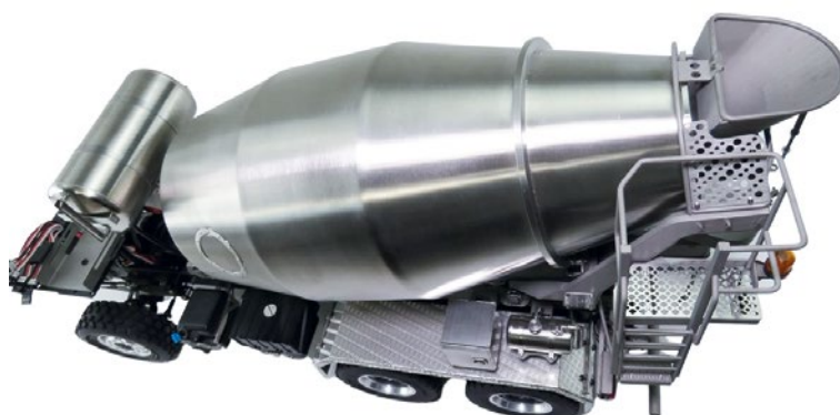
Die Trommel wird per 12-V-Bürstenmotor betrieben und ist kugelgelagert
