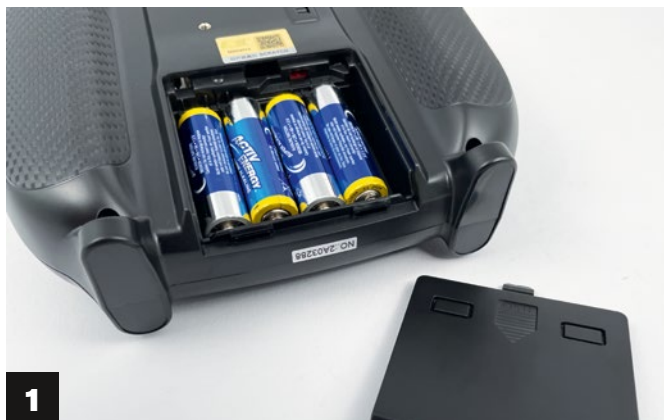
1) Betrieben wird die Fernsteuerung entweder mit vier AA-Batterien oder einem 2s-LiPo-Akku. 2) Im Lieferumfang enthalten ist bei beiden Versionen auch ein FS-SR8-Achtkanalempfänger, was gerade für Einsteiger einen zusätzlichen Anreiz bietet
