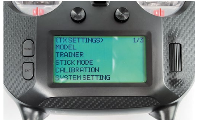
Das LCD-Display mit Hintergrundbeleuchtung misst 128 x 64 mm und liegt unter den beiden Joysticks zum Trimmen
