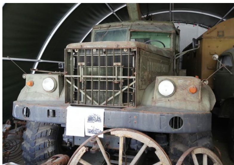
E-305 W. Der Universal-Autobagger aus der ehemaligen UdSSR kam als Stellungsbaugerät zum Einsatz
