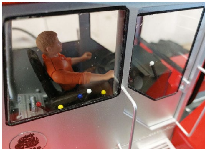
Der Blick ins Innere offenbart alle notwendigen Details. Die Plexiglasfenster sitzen in einem handgemalten Edding-Rahmen
