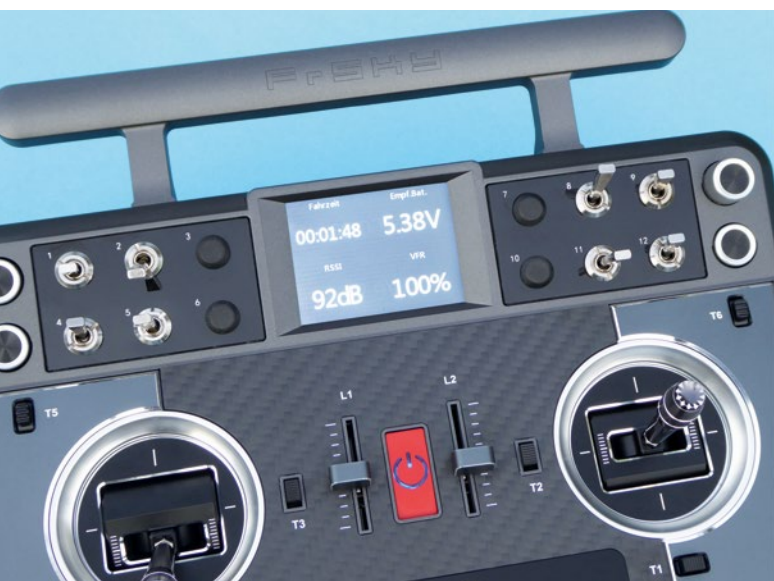
Das obere Display, in dem sich wichtige Daten anzeigen lassen, liegt gut im Blickfeld
