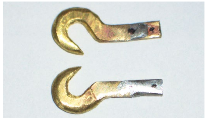
Die Haken wurden aus 2 mm starkem Messingblech gefertigt. Sie werden eingeklebt und mit je zwei M1,5-Stahlschrauben befestigt
