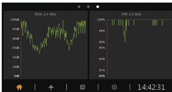
Zur Überprüfung der Funkstrecken lassen sich Liniendiagramme der Kennwerte generieren
