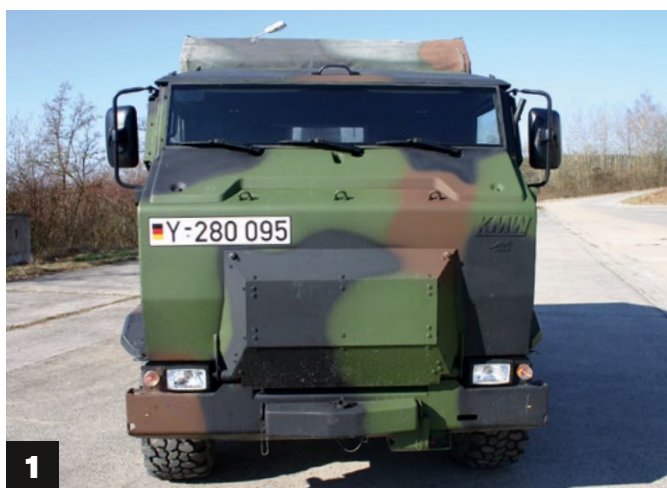
1) Das Einsatzfahrzeug ESK verfügt über ein vollständig gepanzertes Fahrerhaus. Das ebenfalls geschützt eingebaute Triebwerk stellt eine hohe Restmobilität sicher. 2) Auch von hinten erinnert der Mungo eher an einen Schuhkarton auf Rädern
