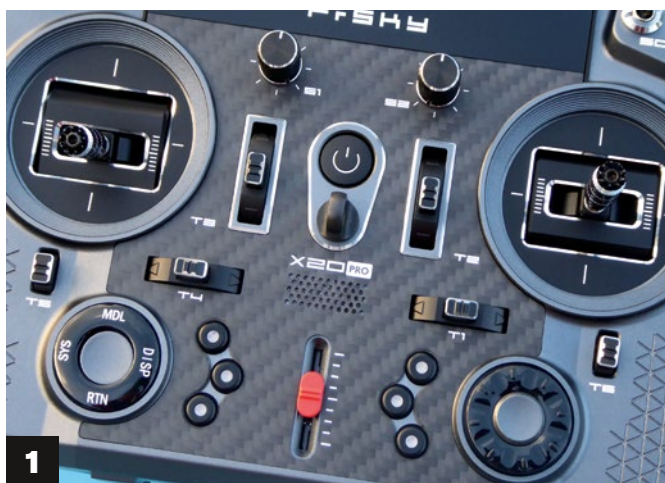
1) Mittig befindet sich der Ein-aus-Schalter, darüber sind zwei Dreh- und seitlich darunter zwei Tastgeber angebracht, unten sind ein Schiebekanal und sechs individuell belegbare Tasten vorhanden. 2) Besser kann man ein Display nicht anordnen, es ist auch bei Sonnenlicht gut ablesbar
