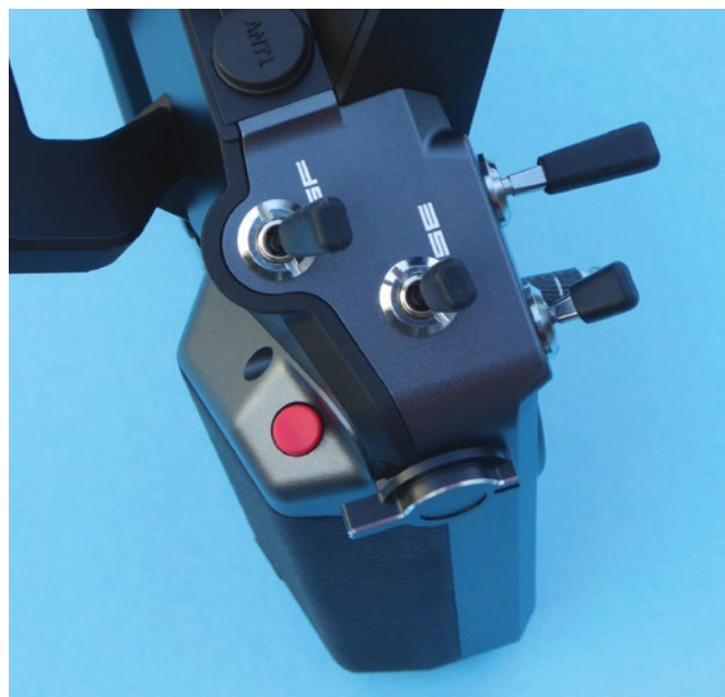
Für die Bedienung stehen beidseitig jeweils zusätzlich vier Schalter und ein Slider sowie ein roter Tastschalter bereit
