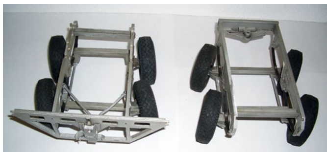
Die beiden Drehgestelle – links das vordere und rechts das hintere – sind aus Alu-Druckguss
