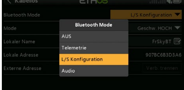
Das eingebaute BT-Modul unterstützt die mit dem Sender möglichen Aktionen
