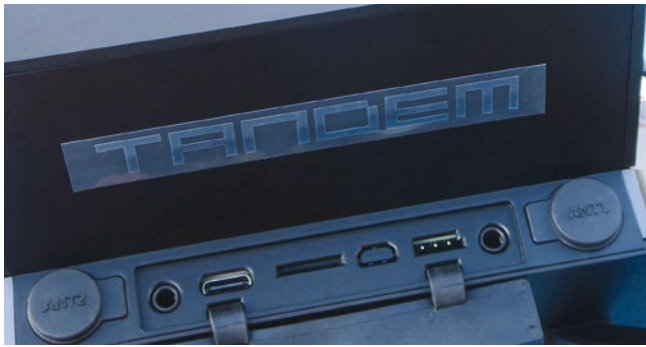
Sämtliche Ports einschließlich eines SD-Karten-Slots sind, durch eine Abdeckung geschützt, gut zugänglich
