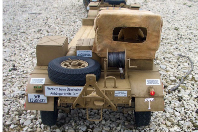
Das Kolonnenlicht (links, mit grüner Beleuchtung) und das Rücklicht (rot) lassen sich einschalten
