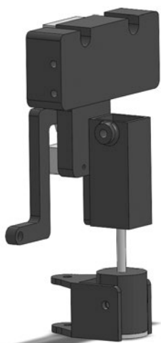
Bild 1: Gewindestück und Feder sorgen für eine funktionierende Liftachse
