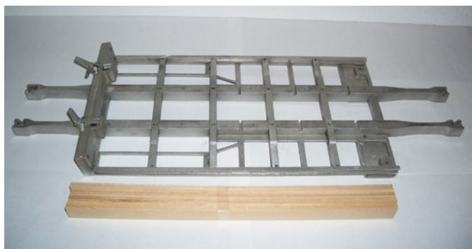
Ebenfalls aus Alu-Druckguss ist das Gerüst der Ladefläche. Die Ladefläche wird aus Eschenholz-Leisten hergestellt
