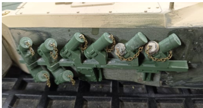
Die Nebelwurfanlage wurde, wie bereits bei meinem Leopard 2A6M, umgebaut. Nahaufnahme der Nebelwurfanlage mit geladenen Nebelgranaten
