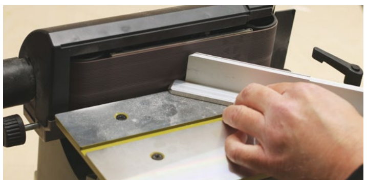
Alu lässt sich genauso gut und mit feinem Schliffbild bearbeiten wie andere Materialien
