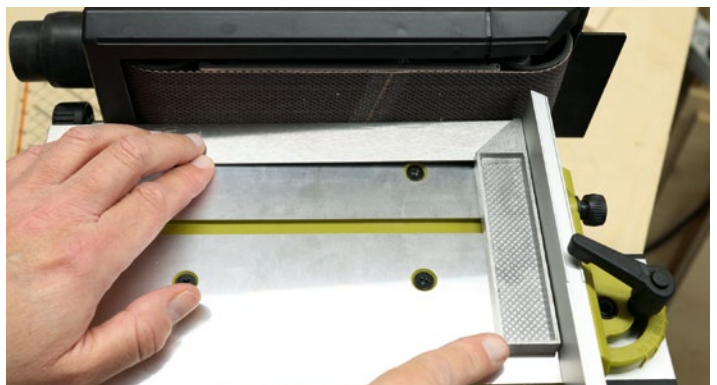
Der Winkelmesser offenbart, dass der auf 90° eingestellte, mitgelieferte Winkelanschlag nicht exakt, sondern um 0,5 bis 1° zu groß ist
