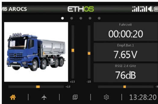
Auf der ersten Seite der Hauptdisplay-Schleife werden wichtigste Betriebsdaten angezeigt
