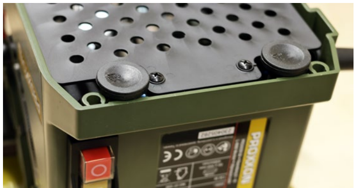
Nicht erfasster Staub kann unten durch die Gehäuseplatte fallen. An vier Punkten lässt sich das sicher stehende Gehäuse zudem mit Schrauben fixieren
