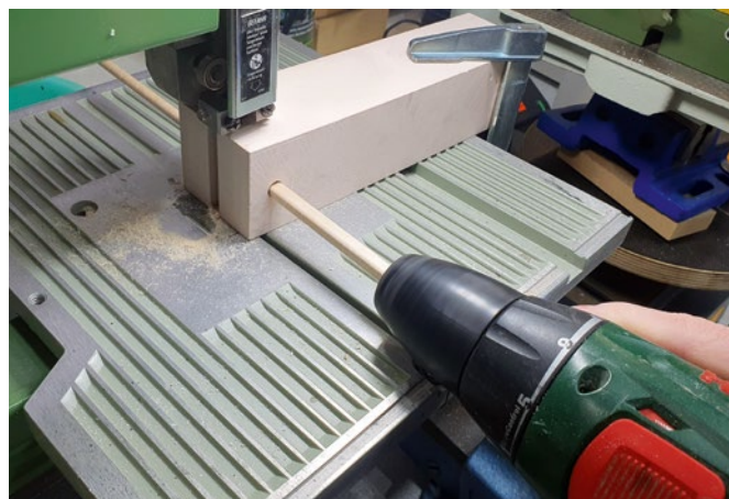
Grundlage des Hilfswerkzeugs ist ein PUR-Hartschaum-Kunststoffblock
