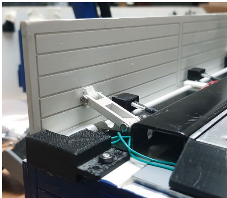
Bild 9: Wird die Welle gedreht, wird die Zwei-Hebel-Mechanik der Klappen nach unten gezogen
