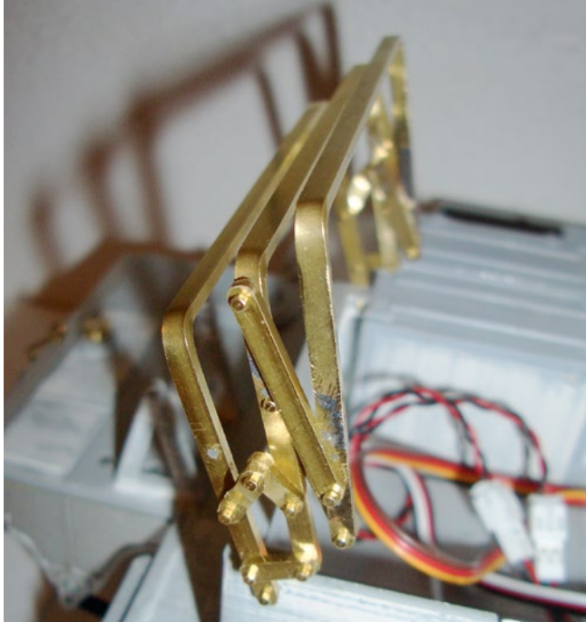
So lässt sich das Gestänge des geplanten, faltbaren Stoffverdecks zusammenklappen
