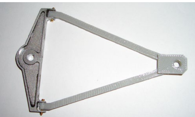
Die Anhängerdeichsel ist am Trapez montiert. Vorher werden die Einzelteile von Kleberresten gesäubert
