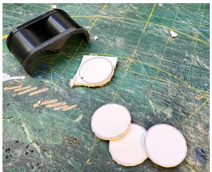
Aus den vorhandenen Luftkesseln entsteht eine neue, schmalere Variante, die seitlich mit ausgeschnittenen Polystyrolplättchen „geschlossen“ werden
