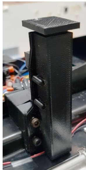
Bild 6: Die Stützen wurden weiter nach außen geschoben, um den Bodenhalterblechen aus dem Weg zu gehen
