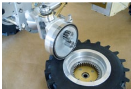
Die geöffnete Vorderradlagerung mit Dünnringkugellager und Innenzahnrad
