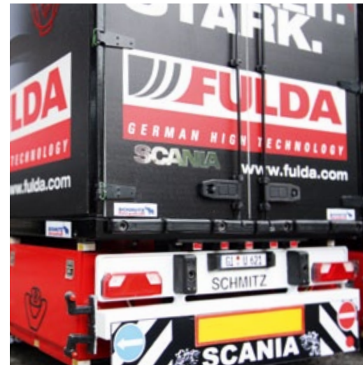
Die Ersatzradhalter beim Tamiya-Original mussten Schwedenkisten von Verkerk Modelbouw weichen, die anschließend rot lackiert wurden
