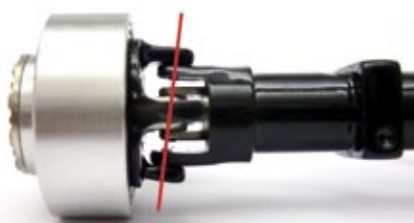
Angetriebene Vorderachse mit optimiertem Sturz von AFV-MODEL
