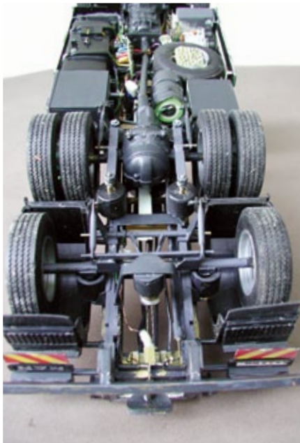
Hier sieht man die Aufhängung der Liftachse und die Anhängerkupplung mit eingebauter Infrarotdiode
