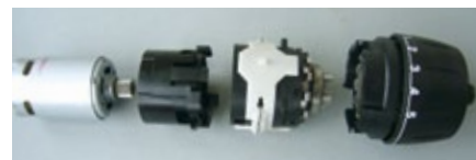
Als Antrieb dient der Motor eines Bosch-Akkuschraubers, den man im Fachhandel bestellen kann
