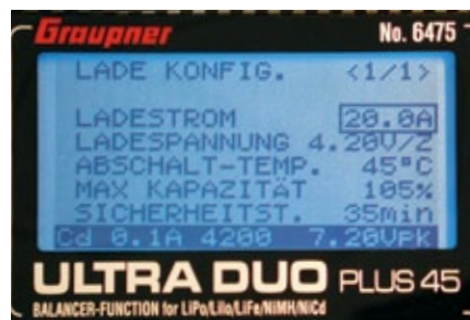
20-A-Ladestrom (im Rahmen von 250/220 Watt) stehen dem kompakten Gerät gut zu Gesicht
