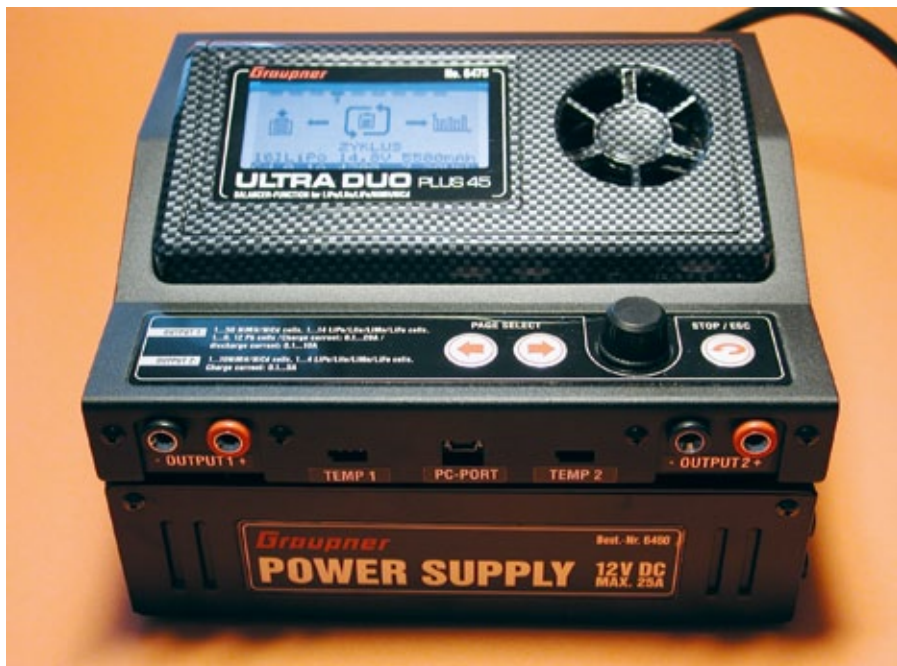
Das Graupner Kompaktnetzteil 12 V/25 A ist perfekt auf das Ultra Duo Plus 45 abgestimmt und bildet eine Einheit
