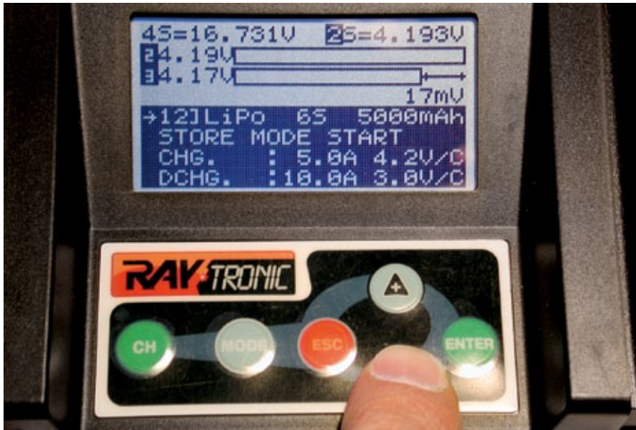
Die Sechs-Knopf-Bedienung ist praktisch und intuitiv zu erfassen. Inversdarstellung des zweiten Ladeausgangs (untere Hälfte)
