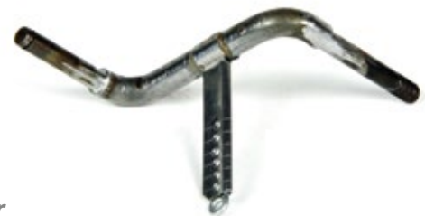
Ein Schwenkarm, der aus Stahlteilen hart gelötet wurde. An diesen werden später die Zinkenräder befestigt
