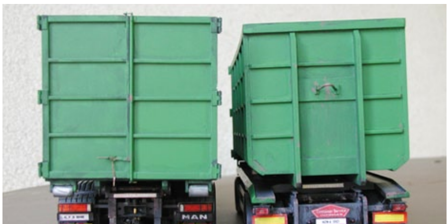
Vergleich: die wechselseitige Verladung der Container bei Zugwagen und Anhängern
