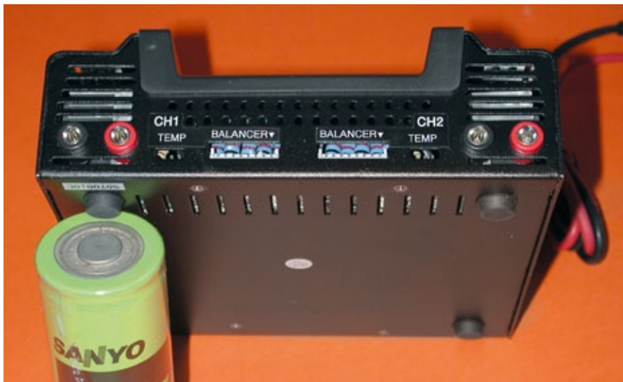
Symmetrisch angeordnete Steckplätze an der Gerätefront. Sichtbar werden auch die Entladewiderstände der Balancer
