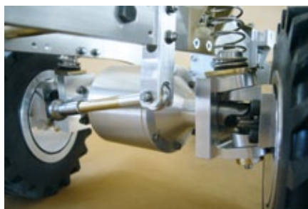
An der Vorderachse ist die Spreizung durch den schräg liegenden Lenkungsbolzen zu erkennen
