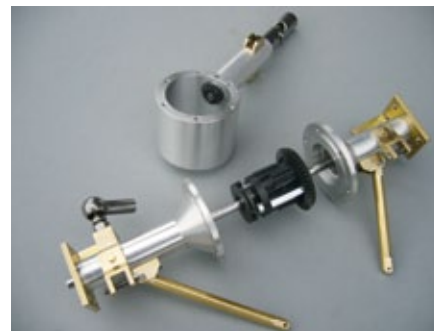
Die Einzelteile der Hinterachse. Die verbauten Stirnraddifferenziale sind eigentlich für den Maßstab 1:12 ausgelegt, passen aber dank der robusten Ausführung auch in den Unimog
