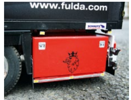
Die Ersatzradhalter beim Tamiya-Original mussten Schwedenkisten von Verkerk Modelbouw weichen, die anschließend rot lackiert wurden
