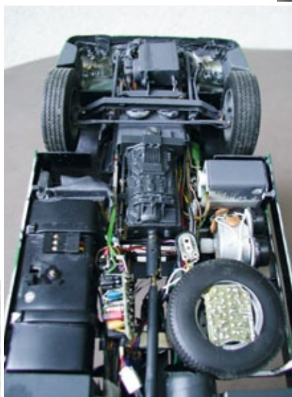
Der Antrieb der Liftachse. Das Heben und Senken geschieht über einen Kleinstgetriebemotor von Conrad
