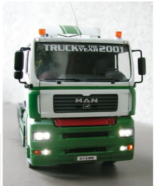
Die fertige Front- und Heckbeleuchtung. Verschiedene Lichtfunktionen wie Nebelscheinwerfer, Abblendlicht, Fernlicht, Drehleuchten, Blinker und Warnblinkanlage sind möglich
