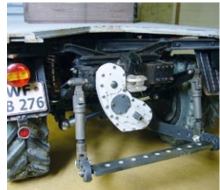
Am Heck sticht das Zapfwellengetriebe sofort ins Auge. Leider ist es noch nicht funktionsfertig, da unter anderem noch weitere Kugellager verbaut werden müssen
