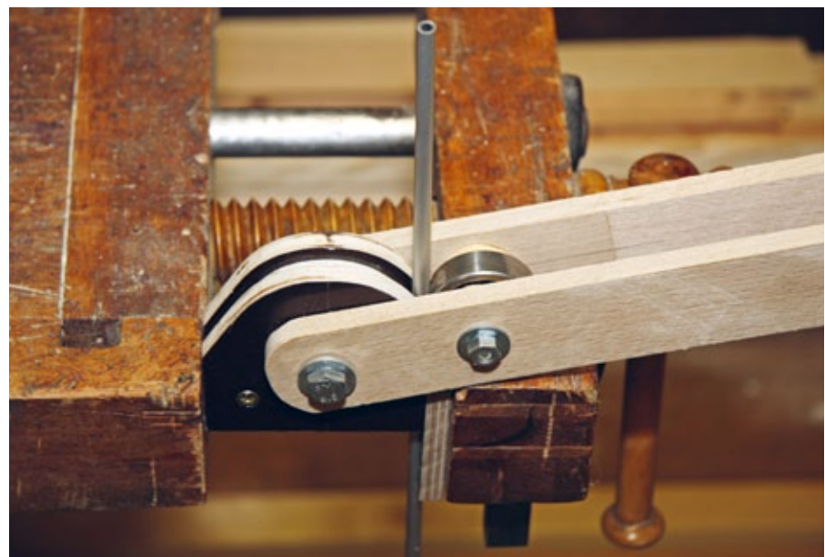
Zum Verbiegen der Aluminiumrohre wurde eine selbst gebaute Biegemaschine aus Holzteilen und einem alten Kugellager verwendet
