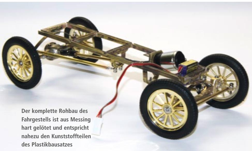
Der komplette Rohbau des Fahrgestells ist aus Messing hart gelötet und entspricht nahezu den Kunststoffteilen des Plastikbausatzes
