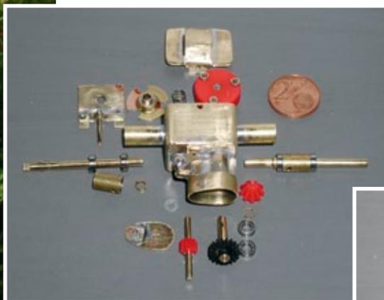
Die Bestandteile des Sperrdifferenzials. Der Rahmen ist aus Messing gefertigt, einzelne Bestandteile stammen aus der Carson X-Mods-Serie
