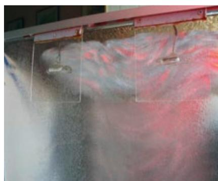
Die Unterbrechungselektronik schaltet immer dann, wenn ein Wasserstrahl auf die Sensoren – Reedkontakte und Magneten – trifft
