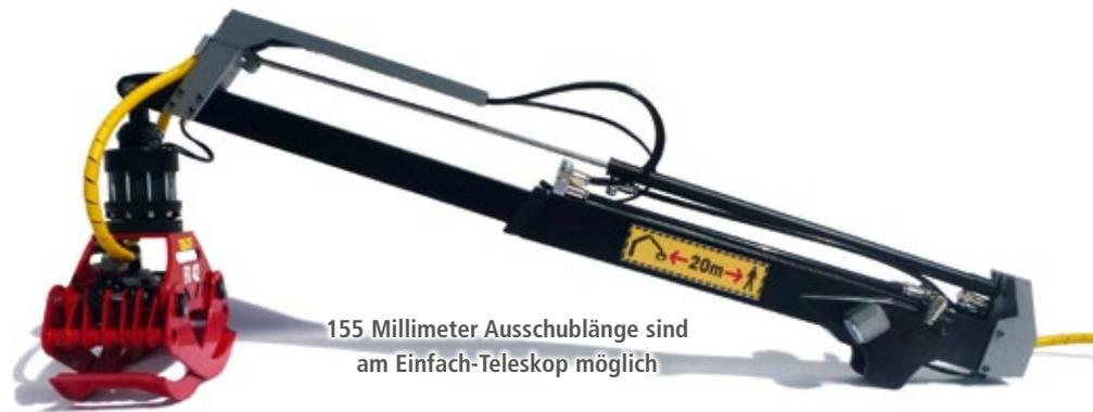
155 Millimeter Ausschublänge sind am Einfach-Teleskop möglich
