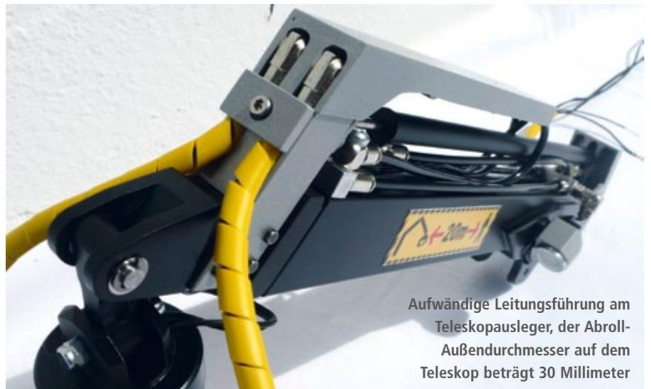
Aufwändige Leitungsführung am Teleskopausleger, der Abroll-Außendurchmesser auf dem Teleskop beträgt 30 Millimeter
