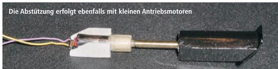
Die Abstützung erfolgt ebenfalls mit kleinen Antriebsmotoren
