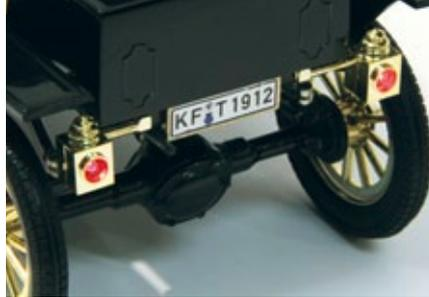
In den Kunststofflampengehäusen wurden Mini-LED untergebracht
