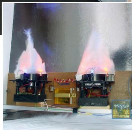
Der Kasten mit den Flammenteilen von hinten mit geöffneter Rückwand. In der Mitte die LED mit der Brandflacker-Elektronik
