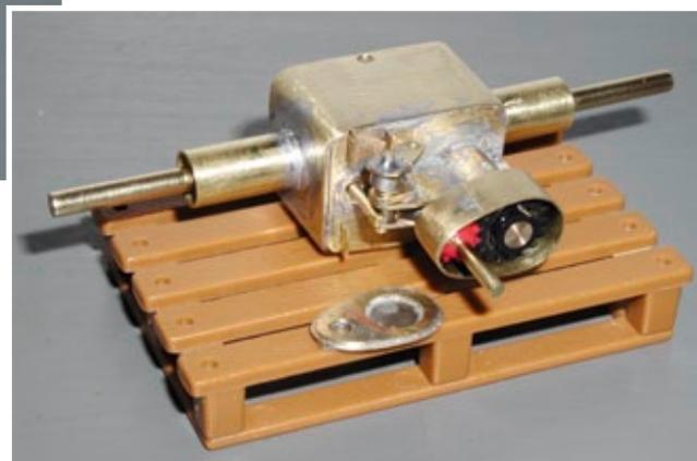
So sieht die fertige Hinterachse aus
