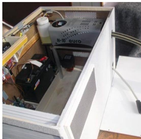
Blick von oben in die Garage: Der 12-Volt-Akku (mittig links) betreibt die Elektronik und die Motoren. Ein 220-Volt-Netzanschluss dient der Nebelmaschine, einem Ladegerät und der Hausbeleuchtung. Rechts der 14-polige Stecker und der Schlauch für den Nebel zum Haus. An der rechten Außenwand ist der Lautsprecher für den „Feuer aus!“-Ruf
