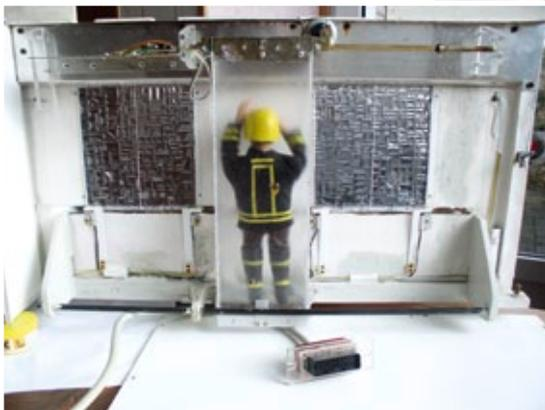
Blick von innen auf die unteren Fenster. Gut zu erkennen sind die Kunststoffhalter rechts und links, die die nur oben aufgehängten Fenster mit leichtem Druck am Rahmen halten. Darunter befinden sich jeweils Reedschalter, die bei minimalem Eindrücken des Fensters die Öffnungsmechanik schalten
