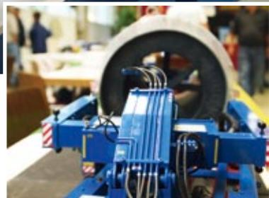
Mit seiner Hubhebel-Kesselbrücke gewann Jürgen Ballreich von der FMT Kurpfalz den ersten Platz im Bereich Funktionsmodellbau. Der originalgetreue Nachbau ist voll funktionsfähig und arbeitet mit einem Hydrauliksystem. Alle Achsen sind einzeln gefedert
