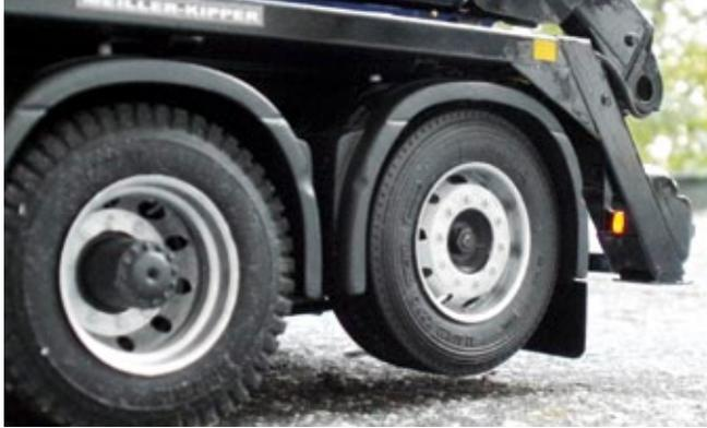
Gelifteter Zustand: der Lenkantrieb der Nachlaufachse abgeschaltet
