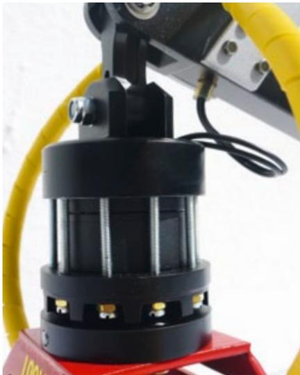
Der Rotator ist durch ein Pendelgelenk mit dem Teleskopauschub verbunden
