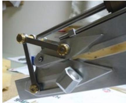
Die Schubstangen zwischen Haupt- und Teleskopausleger wurden aus Edelstahl filigran herausgearbeitet
