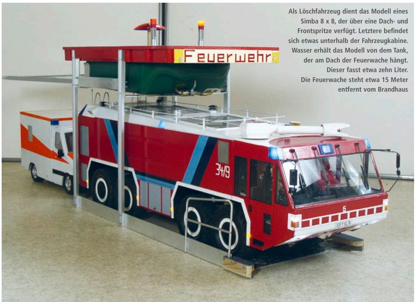
Als Löschfahrzeug dient das Modell eines Simba 8 x 8, der über eine Dach- und Frontspritze verfügt. Letztere befindet sich etwas unterhalb der Fahrzeugkabine. Wasser erhält das Modell von dem Tank, der am Dach der Feuerwache hängt. Dieser fasst etwa zehn Liter. Die Feuerwache steht etwa 15 Meter entfernt vom Brandhaus
