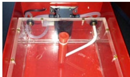
Das Herzstück des Feuerwehrfahrzeugs: Der Wassertank mit dem Ansaugstutzen der Pumpeneinheit
