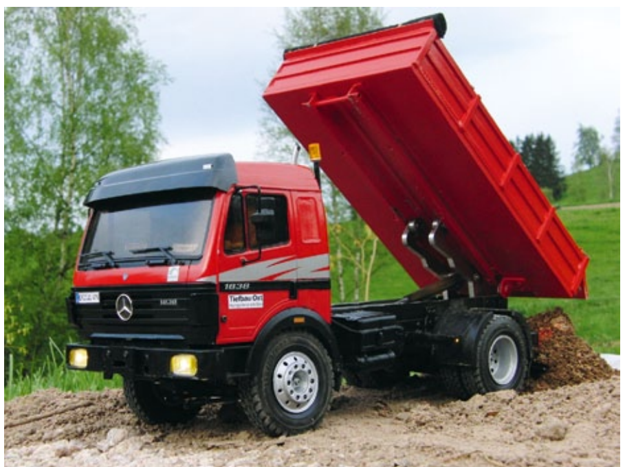
Der Kipper ist als reiner Hinterkipper ausgeführt
