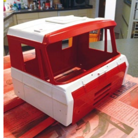
Die Lackierung des Fahrerhauses. Die weißen Streifen wurden durch Abkleben der nicht zu lackierenden Stellen erreicht
