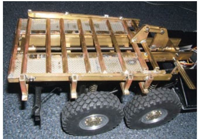
Über einen Spindelantrieb wird die Rampe bewegt und kann ferngesteuert bedient werden
