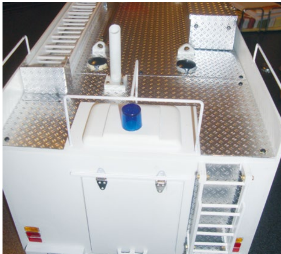
Anbringen des Alu-Riffelblechs mit sogenanntem Reiskornmuster auf dem Tankaufbau
