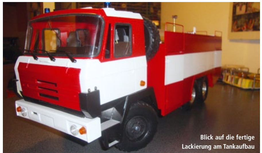
Die Lackierung des Fahrerhauses. Die weißen Streifen wurden durch Abkleben der nicht zu lackierenden Stellen erreicht
