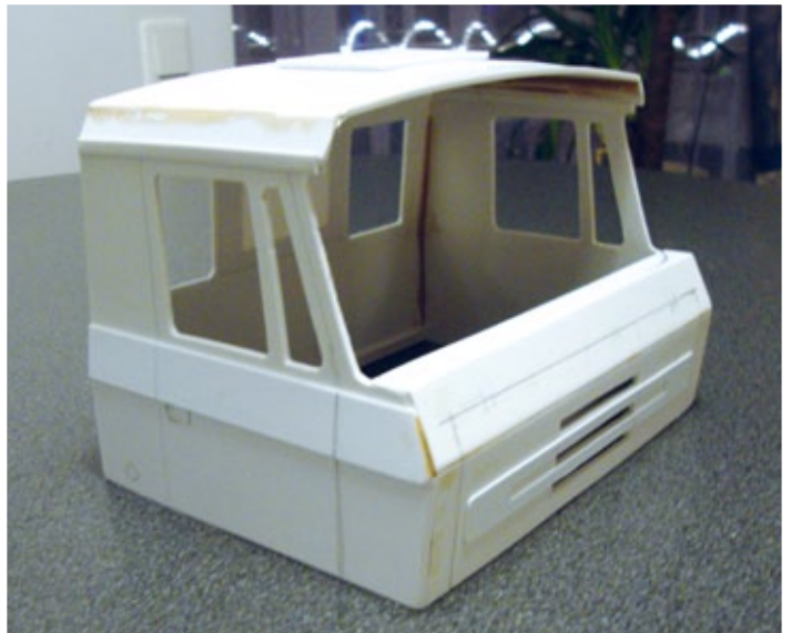
Der Grundkörper vom späteren Fahrerhaus. Zum Einsatz kamen hier Polystyrol- und ABS-Platten
