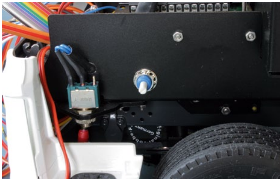
An alles gedacht: Aufnahme für den Hauptschalter und Bohrung für den Lautstärkereger des SMX-Soundmoduls
