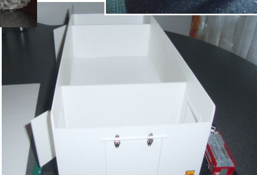
Das Dreikammer-System im Tankaufbau. In die mittlere Kammer kommt Löschwasser, während die vordere und die hintere Kammer für Servos beziehungsweise Elektronik vorgesehen sind
