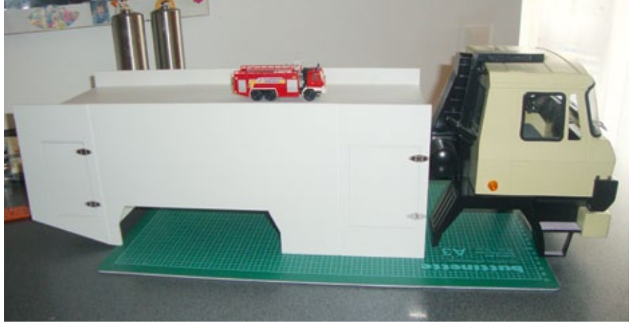
Rohmodell des Tankaufbaus: Die Grundform wird über 3-Millimeter-ABS-Platten realisiert
