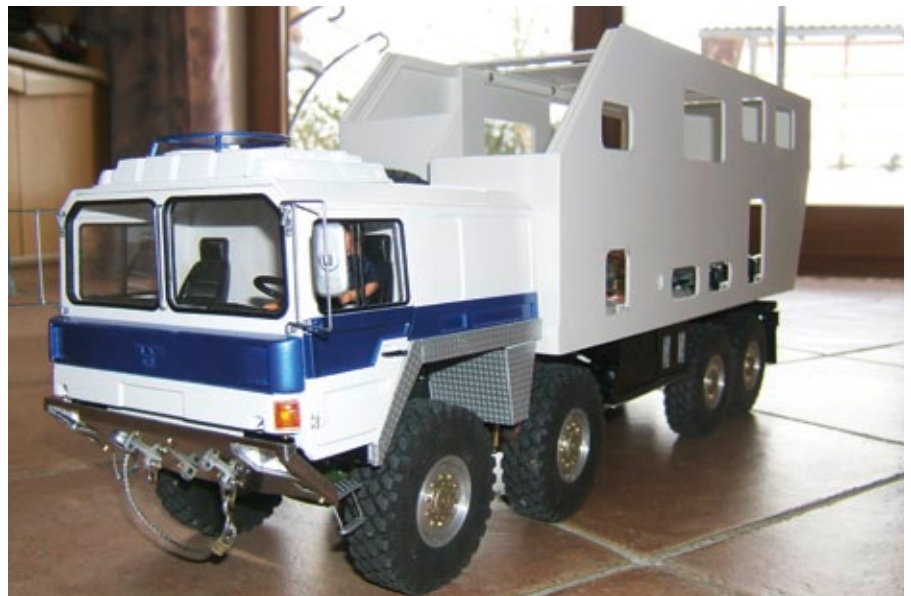
Der Wohnaufbau besteht aus ABS-Platten
