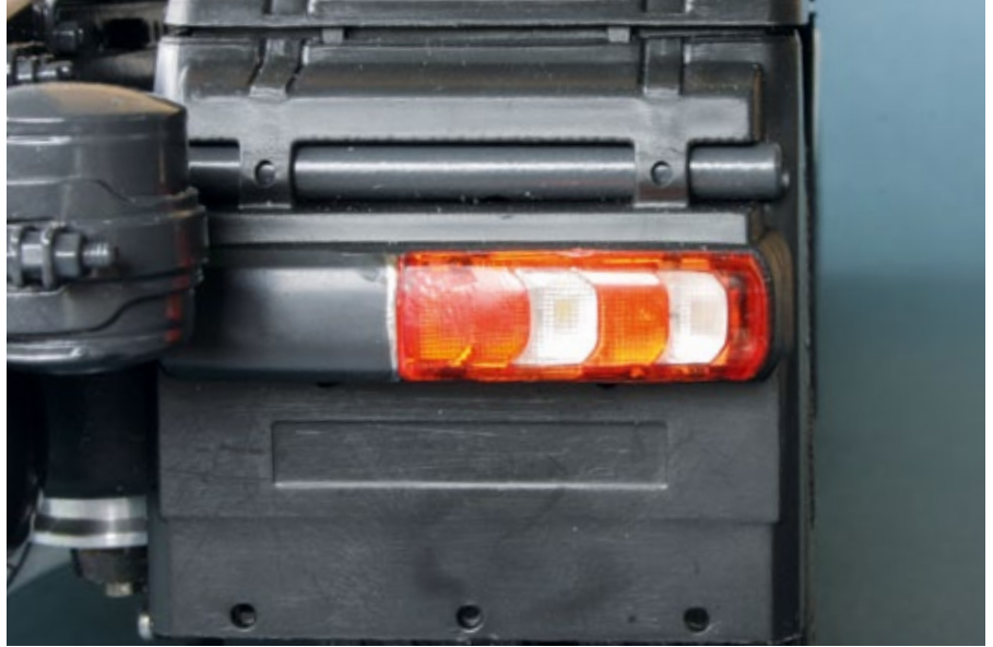
Die neuen Fünfkammer-Rückleuchten sehen deutlich realistischer aus, als die alten Kunststoffplatten
