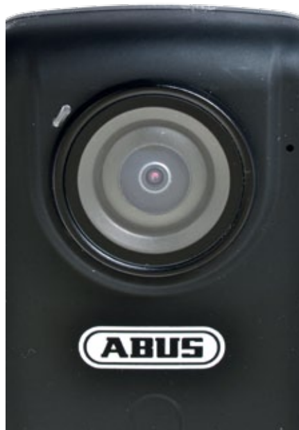
In der Abus ist ein 170-Grad-Weitwinkelobjektiv verbaut. Daneben befinden sich eine LED sowie das Mikrofon
