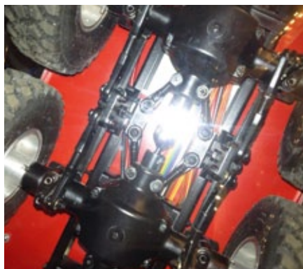
Als Hinterachse kommen zwei Modelle aus der Panther-Serie von robbe zum Einsatz
