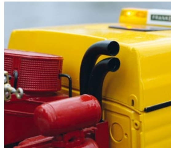
Die Auspuffrohre führen wie beim Original seitlich im rechten Winkel vom Fahrzeug weg
