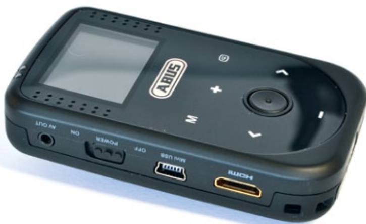
An der linken Seite der Sportscam Full HD befinden sich der AV-Ausgang, der Ein-aus-Schalter, der Mini-USB- sowie der HDMI-Anschluss
