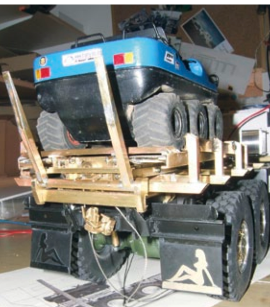
Die Rampe, auf der das Amphibienfahrzeug stehen wird, ist aus Messing gefertigt
