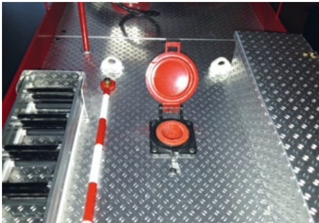
Das Wasser kann über diesen Deckel am Dach nachgefüllt werden
