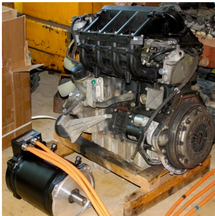
Synchron-Elektromotor (links) und Dieselaggregat im Größenvergleich
