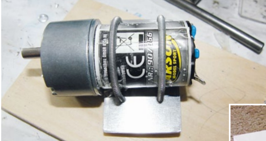
Der Getriebemotor wird mittels gebogenen 3-Millimeter-Gewindestäben auf sein Halteblech gepresst
