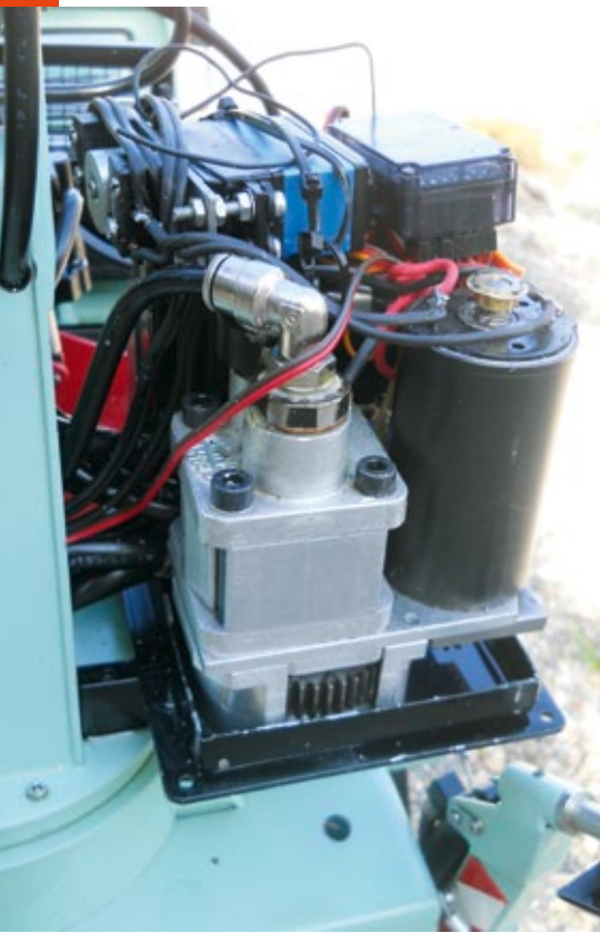
Dicht gedrängt finden sich in der Baggerkabine die Hydraulikpumpe und der Motor
