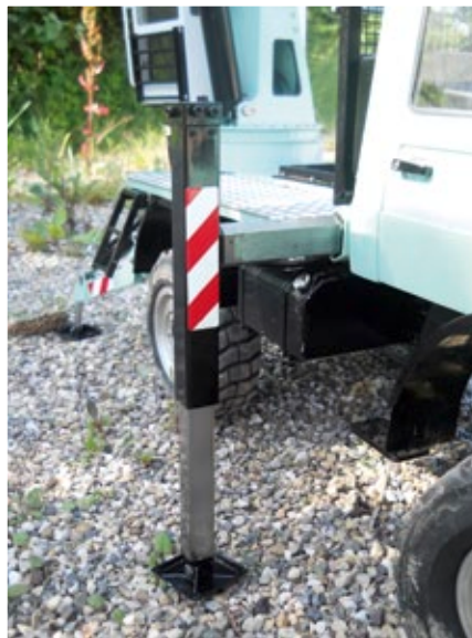
Die vorderen Stützen sind ausgezogen und ausgefahren
