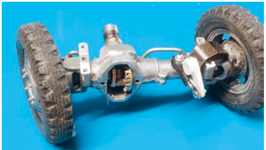
Aus der Not geboren: der übergreifende längere Lenkhebel. Die Anlenkung erfolgt nun innerhalb des Fahrgestell-Rahmens. Am Differential-Gehäuse wurde oben auf dessen rechter Seite etwas Material abgetragen, damit es bei Vertikalbewegungen nicht an den rechten Längsträger stößt
