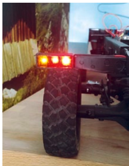
Die Lampengläser von den Rückleuchten sind aus bemaltem Plexiglas und werden mit Leuchtdioden zum Leben erweckt
