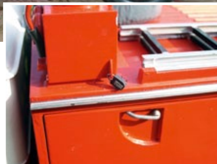
Ein Schloss am Dachkasten verhindert unbefugten Zugriff
