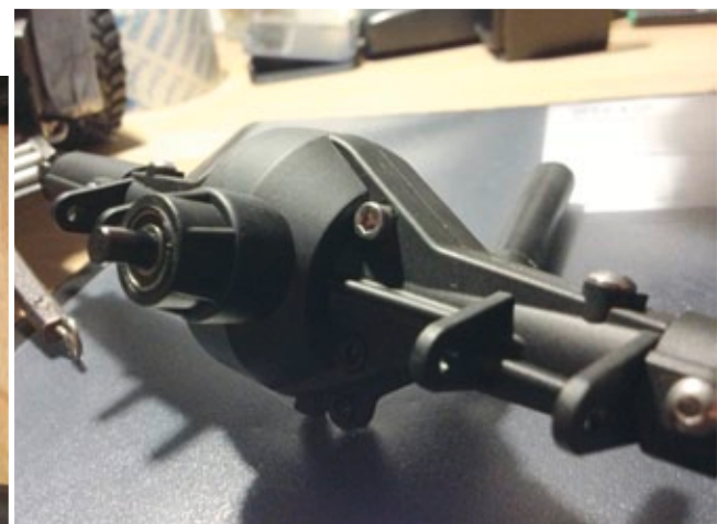
Die Achse mit Durchtrieb ist zusammengebaut
