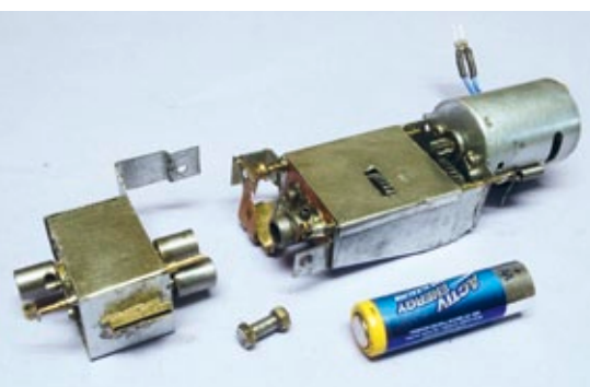
Mit seinem schrägen Unterboden gibt das flach bauende Dreigang-Schaltgetriebe der Kardanwelle zur Vorderachse den erforderlichen Raum. Das große Gangrad für den ersten Gang erzwang ein Fenster im Deckel
