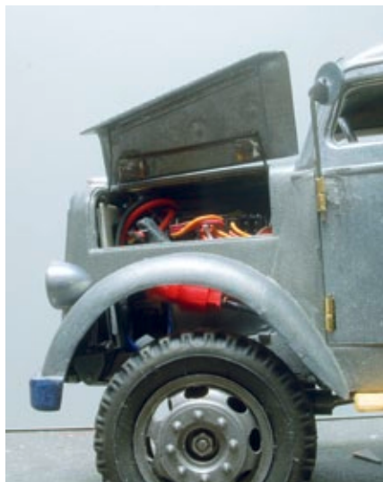
So angeschlagen lassen sich die Motorhaubenhälften auch richtig aufstellen
