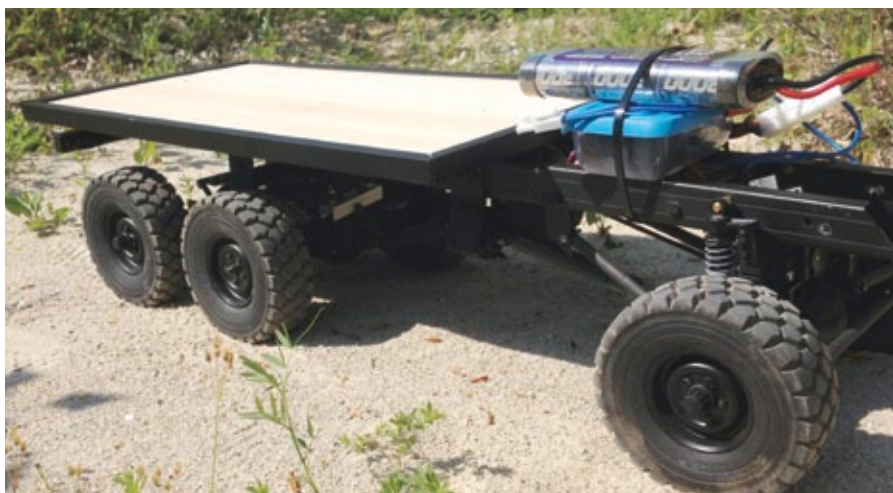
Kurzer Testlauf: gut zu erkennen ist die Pritsche aus einfachen Holzplatten
