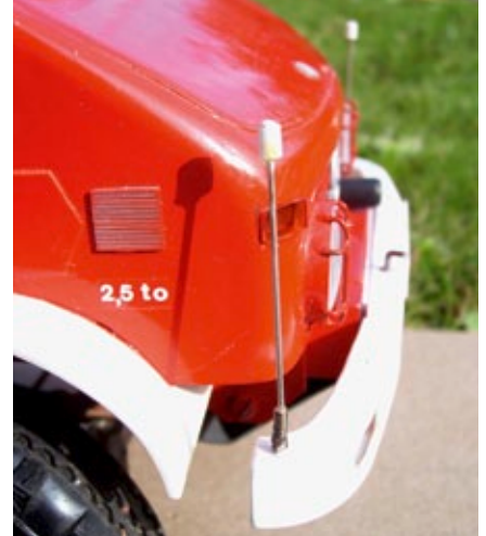
An den äußeren Enden der Stoßstange ist jeweils eine federnde Peilstange montiert
