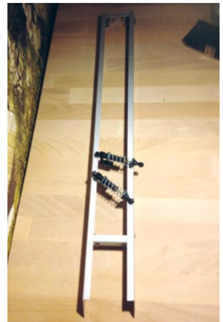
L-Profile aus dem Baumarkt sind die Basis für das Chassis
