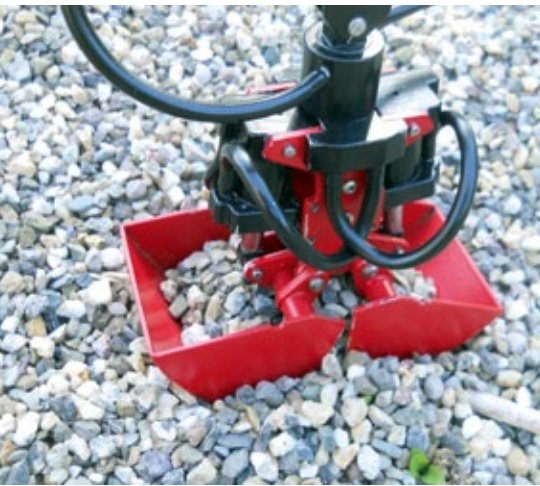
Ein Gewicht von 5 Kilogramm kann der Aufbauagger problemlos anheben
