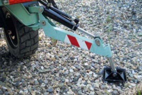
Die hinteren Stützen sind hydraulisch betrieben
