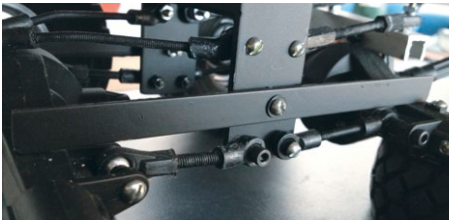
Die ursprünglichen Befestigungen sind jetzt durch Inbusschrauben ersetzt
