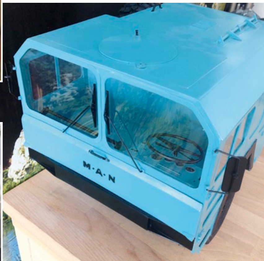
Die Kabinenverglasung ist aus 0,6-mm-Plexiglas hergestellt
