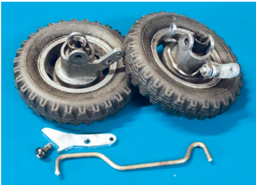
Neu angefertigte Spurstangenhebel und Spurstange für eine stimmige Lenkgeometrie
