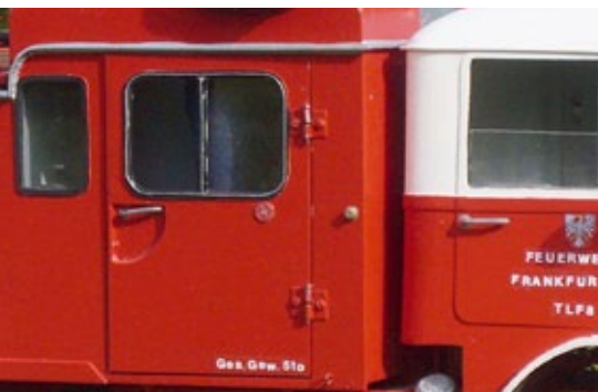
Die Türgriffe wurden aus 2-mm-Messingdraht mit passenden Verschlussstücken in die Griffmulden eingebaut
