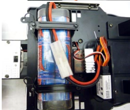
Empfänger und Regler sind heute so klein, dass der Platzbedarf nur noch sehr gering ist
