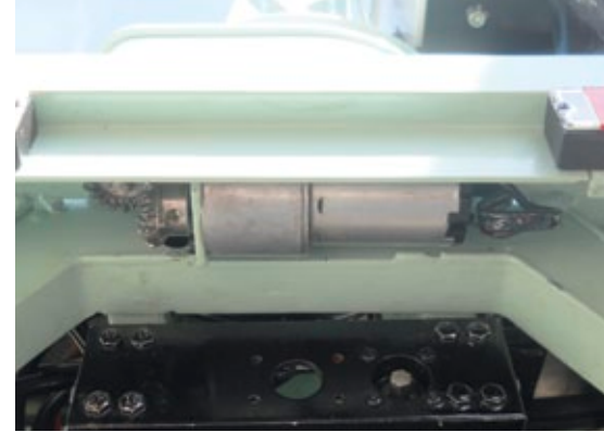
Der Getriebemotor zum Drehen des Turms ist unter dem Rahmen versteckt
