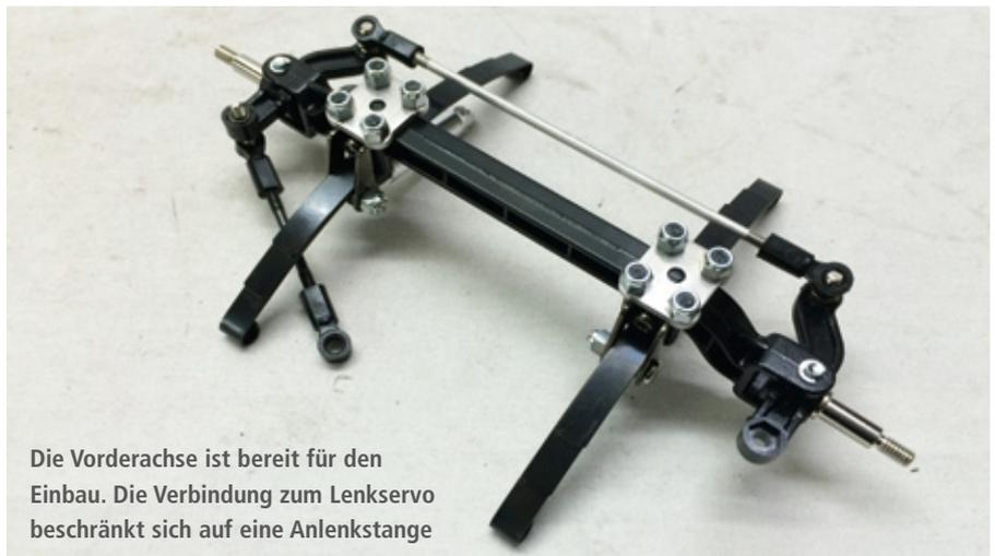
Die Vorderachse ist bereit für den Einbau. Die Verbindung zum Lenkservo beschränkt sich auf eine Anlenkstange
