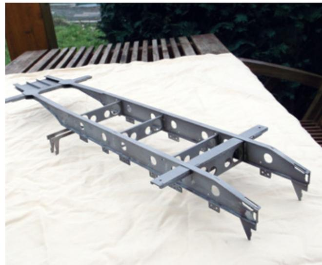
Die Blechteile sind zusammengebaut und das Chassis wurde bereits sandgestrahlt
