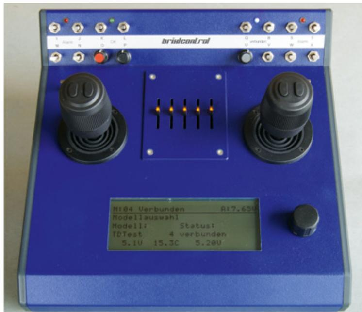
Sind Telemetriemodule am Empfänger angeschlossen, werden sie im Sender in der unteren Zeile dargestellt: Hier sieht man neben der BEC-Spannung und einer weiteren Bordspannung die Temperatur im Modell
