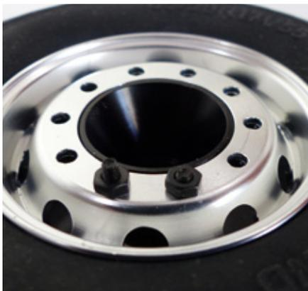
Unterschied: Rechts ist die Inbusschraube mit der zusätzlichen Mutter befestigt
