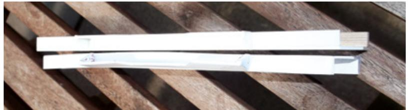
Die 3D-Druck-Stoßstange verzog sich nach dem Kontakt mit der Farbe und musste kurzerhand aus PS und Holz neu hergestellt und lackiert werden
