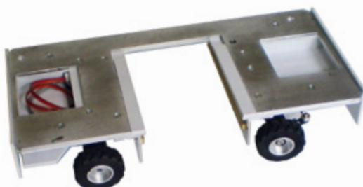
Die Grundplatte für das Fahrgestell besteht aus CNC-gefrästem Aluminium
