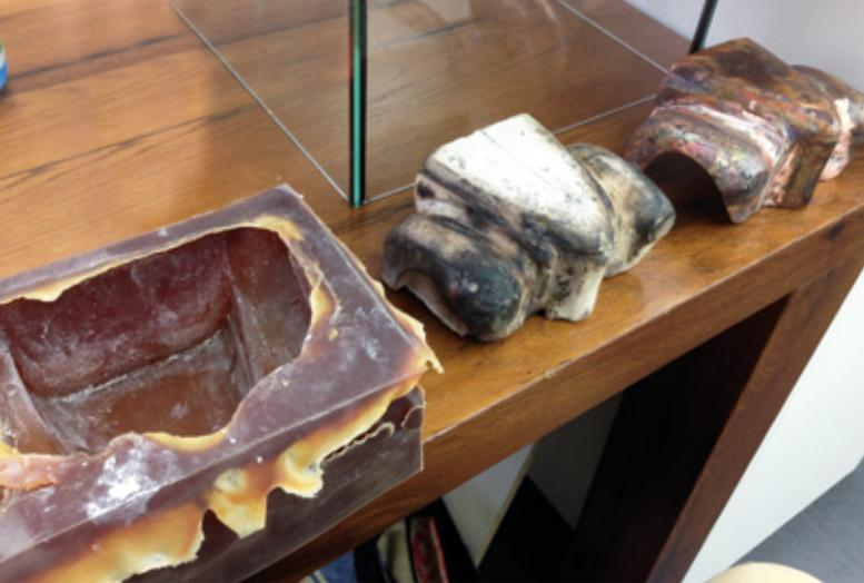
Die Latexform und der Abguss: Die Spuren des Treibens des Blechs und des Verlöten mit Hartlot sind deutlich zu sehen. Eine neue Form kann jedoch schnell nachgefertigt werden. Rechts liegt die fertige Kupferkarosserie
