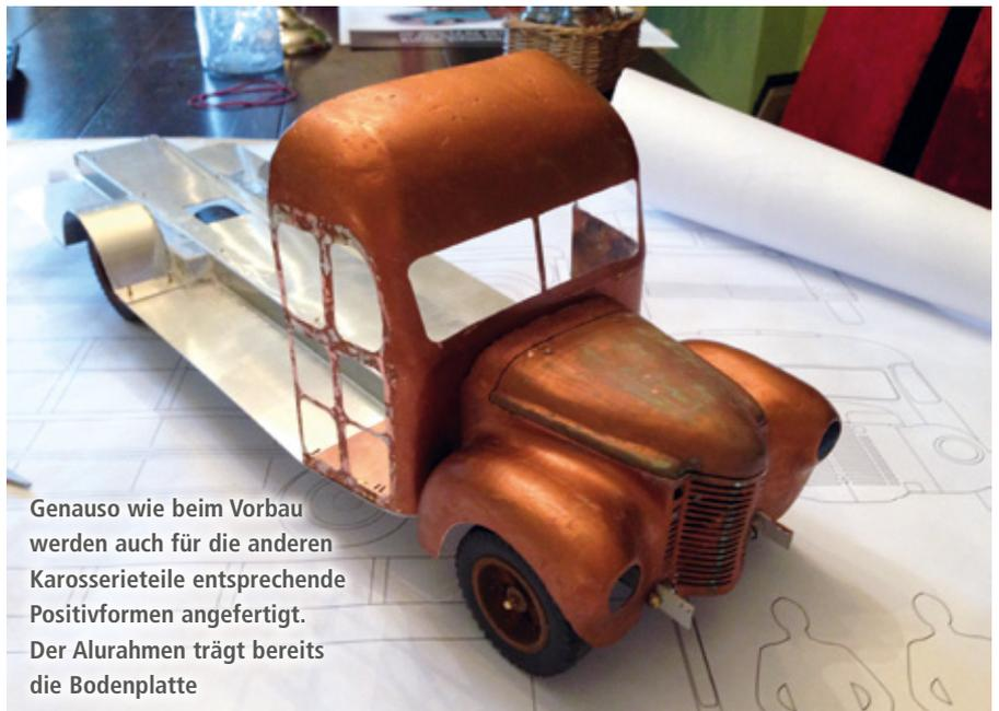
Genauso wie beim Vorbau werden auch für die anderen Karosserieteile entsprechende Positivformen angefertigt. Der Alurahmen trägt bereits die Bodenplatte
