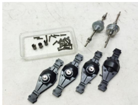
Die Achsen werden von Anfang an mit Kugellagern ausgestattet
