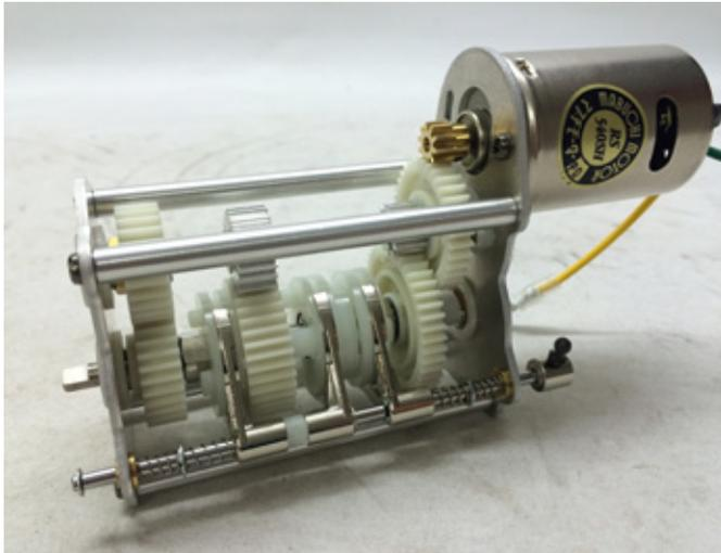
Technisch gesehen ist das Seriengetriebe ein Leckerbissen. Nur das Übersetzungsverhältnis in Verbindung mit dem hochdrehenden Motor ist für den Einsatz im Truck zu schnell
