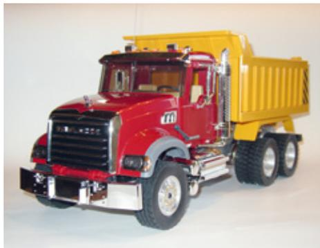
Neu bei MFZ-Blocher ist ein Bausatz für den Mack-Kipper von BRUDER. Der Umrüstsatz enthält neue Reifen mit Alufelgen, eine Vorderachse, die Hinterachspendel mit Antriebsmotoren und eine Kippmechanik. Der Antrieb erfolgt über vier Motoren auf die Hinterräder. Der Preis: 600,- Euro
