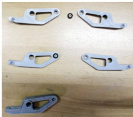
Die Radträger wurden zusammengebaut und sind bereit für die Montage
