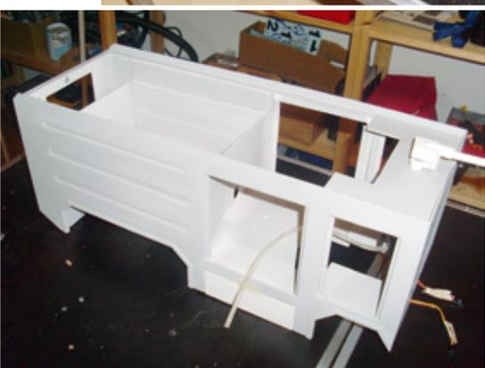
Der Rohbau ist fertig. Er besteht aus Polystyrol-Platten
