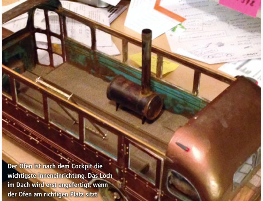
Der Ofen ist nach dem Cockpit die wichtigste Inneneinrichtung. Das Loch im Dach wird erst angefertigt, wenn der Ofen am richtigen Platz sitzt
