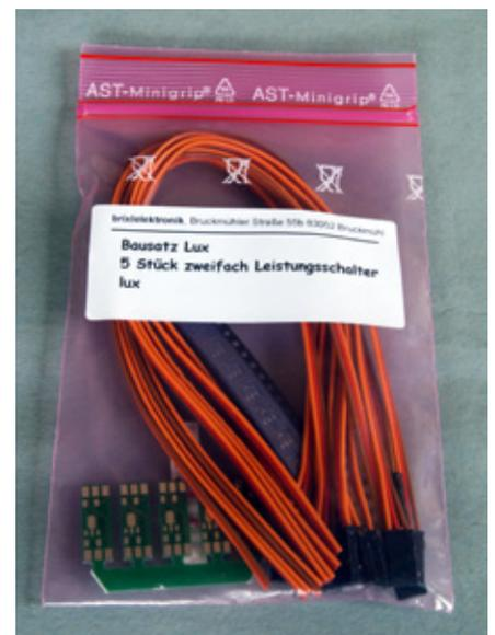
Mit dem Fünffach-Leistungsschalter lassen sich beispielsweise LEDs direkt am Auswertemodul anschließen
