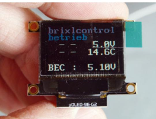
Das 1,9 Zoll-Display zeigt die Telemetrieadaten am Empfänger auch ohne Senderverbindung an. Neben der BEC-Spannung können weitere vier Messwerte gezeigt werden
