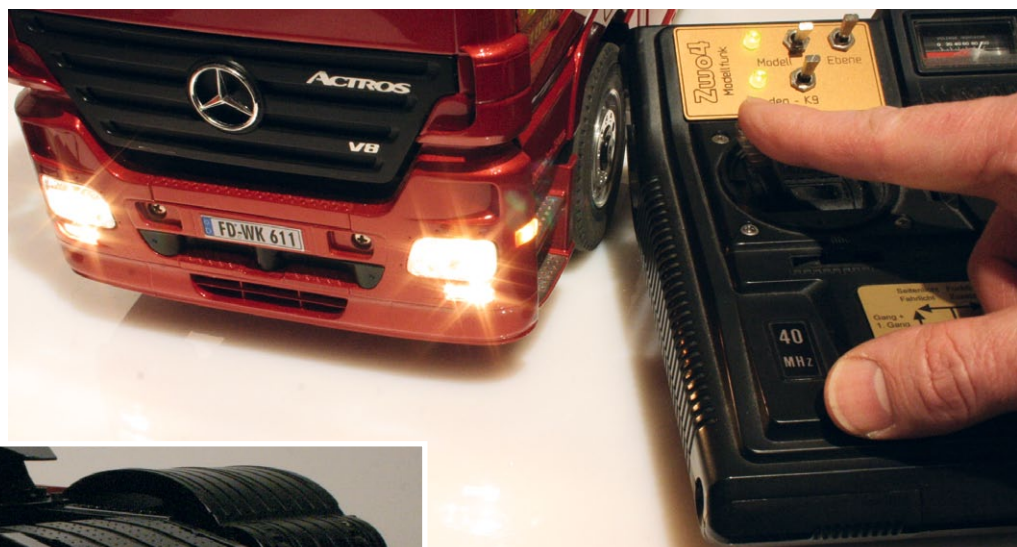
Die Bedienung der Lichtanlage und der anderen Zusatzfunktionen kann auch über den Kreuzknüppel erfolgen
