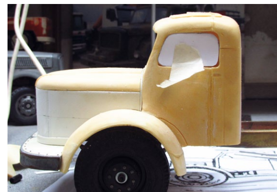
Das Fahrerhaus wurde modifiziert, sodass es am Ende besser auf das Chassis passte
