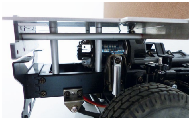
Durch die fertig montierte Tussenwand ist reichlich neuer verdeckter Raum für Elektronik entstanden
