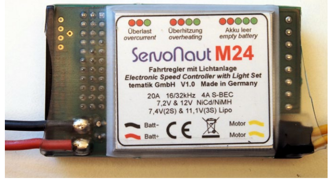
Die Anschlüsse für Empfänger und weitere Elektronik (links) sowie die Lichtanlage (rechts) sind klar und übersichtlich beschriftet
