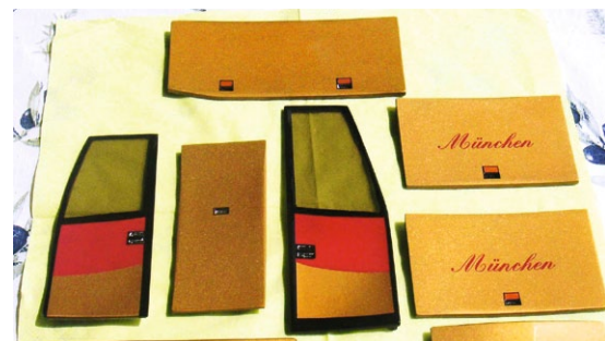
Türen und Luken waren durch das Lackieren völlig verzogen
