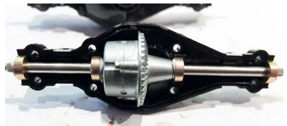
Die etwas veränderte Vorderachse mit dem Servo mittig und der nach hinten verlegten Lenkstange
