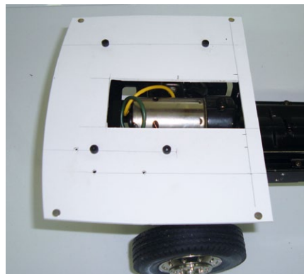
Eine neue Trägerplatte wurde angefertigt, damit die neue Hütte auf das Chassis passt
