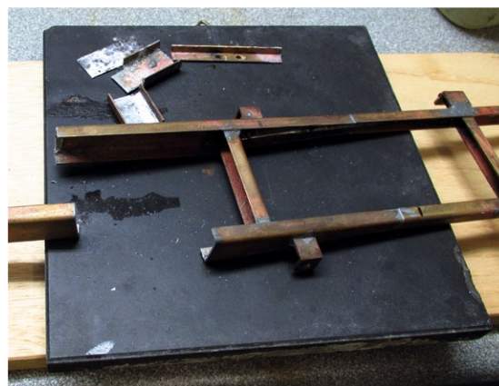
Das Chassis wurde verkürzt und der Radstand reduziert
