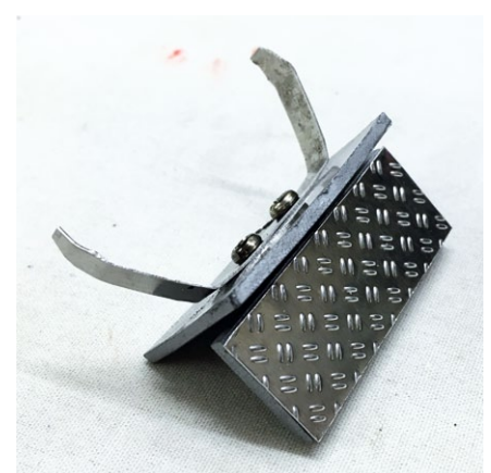
Mit einer alten Blattfeder und einer Trittstufe als Halter kann der Akkufachdeckel sicher in den Tank geklemmt werden
