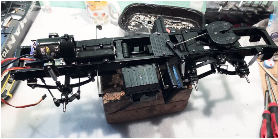
Das fertige Chassis nach der Hochzeit des Motors mit der Getriebeeinheit
