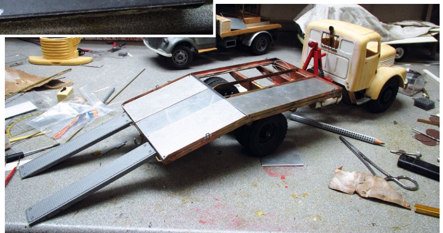
Die massive Ladeplattform wurde aus Messing-Profilen und Alu-Blechen aufgebaut
