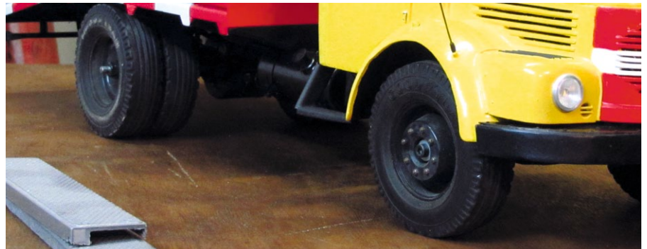
Von den vorderen Felgen wurden die angeformten Kunststoffschrauben abgedreht und diese durch acht echte, aber funktionslose Stahlschrauben ersetzt
