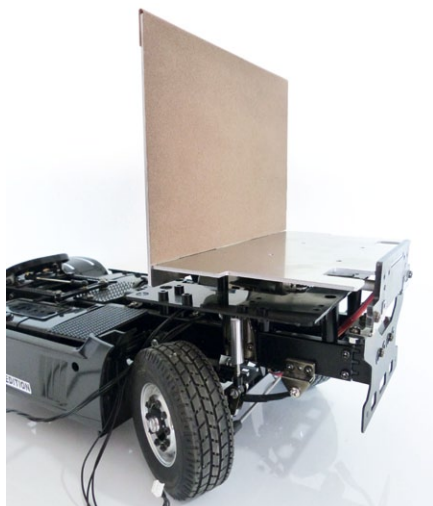
Die Tussenwand wird auf die Tamiya-Grundplatte angepasst
