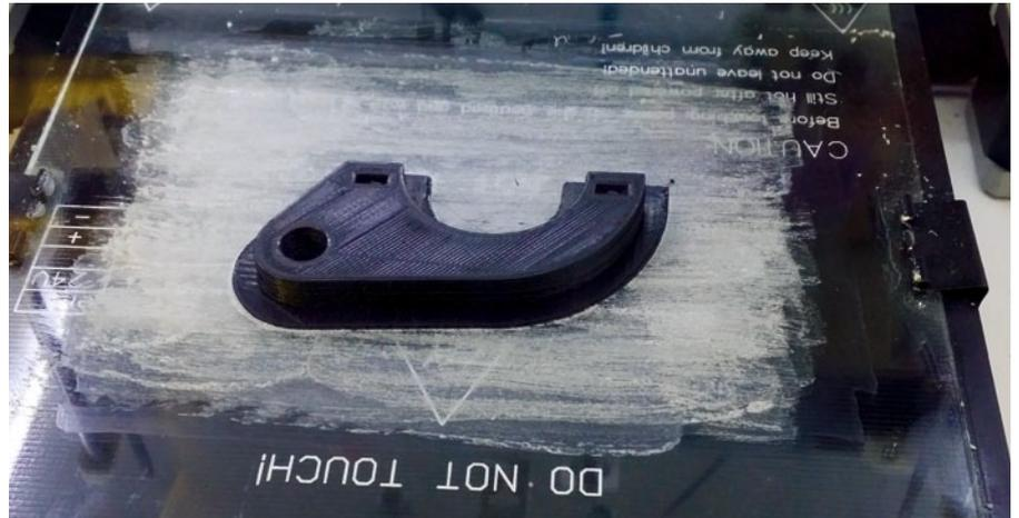
Das Druckobjekt aus Polycarbonat auf dem Heizbett. Gut zu erkennen ist die milchig erscheinende Haftvermittler-Schicht. Das Druckteil ist mit Raft gedruckt
