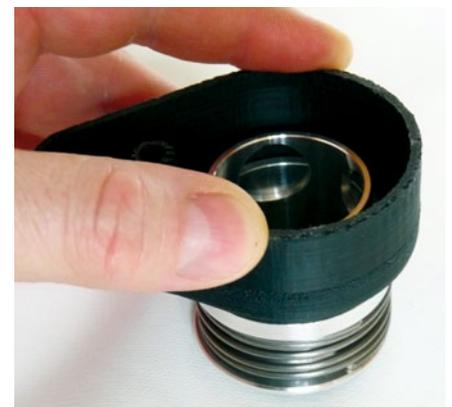
Die Absaugung samt Niederhaltermechanismus besteht aus Dreh- und 3D-Druckteilen und ist nicht nur sehr stabil, sondern auch passgenau. Der Anpressdruck der Feder ist recht hoch, daher werden Werkstücke sicher auf der Fräsplatte gehalten
