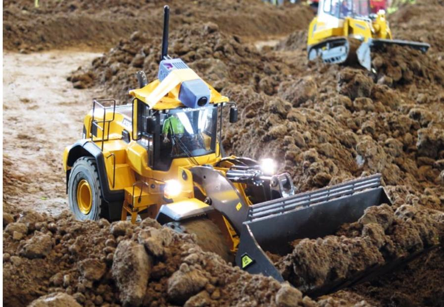
Beim ersten öffentlichen Einsatz des Systems in Alsfeld kam ein Gehäuse aus dem 3D-Drucker zum Einsatz, das oben auf dem Modell angebracht wurde
