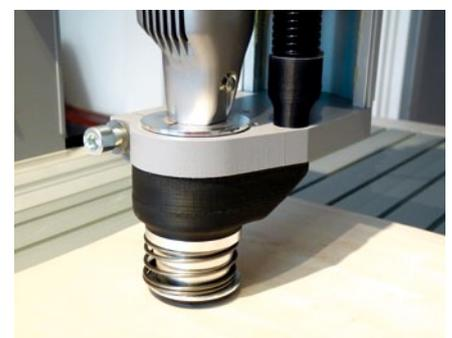
Um auch bei 43-Millimeter-Fräsmotoren von Kress oder HF-Spindeln genügend Platz zu haben, verfügt der Absaugadapter über einen seitlich versetzten und im Durchmesser sehr kompakt gehaltenen Anschluss für den Staubsaugerschlauch
