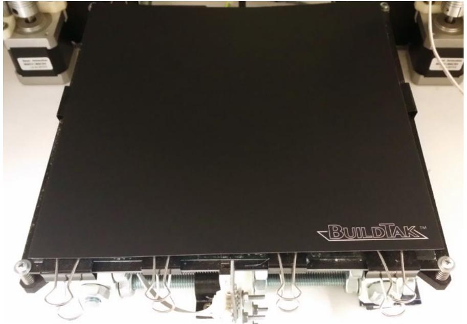
Dauerdruckplatten werden oft passend für das jeweilige Druckbett angeboten beziehungsweise lassen sie sich einfach zuschneiden
