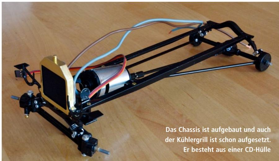
Das Chassis ist aufgebaut und auch der Kühlergrill ist schon aufgesetzt. Er besteht aus einer CD-Hülle
