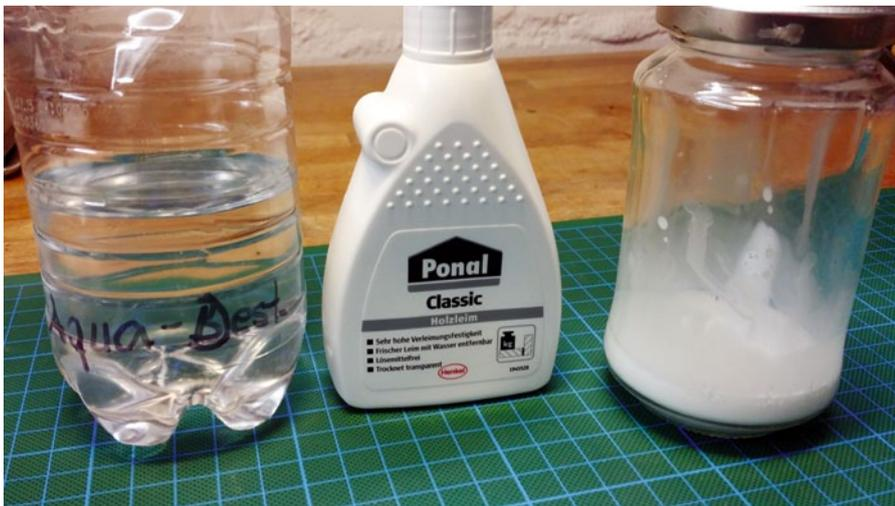
Die PVA-Wasserlösung wird aus Ponal-Holzleim und destilliertem Wasser im Mischungsverhältnis 1:3 angesetzt
