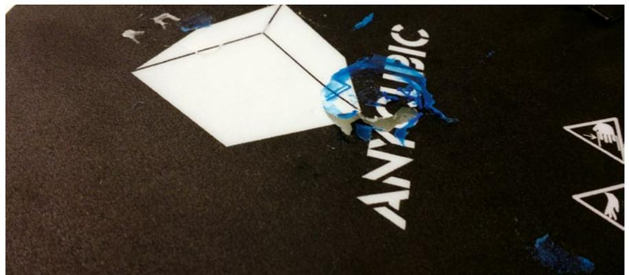
Die Dauerdruckplatte hat schon sehr gelitten: Die Druckobjekte lassen sich zum Teil sehr schwer lösen – das hat Spuren hinterlassen
