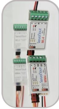
Der **Mini-Multiswitch MM4** hat je vier Ausgänge und ist universell für alle Bereiche des Funktionsmodellbaus geeignet. Die Mini-Lichtanlage **ML4** bietet diverse Lichtfunktionen. Eine Ansteuerung über **MultiBus** ist bei beiden möglich.
