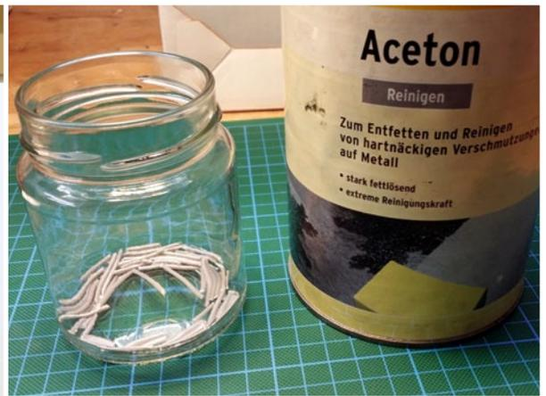
Für ABS-Juice nutzt man ABS-Filament und Aceton
