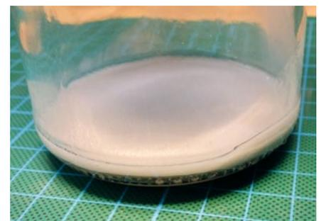
Das ABS ist in Aceton aufgelöst und kann in milchiger Konsistenz als Haftvermittler eingesetzt werden
