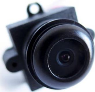
Die Kamera des TruckView-Systems ist mit einem 170-Grad-Weitwinkel ausgestattet
