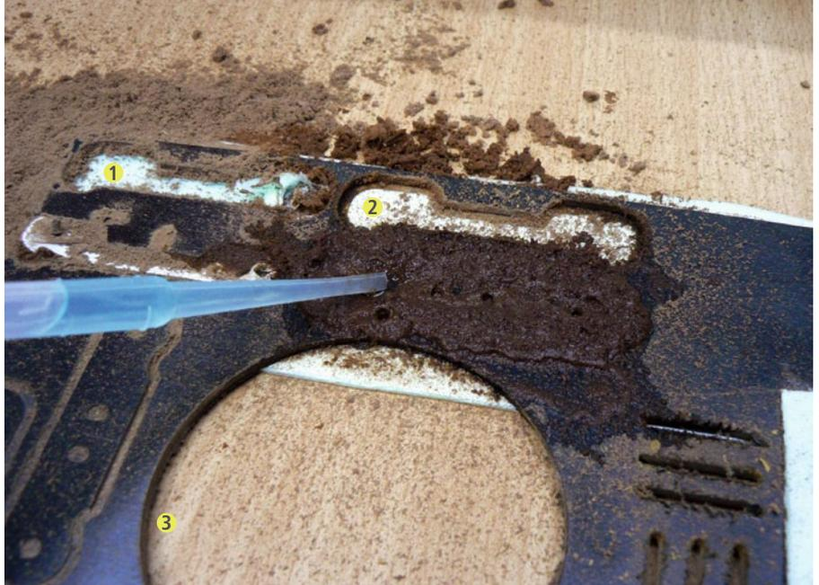
Hier kann man gut die Unterschiede zwischen keiner Absaugung (1), einer erfolgten Absaugung (2) und einem Nassfräsvorgang (3) erkennen. Letzterer ist allerdings nicht mit allen Materialien möglich und bedingt zudem die Umrüstung der Maschine auf das neu vorgestellte Wasserbecken von GoCNC
