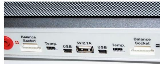
Die Frontseite bietet neben den Zugängen für die Balancer-Boards noch Anschlüsse für Temperatursensoren und Verbindungskabel zu PC oder Laptop. Darüber hinaus ist eine USB-Ladebuchse mit 5 Volt vorhanden, an der beispielsweise ein Smartphone geladen werden kann
