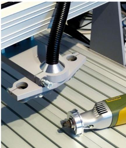
Der Einsatz des Hydra-Kopfs bedingt ebenfalls die Nutzung von Proxxon oder ähnlicher Fräsmotoren. Da dieser spezielle Umrüstsatz auf die Fertigung von Platinen abzielt, stellt die eher geringe Leistung der kleinen Fräsmotoren kein Problem dar
