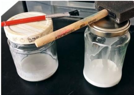
Die beiden Haftvermittler PVA-Wasserlösung (links) und ABS-Juice sind fertig zur Anwendung
