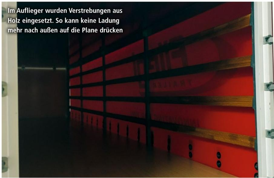
Im Auflieger wurden Verstrebungen aus Holz eingesetzt. So kann keine Ladung mehr nach außen auf die Plane drücken
