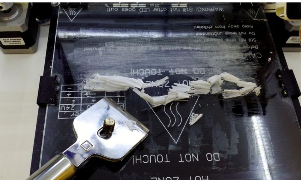
Mit einem Glasschaber lassen sich Haftvermittlerreste gut vom der Glasplatte des Druckbetts entfernen
