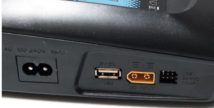
Links gibt es neben den Anschlüssen für Gleich- und Wechselstrom einen USB- sowie ein Multiport inklusive Servo-Tester
