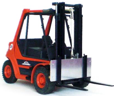
Elektrischer Seitenschieber: die Idee hierzu wurde durch die Anfrage eines Modellbauers geboren
