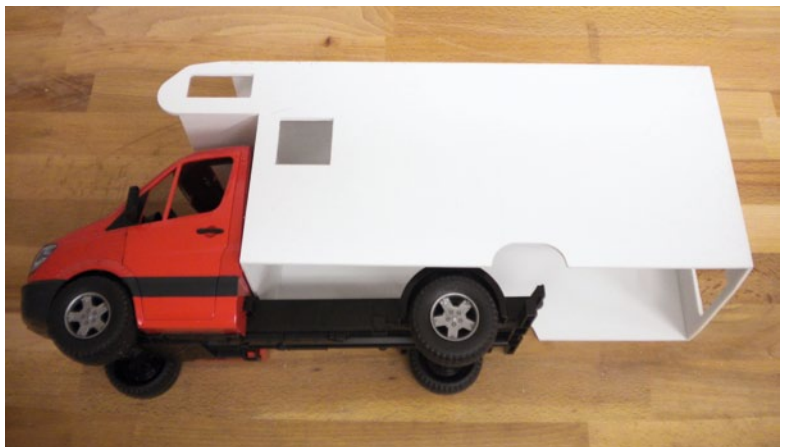
Der Radstand des Ausgangsmodells ist deutlich zu kurz für den Heckaufbau – eine Lösung musste her
