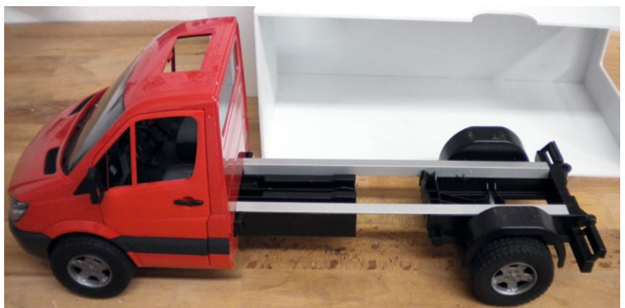
Der angepasste Radstand bietet genug Platz für den Aufbau, zwei Aluminiumwinkel verstärken das Chassis
