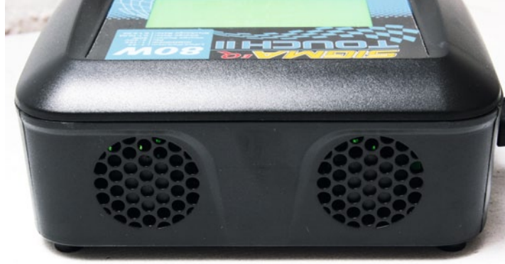
Zwei integrierte, leistungsgesteuerte Lüfter sorgen für die Kühlung im Betrieb
