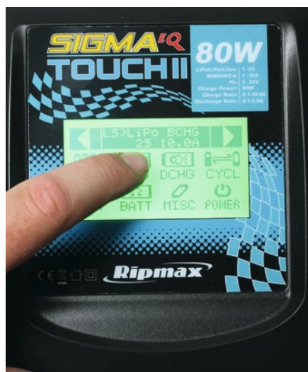
Bedient wird der Lader über ein Touch-Display. Die Menüstruktur ist intuitiv erfassbar
