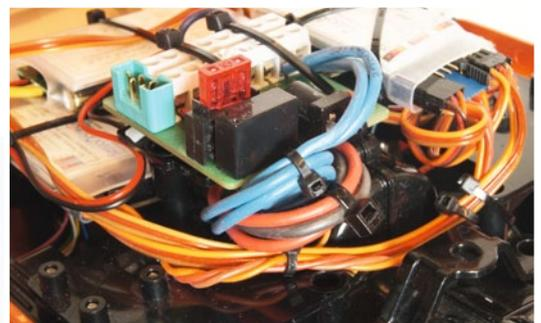
**Auch im Testaufbau muss Ordnung sein; für einen endgültigen Aufbau sollte man die Leitungen so weit wie es geht einkürzen. Über den grünen Multiplex-Stecker wird der Akku angeschlossen**
