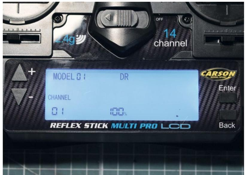
Über die Tasten links und rechts neben dem Display lassen sich die Funktionen und Einstellungen gut konfigurieren
