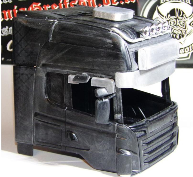
Die Kabinenteile wurden mit 800er-Schmirgelpapier angeraut, entfettet und anschließend grundiert. Nachdem die Grundierung getrocknet war, folgte eine zweite Schleifrunde mit 1.000er-Schmirgelpapier
