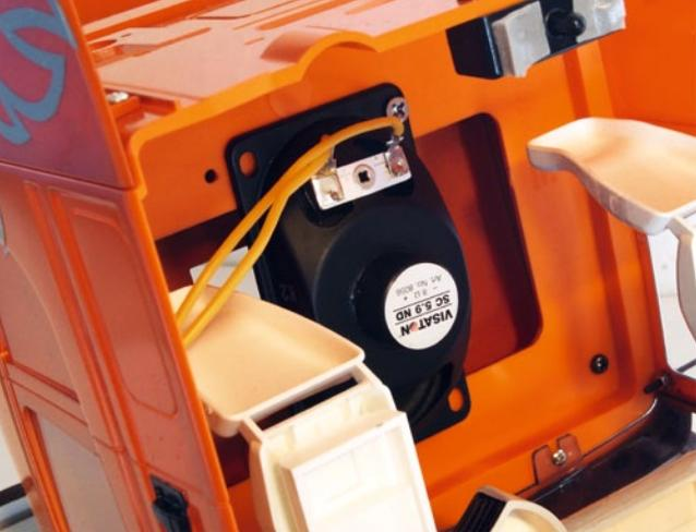
Der Lautsprecher für das Soundmodul wurde unter dem Dach montiert und tönt durch die offene Luke
