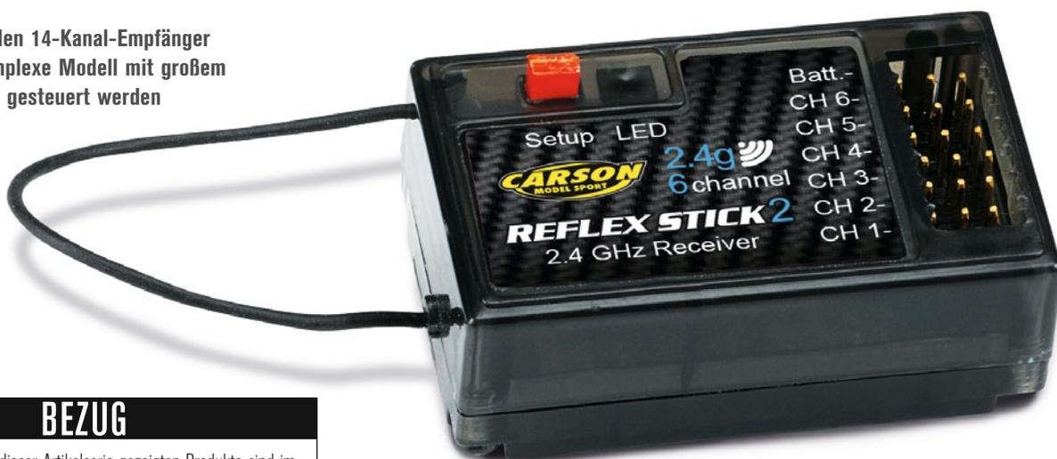
Für eine einfache Zugmaschine sollte es mindestens ein Vierkanal-Empfänger sein, mit einem Sechskanal-Receiver wie diesem hält man sich zusätzliche Steueroptionen offen
