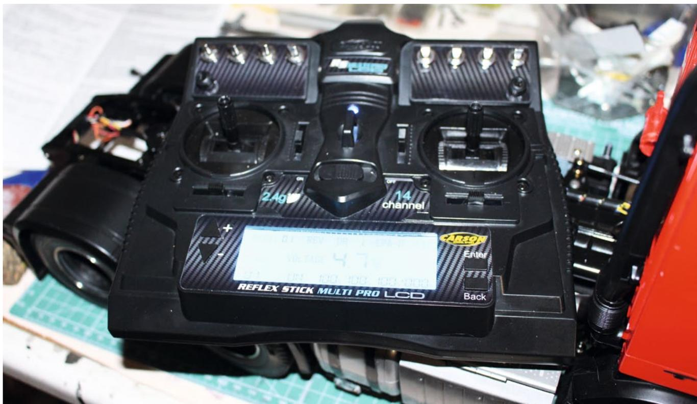
Zum Bindevorgang zwischen Empfänger und Sender ist zwar kein direkter Kontakt erforderlich, eine ruhige Umgebung ohne störende 2,4-Gigahertz-Quellen ist jedoch sinnvoll
