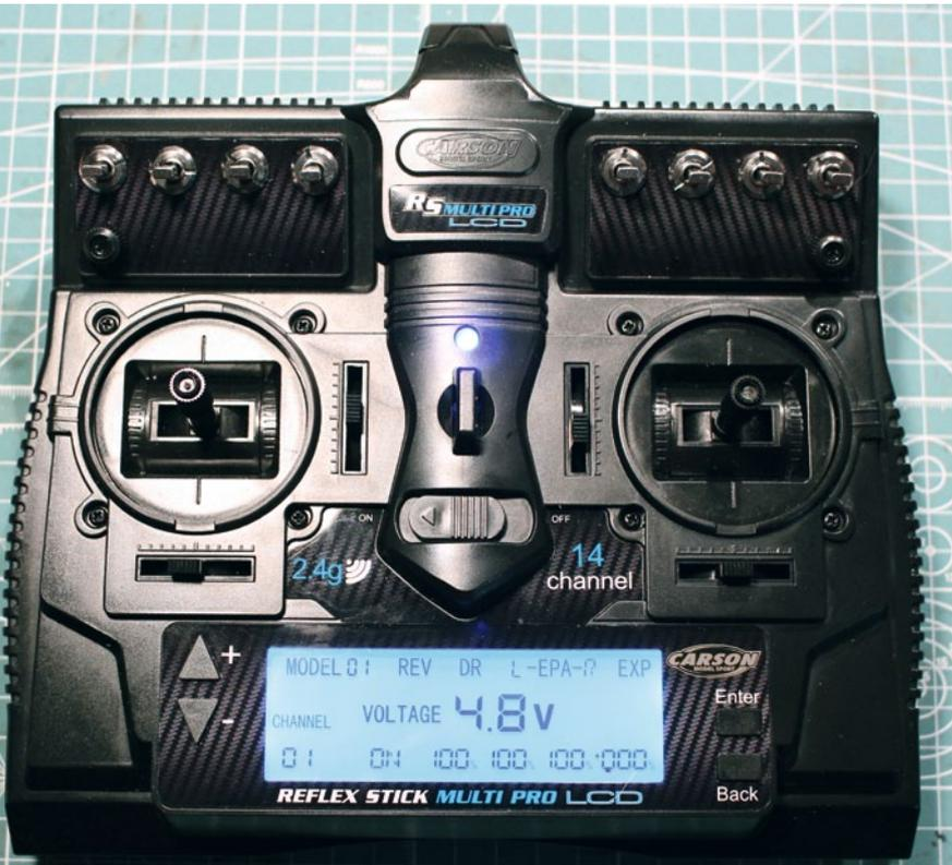
Aufgrund der guten Ausstattung mit 14 Kanälen sowie weiteren Schaltern, Tastern und Reglern eignet sich die Reflex Stick Multi Pro LCD von Carson gut für Ein- und Aufsteiger im Funktionsmodellbau
