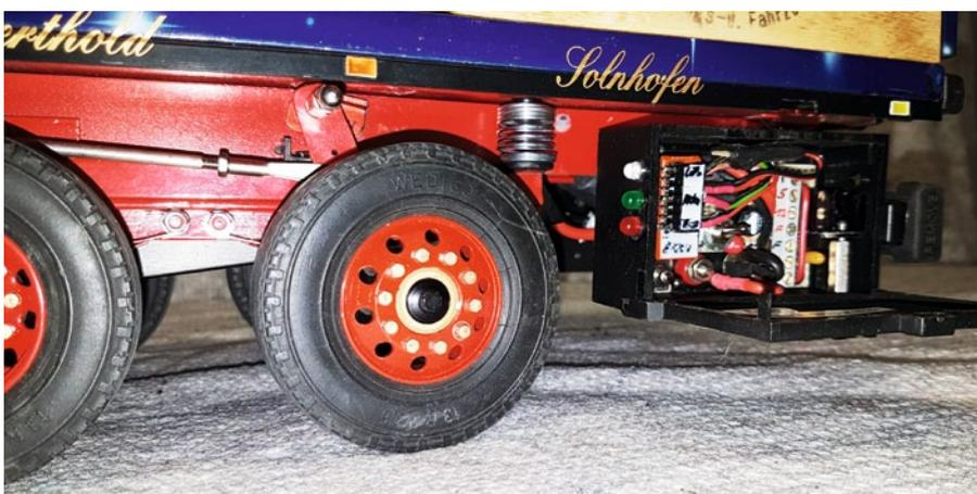
Federunterstützung mit linker Schaltbox im Werkzeugkasten
