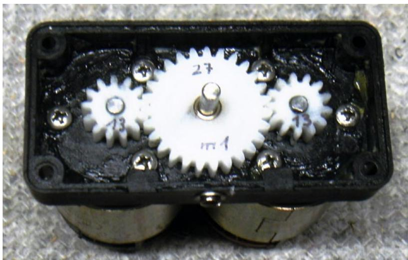
Verschleißfeste Kunststoffzahnräder, die auf 7 Millimeter gedreht wurden, kamen neu zum Einsatz
