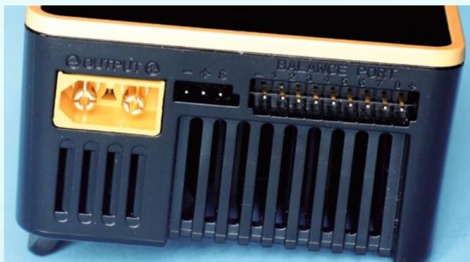
Die linke Gehäuseseite mit den Anschlüssen für Akku, Servo und Balancer
