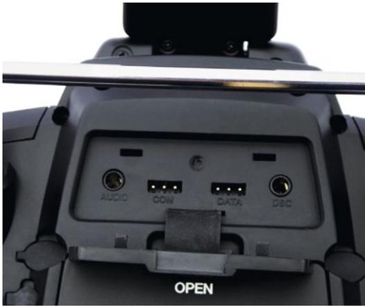
Unter einer Abdeckkappe befinden sich Kopfhöreranschluss, COM-Schnittstelle, Data- und DSC-Buchse
