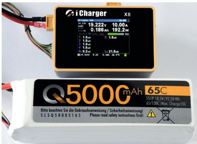
Die Praxistests beim X8 wurden mit einem 6s-LiPo mit 5.000 mAh Kapazität vom Typ Quantum durchgeführt
