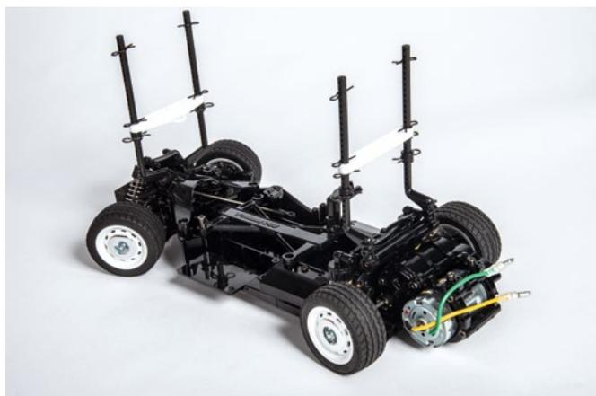
Das M-06-Chassis von Tamiya ist die optimale Basis für den T1 Samba im Maßstab 1:10
