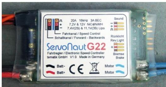
Der Servonaut G22 kann wahlweise Standard- oder Tempomat-Betrieb und simuliert zusätzlich ein automatisches Viergang-Schaltgetriebe
