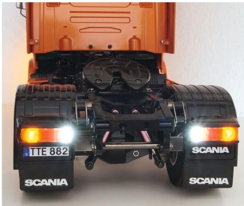
**Beim Einlegen des Rückwärtsgangs werden automatisch die Rückfahrcheinwerfer und die Warnblinker aktiviert. Nicht im Bild der ebenfalls eingeschaltete, akustische Rückfahrwarner**
