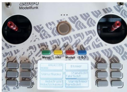
**Zwo4 Sender mit den Softkeys für die Funktionen im Scania: Der ganz linke graue Taster betätigt das Horn, der rechts daneben den Anlasser; darunter die Umschaltung von vorwärts auf rückwärts. Je nach Ebene (1-3) können unterschiedliche Funktionen mit den gleichen Tastern bedient werden**
