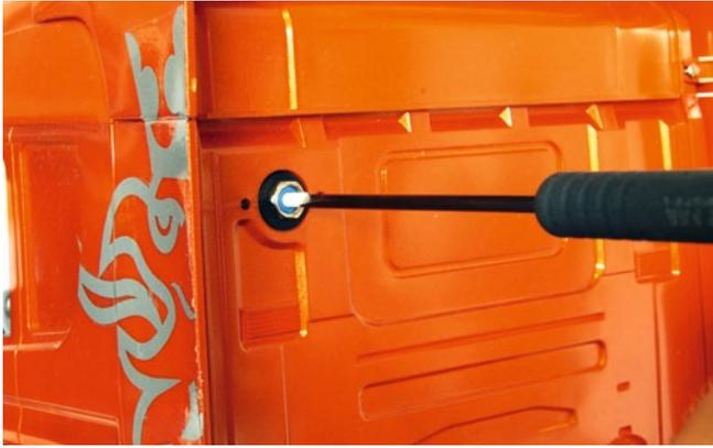
**Endlich findet das komische Bauteil eine sinnvolle Verwendung: Das Poti zur Lautstärkeregelung des Soundmoduls ist von außen zugänglich**
