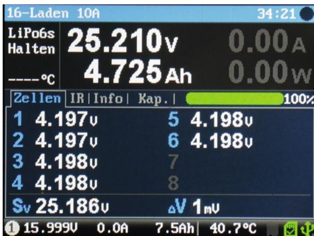
Die Display-Anzeige kurz nach dem Ladeende: nur 1 Millivolt Zellenspannungsdifferenz, das ist exzellent
