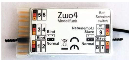
Der Zwo4-Empfänger RX9 empfängt die Signale vom Handsender HS16 und bereitet sie für die einzelnen Bausteine auf
