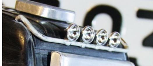
Der Lampenbügel ist mit Rundumlampen aus 5-mm-LED-Köpfen und Scheinwerfer-Linsen ausgestattet
