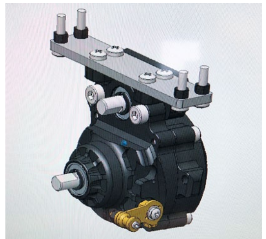
Die schräge Verzahnung der Zahnräder soll unter anderem für eine geräuscharme Laufleistung sorgen
