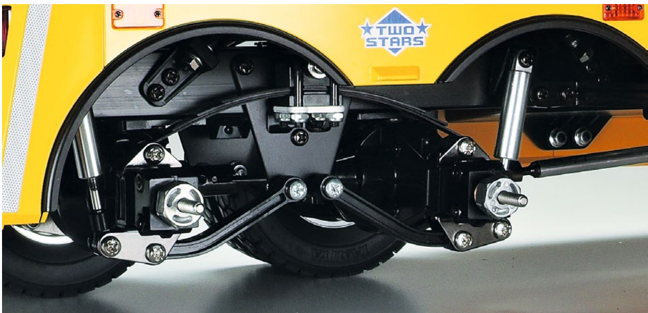
Angetrieben wird der FH 16 über die beiden Hinterachsen
