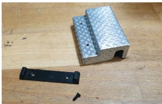
Eine Verkleidung des Schneckenradgetriebes der Rampen wurde aus Riffelblech angefertigt, ...
