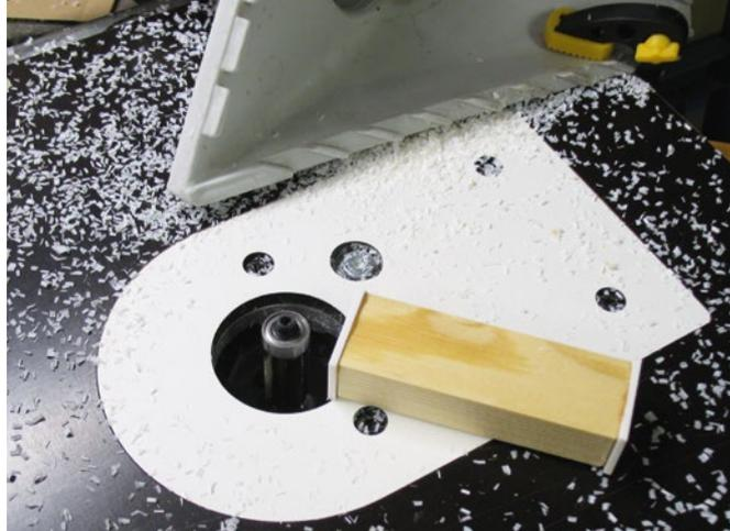
Mithilfe einer kleinen Oberfräse sind die Kanten und die beklebten Stirnseiten der Leisten abgerundet
