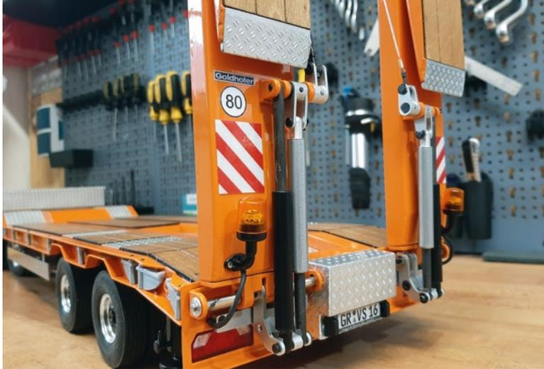
Die Rampen wurden getestet. Dabei mussten immer wieder Nuancen an den Zylindern, Federn, den Kolben oder auch der Seilanlenkung verändert werden
