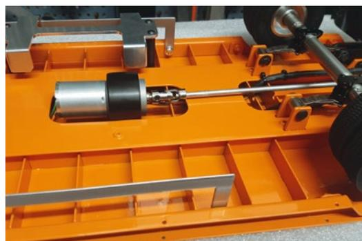
Der Motor erhielt eine spezielle Halterung aus Alu
