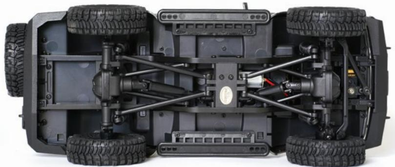
Blick auf Aluleiterrahmen, Kardanwellen, Lenkservo, Stoßdämpfer, Getriebe und Bürstenmotor
