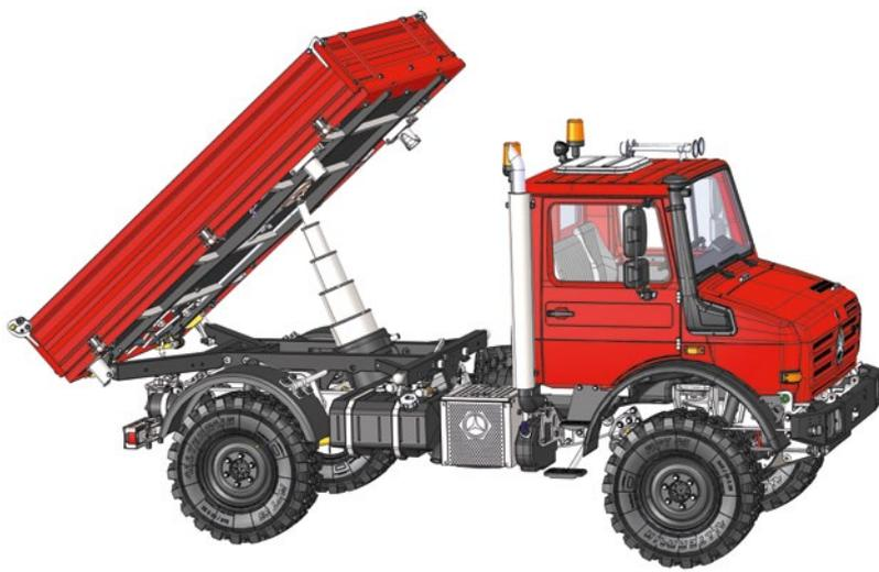
**Gleicher Hub bei verringerter Einbaulänge: Für die Unimog-Dreiseitenkippe wurde eigens eine neue Version des Teleskopzylinders entwickelt**
