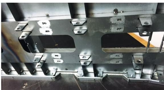
Die Radläufe sowie das Heck wurden genau eingepasst und komplett am Rahmen verschweißt
