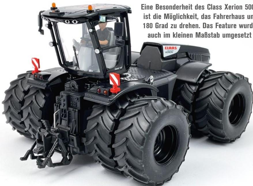
Eine Besonderheit des Claas Xerion 5000 ist die Möglichkeit, das Fahrerhaus um 180 Grad zu drehen. Das Feature wurde auch im kleinen Maßstab umgesetzt
