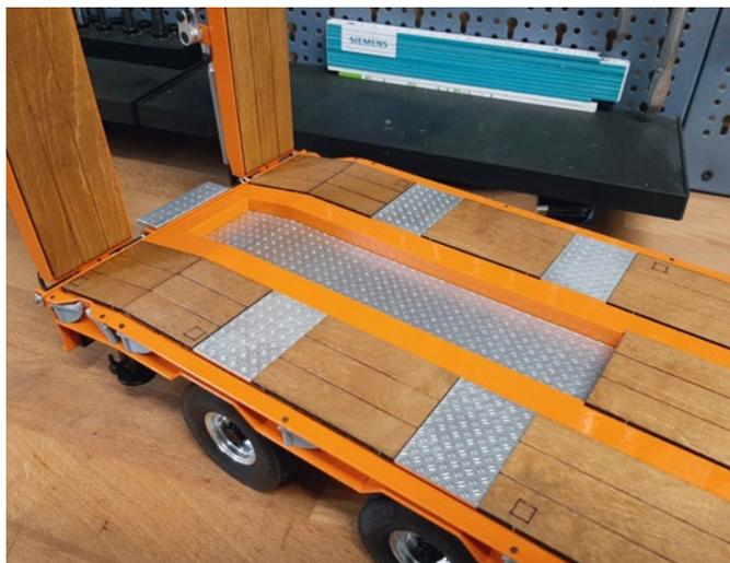
Das Riffelblech sowie die Holzbeplankung wurden mit Zwei-Komponentenkleber verklebt
