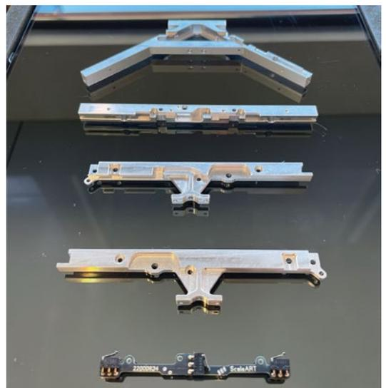
**Keine Kompromisse: Damit nichts die optische Wirkung beeinträchtigen kann, wurde bei der Konstruktion der Einzelteile darauf geachtet, dass die erforderlichen Platinen versteckt werden können**
