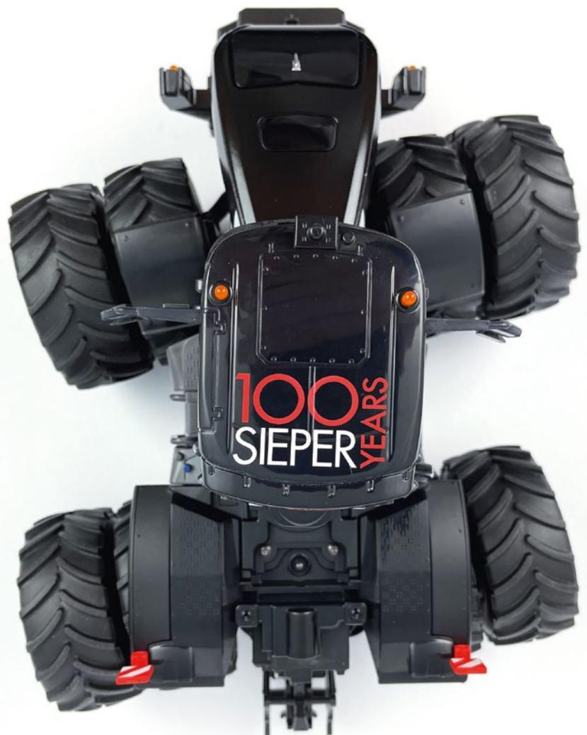
Eine weitere Besonderheit des Class Xerion 5000 ist der Hundegang, der auch im Modell umgesetzt ist. Dabei lassen sich Vorder- und Hinterachse in die gleiche Richtung verstellen
