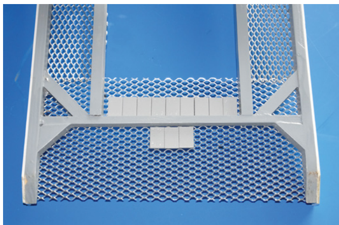
Im hinteren Auffahrbereich hat der Trailer über seine volle Breite eine Auflagefläche
