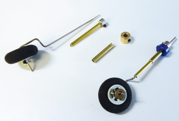
Das vordere Stützrad setzt sich aus den abgebildeten Komponenten zusammen
