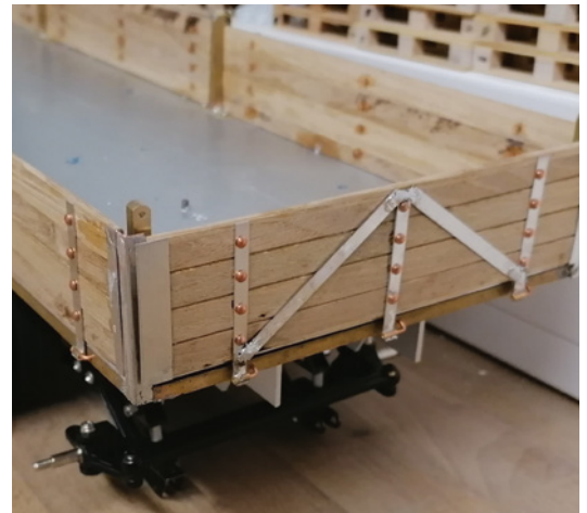
... die aufwändig mit Metallnieten und Beschlägen versehen wurden
