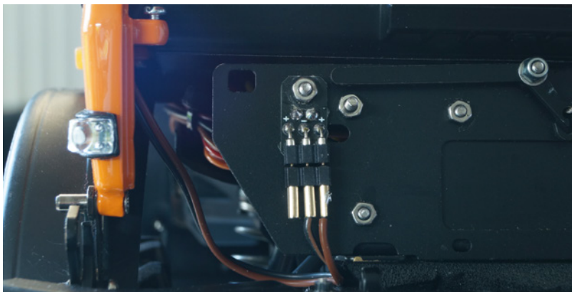
Der Steckverbinder stellt den Kontakt zwischen dem Fahrgestell und dem abnehmbaren Fahrerhaus her und trennt die Verbindung zu den Leuchten im oberen Teil
