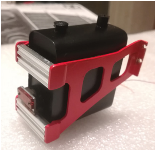
Ein selbstgefertigter Hydraulikölbehälter ersetzt den Sandkasten des Baukastenmodells
