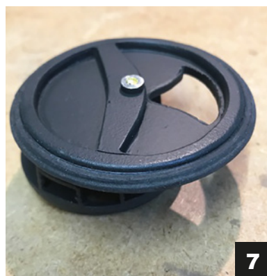
Aus einem alten Keilriemen wurde ein Stück herausschnitt, um die Griffigkeit des Steuerradaufsatzes zu erhöhen und ein Abrutschen zu verhindern
