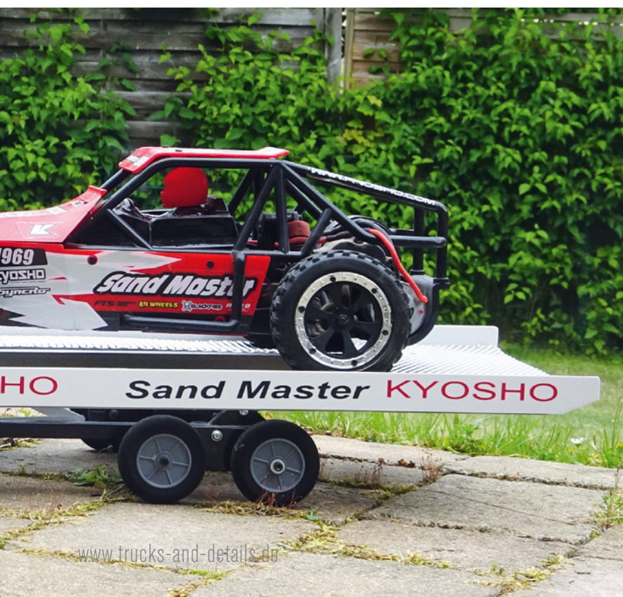
Der Vorderwagen des Trailers mit der gekrümmten Deichsel, den Auflagen für die Ladefläche und dem Ruderarm für dessen Fixierung
