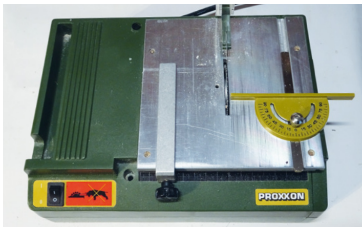
Die kleine Tischkreissäge von Proxxon war beim Rahmenbau eine große Hilfe. Ihre maximale Schnitttiefe limitierte die Rahmenhöhe von 10 mm
