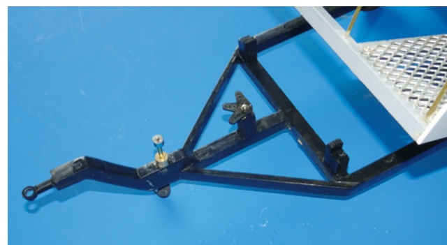
Der Vorderwagen des Trailers mit der gekrümmten Deichsel, den Auflagen für die Ladefläche und dem Ruderarm für dessen Fixierung
