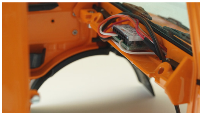
Der Armaturenbrettträger mit dem angeschlossenen MiniMod DSB für die Versorgung der Leuchten auf dem Dach
