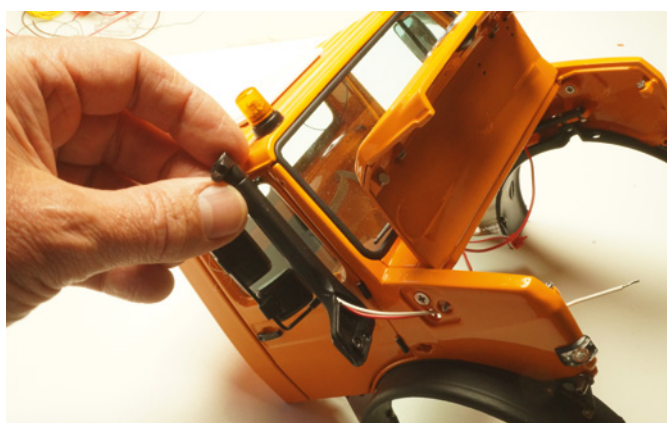
Am hochgelegten Luftfilteransaugschacht sitzt eine der beiden Dachmarkierungsleuchten; die Zuleitungen werden elegant darin versteckt
