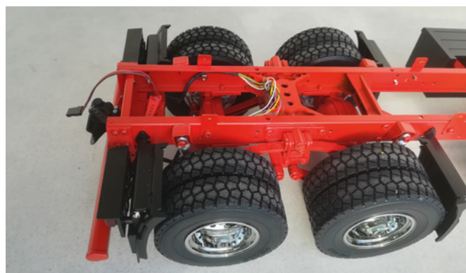
Für die Umwidmung zum Abrollkipper musste das Heck des Holztransporters eingekürzt werden
