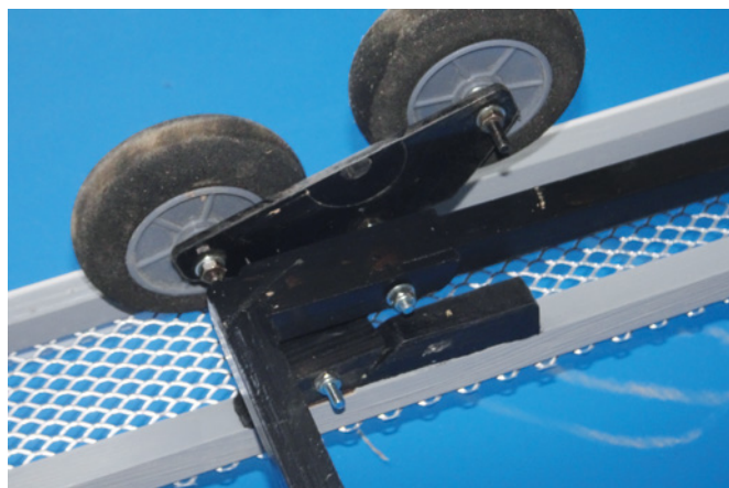
Da der Fahrrahmen deutlich schmaler als die Ladefläche ist, werden keine Kotflügel benötigt
