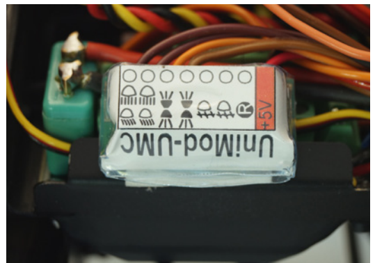
Das Lichtmodul UniMod UMC ist im Fahrgestell verbaut und nimmt beim U5000 die Anschlüsse für die Hauptscheinwerfer und – sofern vorhanden – die Nebelscheinwerfer auf
