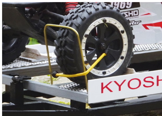
Ladungssicherung durch Spannband von der Felge zum Messingbügel
