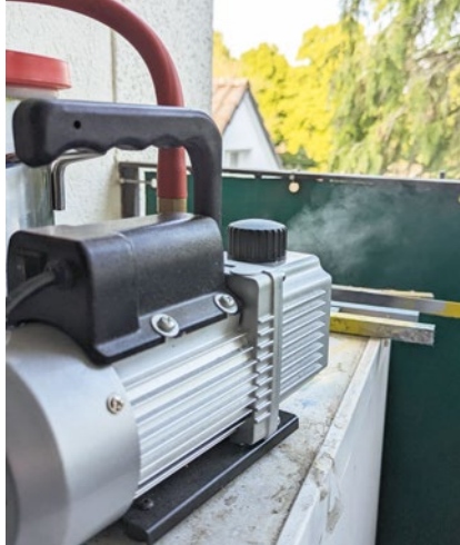
Ölnebel entweicht aus der Drehschieberpumpe
