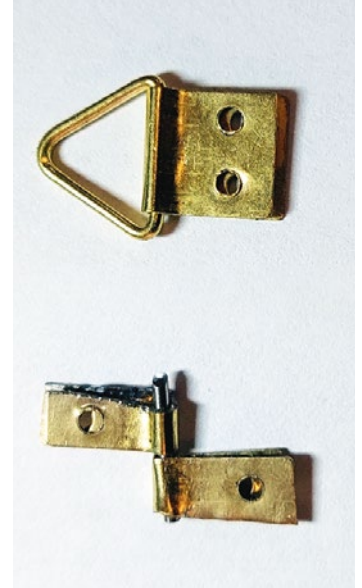
Für die Ladefläche wurden eigene Scharniere hergestellt
