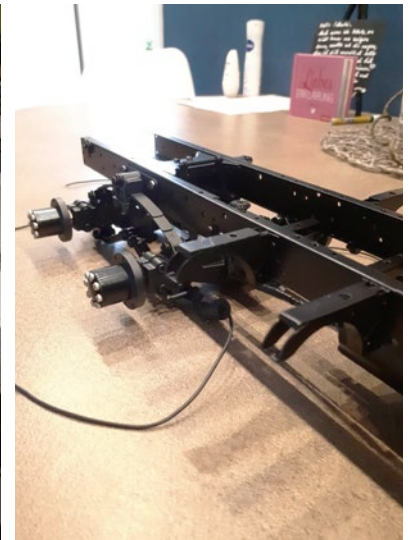
Für das Chassis wurde auf einen gebrauchten Tamiya-Rahmen und Achsen aus dem Internet zurückgegriffen. Bis auf einige Traversen wurden solche aus diversen Materialien ergänzt
