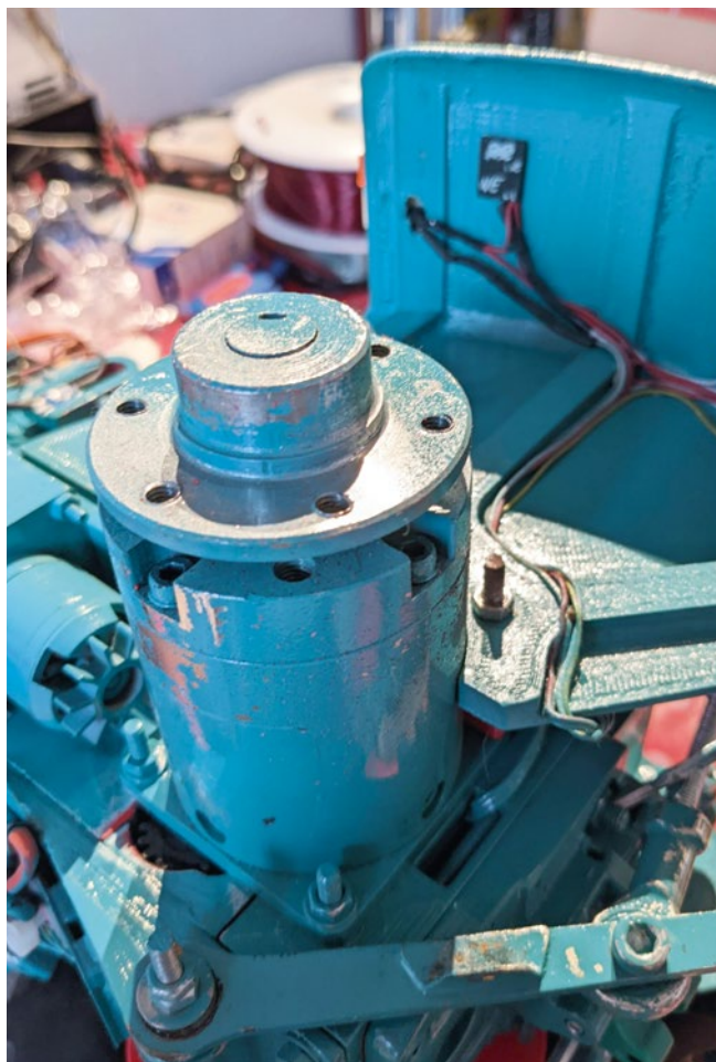
Vorderachsenantrieb oben und die Hinterachsplaneten unten
