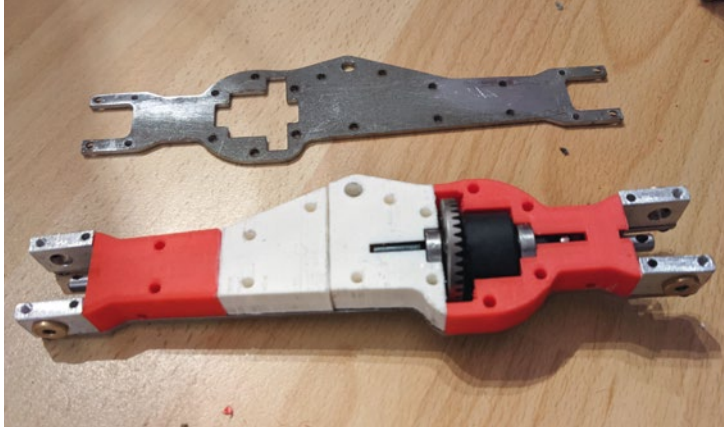
Das Bauprinzip der Vorderachse
