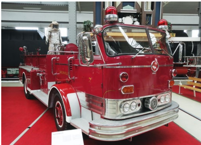
Der Mack Pumper C75 aus dem Jahre 1961 mit einem Sechszylinder Mack 707-Benzinmotor (180 PS, 5,4 l) und Fünfgang-Schaltung
