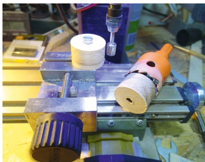
Das Abfallstück einer Lochfräse bildet die perfekte Grundlage für die Aufnahme der Riemenscheibe
