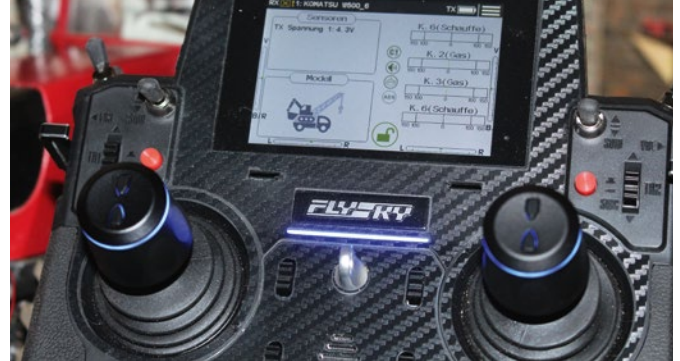
Neben diversen Schaltern stechen vor allem die beiden 4D-Kreuzknüppel hervor
