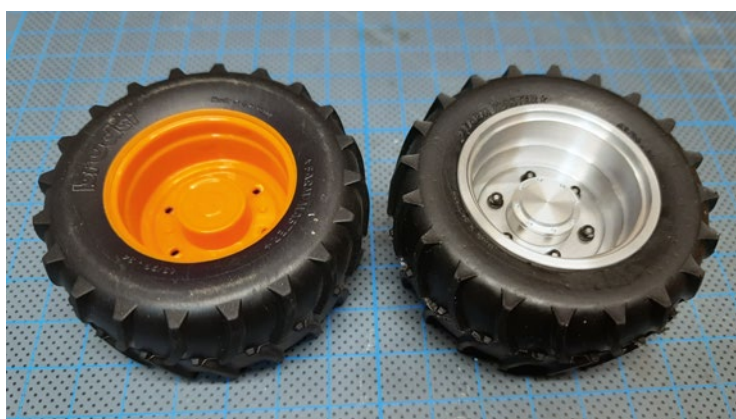
Links ist das originale Bruder-Rad, rechts der Reifen von Der RC-Bruder, montiert auf die Felge/Achsnaben aus Eigenfertigung
