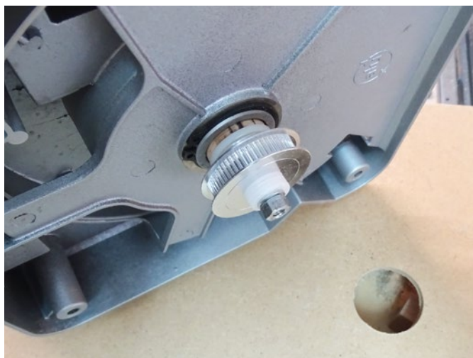
Erste Anprobe der Riemenscheibe
