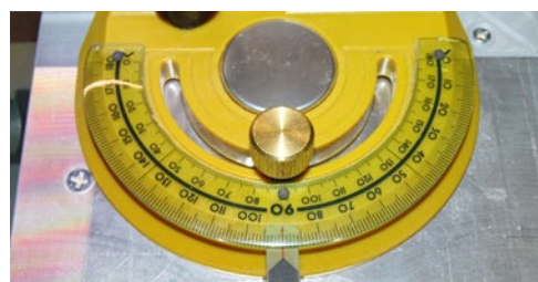
Die neue Skala für den Winkelanschlag ist nun einfacher einzustellen und besser ablesbar
