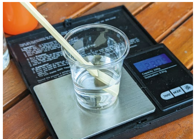
Beim Mischen das Verhältnis genau einhalten. Ein Feinwaage ist das Mittel der Wahl
