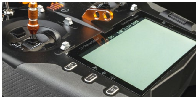
Der 800 x 480-Zoll-Bildschirm ist hintergrundbeleuchtet und kann farblich angepasst werden
