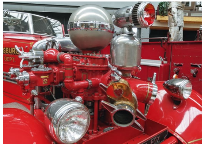
Die silberne Kugel, der Luftausgleichsbehälter für die Löschwasserpumpe darunter, wurde zum Markenzeichen des Ahrens-Fox
