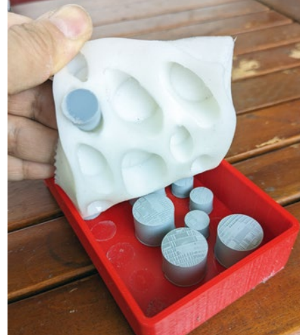
Langsam wird es richtig spannend: das Entformen beginnt
