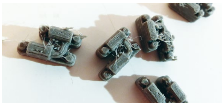
SLA-Druckdatei in FDM gedruckt, mit leichter Nacharbeit absolut brauchbar
