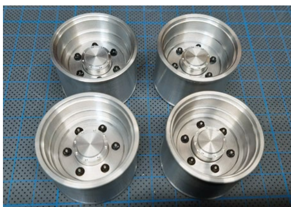
Selbstgedrehte Alufelgen und Achsnaben, montagefertig
