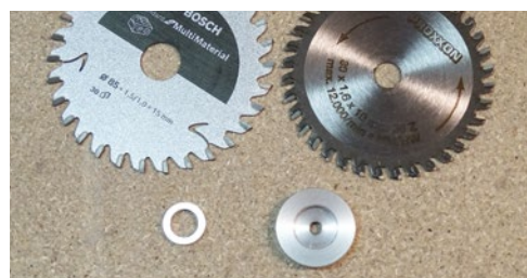
Vergrößerte Anpressplatte und Reduzierhülse für vielfältige Sägeblattwahl
