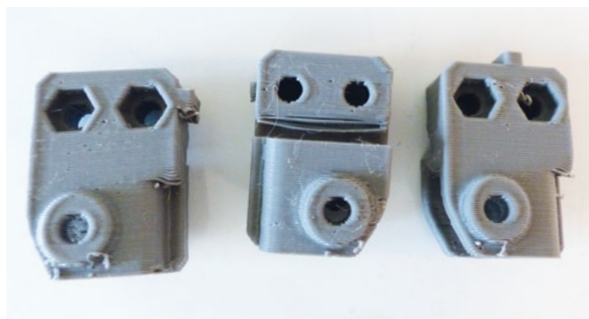
Die drei Achshalter mit verschiedenen Nuten und Passungen für eine bessere Teilezuordnung
