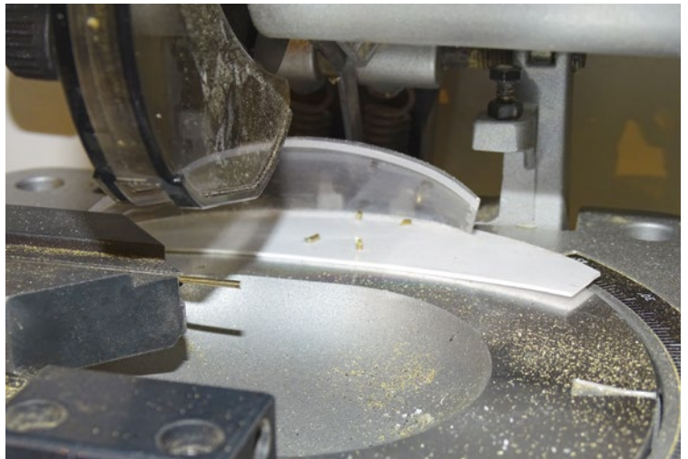
Die Fangeinrichtung ist schnell erstellt und hilft, die Kleinteile aufzufangen
