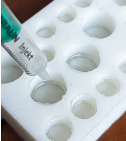
Das Epoxy wird in die Form geträpelt. Trotz Entgasen können sich Bläschen bilden
