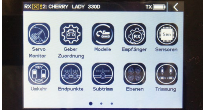
Das Display der Fernsteuerung hat eine Auflösung von 480 x 320 Pixeln
