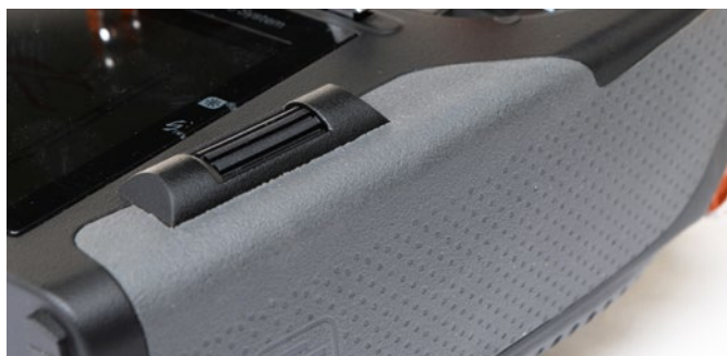
Die gummierten Griffflächen sollen dafür sorgen, dass der bisher größte NX-Sender sicher in der Hand liegt
