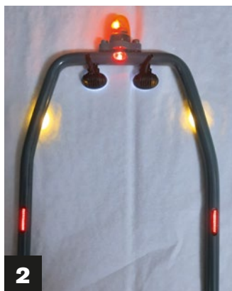
1) Der überarbeitete Überrollbügel in der Vorderansicht. 2) Der fertig bearbeitete Bügel ist durch mehrere Positions-, Brems- und Standlichter ergänzt
