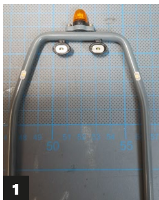
1) Der überarbeitete Überrollbügel in der Vorderansicht. 2) Der fertig bearbeitete Bügel ist durch mehrere Positions-, Brems- und Standlichter ergänzt
