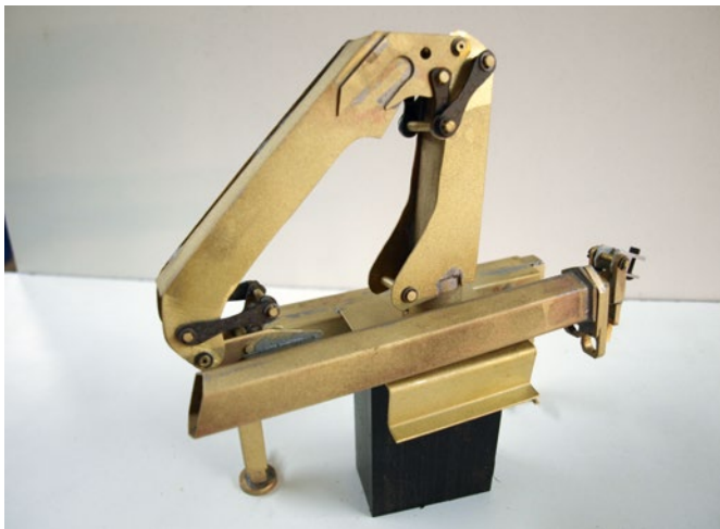
Hier ist der Kran auf die Grundplatte gestellt. Hier sind die Stützen, für den Kniehebel und Wellen eingebaut
