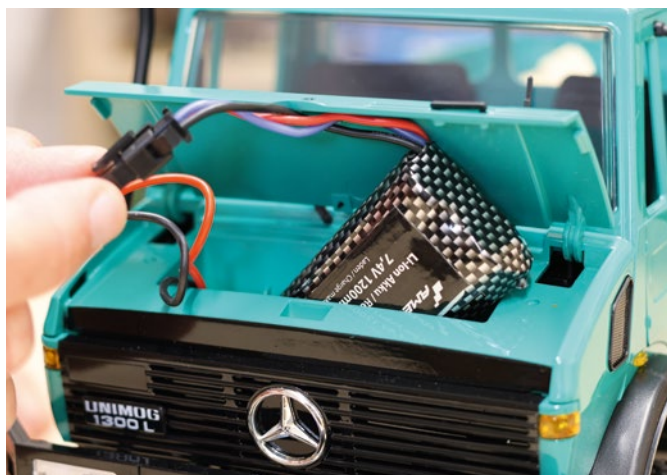
Unter der Motorhaube findet der 2s-Li-Ion-Akku in einer Wanne Platz. Das exotische Stecksystem kann jedoch nicht überzeugen
