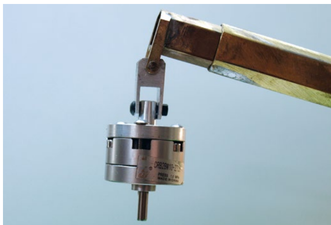
Hier ist der Schwenkzylinder für den Greifer des Eigenbaus zu sehen
