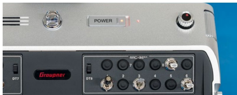
Klassischer Ein-Aus-Schalter. Ein weiterer Geberausbau für ein individuelles Setup ist durchaus möglich
