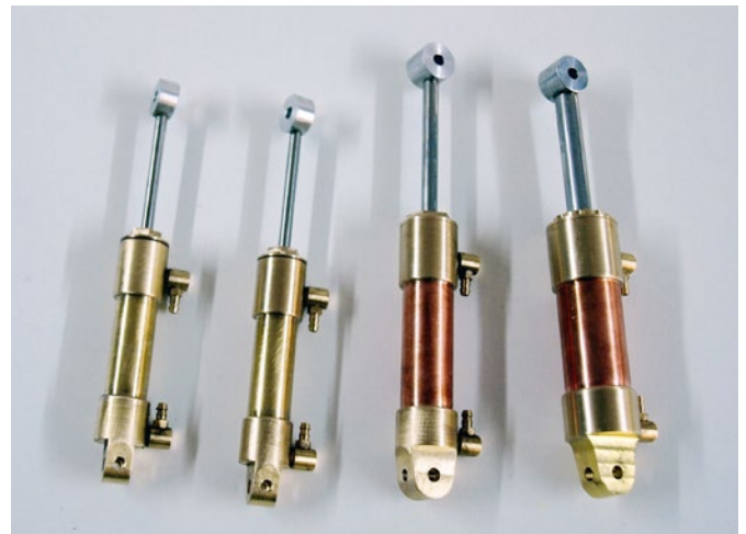
Das sind die Zylinder für die Stützen, für den Hubarm und für den Knickarm
