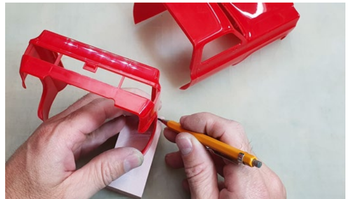
Die Karosserie muss ein Stück verlängert werden. Nach dem Durchsägen wurde die Kontur auf 800er-Kunststoffblockmaterial gezeichnet
