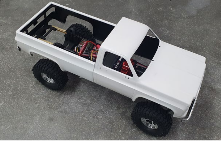
Die weiße Grundierung ist zweikomponentiger PUR-Lack, DB-555 von Hesse. Er überzeugt durch gute Fülleigenschaften und lässt sich super schleifen
