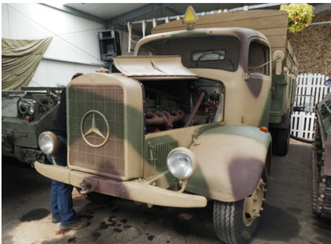
Angetrieben wird der L 4500 S von einem OM 67/4 Diesel mit 7.274 cm 3 Hubraum
