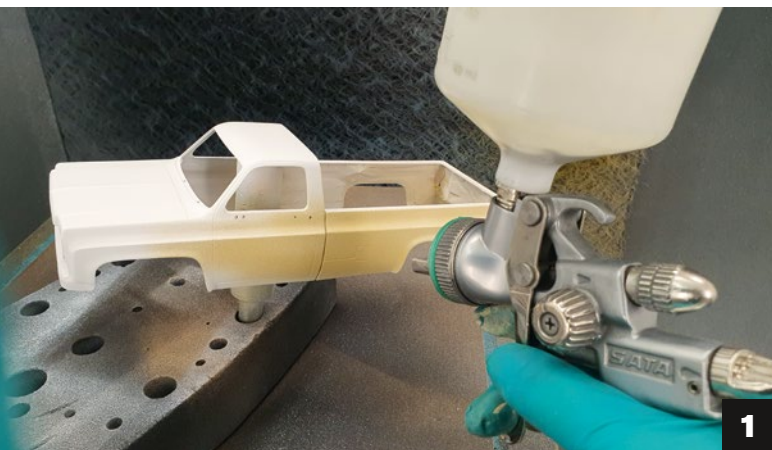
Die weiße Grundierung ist zweikomponentiger PUR-Lack, DB-555 von Hesse. Er überzeugt durch gute Fülleigenschaften und lässt sich super schleifen
