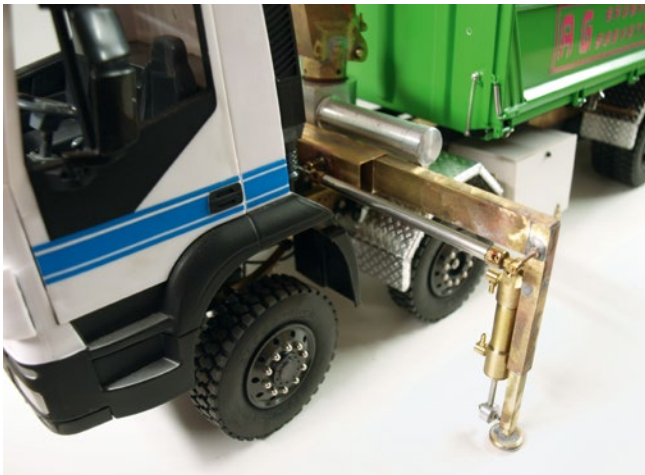
Die linke Stütze mit Zylinder und Ausschubzylinder
