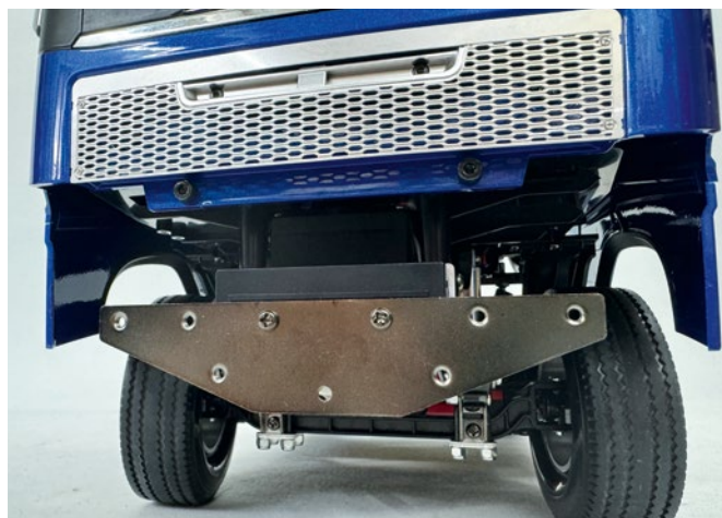
Über Nut und Feder wird das Fahrerhaus von hinten am Rahmen eingesetzt und vorne verschraubt
