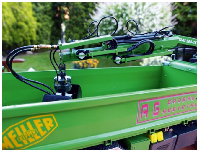
Gut zu sehen: die Schlauchführung an den Teleskopzylindern und zum Greifer
