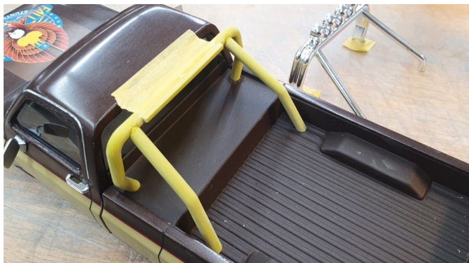
Der dreiteilige Bügel besteht aus 3D-gefrästem Kunststoffblockmaterial. Er wird am Modell passgenau zusammengefügt und letztendlich von innen angeschraubt
