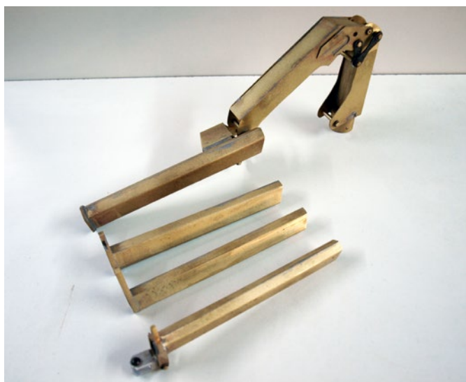
Der Kran mit Knickarm und den drei Ausschüben. Hier sind die Teile schon sandgestrahlt
