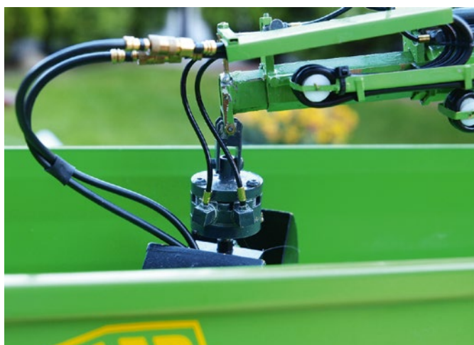
Der Schwenkzylinder mit den 2-mm-Schläuchen. Der Schwenkzylinder dreht 270°
