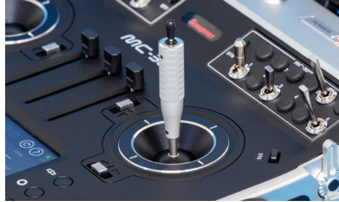
Präzise, fein auflösende, Alu-Kreuzknüppel mit Hallensensoren und integrierten Schaltern zeichnen die mc-32ex aus
