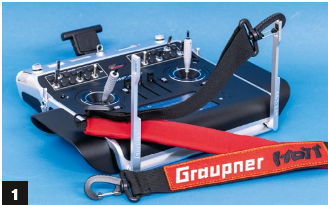
1) An den stabilen, im Gehäuse integrierten Tragebügeln lässt sich der angenehm zu tragende, mitgelieferte Nackenriemen einhängen. 2) Das Grundgehäuse der mc32-ex besteht aus Alu, in das hochwertige Kunststoffelemente eingefasst sind. Über den großen Rückendeckel hat man einen guten Zugang zum kompletten Innenausbau
