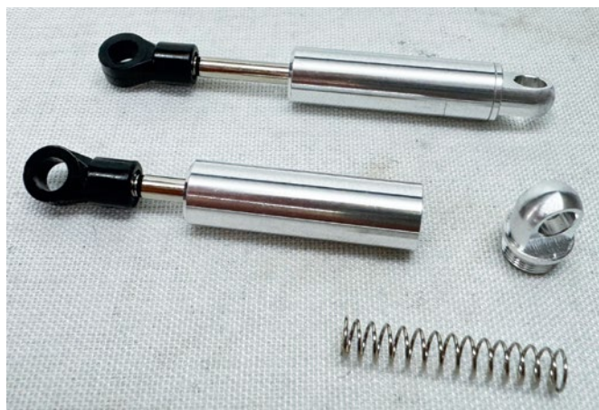
Die Stoßfängerattrappen werden vorne mit kleinen, innen liegenden Federn versehen
