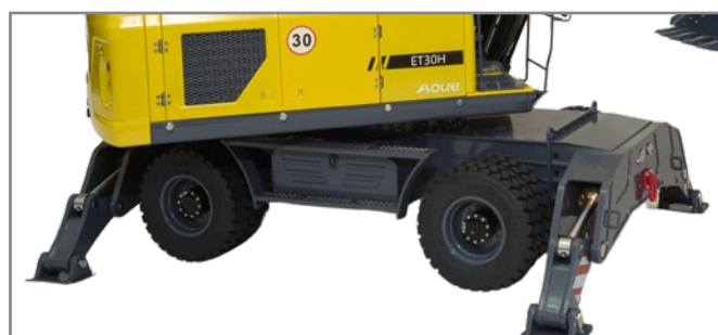
Für einen festen Stand des etwa 19 kg schweren Baggermodells sorgen die hydraulischen Abstützungen
