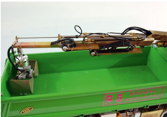
Schlauchführung seitlich am Knickarm zum Greifer
