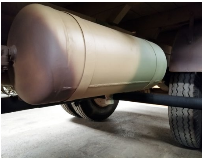
Der Tank des Lasters. 140 l Dieselkraftstoff passen in diesen Zylinder
