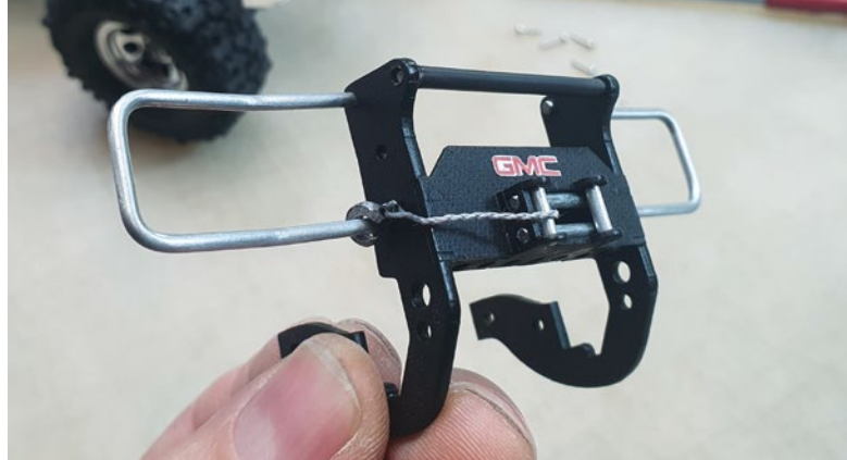
Der Rammschutz wurde aus 1-mm-Kraftplex-Plattenmaterial als Laserteilesatz konstruiert, schwarz lackiert und mit einem 2-mm-Nickeldraht-Bügel versehen
