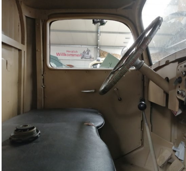
Die Rückbank baut man besser aus. Sonst quetscht das Steuerrad den Fahrer ziemlich ein
