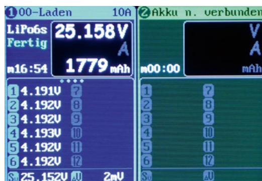
Der Anzeige ist zu entnehmen, dass der 6s-Akku voll aufgeladen und gut balanciert ist
