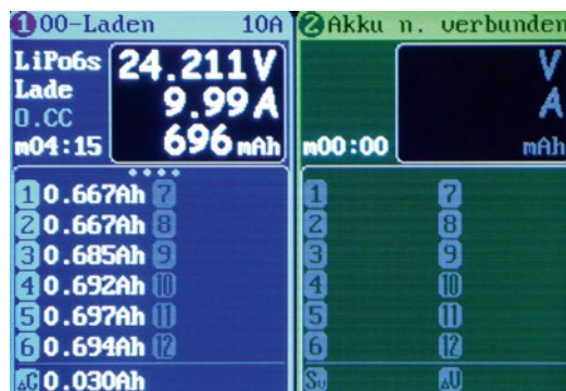
Auch die Anzeige der ge- oder entladenen Kapazität der einzelnen Zellen ist möglich
