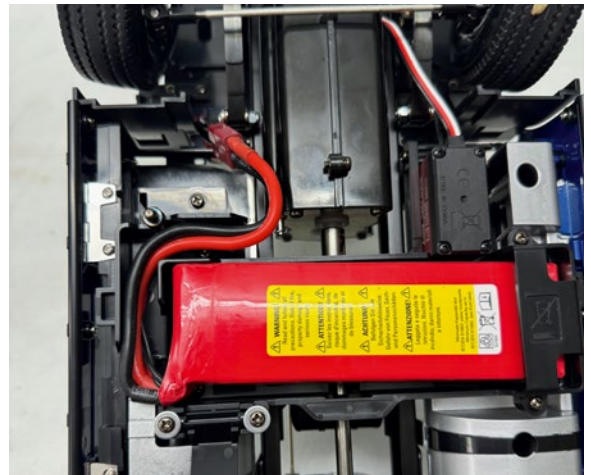
Um die Anschlusskabel des LiPo-Akkus vernünftig unterzubringen, muss das Akkufach etwas bearbeitet werden
