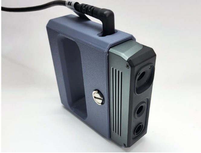
Der gedruckte Handhalter für den Scanner macht das Handhaben des Gerätes komfortabel
