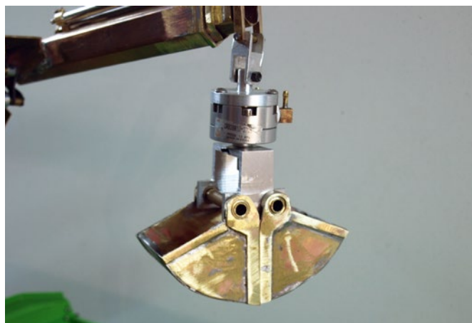
Griffbereit: der Schwenkzylinder mit angebautem Greifer
