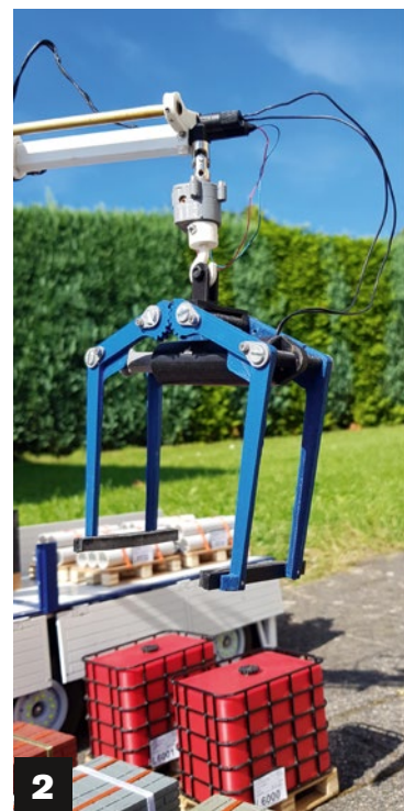
1) Durch ein Kardangeln wird der Haken mit dem Kran verbunden und ist nach unten hin frei beweglich. 2) Mit der gedruckten Palettenzange kann an einem Fahrtag ordentlich Ladegut aufgenommen werden
