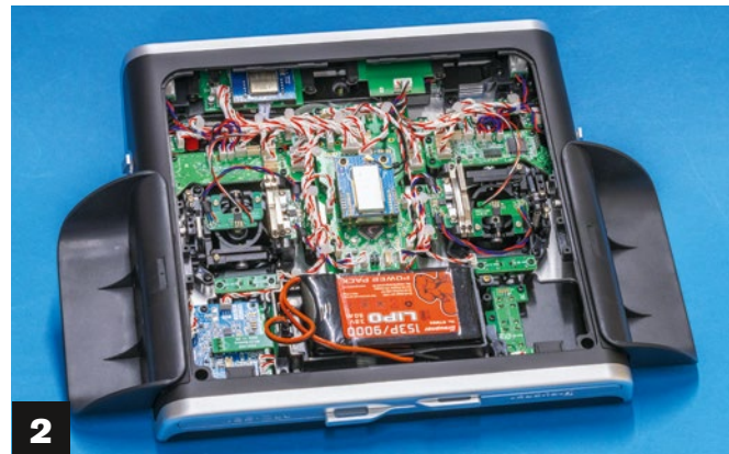
1) An den stabilen, im Gehäuse integrierten Tragebügeln lässt sich der angenehm zu tragende, mitgelieferte Nackenriemen einhängen. 2) Das Grundgehäuse der mc32-ex besteht aus Alu, in das hochwertige Kunststoffelemente eingefasst sind. Über den großen Rückendeckel hat man einen guten Zugang zum kompletten Innenausbau
