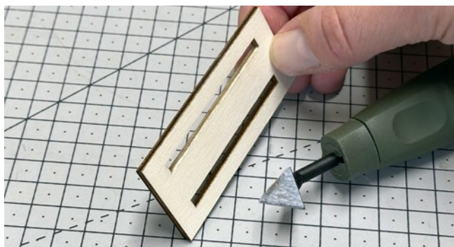
Die von Abbrand befreite Oberfläche lässt sich jetzt besser kleben
