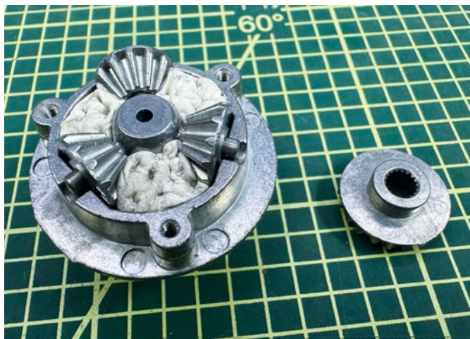
Das Differenzialgehäuse wird mit Fotopad-Knetmasse befüllt, um eine Teilspernung der Achsen zu erlangen
