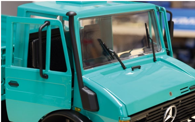
Charakteristisch für den Unimog ist der Schnorchel
