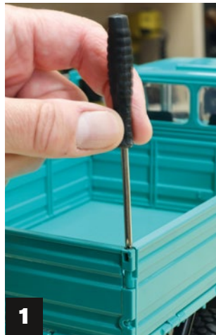
1) Alle Wangen werden gegen unbeabsichtigtes Öffnen über eine feine Blechschraube gesichert – sind also jedes Mal zu lösen und zu verschließen. 2) Selbst geladertes Ladegut – siehe Bericht xTool M1 in TRUCKS & Details 2/2024
