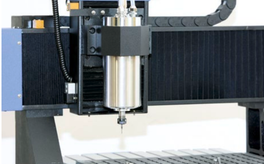
Die bullig gefertigte Z-Achse sorgt für eine solide Halterung der HF-Spindel. Die schwarzen Faltenbälge sorgen für Schutz vor Verschmutzung
