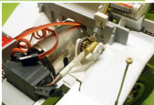
Die Lenk-rad-Mitdrehmechanik mit ihren Zahnrädern im Detail
