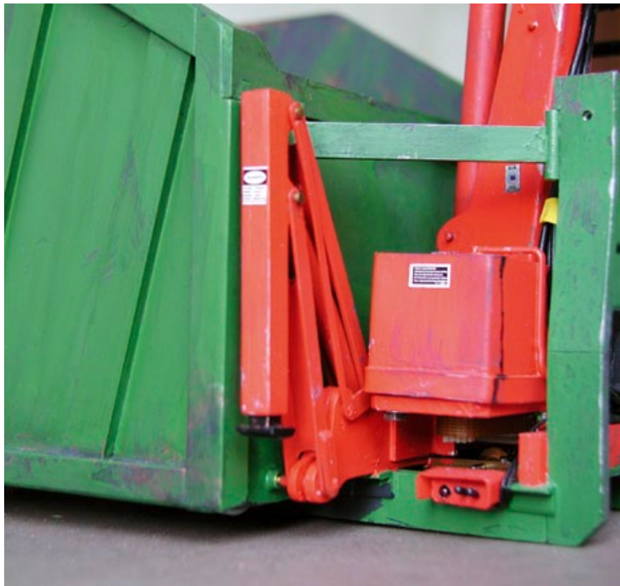
Wer genau hinsieht, erkennt unter dem Hydrauliktank den Zahnriemen für die Drehbewegung und die Messingwelle
