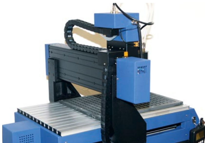
An allen Achsen sind die Schrittmotoren durch einen zusätzlichen Kasten vor Beschädigungen jeglicher Art geschützt. Gut zu sehen ist auch die durchdachte Führung der Energieketten
