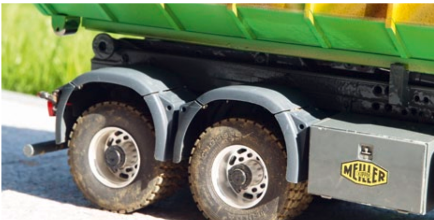
Pendelachse, daneben die Kiste mit den Ventilen und darüber die Mulde
