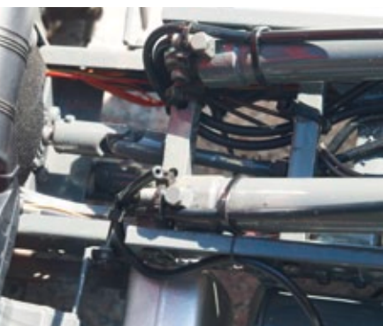
Hier die Aufhängung der Zylinder, darunter die Antriebswelle vom Motor zum Verteilergetriebe
