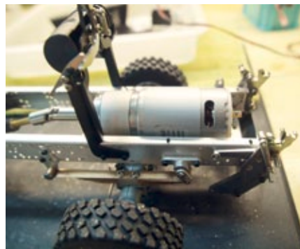
Rechts sind die Fahrerhauslager, daneben im Rahmen der Getriebemotor und die Halterung für das Fahrerhaus
