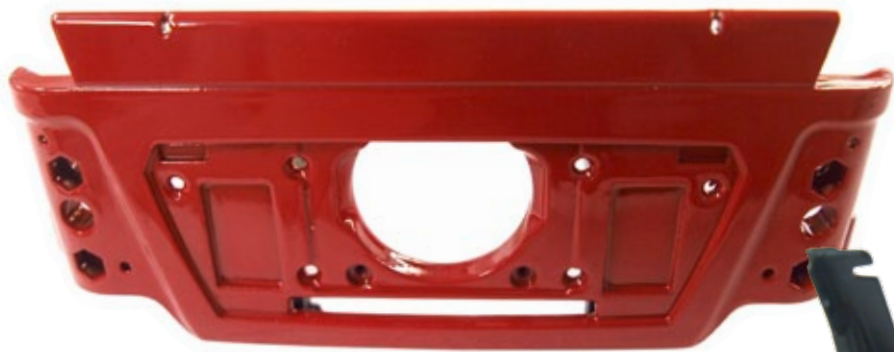
Das Frontteil des MAN, das Loch in der Mitte ist für den Lautsprecher vorgesehen
