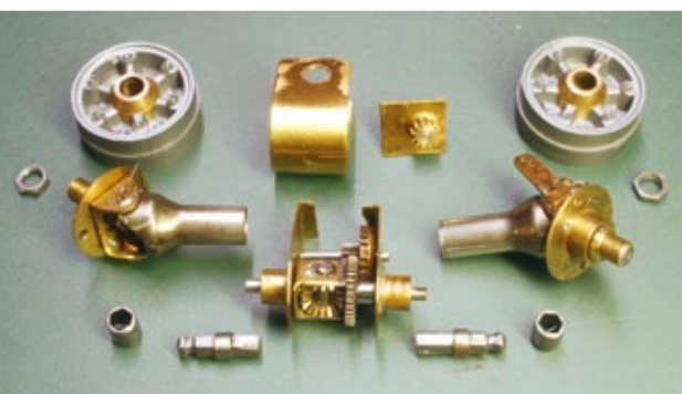
Warten auf den Lötkolben; Komponenten der angetriebenen Lenkachse
