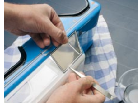
Mit ruhiger Hand, Spüli-Wasser und einer Pinzette werden die Scheibenaufkleber aufgebracht und gut angerieben, damit auch die letzten Luftblasen verschwinden
