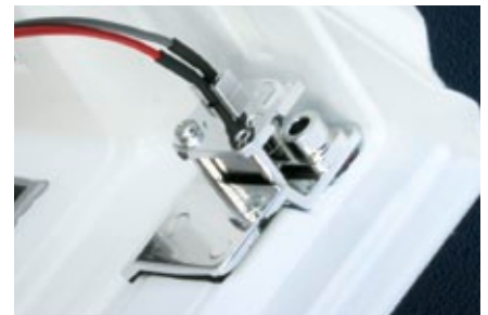
Die Halter für die LED der Rückleuchten werden mit Doppelklebeband an die Karosserie geklebt. Die LED selbst sind mit Schrauben in den Haltern befestigt und können leicht ersetzt werden
