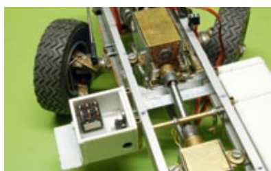
Sechskant-Kugelköpfe machen die Gelenkwellen nahezu wartungsfrei
