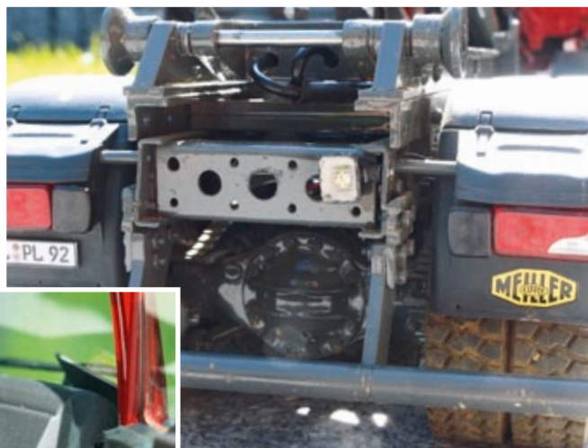
Details am Heck: Der zusätzliche Rückfahr-scheinwerfer sorgt für ausreichend Licht
