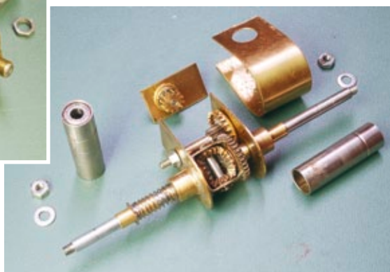
Warten auf den Lötkolben; Komponenten der angetriebenen Lenkachse
