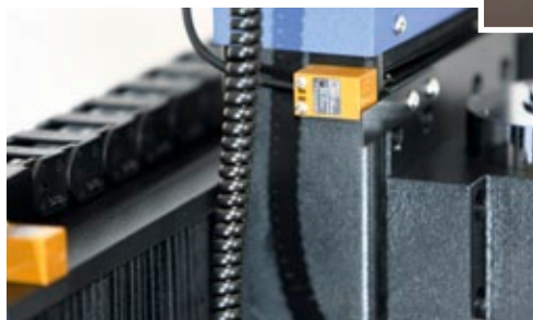
Der Endlagenschalter, der dem Schutz von Maschine, Werkstück und Nutzer dient
