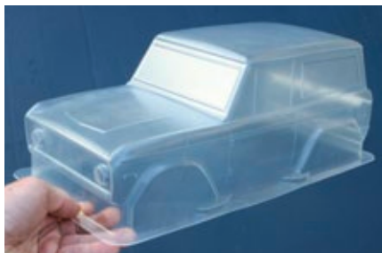
Die Karosserie aus transparentem Lexan gibt die charakteristische Form des Ford Bronco sehr gut erkennbar wieder
