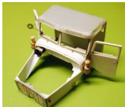
Das Haus bekommt ein Gesicht. Ein Kleinstgetriebemotor treibt die Scheibenwischer später an
