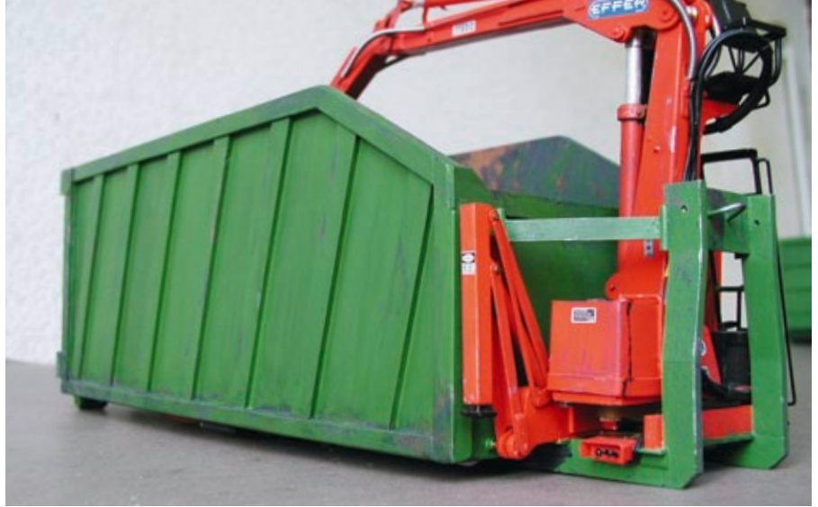
Beim abgelegten Container sieht man sehr gut, wie der Kran am Schlitten montiert ist
