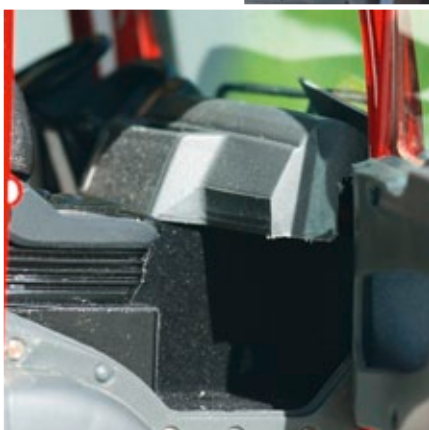
Schleifspuren am Armaturenbrett. Dieses war werksseitig etwa 2 Millimeter zu lang. Mittlerweile ist dieser kleine Schönheitsfehler vom Hersteller beseitigt
