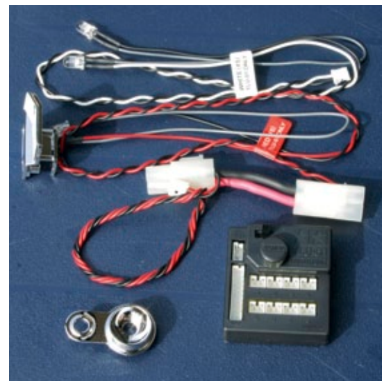
Das mitgelieferte Beleuchtungsset, bestehend aus zwei weißen LED für vorne und zwei roten für die Rückleuchten. Die Lichteinheit sorgt für die Stromversorgung der LED aus dem Fahrakku und bietet Anschlussmöglichkeiten für acht Lichtkreise
