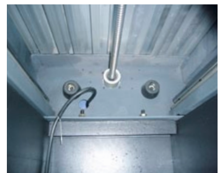
Endlagenpuffer, je eine Kugelumlaufführung pro Seite und eine doppelt kugelgelagerte Trapezgewindespindel für den Antrieb zeugen von der ausgesprochen hohen Fertigungsqualität der KH 0504
