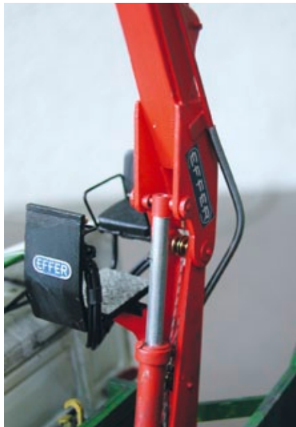
Das gestreckte Hauptarmgelenk zeigt die Seilführung zum Knickarmzylinder
