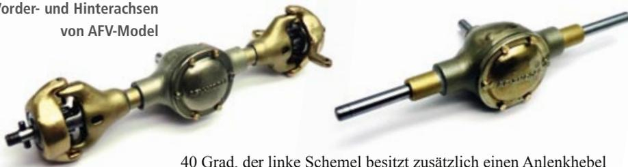
40 Grad, der linke Schemel besitzt zusätzlich einen Anlenkhebel vor dem Rad. Die Achsbreite der Vorderachse beträgt 83 Millimeter zuzüglich jeweils 5 Millimeter Achswellen und 3 Millimeter Mitnehmerstift. Die Hinterachse hat eine Breite von 45 Millimeter plus 16 Millimeter Achswellen und 3 Millimeter Mitnehmerstift. Beide Achsen sind auf Durchtrieb erweiterbar. Der Preis: 49,- Euro für die Hinterachse beziehungsweise 165,- Euro für die Vorderachse.
