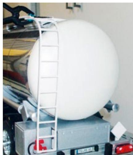
Den Abschluss bildet ein Kunststoffdeckel. Alternativ kann man hier auch Tiefziehteile aus Eigenfertigung anbringen
