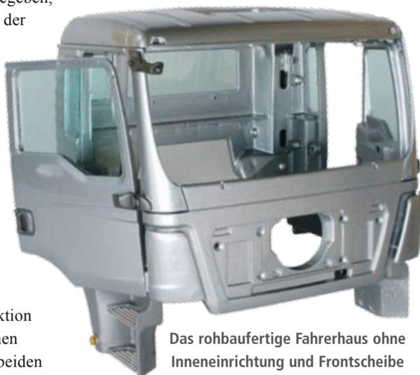
Das rohbaufertige Fahrerhaus ohne Inneneinrichtung und Frontscheibe
