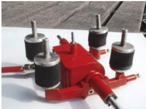
Bei der ausgebauten Hinterachse ist das Gehäuse des Differenzials gut zu erkennen
