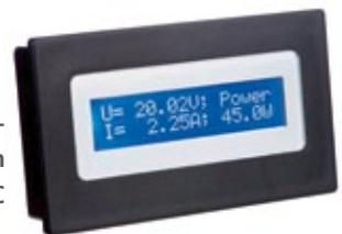
Das LCD Digital-Power-Panel-Meter von H-TRONIC kann zwischen Akku und Regler geschaltet werden und gibt auf seinem zweizeiligen Display die gemessenen Strom-, Spannungs- und Leistungswert aus. Die Messspannung liegt zwischen null und 40 Volt, der Strommessbereich beträgt bis zu 20 Ampere. Das Gerät mit den Abmessungen von 84 x 44 x 28 Millimeter kostet 59,95 Euro.
