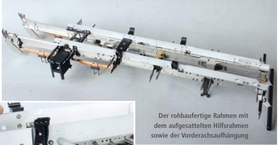
Der rohbaufertige Rahmen mit dem aufgesattelten Hilfsrahmen sowie der Vorderachsaufhängung
