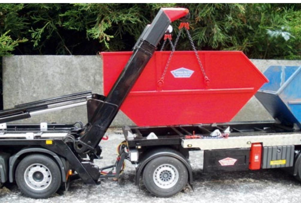
Bei der axialen Ausrichtung werden die Teleskoparme zu Hilfe genommen
