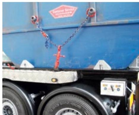
Die Zurrketten und Anschlagblöcke zur Ladungssicherung wurden vorbildgetreu ausgeführt. Rechts unten ist die Bedienungsbox für die Liftachse
