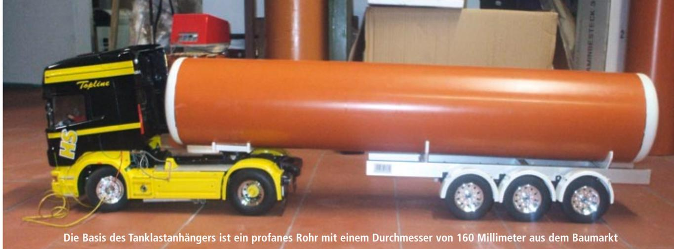
Die Basis des Tanklastanhängers ist ein profanes Rohr mit einem Durchmesser von 160 Millimeter aus dem Baumarkt
