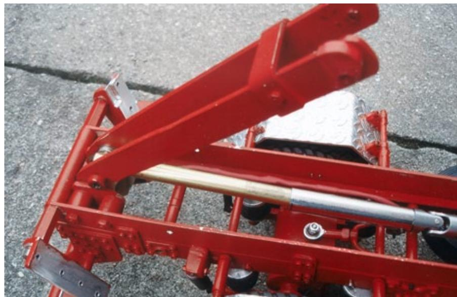
Der Kippmechanismus ist als Hydraulikzylinder getarnt, innendrin befindet sich eine Spindel
