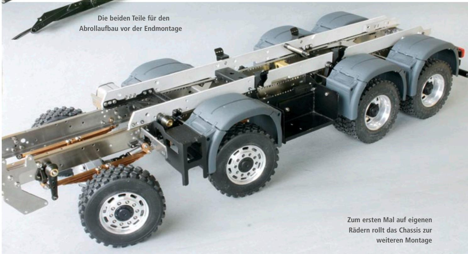
Zum ersten Mal auf eigenen Rädern rollt das Chassis zur weiteren Montage
