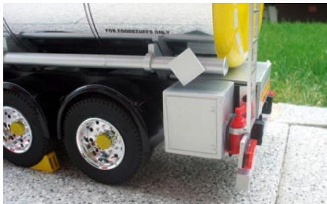
Bevor der Aufbau fest auf dem Chassis montiert wird, sollte man noch die Kabel für die Rückleuchten entsprechend verlegen
