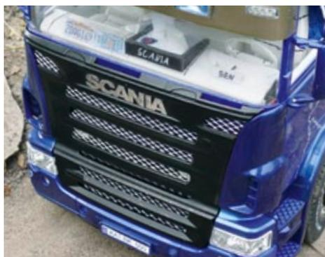
Beim Blick ins Fahrerhaus sind verschiedene kleine Elemente wie beispielsweise der Bilderrahmen auf der schwarzen Halterung auf dem Armaturenbrett zu erkennen. Diese wurden aus Polystyrol gefertigt
