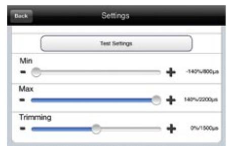
Beispiel aus dem Konfigurationsmenü: Hier können Servowege und die Trimmung justiert werden
