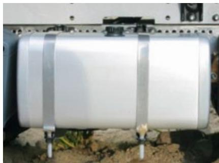
Der Hydrauliktank mit integrierter Pumpe zwischen den Achsen; das vordere Band muss für die Optik noch etwas nach rechts versetzt werden
