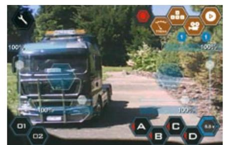
Livebild von der Kamera. Die beiden Joysticks mit den Trimmhebeln befinden sich mittig. Oben rechts finden sich Startknopf und Kameraschalter. Unten links befinden sich die zwei Manöverschalter. Rechts unten kann man die Betriebsspannung ablesen
