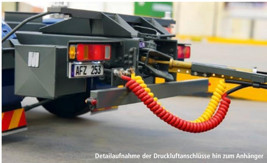
Detailaufnahme der Druckluftanschlüsse hin zum Anhänger
