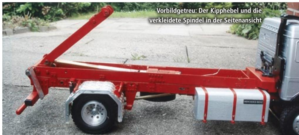
Vorbildgetreu: Der Kipphebel und die verkleidete Spindel in der Seitenansicht
