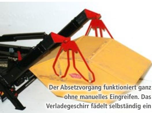
Der Absetzvorgang funktioniert ganz ohne manuelles Eingreifen. Das Verladegeschirr fädelt selbständig ein
