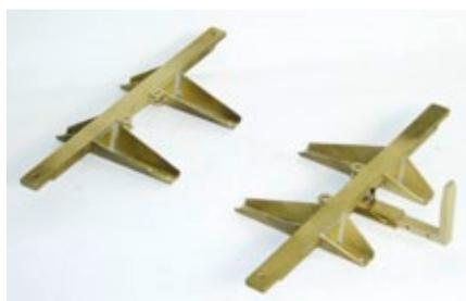
Die Containeraufnahmen wurden aus 10 x 5-Millimeter-Messingflachmaterial hergestellt. Die vordere (rechts) verfügt über einen verstellbaren Anschlag
