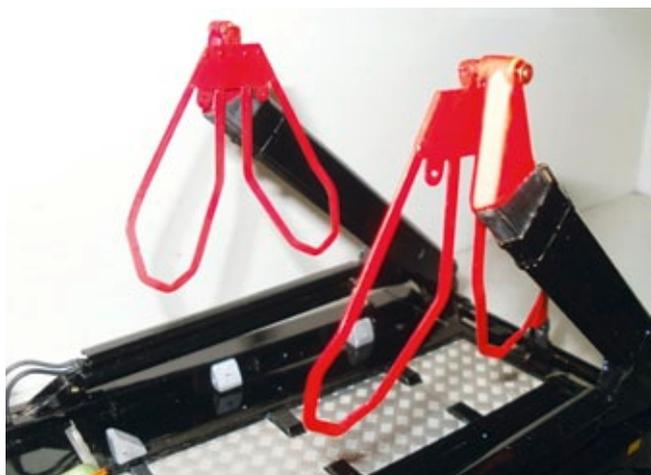
Aus 0,5-Millimeter-Messingblech ist dieses Verladegeschirr angefertigt. Die kardananische Aufhängung erlaubt Bewegungen in alle Richtungen
