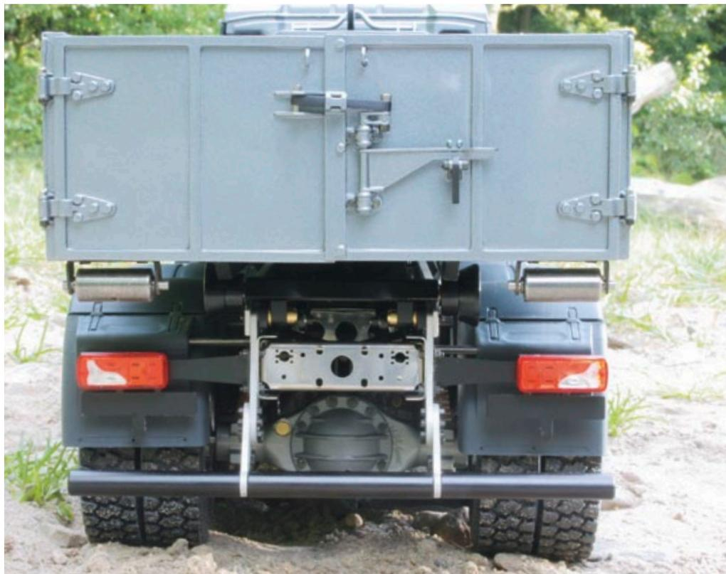
Die Verschlussmechanik der Hecktüren an der Mulde ist auf diesem Bild gut zu erkennen
