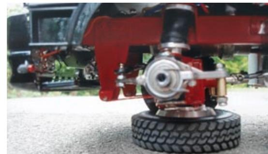
Wie beim Vorbild wird die Aufhängung der Vorderräder an Längslenkern mit Luftbälgen gefedert. Beim Modell handelt es sich allerdings um Imitate aus Moosgummi
