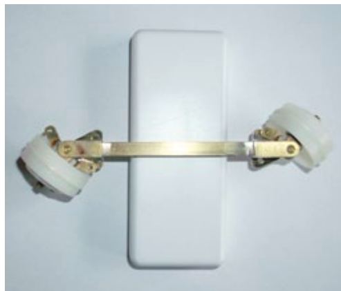
Die Achsschenkel wiederum bestehen aus 8-Millimeter-Vollmaterial, an die Halter für die Anlenkung gelötet wurden
