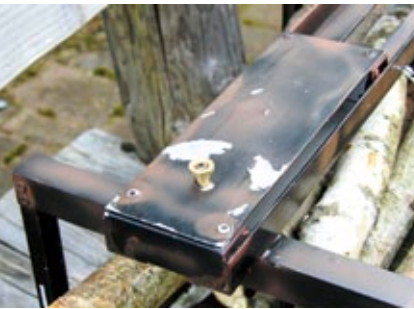
Der aus Messing gedrehte Königsbolzen auf einer Stahlblechplatte
