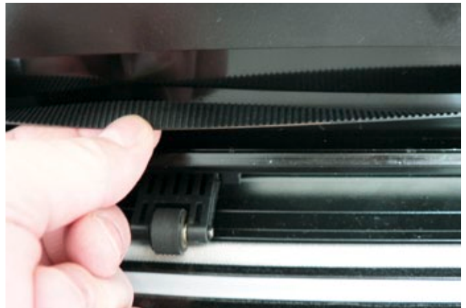
Die Ansteuerung der beiden Achsen erfolgt über unterschiedlich lange Riemen, wobei der beim Messerschleifen genutzte Riemen über einen Spannmechanismus zur Reduktion des Spiels verfügt
