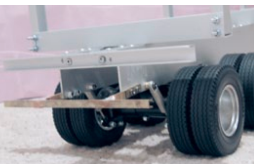
Heckansicht im Rohbau – Rücklichttraverse und Rangierbügel
