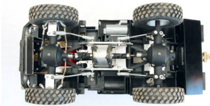
Das U-Profil und das Getriebe wurden nachträglich eingefügt
