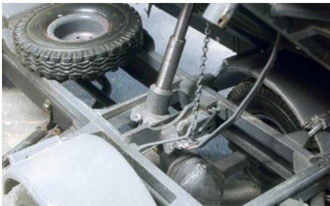
Blick auf die untere Kippspindellagerung; die äußerste Gewindehülse taucht in die kardanische gelagerte Aufnahme ein und wird mit der Madenschraube arretiert. Die Kette löst die obere Endabschaltung aus, das zweiadrige Kabel versorgt den Kipptrieb mit Strom
