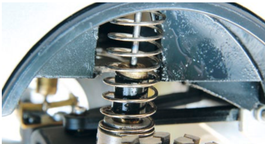
Die Dämpfer entstanden im Eigenbau
