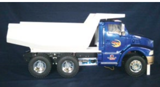
Steinmulde für Tamiya-Modelle aus Polystyrol vom RC-Bruder
