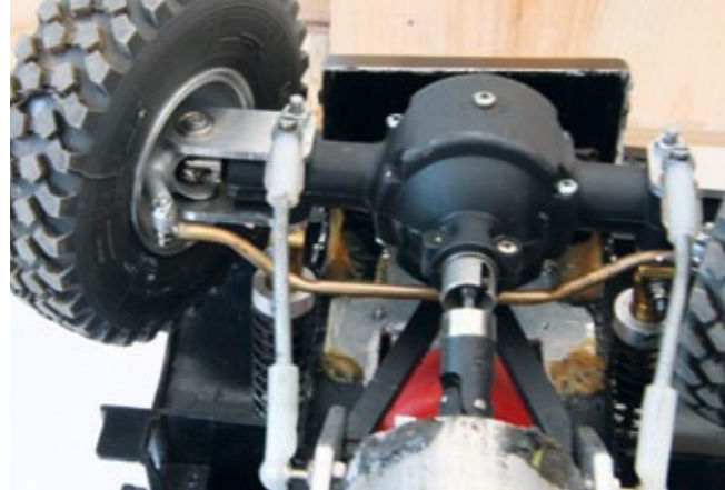
Durch einen Umbausatz der Firma AFV wurden die Panther-Achsen schmalere
