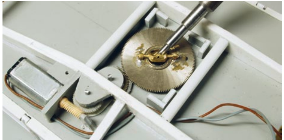
Kippantrieb in bewährter, platzsparender Manier: Motor unter Kipppritsche, Schneckenantrieb zur Drehzahlreduzierung bei gleichzeitiger Änderung der Drehebene, Stirnradstufen zur weiteren Reduktion und Distanzüberbrückung, kardanisch gelagerte Aufnahme des Spindelkopfs
