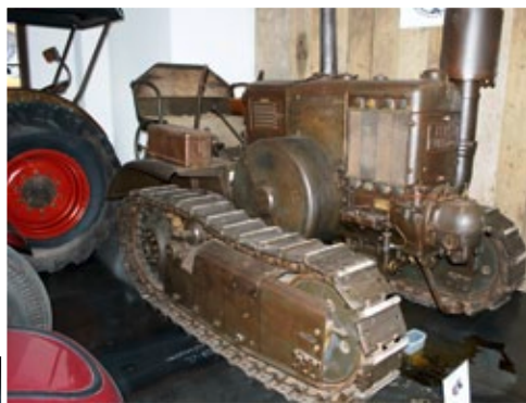
Das Lanz HRK55-Raupenfahrzeug wurde zum Pflügen bei schweren Böden oder in schwierigem Gelände eingesetzt
