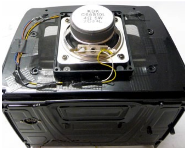
Der Lautsprecher kann für die bessere Optik im Innenraum von oben auf das Fahrerhausinnendach geschraubt werden
