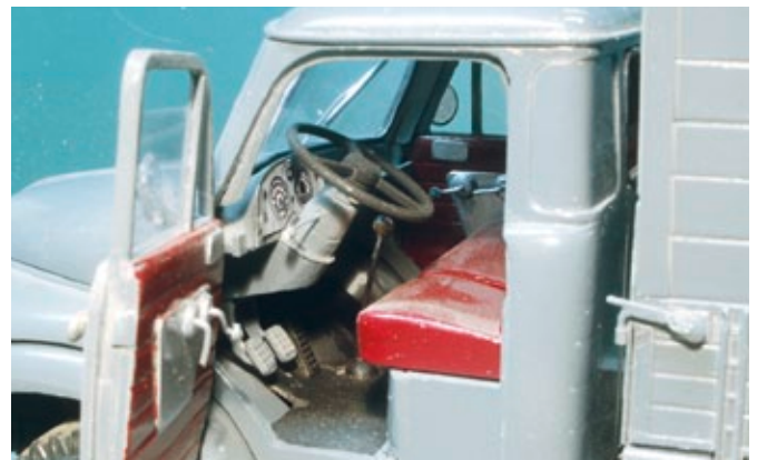
Für Mitte der 1950er-Jahre ein ergonomisch und optisch ansprechender Arbeitsplatz. Zwar ist der Fahrersitz noch nicht separat gefedert, jedoch erlaubt die abgelenkte Lenksäule schon eine flachere Position des Lenkrads
