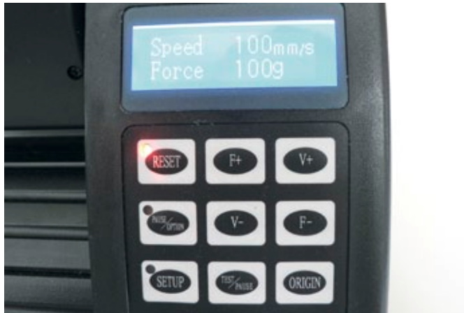
Neben sauberer Datenvorbereitung der zu schneidenden Datei sind vor allem der Anpressdruck und die korrekte Geschwindigkeit entscheidend für ein gutes Ergebnis
