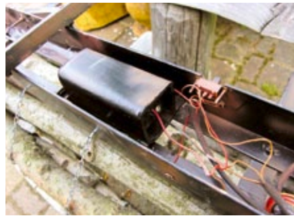
Selbstgebauter Akkusacht aus Kunststoffplatten
