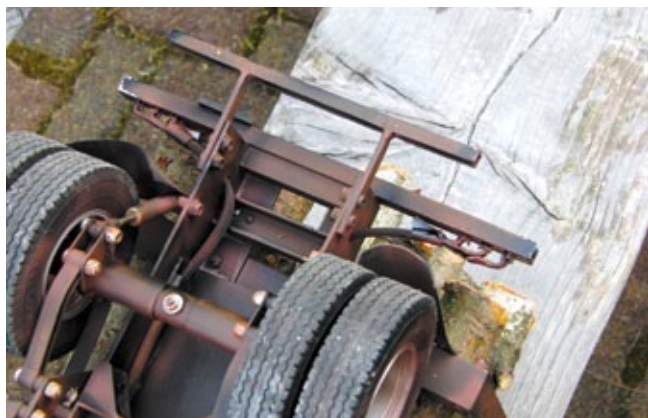
Die Zuleitungen der LED verschwinden in den Gewebeschläuchen aus dem Flugmodellbau
