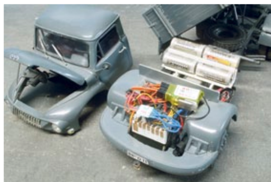
Unter der Sitzbank bunkerte auch das Vorbild seinen Treibstoff. Sechs NiMH-Zellen sind für den leichten Laster ein mehr als ausreichender Energievorrat. Unter der geöffneten Haube schaut der im Motorraum rechts anmontierte Wischerantrieb hervor
