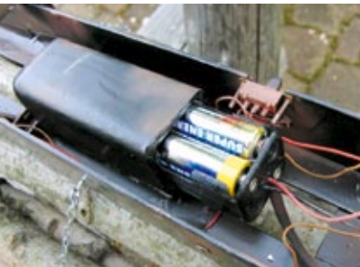
Vier Mignonzellen als Energiespender für die zehn LED
