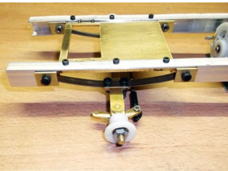
Rahmen mit Vorderwagen zur Aufnahme und Federung der Achse
