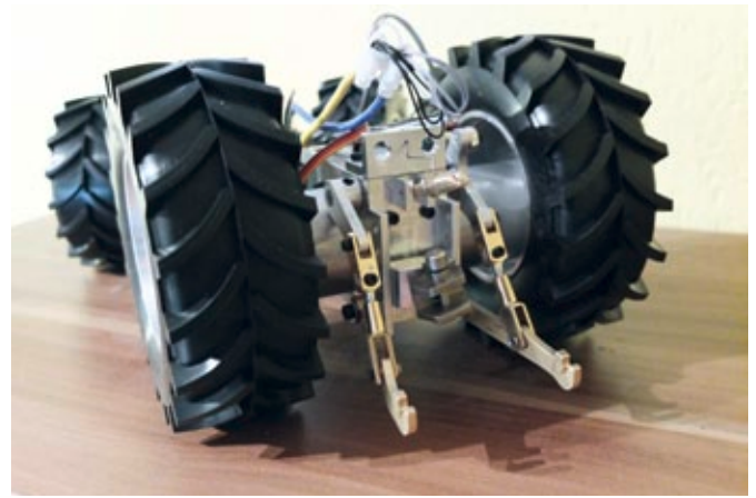
Zu sehen ist das komplettierte Heck mit abgesenktem Kraftheber
