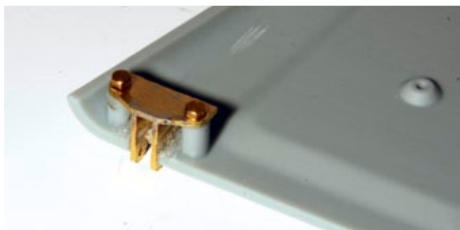
Die verlötete Befestigung für die TD5-Motorhaube wird von unten an den Guss geschraubt
