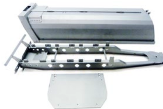
Aus zusammengepunkteten, gelaserten Stahlblechteilen sind Fahrgestell und Kippmulde hergestellt
