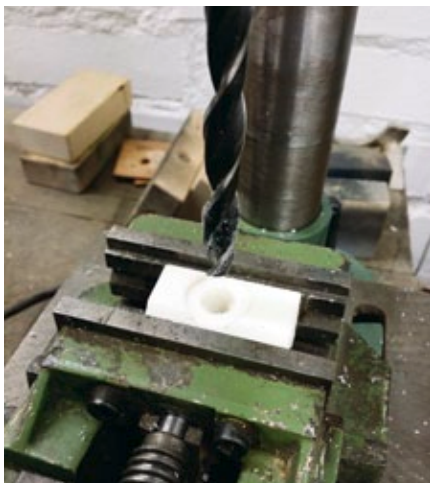
Die gedruckten Fertigteile müssen unbedingt nachgearbeitet werden
