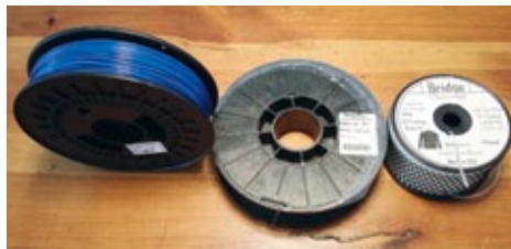
Die unterschiedlichen Druckmaterialien werden auch Filament genannt. Von links nach rechts sieht man PLA, ABS und Nylon
