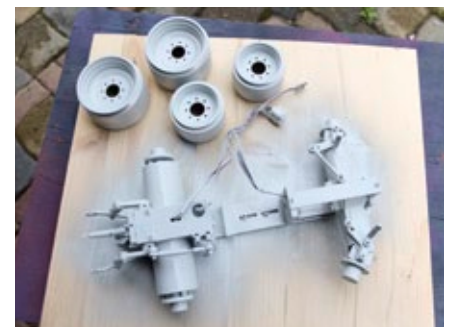
Chassis und Felgen wurden mehrfach grundiert
