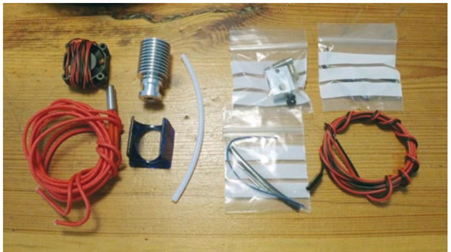
Ein unerlässliches Upgrade ist das Ganzmetall-Hotend, hier das viel gelobte E3D vor der Montage
