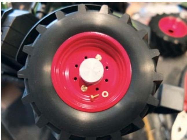
Mit acht kleinen M4-Messingschrauben werden die Felgen an ihre Aufnahmen geschraubt
