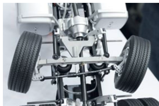
Die neue lenkbare Vorlaufiftachse ist aus Metall gefertigt und kostet inklusive Stehr-Luftfedersystem 220,- Euro
