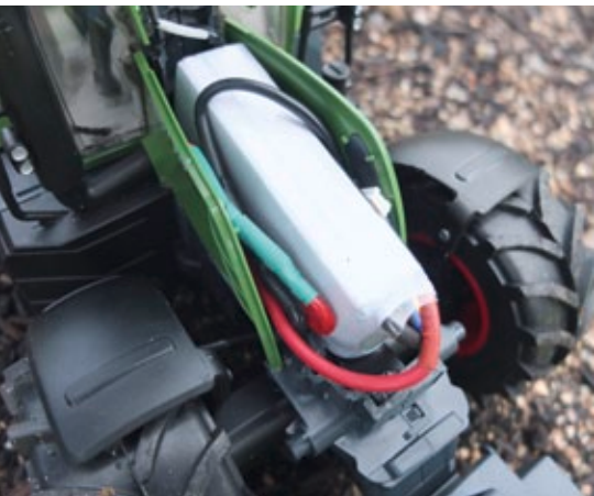
Der 3s-LiPo findet unter der Motorhaube seinen Platz
