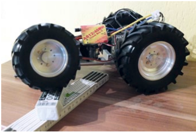
Die Vorderachse hat einen enormen Pendelweg, um Unebenheiten auszugleichen
