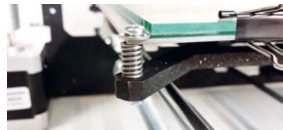
Die Druckfeder der Heizbettbefestigung ist für die Nivellierung wichtig
