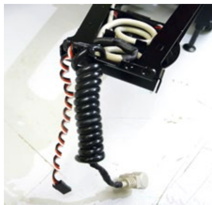
Das Servokabel vom Umpolsschalter kann man jetzt noch durch die Spirale führen um es unsichtbarer zu machen
