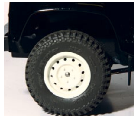
Die Bezeichnung MT steht für „Mud-Terrain“. Diese Reifen eignen sich für das grobe Gelände
