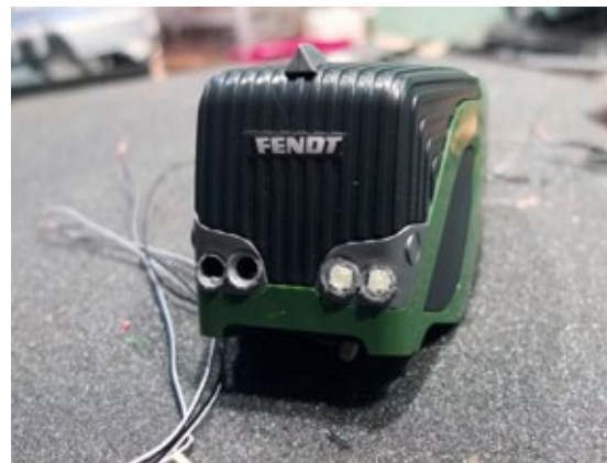
Nichts für dicke Finger: der Einbau der Beleuchtung mittels SMD-Bauteilen ist schwierig
