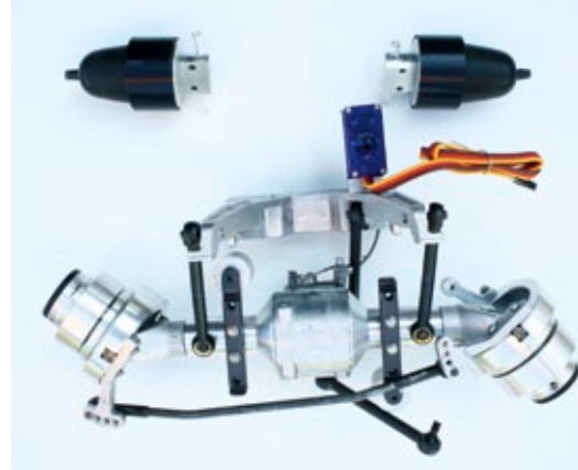
Die hier abgebildete, angetriebene Lenkachse mit Differenzialsperre wurde auch von Jürgen Schmid entwickelt
