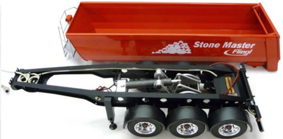
Die Mulde ist soweit vorbereitet. Am Fahrgestell müssen noch die Kabel verlegt werden und es fehlt noch der Getriebemotor für den Kippspindelantrieb
