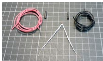
Konfektionierung: Die Kabel müssen am Thermistor selbst verlötet werden
