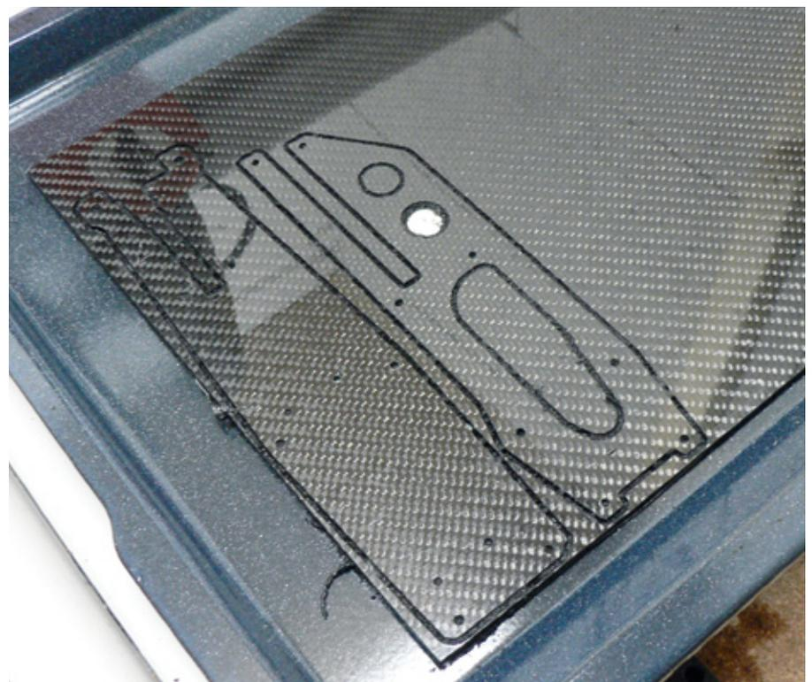
Mit der leistungsstarken HF-Spindel macht vor allem das Fräsen von CFK-Teilen erheblich mehr Spaß. Die besser nutzbaren höheren Geschwindigkeitsbereiche ermöglichen zudem ein rascheres Bearbeiten dieses sehr abrasiven Materials
