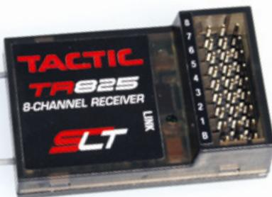
Der Diversity-Empfänger des Typs TR825 verfügt durch die beiden Antennen über eine hohe Betriebssicherheit
