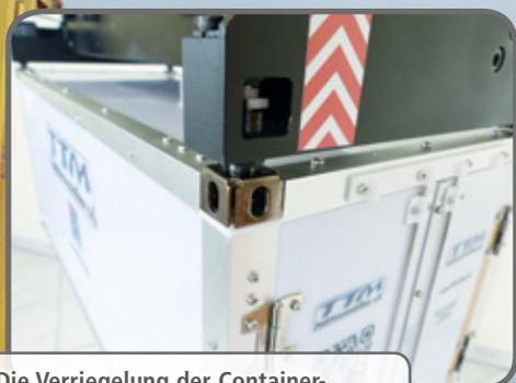
Die Verriegelung der Container-Aufnahme vor dem Transport erfolgt ferngesteuert über vier Miniservos
