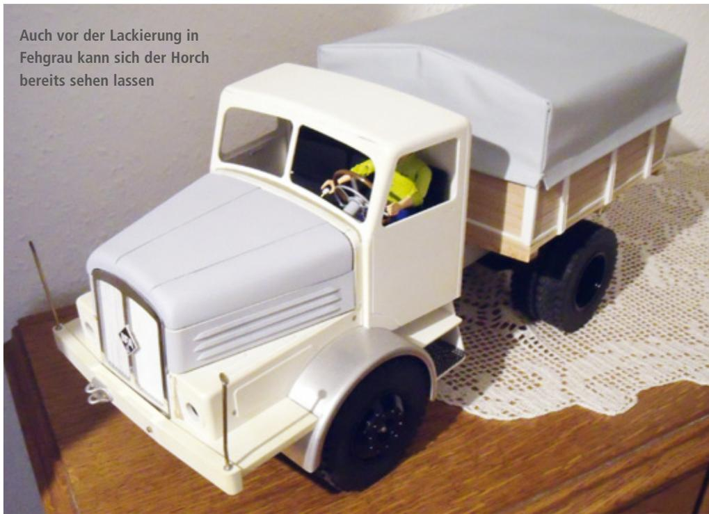
Polaroid-Blitzlicht. Die Fassungen der vorderen Blinker sind ebenfalls ein Produkt der heimischen Drehbank. Nach und nach fanden noch diverse Anbauteile ihren Platz, sodass das Modell nun auch Scheibenwischer und Winker bekam, beides allerdings ohne Funktion. Das typische Logo des Kraftfahrzeugwerks „Ernst Grube“ aus Werdau sowie
