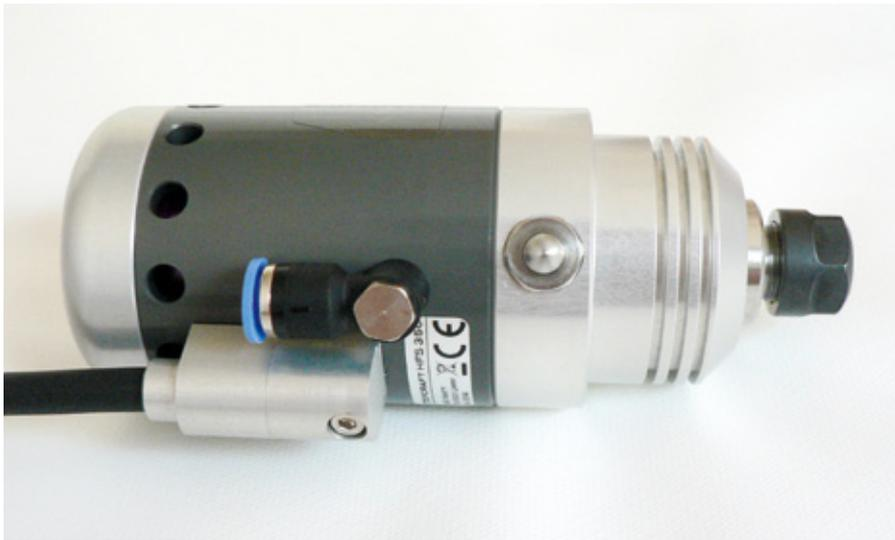
Die Spindel selbst gibt keine Rätsel auf. Neben der Stromversorgung über den DIN-Anschluss von der Steuerbox verfügt das Gehäuse nur noch über den Sperrluftanschluss und einen Sperrdrücker zum Arretieren der Welle beim Werkzeugwechsel
