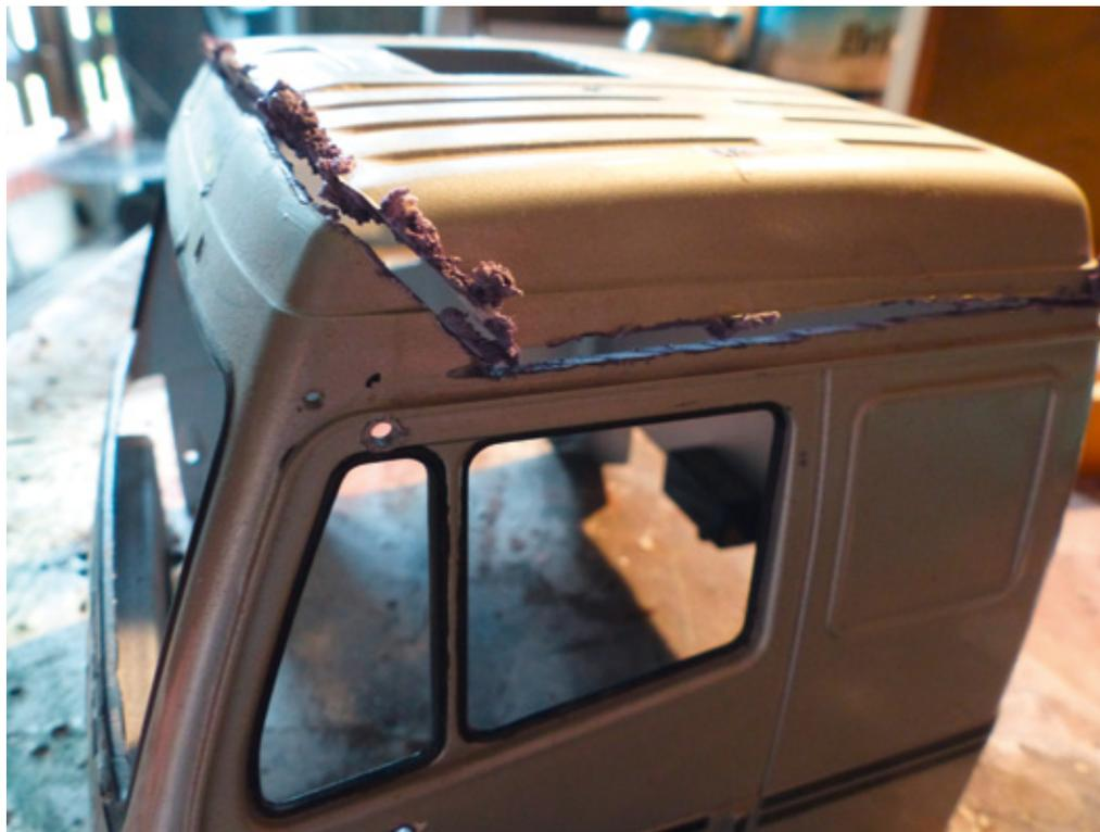
Oberhalb der angedeuteten Regenrinne wurde der ersten Trennschnitt angesetzt
