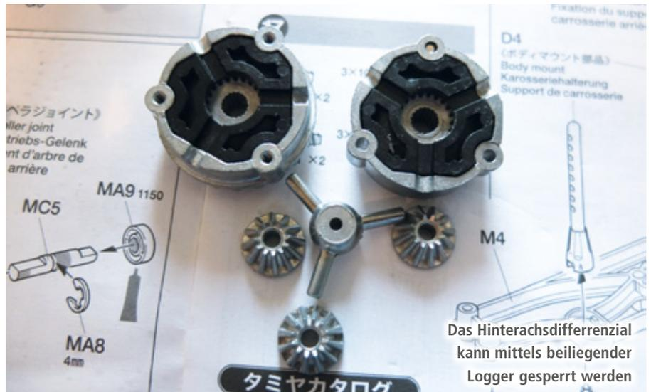
Das Hinterachsdifferenzial kann mittels beiliegender Logger gesperrt werden
