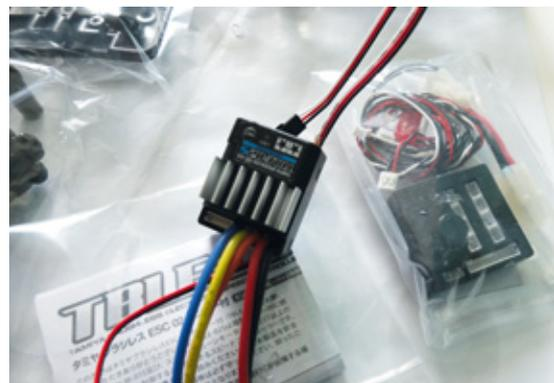
Fahrregler für NiMH- und LiPo-Akkus sowie eine Lichteinheit gehören zum Baukasten
