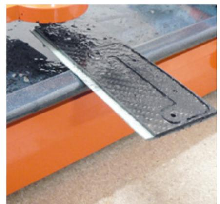
Beim Fräsen im Schmierbad und ohne Stege oder Schrauben gibt es natürlich auch Tücken bei der Befestigung, denn sofern sich ein Bauteil beim Fräsen löst, ist dieses unwiederbringlich beschädigt. Wer mehr mit Holz arbeitet, kann derart „nasse“ Verfahren ohnehin nicht nutzen und sollte lieber Spannhebel oder Spannpratzensets samt optionalem T-Nuten-Spanntisch verwenden
