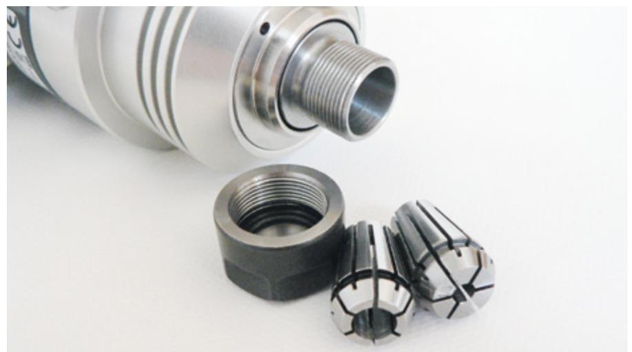
Die Spannzangenaufnahme ist im ER11-Standard gehalten und ermöglicht daher das Spannen nahezu aller auf dem Markt befindlichen Frässtifte von 1 bis 6 Millimeter Durchmesser
