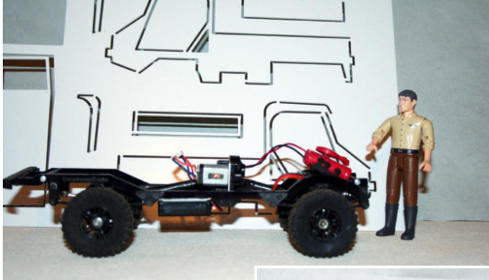
Der Rahmen ist etwas zu lang für die Frästeile
