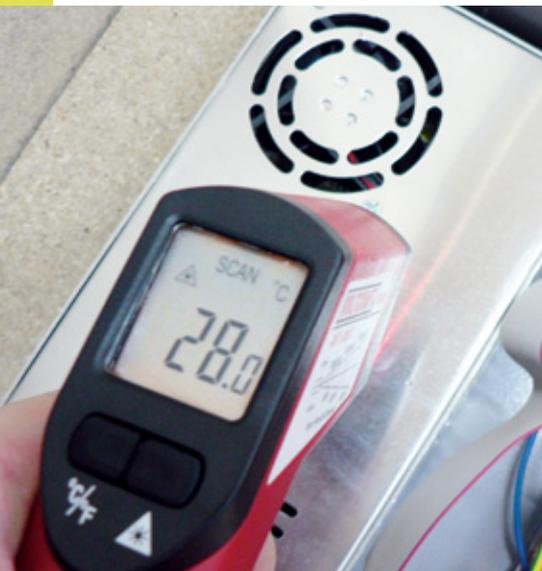
Direkt nach einer mehrstündigen Belastung wurde die Steuerbox geöffnet, um die Temperatur direkt an den Bauteilen zu messen. Das Netzteil weist mit 28 Grad Celsius sogar einen noch geringeren Wert auf als der Motorcontroller mit knapp über 44 Grad – beides absolut unkritische Werte
