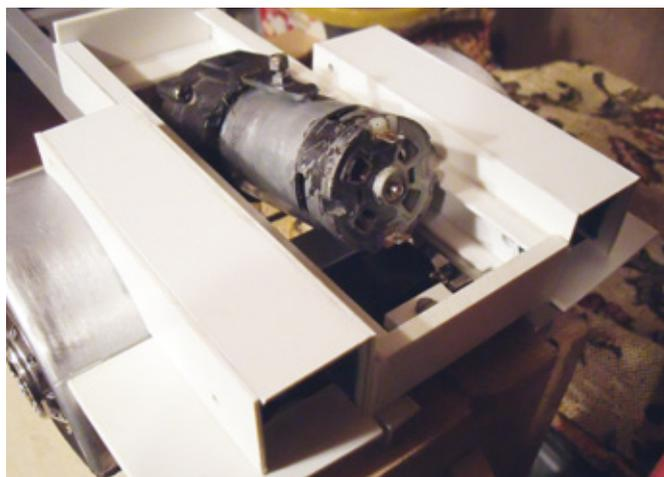
Der Motor wurde schräg eingesetzt. Dadurch passt er perfekt unter die bullige Motorhaube des Horch
