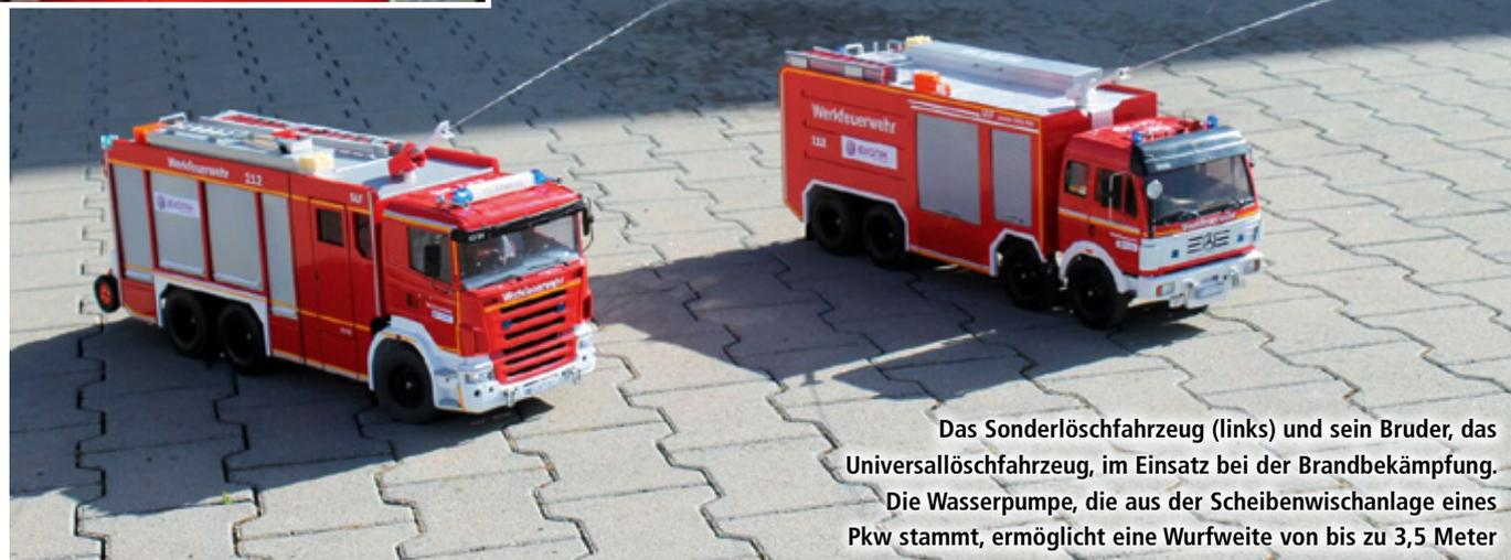
Das Sonderlöschfahrzeug (links) und sein Bruder, das Universallöschfahrzeug, im Einsatz bei der Brandbekämpfung. Die Wasserpumpe, die aus der Scheibenwischanlage eines Pkw stammt, ermöglicht eine Wurfweite von bis zu 3,5 Meter
