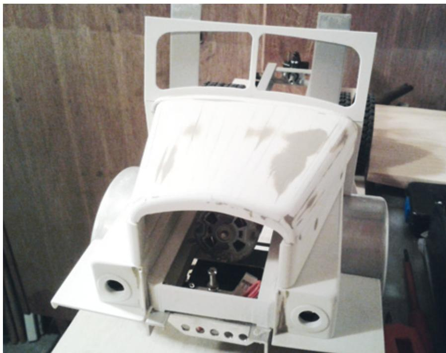
Die Karosserie wurde größtenteils aus Polystyrol gefertigt. Der Kühlergrill ist abnehmbar, sodass der Motor besser erreicht werden kann
