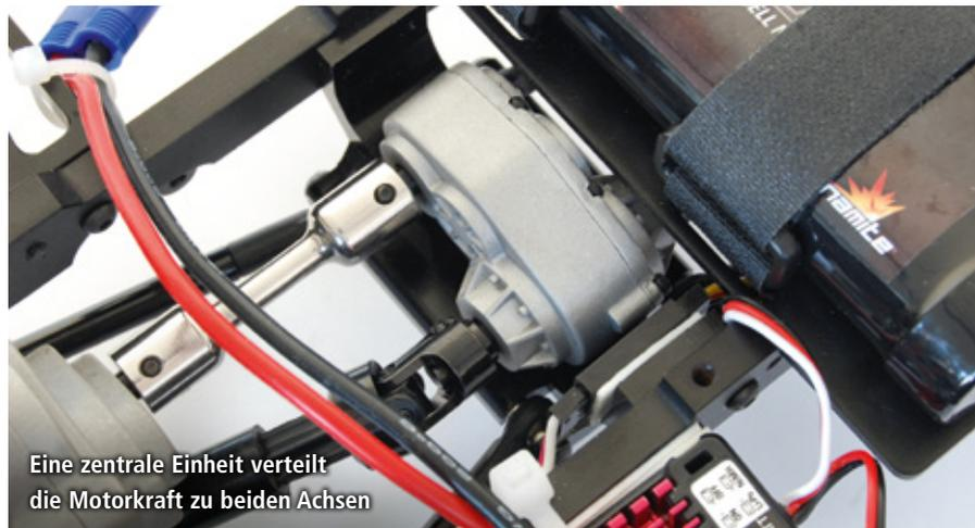
Eine zentrale Einheit verteilt die Motorkraft zu beiden Achsen
