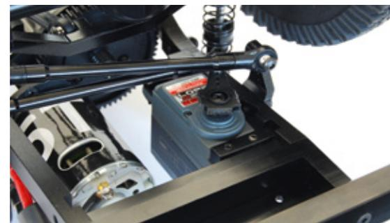
Das hängend verbaute Lenkservo bewegt die Räder über eine Alu-Lenkstange. Davor sieht man den Panhard-Stab, der die Achse führt
