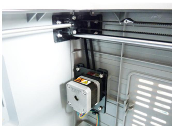
Der Antrieb erfolgt über kleine Stepper-Motoren, deren Kraft an der X- und Y-Achse via S2M-Riemen übertragen wird. Die besonders feine Verzahnung der Riemen sorgt für die nötige Wiederhol- und Stellgenauigkeit des Extruders
