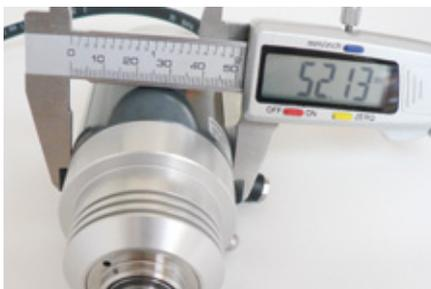
Die kompakte Bauweise des Gehäuses behindert zu keiner Zeit die Arbeiten an der Maschine oder dem Werkstück. Zur optimalen Aufnahme ist der Hals der Spindel mit 43 Millimeter Durchmesser gefertigt und passt so auch an andere Maschinen
