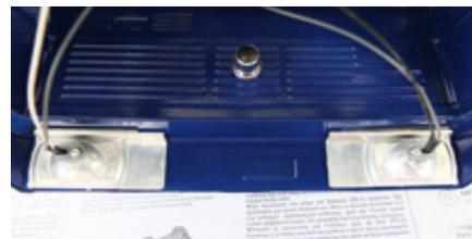
Für die Scheinwerfer und Rücklichter sind Reflektoren und Halter für die LED im Bausatz enthalten
