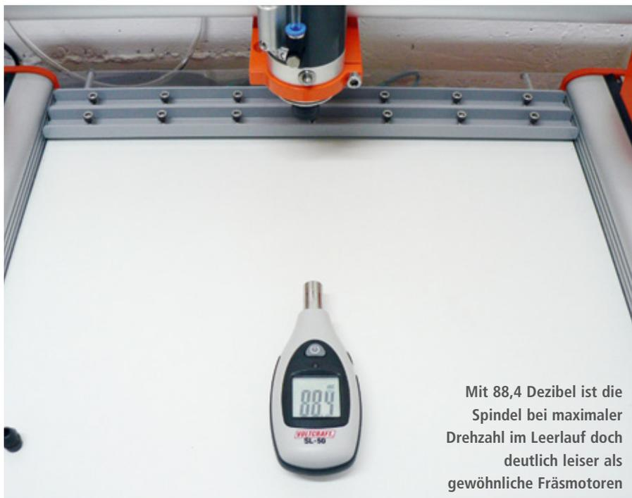
Mit 88,4 Dezibel ist die Spindel bei maximaler Drehzahl im Leerlauf doch deutlich leiser als gewöhnliche Fräsmotoren
