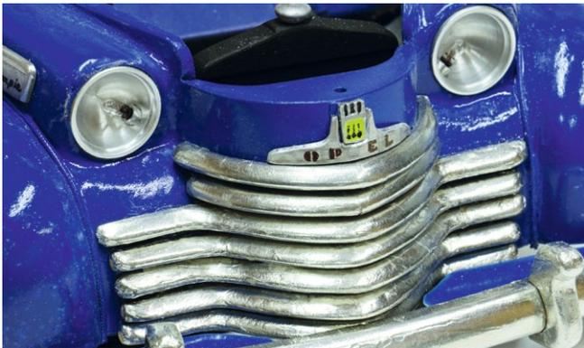
Der Kühlergrill wurde mit einer speziellen Folie verchromt
