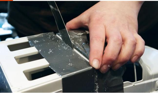
Die Fahrerkabine wird mittels einer Japan-Säge vom Sleeper-Aufbau getrennt
