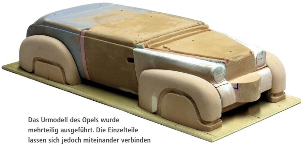
Das Urmodell des Opels wurde mehrteilig ausgeführt. Die Einzelteile lassen sich jedoch miteinander verbinden
