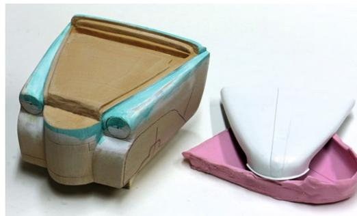
Einzelteile wie die Motorhaube wurden auf der Masterform mit Hilfe von Knetsilikon geformt
