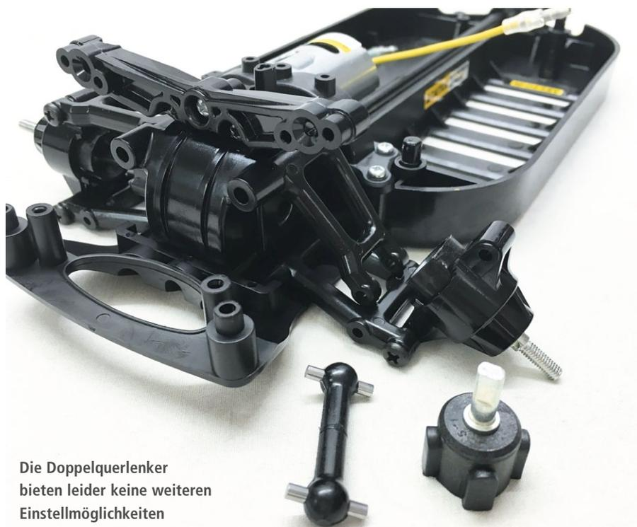
Die Doppelquerlenker bieten leider keine weiteren Einstellmöglichkeiten
