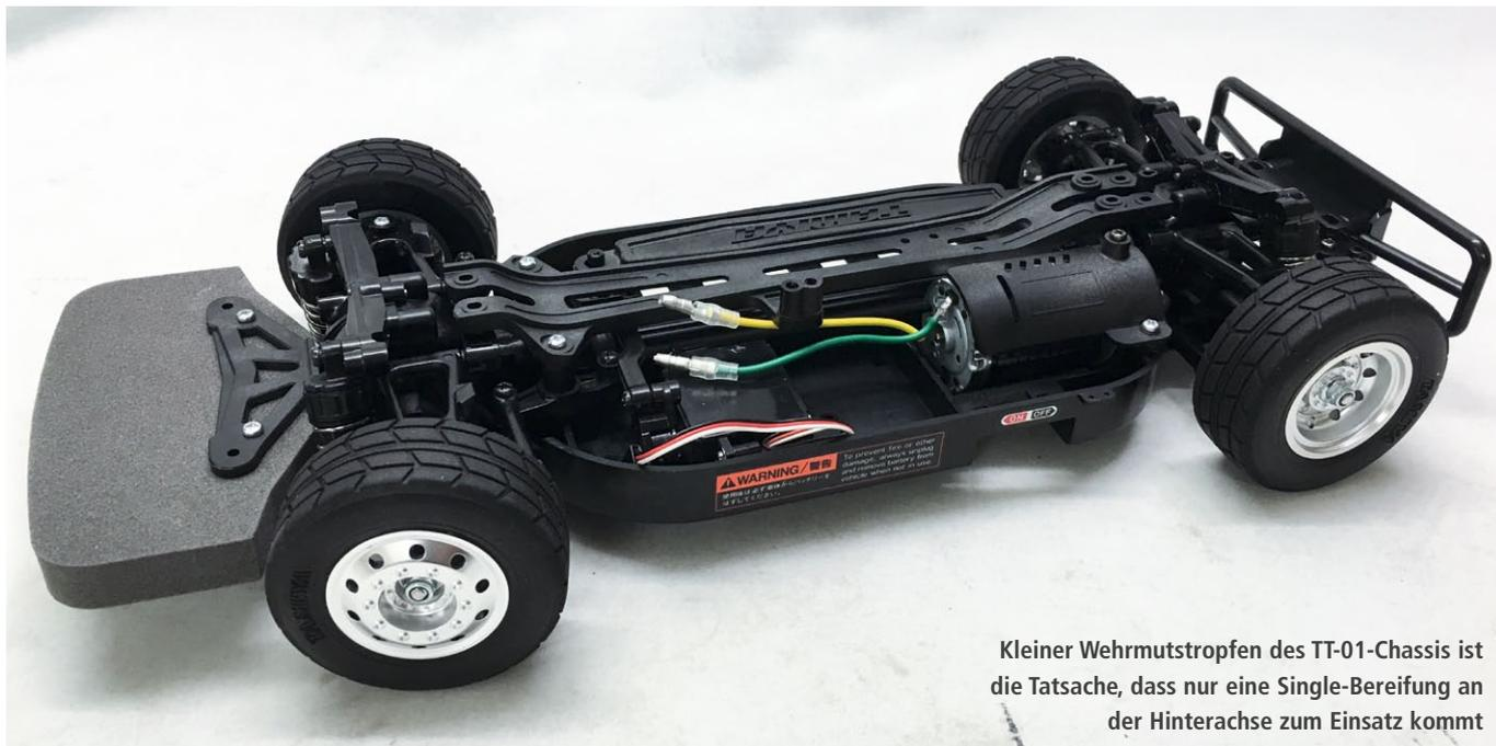
Kleiner Wehrmutstropfen des TT-01-Chassis ist die Tatsache, dass nur eine Single-Bereifung an der Hinterachse zum Einsatz kommt
