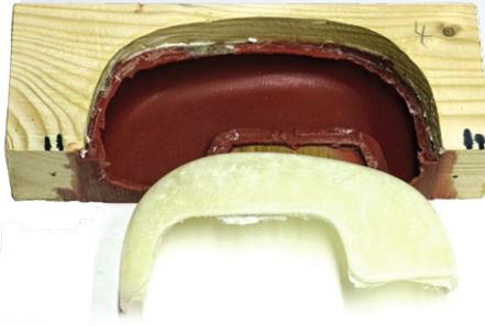
Mit Negativ-Formen wurden auch die Kotflügel abgegossen
