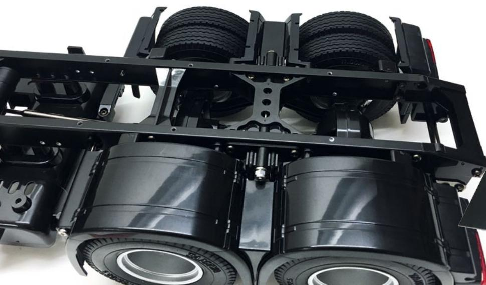
Die Deckel der Kotflügel sollten besser bei demontierten Rädern angebracht werden
