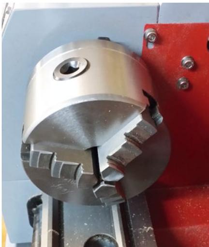
Im Lieferumfang der Holzmann Drehmaschine enthalten: das Dreibacken-Futter
