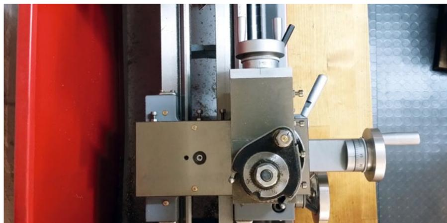
Blick von oben auf den Ober- und Querschlitten der Drehmaschine – der PWT-Schnellwechshalter ist bereits montiert
