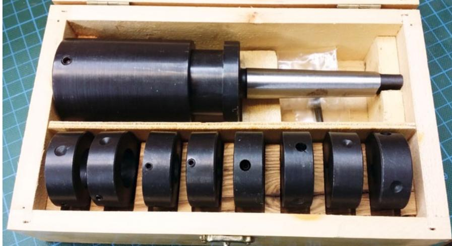
Die Gewindeschneide-Einrichtung von Wabeco kommt in einem extra Kasten, in dem alle Einzelteile gut sortiert aufbewahrt werden
