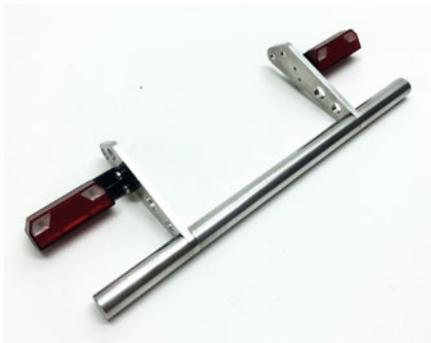
Der Heckunterfahrerschutz aus Aluminium ist nicht lackiert, sondern poliert worden
