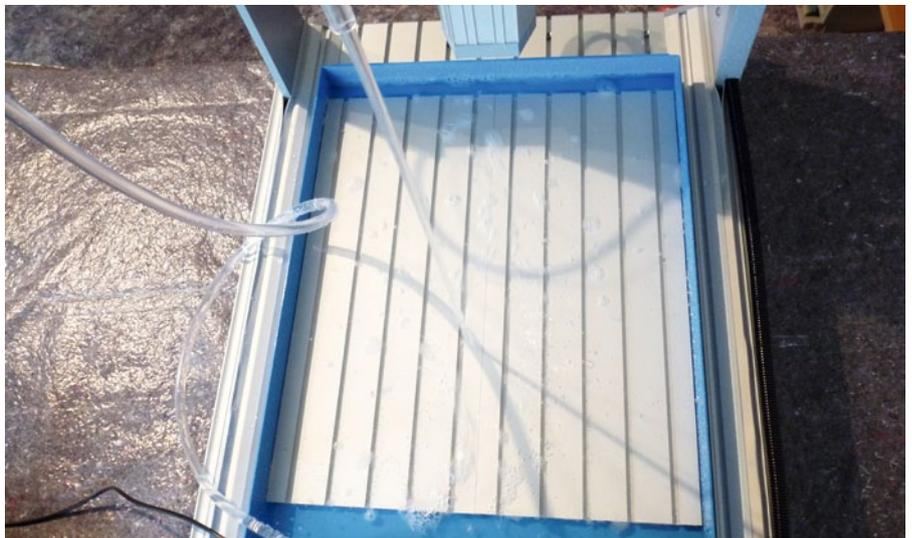
Trotz des großen Schlauchdurchmessers schaffte die Pumpe leicht die Förderhöhe von einem Meter und mehr. Damit ist auch der Betrieb von größeren Maschinen oder einer längeren Schlauchführung eine saubere Kühlung gewährleistet
