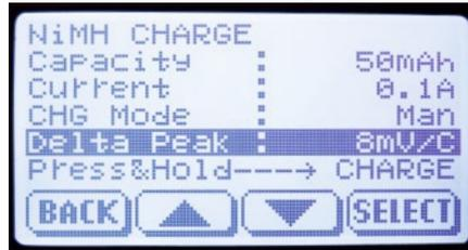
Selbstverständlich beherrscht das Gerät auch das Laden von NiXX-Akkus und lässt hierbei eine Einstellung des Delta Peak-Werts für die Abschaltung im Bereich von 4 bis 20 Millivolt zu. Beim Entladen wird die Gesamtspannung eingestellt und nicht die Anzahl der Zellen und deren Spannung
