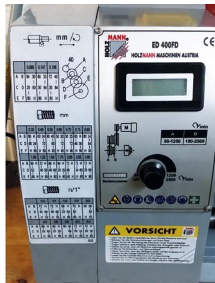
Im Spindelstock sind der Motor, das Getriebe, die Steuerung und die Spindel untergebracht
