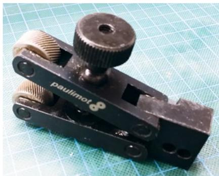
Das Kreuzrändelrad von Paulimot. Es lässt sich gut in den Schnellwechselhalter montieren und kann dank der Justierung für unterschiedliche Werkstückdurchmesser verwendet werden
