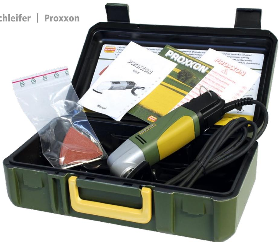
Mit 230 Volt Spannung betrieben, bietet sich der Eckenschleifer für alle Arten von Schleif- und sogar Sägearbeiten an
