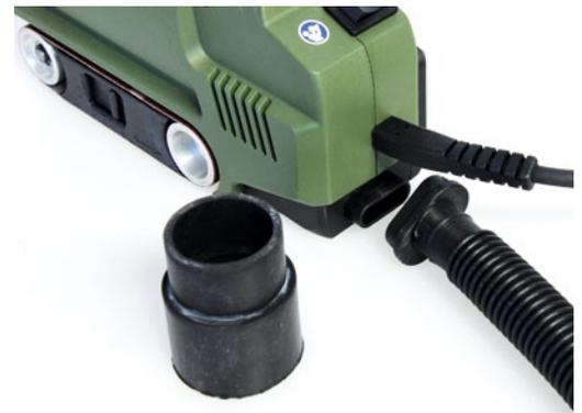
Hilfreich ist der mitgelieferte Staubsaugersanschluss. Da dieser im Handbetrieb gerne abrutscht, ist er allerdings mehr für den stationären Einsatz geeignet
