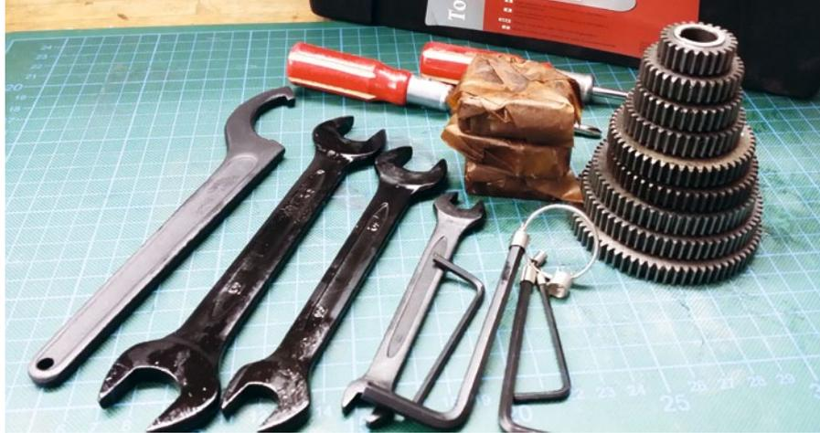
Das zur Holzmann Drehmaschine gelieferte Zubehör: Haken- und Maulschlüssel, Inbus-Bund, Schraubendreher, zusätzliche Backen für das Dreibacken-Futter und die Getriebe-Wechselräder
