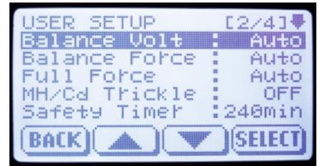
Als Besonderheit kann man im Menü des Duo Touch-Laders sogar Einfluss auf die Stärke des Balancerstroms nehmen – wenn auch nur in einigen vordefinierten Stufen. Zudem ermöglicht die Trickle-Ladung das Regenerieren von älteren NiXX-Akkus durch kurze und starke Entladeimpulse während des Aufladens
