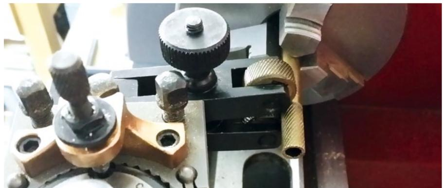
Das Kreuzrändel-Werkzeug im Einsatz. Dank Schnellwechselhalter ist das Werkzeug leicht im gewinkelten Eingriff positionierbar
