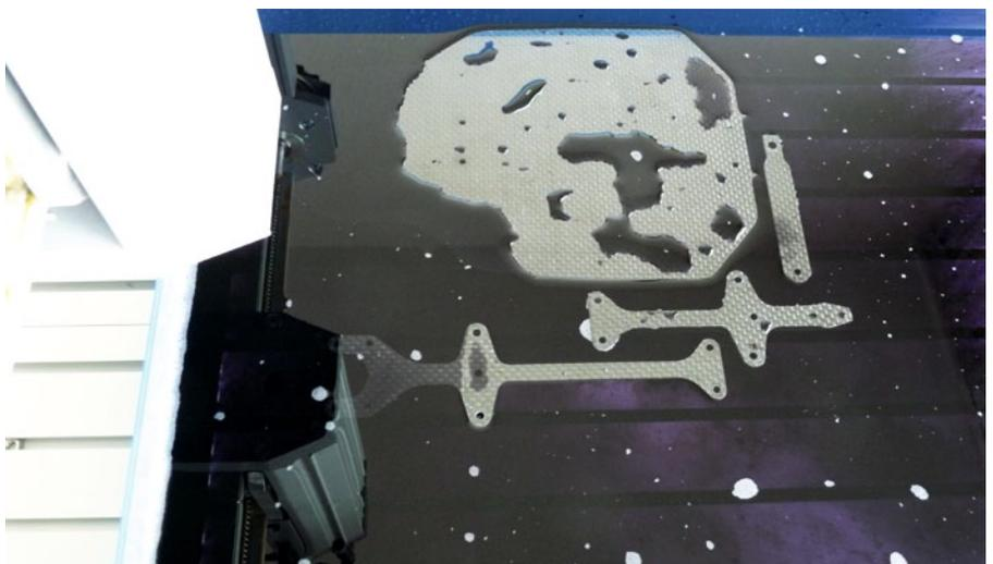
Nach der Entnahme der Restteile sind die ohne Stege gefrästen CFK-Teile gut zu erkennen. Der beim Fräsen entstehende Schmutz ist dennoch nicht ohne, die Maschinenumgebung wird schnell etwas nass. Eine Regeleinheit für die Pumpe wäre daher ideal
