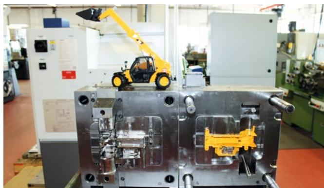
50 Prozent aller Spritzgussformen werden direkt im Fürther Bruder-Werk hergestellt, die andere Hälfte wird extern produziert
