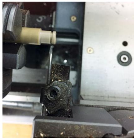
Mit dem Einstechstahl lassen sich beispielsweise Nuten für O-Ringe anfertigen
