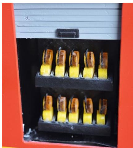
Um Einsatzorte für das Verkehrsgeschehen abzusichern, liegen im Fahrzeuginneren hinter den Rolltoren Warnblinklichter bereit
