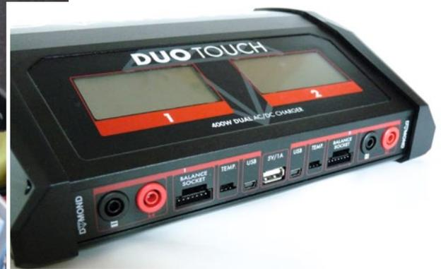
Bedient wird das Duo Touch über die Front, da sich dort auch alle erforderlichen Anschlüsse zu den aufzuladenden Akkus befinden. Der mittige USB-Port ist elektrisch mit dem ersten Ladeausgang verbunden, der Rest ist komplett unabhängig nutzbar
