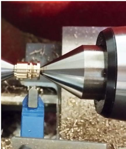
Sehr kleine Teile werden zwischen Spitzen (eine feste und eine mitlaufende) gespannt und nur durch den Anpressdruck gehalten
