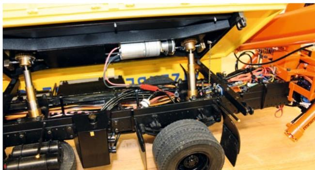
Für den Kipper treibt ein Motor zwei Spindeln an, die mit einer Welle über ein Schneckenrad verbunden sind. Die Kette sorgt für die Betätigung des Endabschalters der oberen Endlage
