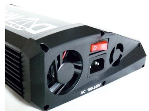
Die linke Seite beherbergt lediglich den AC-Anschluss für das mitgelieferte Netzkabel sowie einen beleuchteten Ein-aus-Schalter. Da das Netzteil den kompletten Leistungsbereich abdeckt, ist es eine vollwertige Alternative zur 12-Volt-DC-Nutzung
