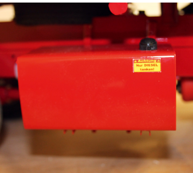
Der Tankdeckel entstand aus einer Fahrrad-Ventilkappe
