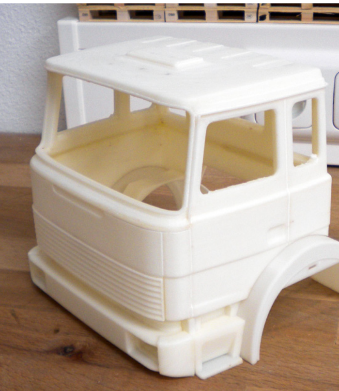
Aus drei 3D-Druckteilen entstand das Fahrerhaus
