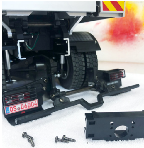
Beim Einsatz im Arocs ist die komplette Hecktraverse zu entfernen, um die Anhängerkupplung vernünftig anzubringen
