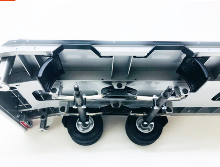
Das Anbringen der hinteren Kotflügel ist etwas knifflig, weil der Rahmen im Ganzen lackiert wurde und somit schon komplettiert ist. Aber mit etwas Geschick kommt man auch hier zum Ziel
