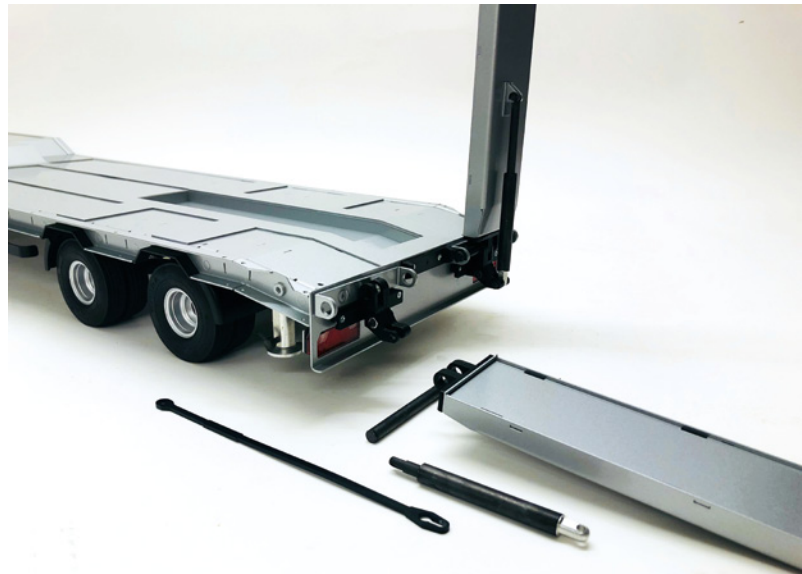
Die vorgefertigten, einteiligen Auffahrampen werden verschiebbar gelagert. Die seitlichen Haltestangen sind anders als beim Goldhofer-Auflieger glücklicherweise aus Stahl
