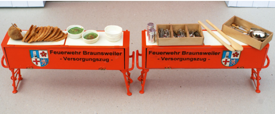
Wie bei einer Biertischgarnitur lassen sich die Füße der Gerätekästen ein- und ausklappen, sodass sie beispielsweise als Essensausgabe eingesetzt werden können
