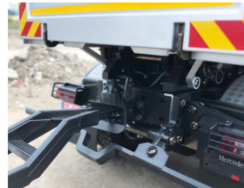
Die Anhängerkupplung kann auch von einem Servo geöffnet werden. Die dreiecksförmige Aussparung der Mulde im unteren Bereich sorgt dafür, dass die Anhängerkupplung beim Erreichen des maximalen Kippwinkels nicht mit der Mulde in Berührung kommt
