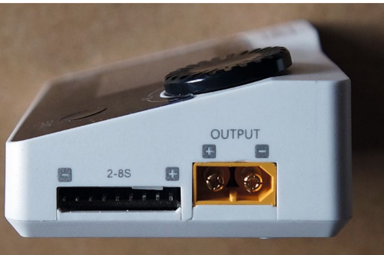
Akkus mit bis zu 8s lassen sich laden, entladen und balancieren
