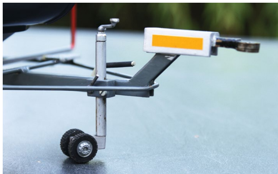
Das Deichselrad stammt aus dem Fundus von Wolfgang Brang: Ein Paar grobstollige Räder für einen Baustellenkipper und einige Messingrohre und fertig war das höhenverstellbare und bewegliche Deichselrad
