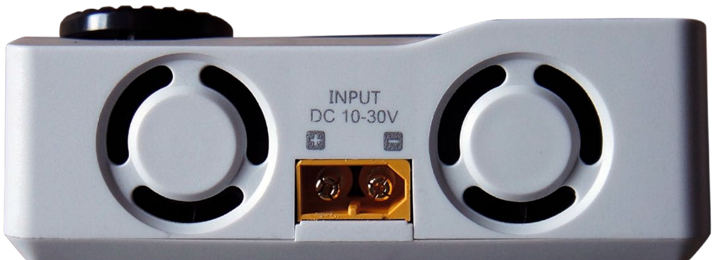
Die beiden Lüfter beugen einer Überhitzung effektiv vor
