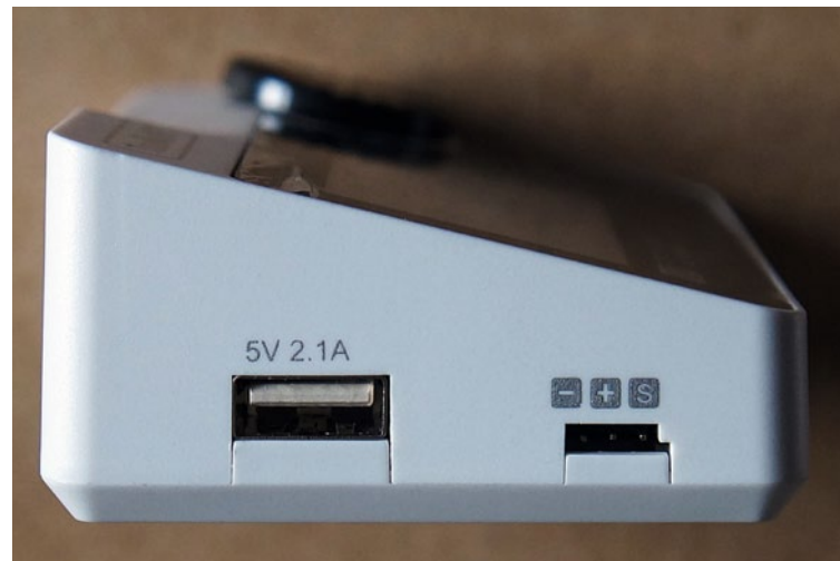
Satte 2.1 Ampere am USB-Anschluss und ein Anschluss für die interessanten Zusatzfunktionen bietet das Gerät
