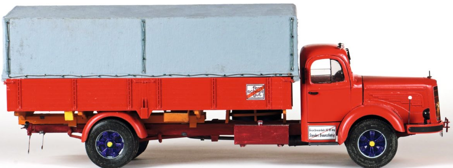
Der Rahmen des Mercedes besteht aus Polystyrolplatten, die Karosserie ist ein reiner Eigenbau. Front- und Heckteil der Plane stammen aus einem Bausatz, Seitenteile und Dach wurden aus rauem Karton gefertigt
