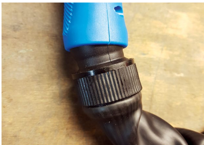
Das am Brenner vorhandene Drehgelenk ermöglicht eine gute Handhabung
