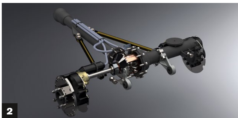
1+2) Zu den Besonderheiten des Unimogs gehören die Portalachsen, eine besondere Bauart von angetriebenen Achsen. Die einstufigen Stirnradgetriebe in den Radträgern wirken von den Wellen auf die Räder
