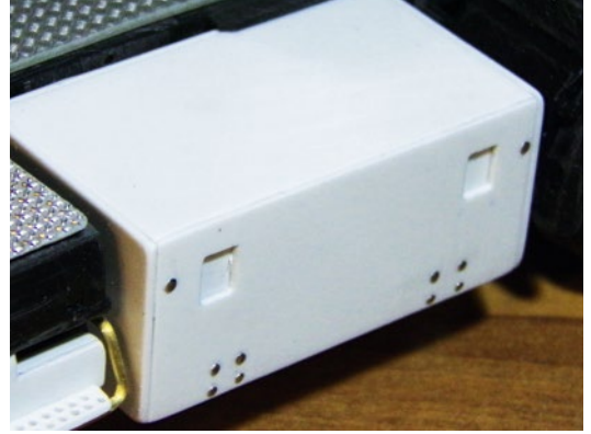
Gerade in kleinen Maßstäben ist Kreativität gefragt, um Details umzusetzen. Beispielsweise geben Stecknadelköpfe optisch mehr her als passable Nieten
