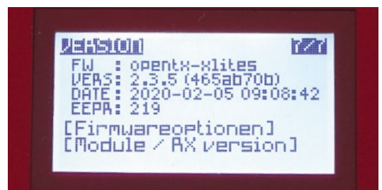
Wichtig bei FrSky-Produkten ist, dass die gewählten Versionen von Sender und Empfänger kompatibel sind
