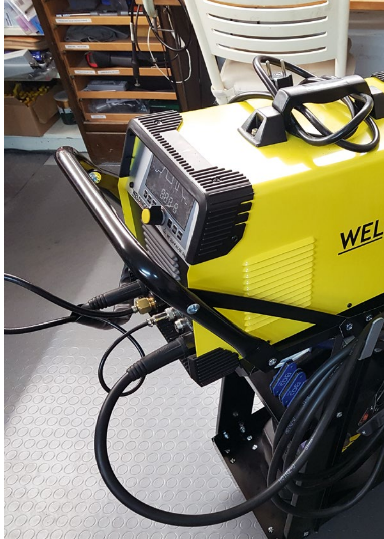
Für die Werkstatt bietet sich gegebenenfalls die Nutzung eines Schweißwagens an. Darauf sind das Schweißgerät samt Zubehör und die Schutzgasflasche beweglich gut untergebracht
