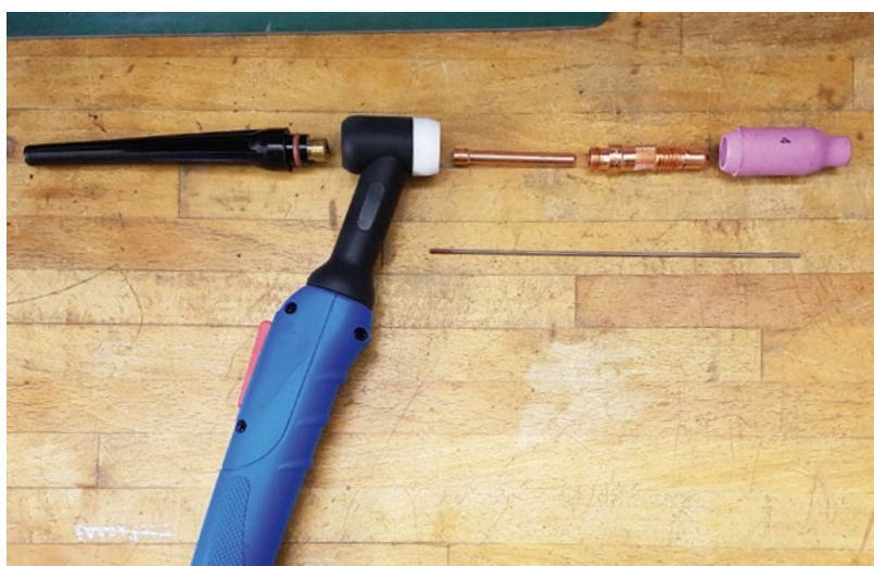
Der Brenner in seine Einzelteile zerlegt (v.l.n.r.): Brennerkappe, Handstück, Spannhülse, Düsenhalterung, Düse, darunter die Wolfram-Elektrode (ungeschliffen)
