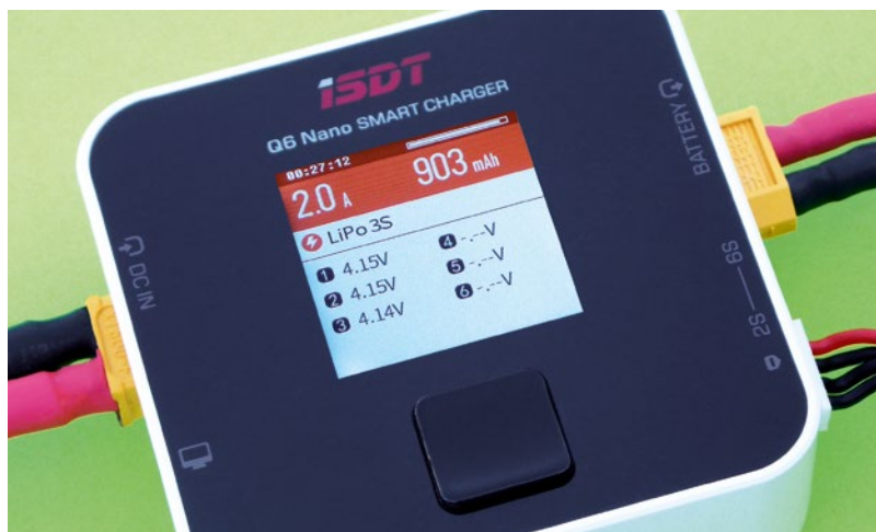
Das Display lässt sich gut ablesen, die Kommunikation erfolgt über die Wipp-Taste
