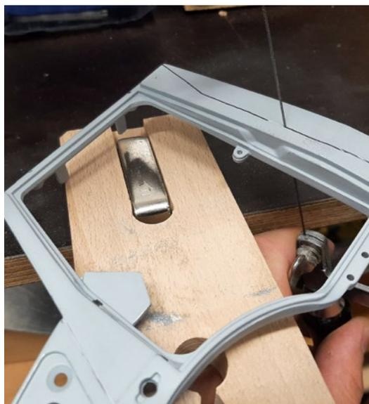
Anschließend riss der Autor an der noch kompletten Seitenwand den schrägen Übergang an der neu zu erstellenden B-Säule an und sägte im Anschluss mit einer Laubsäge die Kontur genau aus
