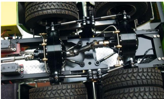
Fertig eingebaute Pendelachse mit Seilzügen für die Differentialsperren
