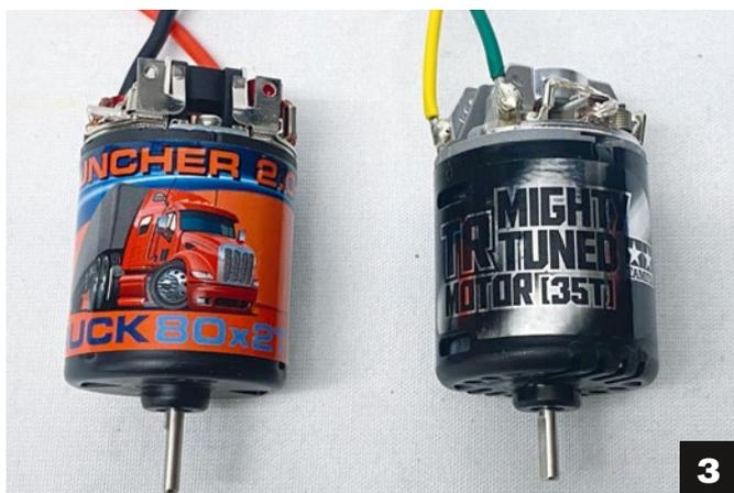
3) Ein 80-Turn-Motor wird gegen den 35-Turn-Motor aus dem Baukasten getauscht.
