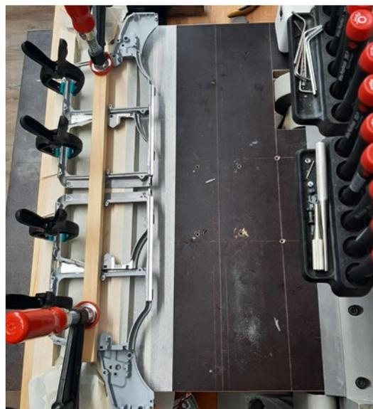
Um die vordere und hintere Seitenwand zu verkleben, kam eine Leistenkonstruktion zum Einsatz, die es ermöglichte, zusammen mit Aluminiumwinkeln eine gerade und fluchtende Seitenwand zu verkleben
