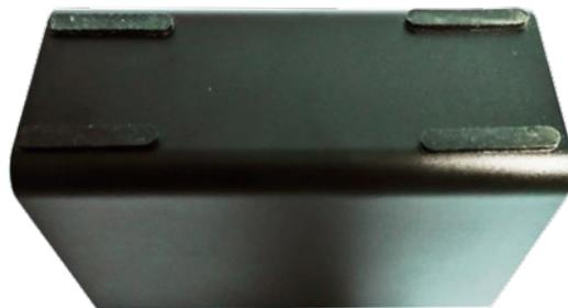
Zunächst klebt man zur besseren Wärmeabstrahlung die beiliegenden Schwammgummistreifen auf; wenn vorhanden sind GummifüÙe noch besser
