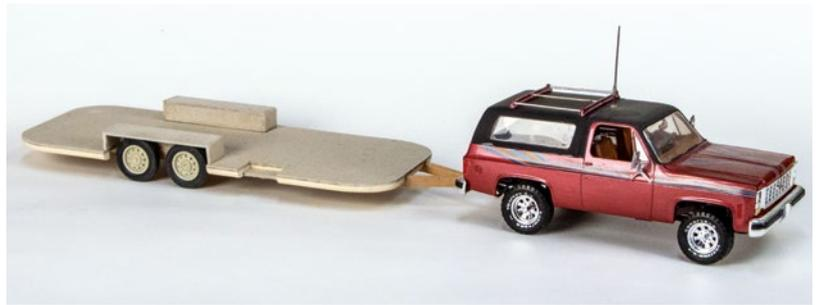
Das Fahrgestell, gebaut auf einer Sperrholzplatte mit aufgeleimten Holzleisten. Die Räder sind Drehteile aus Kunststoff. Das Zugfahrzeug ist ein Bausatzmodell
