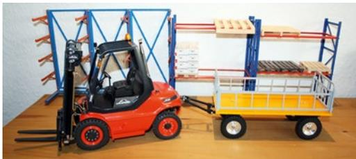
Der neue Anhänger für Gabelstapler von Tönsfeldt Modellbau-Vertrieb kostet 99,- Euro, hat die Maße 107 x 63 Millimeter und wiegt 425 Gramm. Die Bauteile bestehen aus Polystyrol. Die vorderen Achslagerhalter und die Plattform werden mit Kugeln ausgerüstet, das hintere Achslager hingegen kann mit Schrauben festgesetzt werden. Alternativ kann das hintere Achslager mit dem vorderen verbunden werden, indem eine Lenkstange benutzt wird. Die vordere
