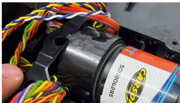
Für die möglichst flache Montage der MFC-03 wurde der obere Rand des Getriebegehäuses weggeschliffen
