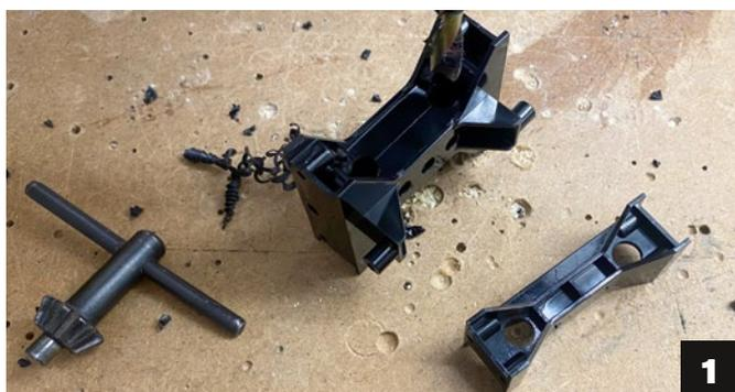
1) Empfehlenswert ist das Einbringen von Bohrungen in die Rahmentraversen zur erleichterten späteren Kabeldurchführung.
