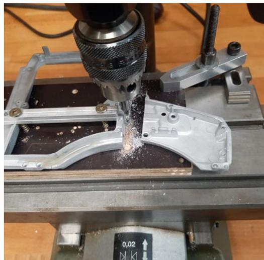
Als Erstes wurde auf der Fräse die vordere Kotflügelpartie winklig zur unteren Einstiegs-kante von der Seitenwand abgetrennt
