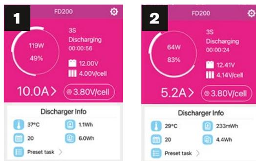
1) Automatische Steuerung des FD-200 mit einem Smartphone: 3s-LiPo, Entladestrom: 10 Ampere, Entladezustand: 49 Prozent. 2) FD-200 mit Smartphone: 3s-LiPo, Entladestrom gesunken auf 5,2 Ampere, Entladezustand: 83 Prozent, Restladung: 17 Prozent, Abschaltung bei 3,8 Volt/Zelle
