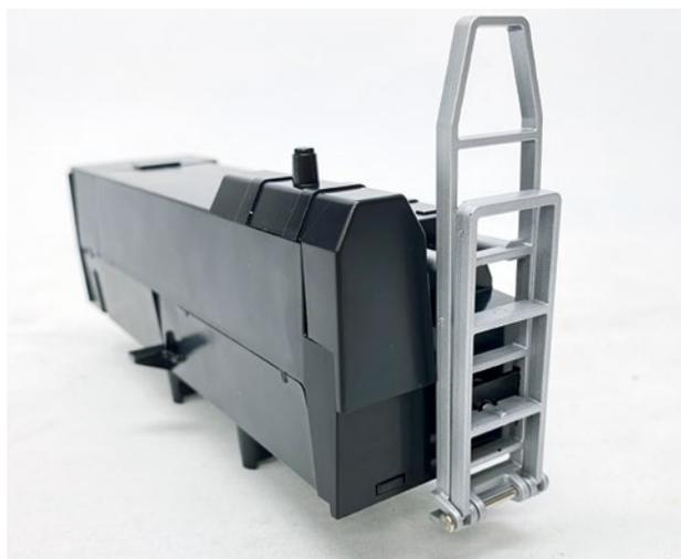
Der Hydrauliktank dient als Akkufach, an dem auch die Klappleiter befestigt wird
