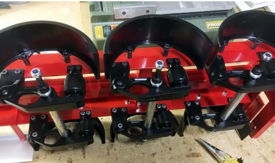
Montage der Achsen und Kotflügel am Rahmen – bei einem zweiten Modell nach gleichem Vorbild
