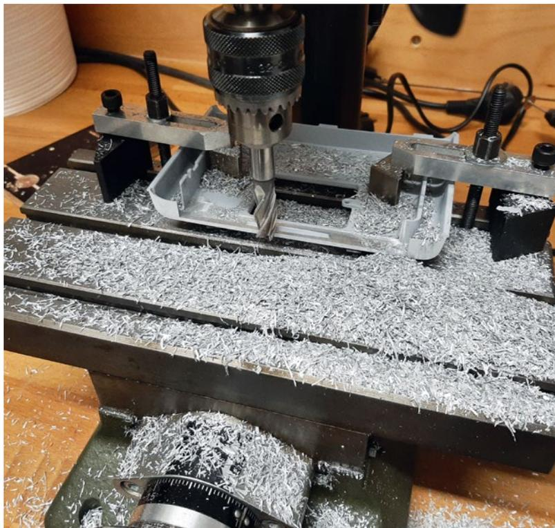
Beim Dach konnten die Seitenwände als Referenz dienen; dementsprechend wurden bei einem Dach die hintere Kante und beim anderen die vordere Kante abgefräst
