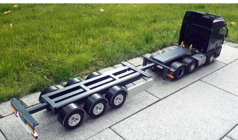
Das fertige Flex-Chassis mit Front- und Heckauszug für eine flexible Beladung
