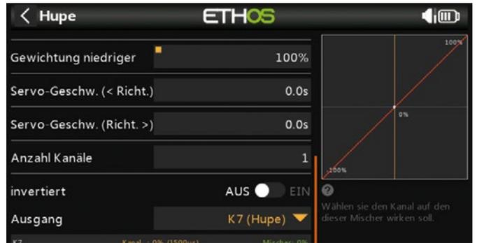
Mischer-Konfiguration für einen Schaltkanal am Beispiel für die Betätigung der Hupe
