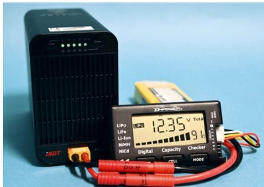
Grüne LEDs zeigen an, dass der Entladevorgang beendet ist
