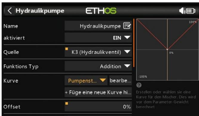
Die Hydraulikpumpe wird vom Kanal 3 aus mit dieser Mischerkurve gesteuert
