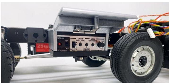
Die Schaltzentrale der MFC befindet sich im Schalldämpfer, der nach oben zu öffnen ist
