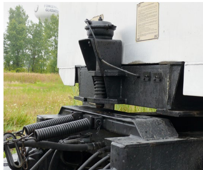
Ein interessantes Detail: Das Drehgestell lässt sich für die Rückwärtsfahrt blockieren
