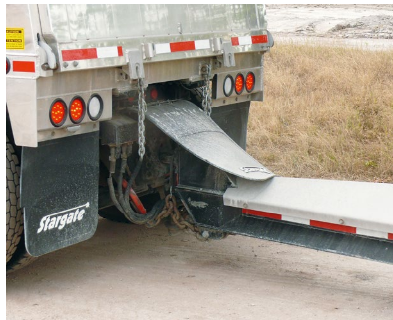
Die Zugdeichsel ist so ausgebildet, dass das Schüttgut nicht darauf liegen bleibt. Die Kupplung und die Anschlüsse sind durch eine Abdeckung geschützt
