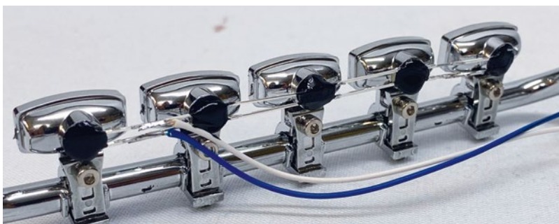
Die fünf LEDs für die Zusatzscheinwerfer auf dem Dach werden auch direkt miteinander verlötet, um den Kabelbaum schlank zu halten
