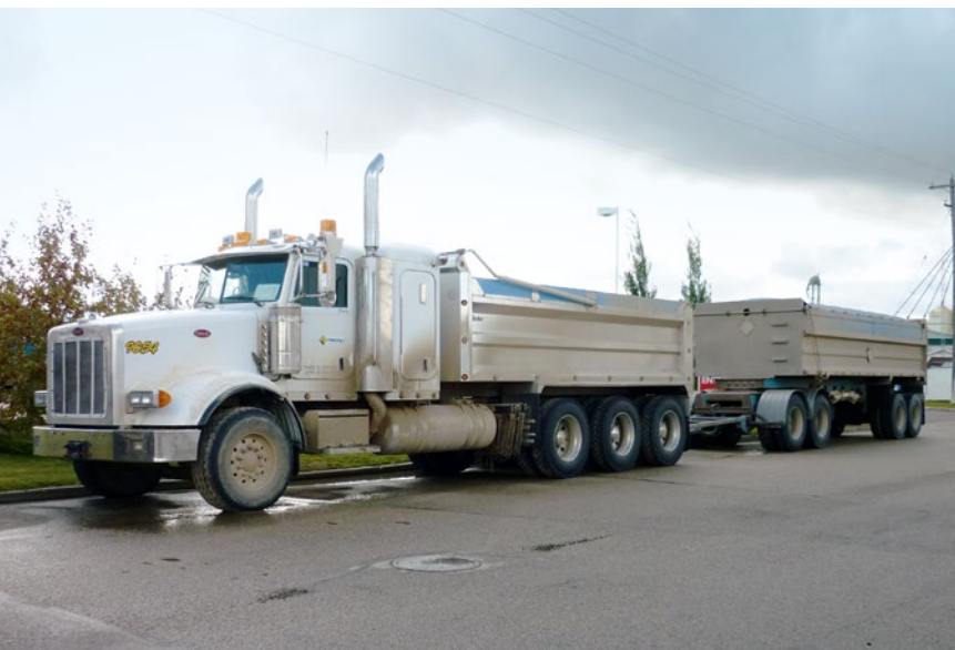
Besonders im Westen Kanadas sind viele Baufahrzeuge mit Tridem Axle, also drei angetriebenen Achsen, zu sehen
