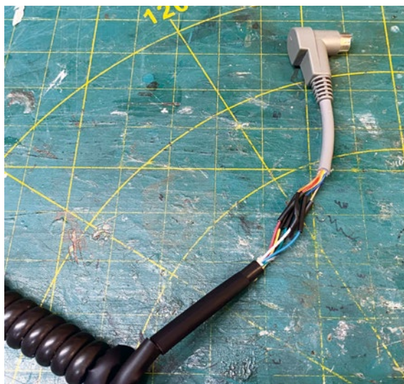
Ein ausrangierter Stecker einer Tamiya-Auflieger-Lichteinheit wird mit dem Spiralkabel verbunden
