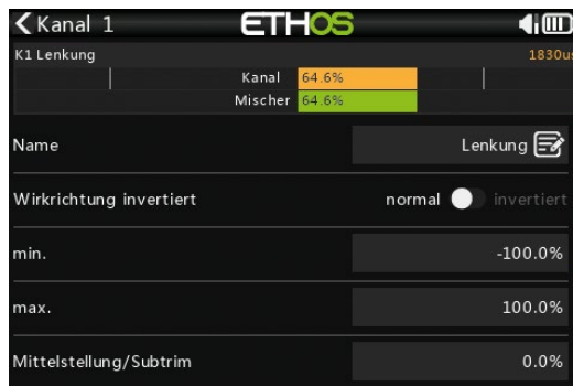
Durch Markierung eines Kanals lassen sich sämtliche Einstellungen einschließlich Kurven vorgeben
