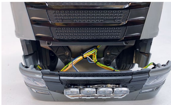
Das Fahrerhaus wird erst von hinten am Fahrgestell „eingehängt“ und anschließend vorne verschraubt. Erst dann wird der Stoßfänger befestigt
