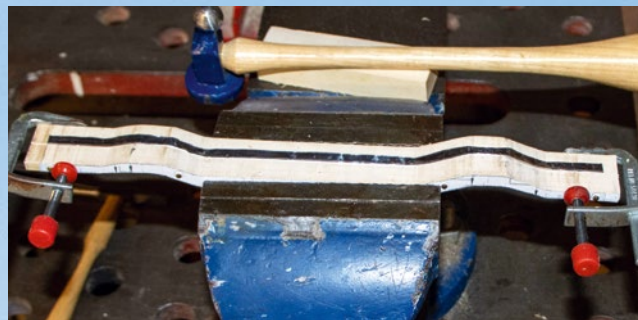
In die längs geteilte Holzform ist ein Blechzuschnitt eingespannt und beidseitig umgebördelt
