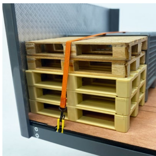
Sobald ein Spanngurt zum Einsatz kommt, ziehen sich die Ösen aus dem Rahmen
