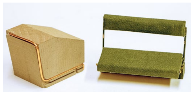
Links die Biegeschablone für einen Sitzrahmen und rechts der Hintersitz mit Klapplehne
