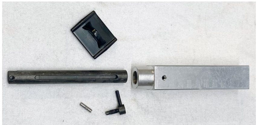
Die Abstellstützen sind alte Bekannte aus dem Carson-Sortiment. Die „Füße“ aus Kunststoff sind pendelnd gelagert
