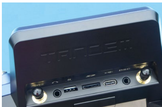
Sämtlich Ports einschließlich eines SD-Karten-Slots sind gut zugänglich
