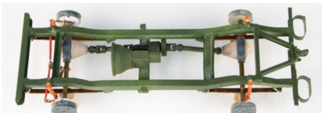
Der Rahmen mit den Achsen, dem Schaltgetriebe und den Antriebswellen
