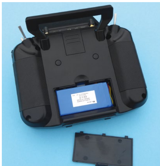
Rückseitig sind das Akkufach und ein Schacht für ein externes HF-Modul sowie zwei weitere Tasten untergebracht, zur Stromversorgung dient ein 2s-LiPo-Akku mit 4.000 Milliamperestunden Kapazität
