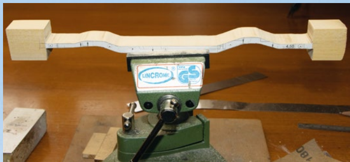
Die aus Hartholz gesägte Form für die Rahmenträger
