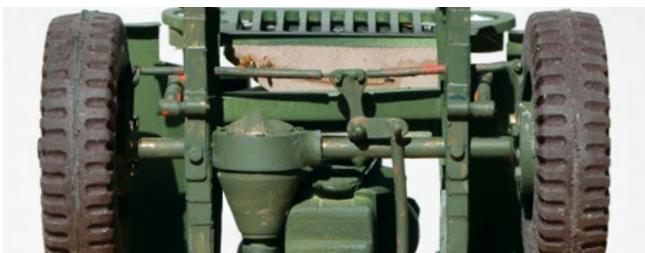
Die Vorderachse von unten. Gut zu erkennen ist das Lenkgestänge mit geteilter Spurstange
