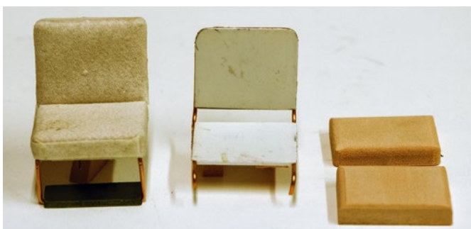
Die Vordersitze im Bau aus Draht und Hartschaum. Der rechte Sitz ist nach vorn klappbar
