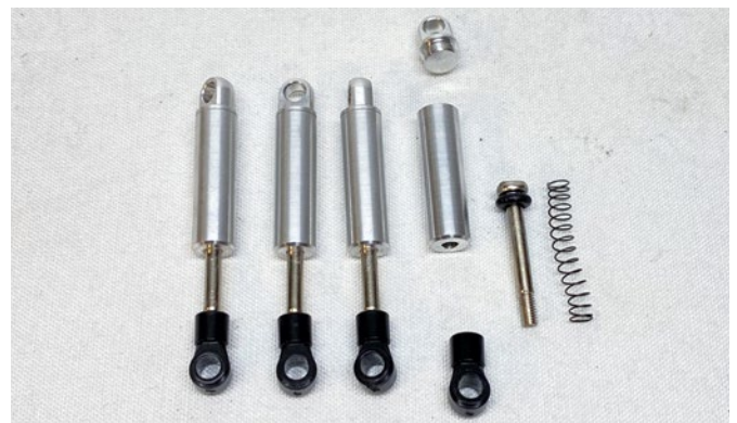
Die silbernen Aluminium-Stoßdämpferattrappen werden mit inneren Federn bestückt, um nicht nur schön auszusehen, sondern auch Last abzufedern
