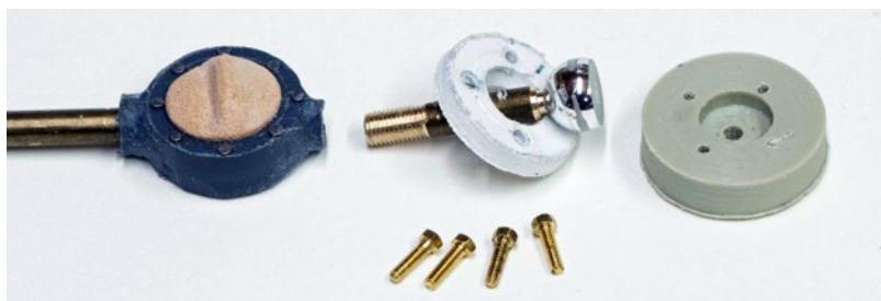
Einzelteile der Vorderachse. Links das Differentialgehäuse, in der Mitte die kugelförmige Lagerung des Vorderrads und rechts Teile der Radlagerung
