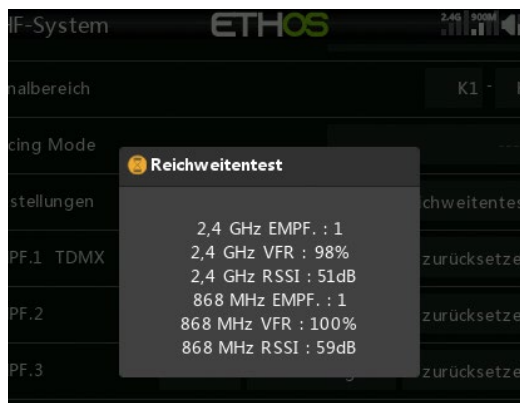
Beim Reichweitentest lagen alle Werte bei der geforderten Distanz im grünen Bereich
