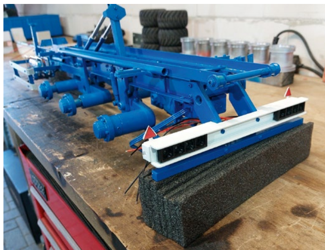
Aus Alu-U-Profil wurde der Heckabschluss geschnitten. Darin finden selbstgedruckte Rückleuchten ihren Platz
