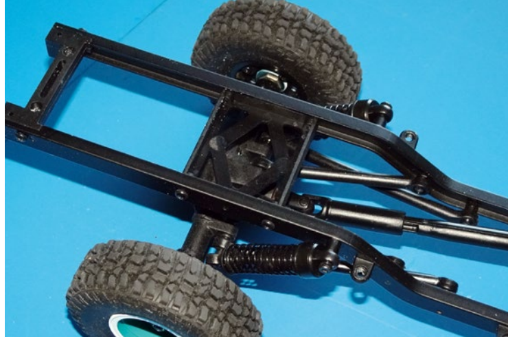
Unter der Ladefläche verbirgt sich die Hinterachse mit den schräggestellten Friktionsdämpfern
