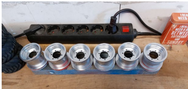
Die Kotflügel des 1:14-Modells bestehen aus 2-mm-Alublech mit gefrästen 1-mm-Nuten. Bei den Rädern kam insbesondere die Drehbank zum Einsatz
