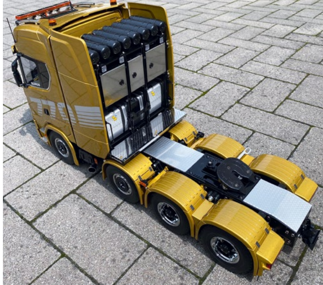
Zu guter Letzt wurde noch der Rahmen mit ein bisschen Riffelblech verkleidet, um die Kabelbäume gänzlich unsichtbar zu machen
