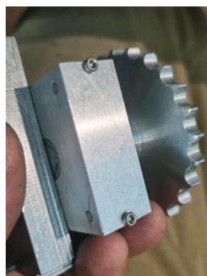
Am liebsten hat TRUCKS & Details-Autor Benjamin Müller einfache, robuste Technik in seinen Modellen. So wurde der Getriebblock etwas aus einer 10-mm-Stahlplatte gefertigt. Dazu kommt ein Gegengewicht aus einer Stahlplatte mit 5 mm Dicke, damit möglichst viel Gewicht ins Heck kommt
