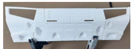
Hier der Stoßstangen-Rohling. Das Modell wurde vom heimischen 3D-Drucker ausgedruckt
