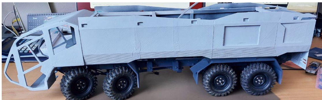
Ein Blick auf den Aufbau des 8x8-Fahrzeugmodells mit sichtbarem Spritzspachtel
