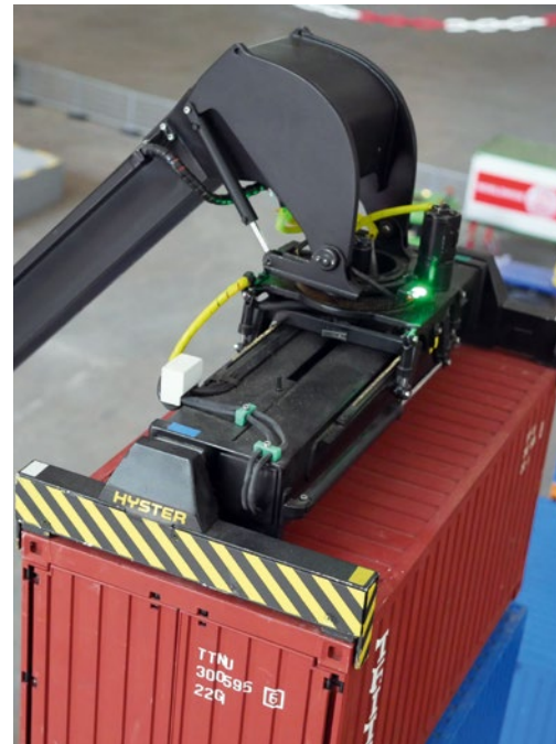
Ohne Pause ging es gleich an den nächsten Container. Und dieses Mal ganz hoch hinaus. Mittels Funktionsleuchte erkennt der Fahrer, ob die Ladung ordnungsgerecht im sogenannten Spreader am Ende des Hauptarms eingespannt ist
