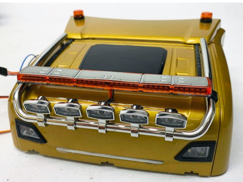
Der Warnlichtbalken wird auf dem Lampenbügel befestigt. Die Zusatzscheinwerfer sind alle parallel aneinander gelötet und werden so von nur einem Kabel versorgt
