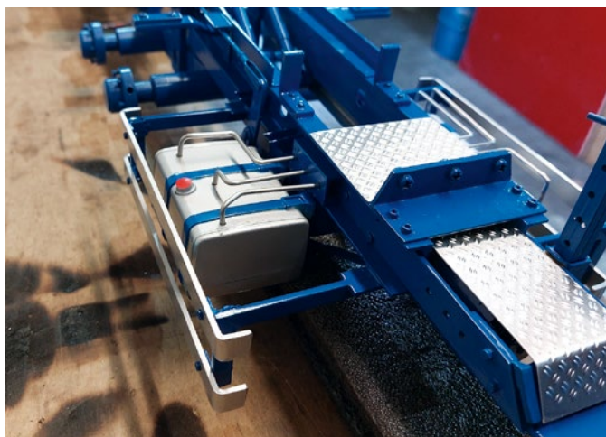
Edelstahl und Alu-Vollmaterial bieten die Basis beim Kipper. Auf einer Längsseite wurde ein Original-Tamiya-Tank aus einem Lkw-Bausatz montiert. Edelstahldrahtleitungen runden das Gesamtbild ab
