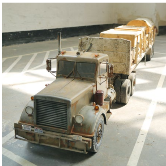
Alterung im Modellbau ist ein spannendes Thema. Realistischen Rost erreicht man etwa durch das Auflösen eines Stahlschwamms in Essig
