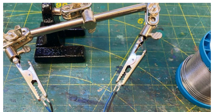
Das Konfektionieren der Zusatz-LED ist relativ einfach. Für den Einsatz an der MFC sind keine Vorwiderstände notwendig
