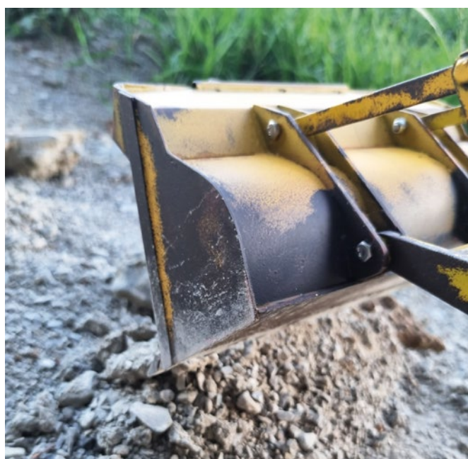
Aus Messingblech mit 1 mm Dicke wurde die Schaufel der Hanomag 400 C hergestellt
