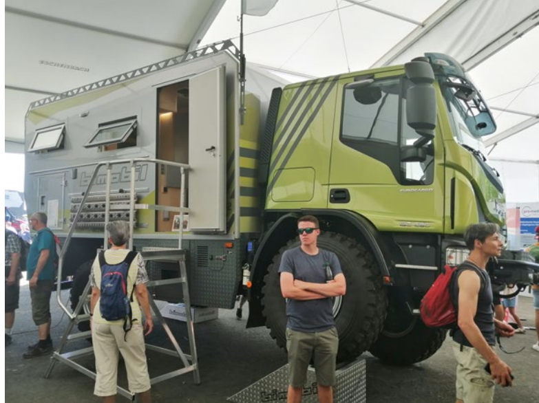
Das Reisemobil Ex 462 auf Basis eines Iveco Eurocargo 4x4 verfügt über 206 kW oder 280 PS
