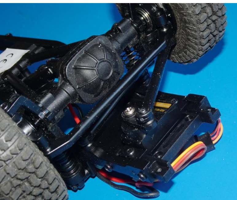
Das Lenkservo sitzt im Chassis. Merkleiche Veränderungen in der Lenkwirkung beim Einfedern der Vorderachse gibt es erwartungsgemäß aber nicht
