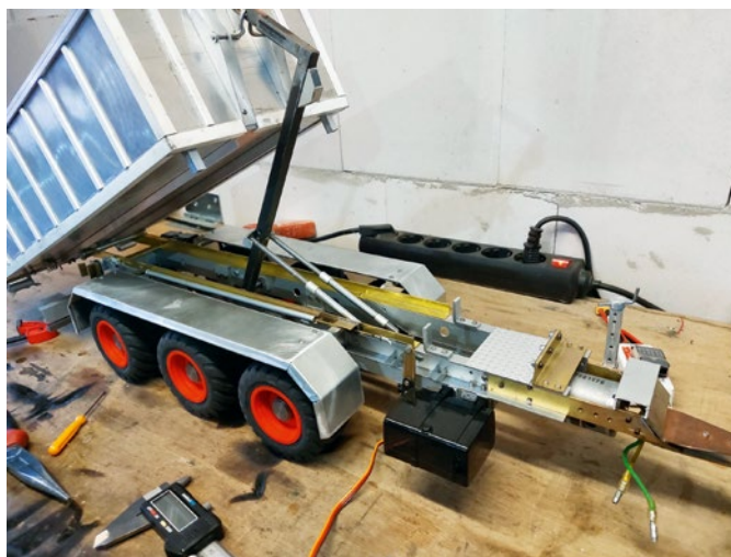
Damit Maß und Länge des Kippmechanismus sowie die Mulde zusammenpassen, wurde beides zeitgleich gebaut
