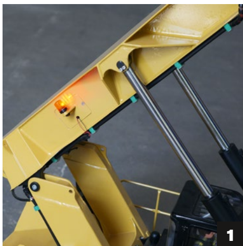
1) Der Reachstacker ist weitestgehend mechanisch aufgebaut. Durch feine Elektronik wie Arbeitsscheinwerfer wird die gewünschte Originalnähe erzeugt. 2) Nachdem der Spreader alle Funktionen nach den Vorstellungen des Erbauers umsetzen konnte, wurde er zerlegt und komplett in Schwarz lackiert. 3) An der rechten Seite des Hauptarms ist eine Energiekette verbaut. Sie führt die Kabel zu einem 15-poligen Sub-D-Stecker im Kopfstück, der die Stromversorgung des Spreaders besorgt
