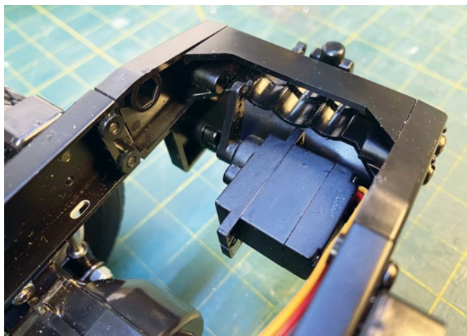
Das AHK-Servo verschwindet im Inneren des Rahmens
