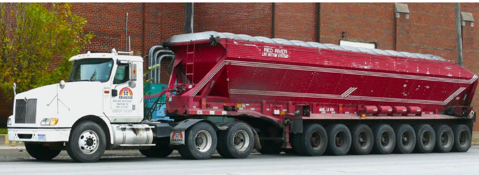
Dieser Live Bottom Auflieger sieht gewaltig aus, Lastzüge im US-Bundesstaat Michigan können bis zu elf Achsen aufweisen. Die Aufliegerachsen sind nicht lenk-, aber zum Teil liftbar
