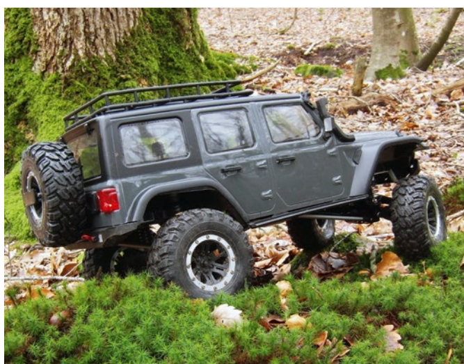
Das Modell misst 635 x 290 x 300 mm und hat einen Lenkeinschlag von maximal 43°
