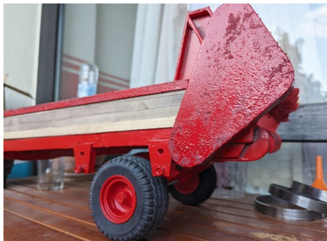
Die Reifen bestehen aus Silikon, die Holzleisten des Anhängers wurden in Alu-U-Profil eingefasst
