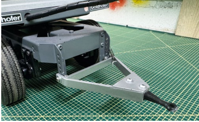
Mit einer kleinen Feder wird die Deichsel waagrecht gehalten
