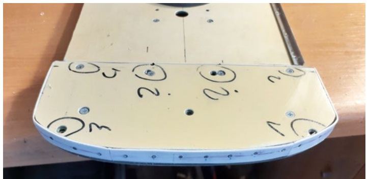
Das ganze Gehäuse des 1:16-Modells wurde aus 2-mm-Kunststoffplatten erstellt
