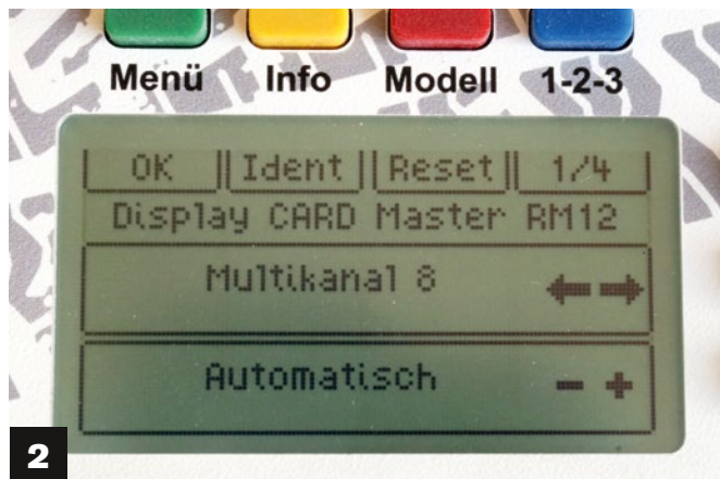
1) Zwo4-Generationen im Vergleich: links der erste Empfänger E9 mit dem separatem Antennenmodul, daneben der RX9, der im Testtruck durch den RM12 (rechts) ersetzt wurde. 2) Per Display CARD können am RM12 die Multiswitch-Kanäle 7 und 8 umgestellt werden
