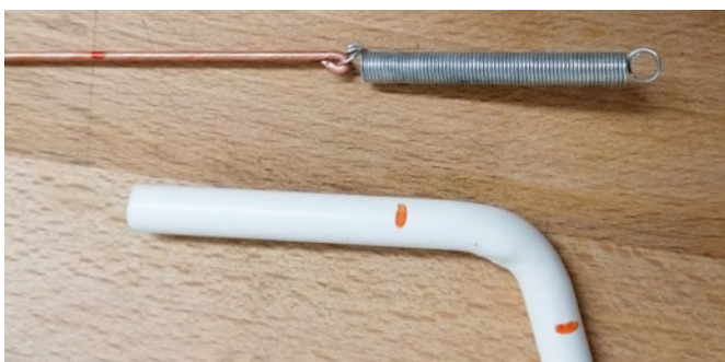
Der Auspuff des Lkw wird mit einer Feder vorsichtig gebogen
