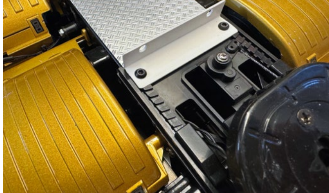
Das Gegenstück zur Fixierung der Pritsche befindet sich im vorderen Bereich der Sattelkupplung
