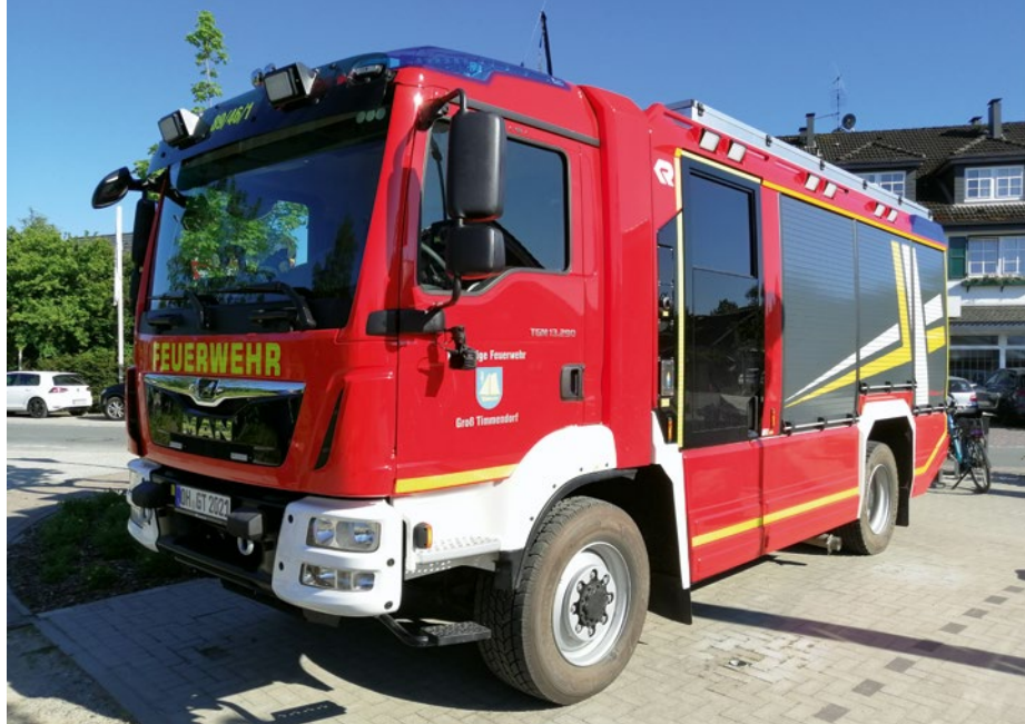
Das LF 10 ist auf dem Fahrgestell eines MAN TMG 13.290 aufgebaut
