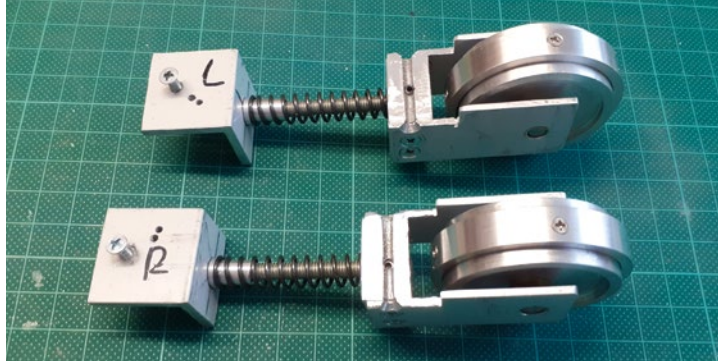
Die Seil-, Lauf-, Stütz- und Spannrollen wurden vom Erbauer selbst hergestellt
