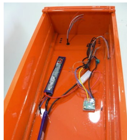
Doppelter Boden im Kipper für die Elektronik, inklusive LiPo-Akku
