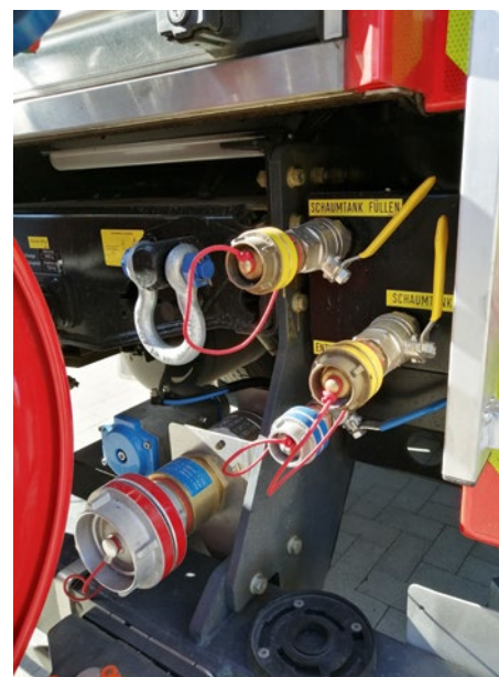
Detail am Heck des LF 10 aus Groß Timmendorf und Anschlüsse für verschiedene Schläuche der Einsatzgruppen
