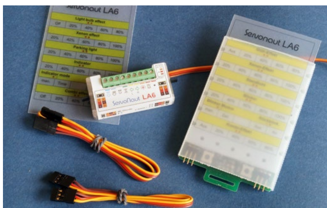
Im Lieferumfang zur Lichtenanlage LA6 findet man neben den notwendigen Anschlusskabeln auch die Karten für das Servonaut-eigene Einstelltool ProgCARD (rechts im Bild)
