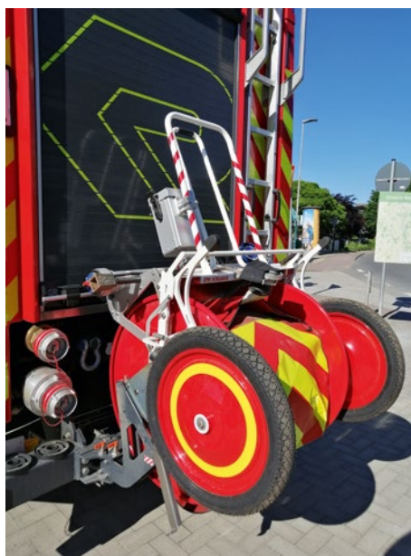
Detail am Heck des LF 10 aus Groß Timmendorf und Anschlüsse für verschiedene Schläuche der Einsatzgruppen
