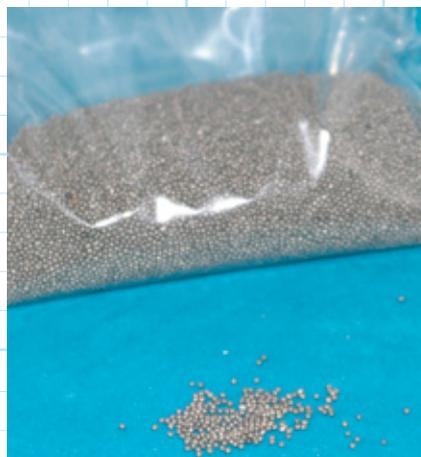
**Feines Stahlgranulat, 1 Zentimeter hoch auf die Sohlen gefüllt, garantiert in Kombination mit der richtigen Fertigungsart einen sicheren Stand**
