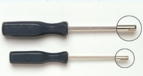
**Splintendreher sind ein Muss, wenn man sich dafür entscheidet, Gelenke auf Basis von Pappscheiben und Splinten zu fertigen**
