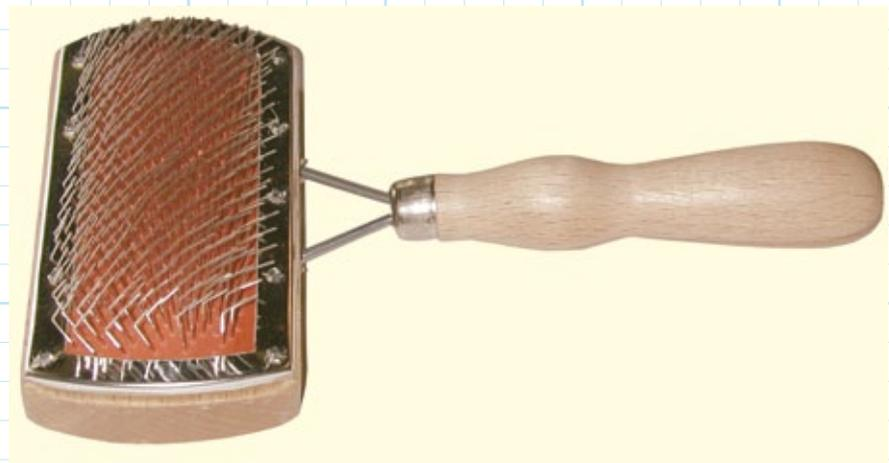
**Die Florbürste kämmt eingenahte Haare aus den Nähten. Sie ist auch in einer kleinen Version als Fingerbürste im Handel erhältlich**
