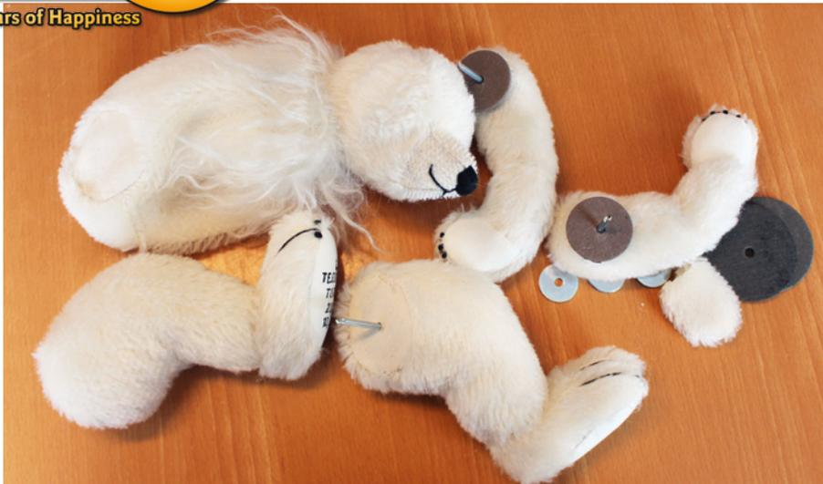
Die einzelnen Teile müssen angesplintet werden
