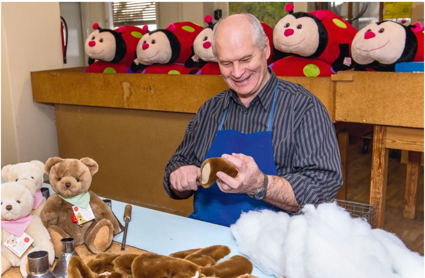
Beim Stopfen läuft wieder alles ganz traditionell ab. Sollen die Bären voll beweglich, also fünffach gegliedert sein, müssen Kopf, Arme und Beine separat gefüllt werden
