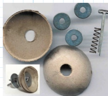
Eine Möglichkeit, ein Gelenk zu erstellen, ist die Halbschale
