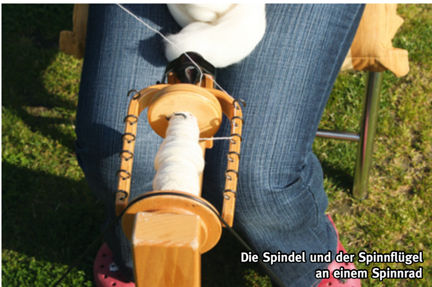
Um die Spindel surrt der Spinnflügel, drei Wirtel (rechts) sorgen für unterschiedliche Drehzahlen
