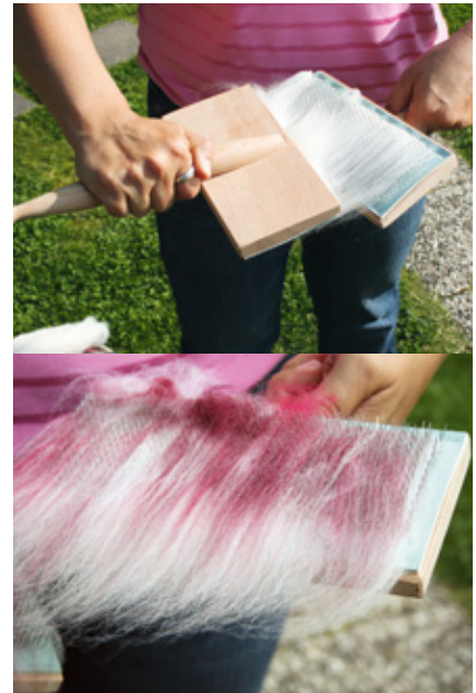
Durch das sogenannte Kardieren werden die Wollfäden in die Reihe gelegt und Farben gemischt
