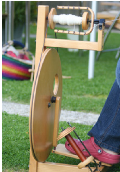
Über das Pedal wird das Spinnrad in Gang gebracht und gehalten
