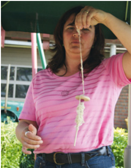
Die hier gezeigte Handspindel verfügt über einen Hochwirtel
