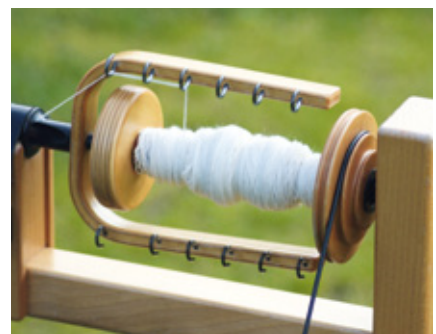
Um die Spindel surrt der Spinnflügel, drei Wirtel (rechts) sorgen für unterschiedliche Drehzahlen
