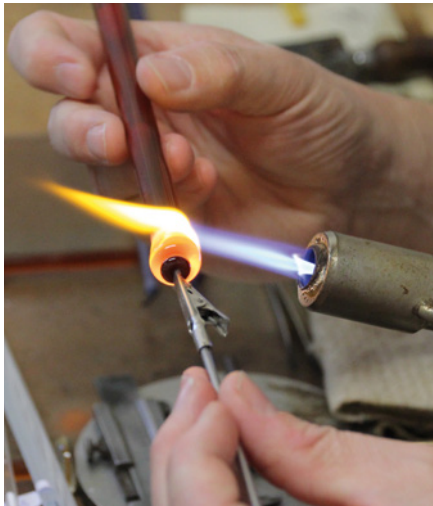
Der braune Glasstab wird in der Flamme erhitzt und die passende Menge für ein Auge geschmolzen
