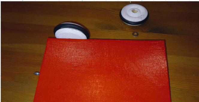
Die Positionierung der Räder erfolgt über Schrauben mit breitem Kopf
