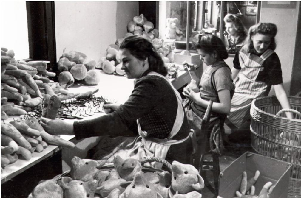
**Die Frauen bereiten das Zusammensetzen der gestopften Einzelteile mittels Splinten vor**
