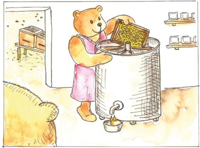
Durch Zentrifugalkraft wird der Honig in einem großen Metallzylinder aus den Wabenwänden und den Wachszellen geschleudert
