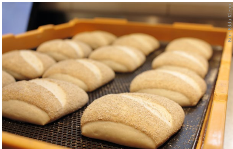
In diesem Fall ist das Backblech in die Diele integriert und die Teiglinge müssen nicht gedreht werden. Es wird einfach herausgenommen
