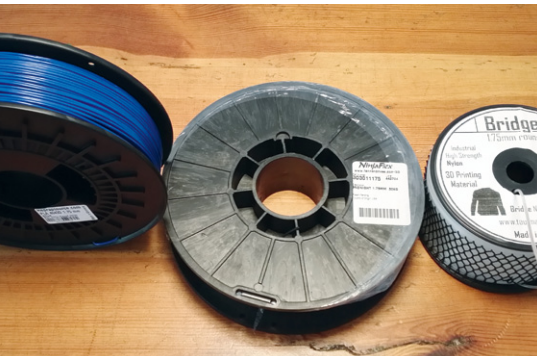
Die unterschiedlichen Druckmaterialien werden auch Filament genannt. Von links nach rechts sieht man PLA, ABS und Nylon
