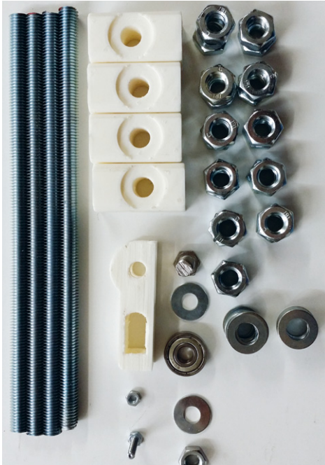
Zutaten für den Rahmen: Muttern, U-Scheiben, Gewindestangen und gedruckte Fertigteile
