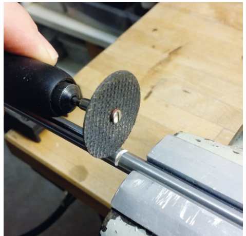
Mit dem Dremel-Trennschleifer wurden die Führungsstangen zugeschnitten
