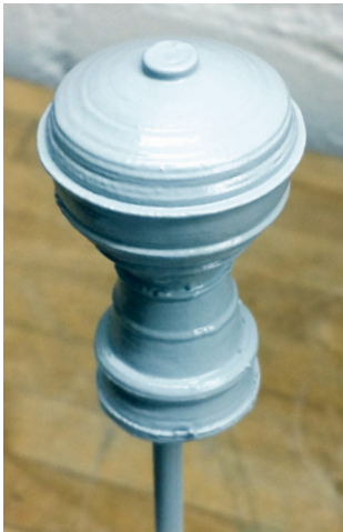
Das gedruckte Modell wird mit Spritzspachtel beschichtet, verschliffen, grundiert und lackiert
