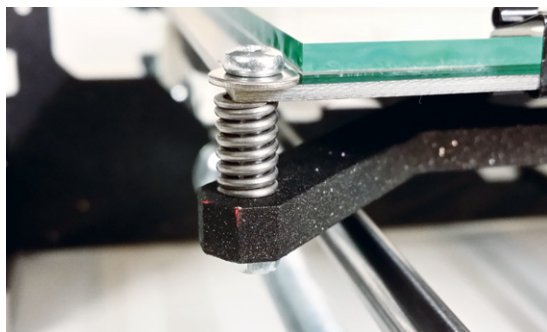
Die Druckfeder der Heizbettbefestigung ist für die Nivellierung wichtig
