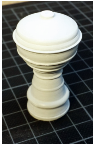
Das gedruckte Modell wird mit Spritzspachtel beschichtet, verschliffen, grundiert und lackiert
