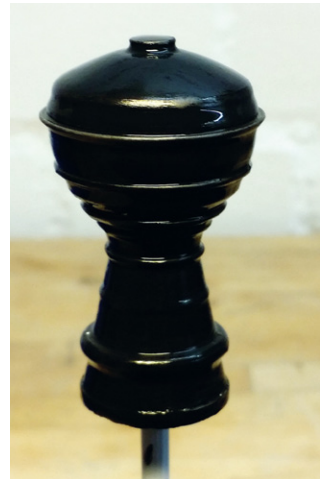
Das gedruckte Modell wird mit Spritzspachtel beschichtet, verschliffen, grundiert und lackiert
