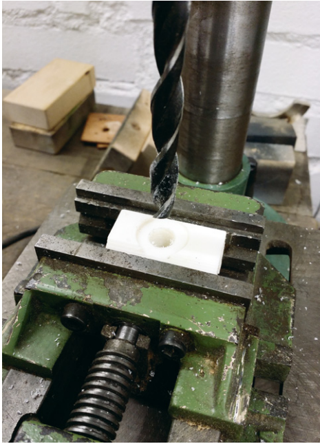
Die gedruckten Fertigteile müssen unbedingt nachgearbeitet werden
