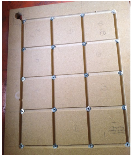
Die Vakuumpalte von unten. Der Unterdruck wird durch einen einfachen Staubsauger erzeugt
