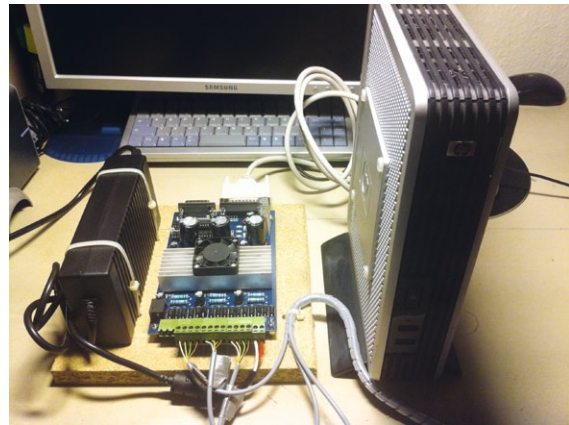
Testaufbau des Thin-PC mit Steuerkarte und Netzteil
