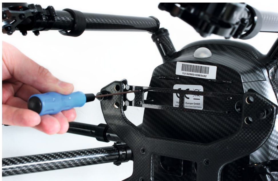
Die Dämpfungsplatte des H920 muss für den Einsatz der CGO4 umgebaut werden. Das dauert weniger als zehn Minuten
