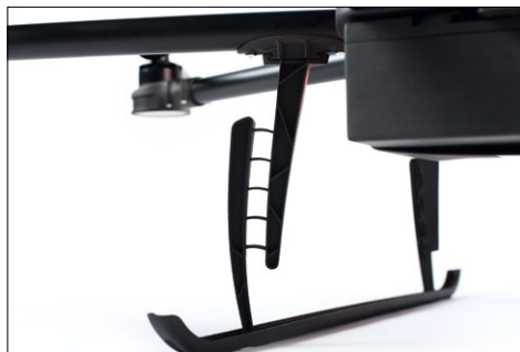
Das Landegestell des Kopters ist gefedert und garantiert ein sanftes Aufsetzen
