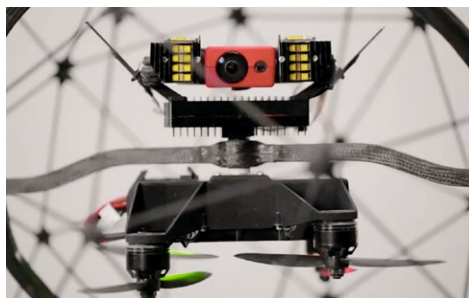
Die gesamte Mechanik sowie die Kamera-Licht-Unit samt Gimbal sind im Inneren des Fiberglaskäfigs platziert
