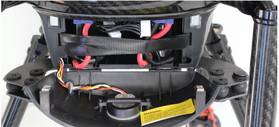
Am Heck des Kopters werden die Akkus eingeschoben, angeschlossen und mit Klettband fixiert
